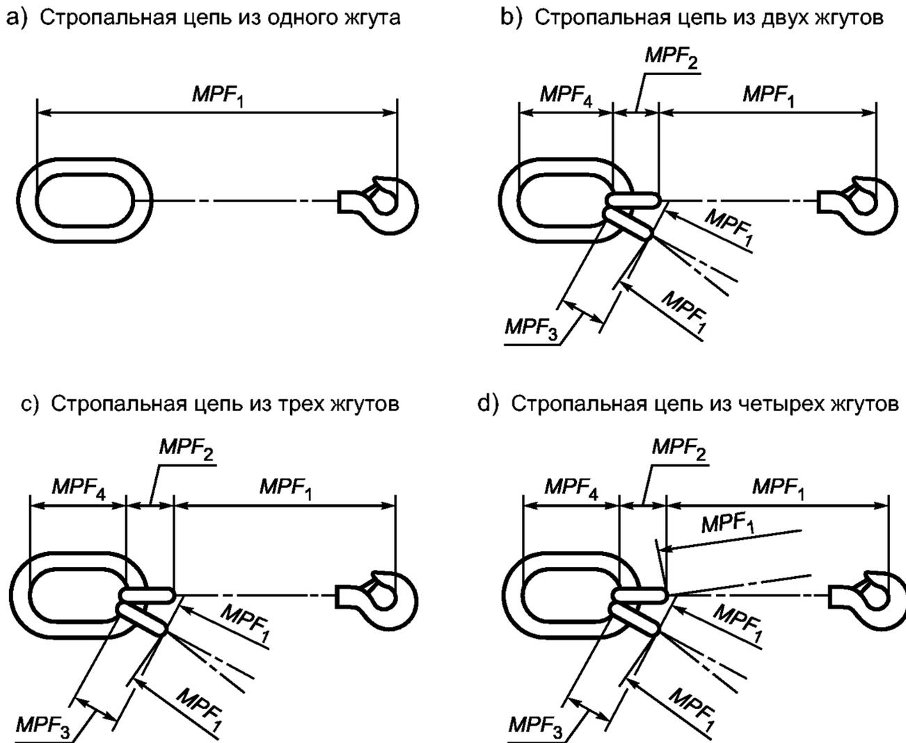
Рисунок 5 — Испытательные участки стропальных цепей
