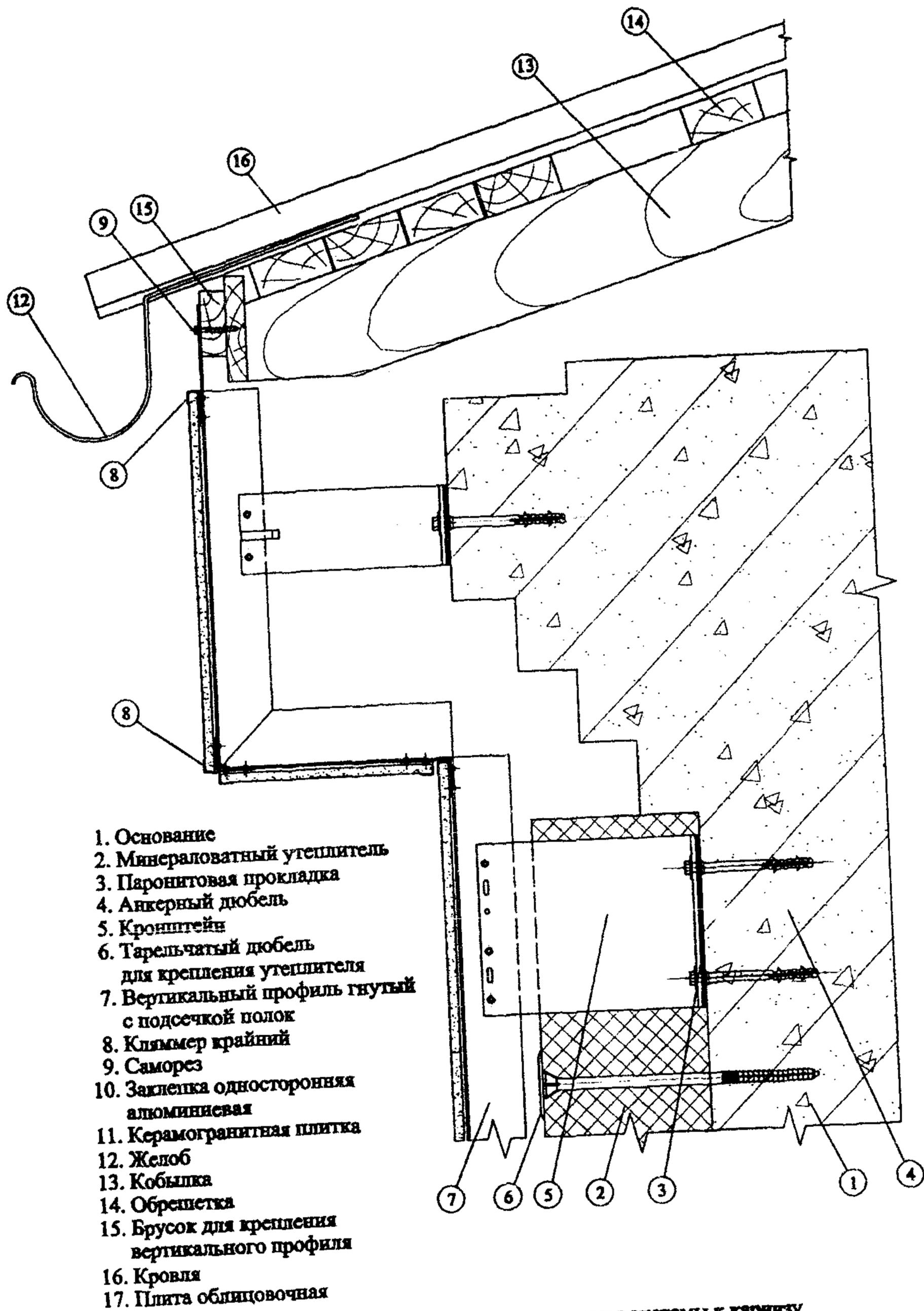
Рис. 3.17. Вертикальный разрез примыкания системы к карнизу
