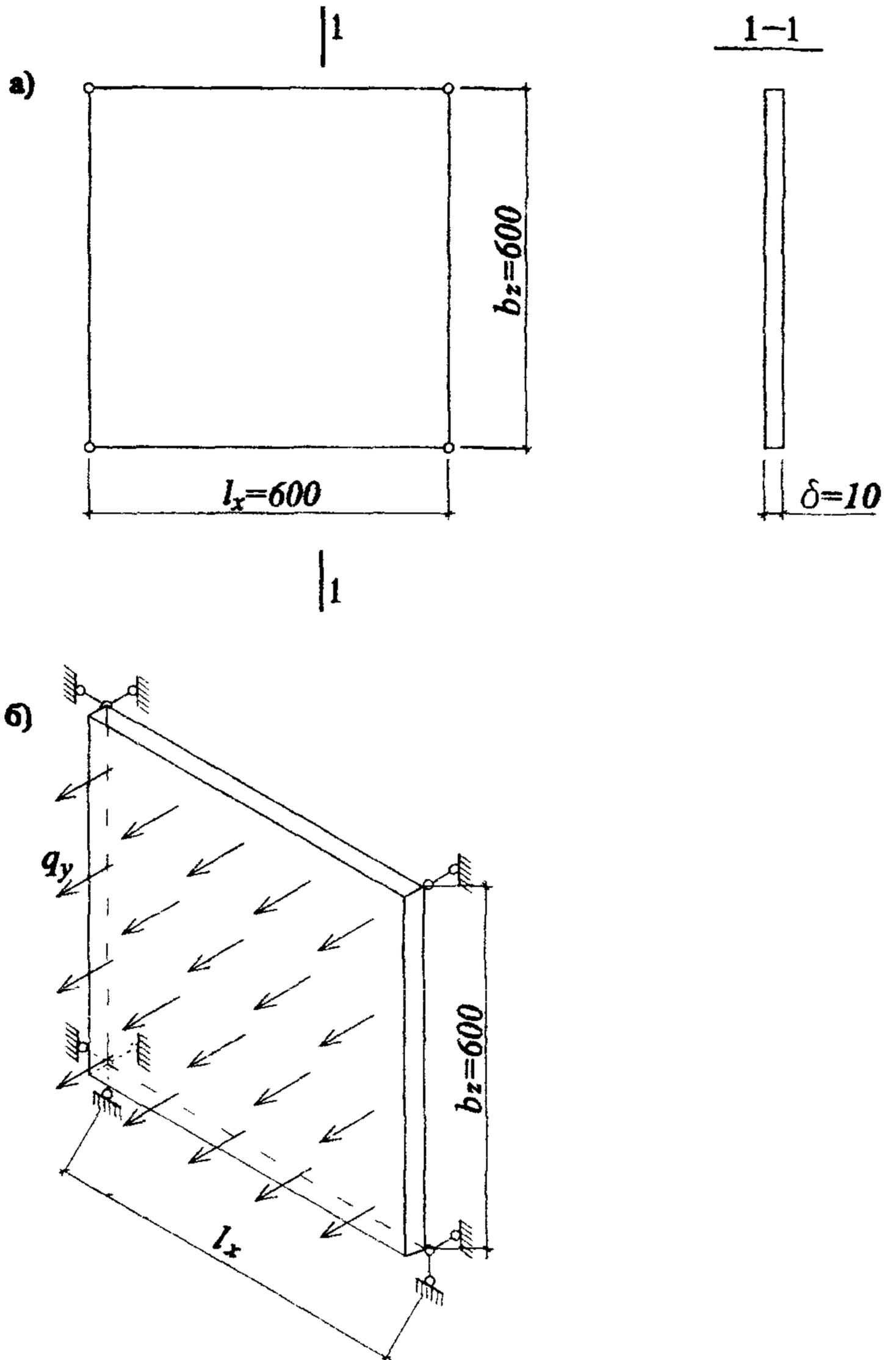
Рис. 6.1. Расчетная схема облицовочной плиты
