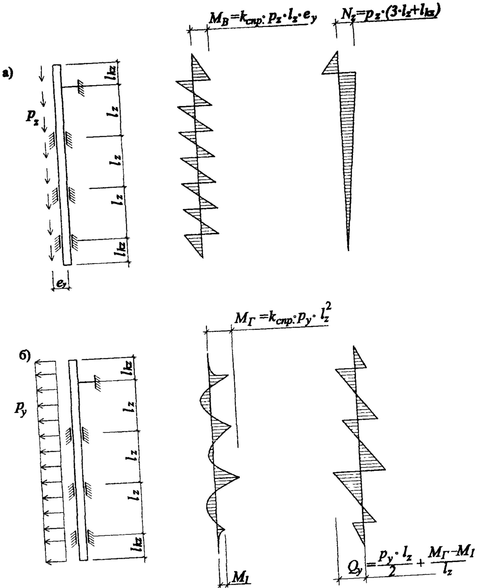
Рис. 6.2. Расчетная схема вертикальной направляющей
