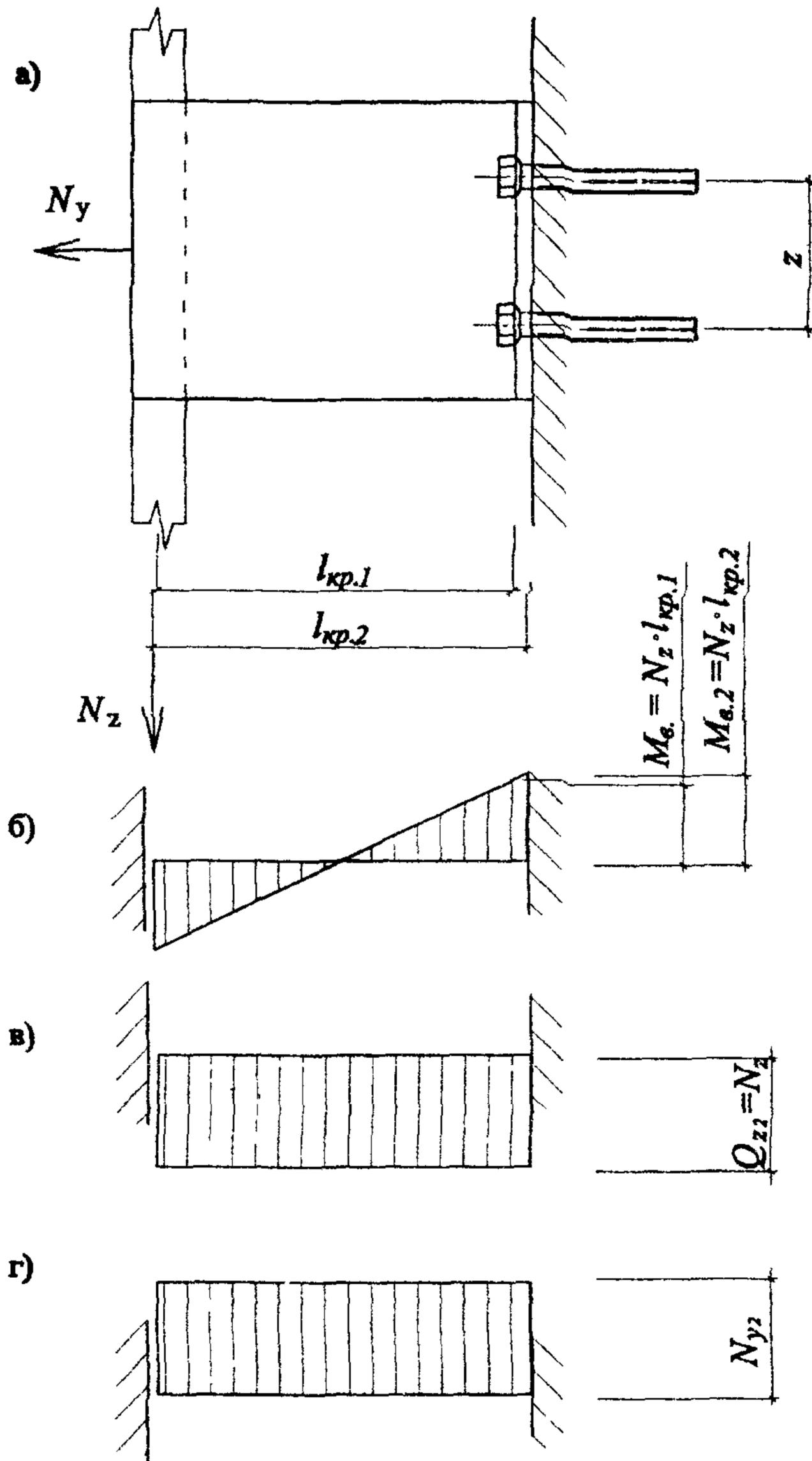
Рис. 6.3. Расчетная схема опорного кронштейна
