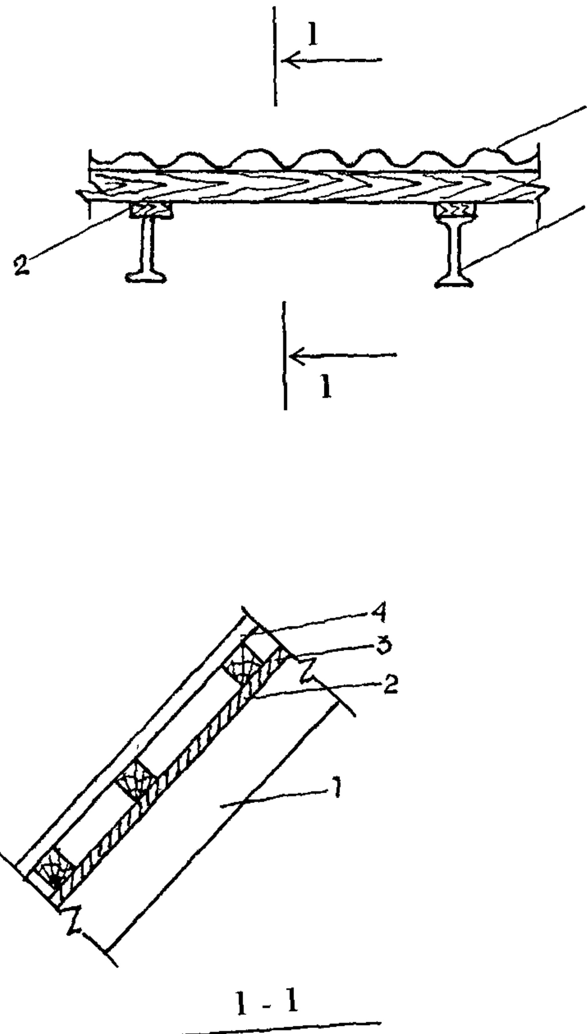
Рис. 4. Кровля с несущими металлическими конструкциями и водоизоляционным ковром из профильных листов: 1 - металлические стропила; 2 - продольные доски или бруски; 3 - обрешетка; 4 - водоизоляционный ковер из профилированных листов, гофрированных листов, металлической черепицы, цементно-песчаной черепицы
