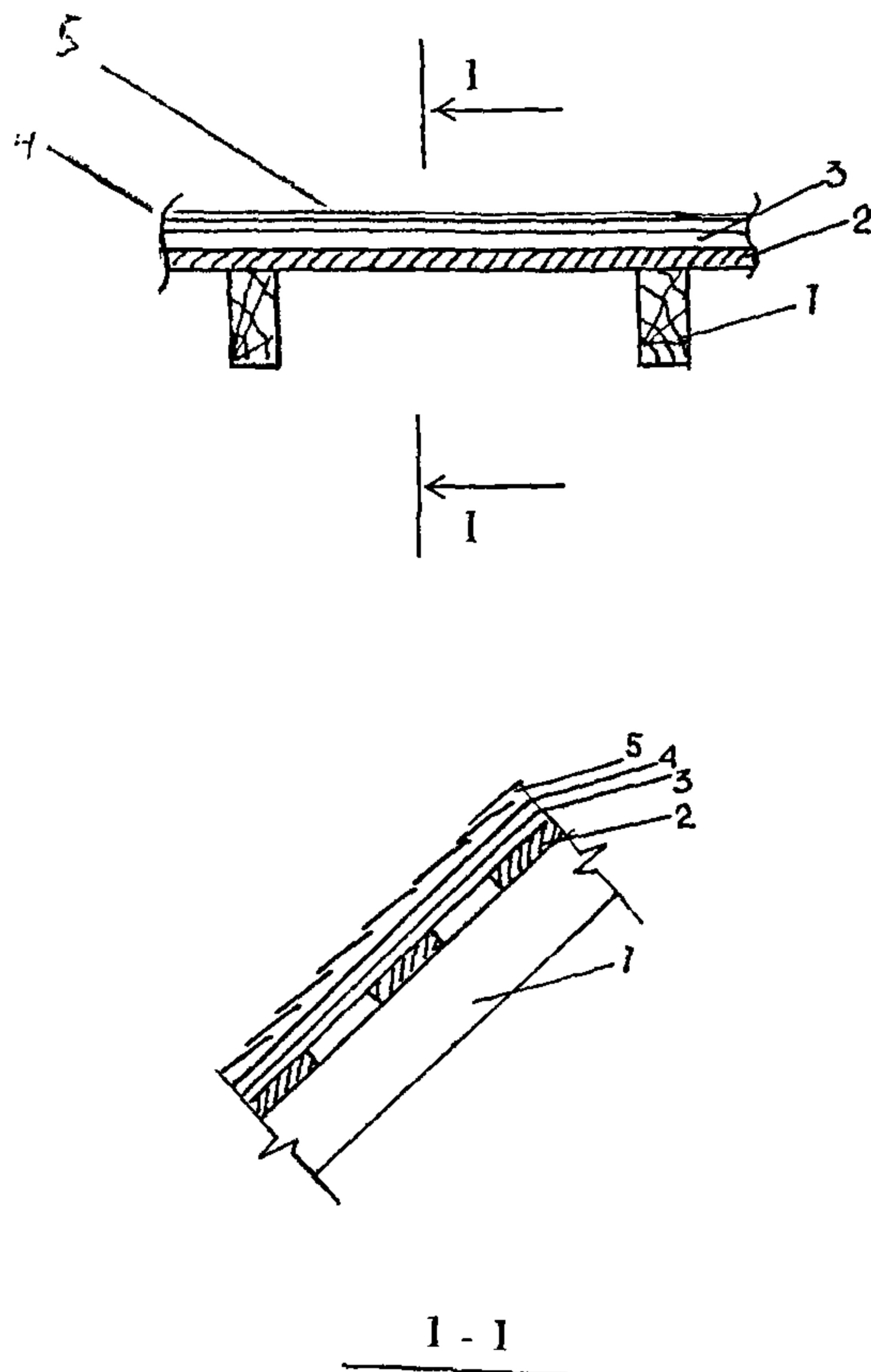
Рис. 9. Кровля с несущими деревянными конструкциями и водоизоляционным ковром из мягкой черепицы: 1 - деревянные стропила; 2 - обрешетка; 3 - водостойкая фанера; 4 - подкладочный слой; 5 -мягкая черепица
