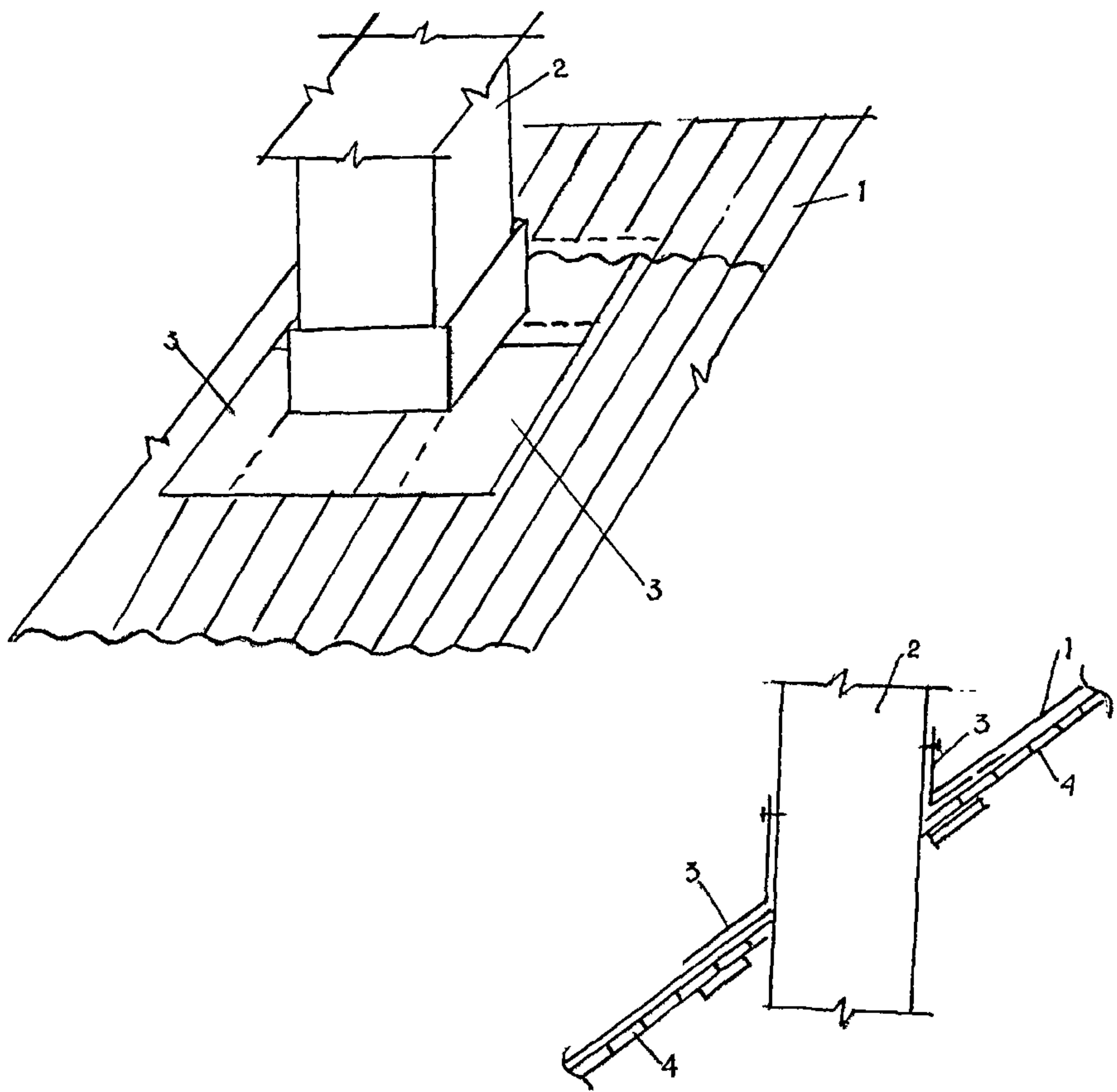
Рис. 14. Место примыкания водоизоляционного ковра к вентилятам, дымоходам и т.п. : 1 - водоизоляционный ковер; 2 - шахта, дымоход и т.п.; 3 - фартуки или специальная деталь; 4 - обрешетка
