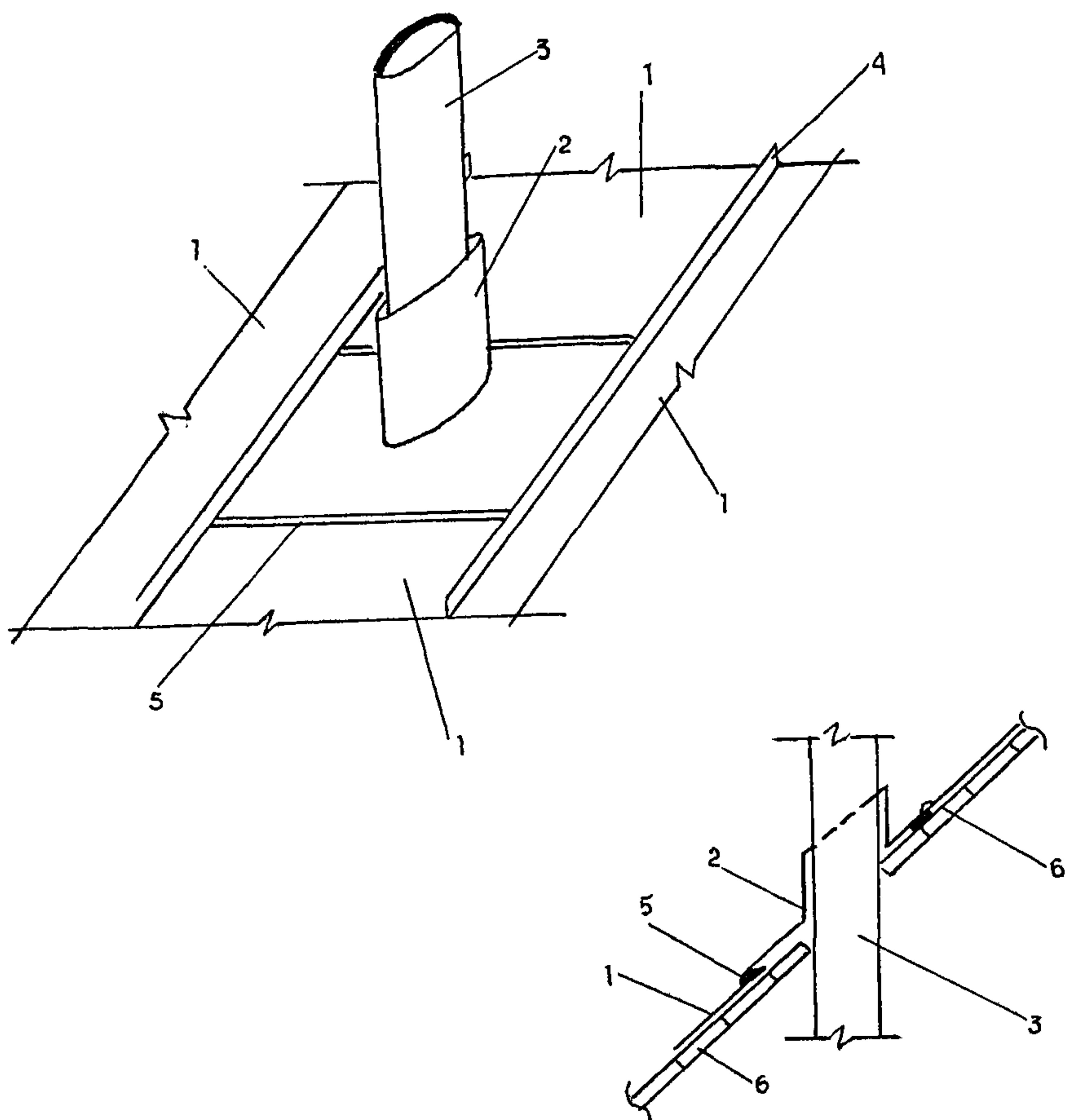
Рис. 15. Место примыкания водоизоляционного ковра к технологическим трубопроводам: 1 - водоизоляционный ковер; 2 - фасонная деталь из металла; 3 - технологический трубопровод; 4 - стоячий фальц; 5 - лежачий фальц; 6 - обрешетка
