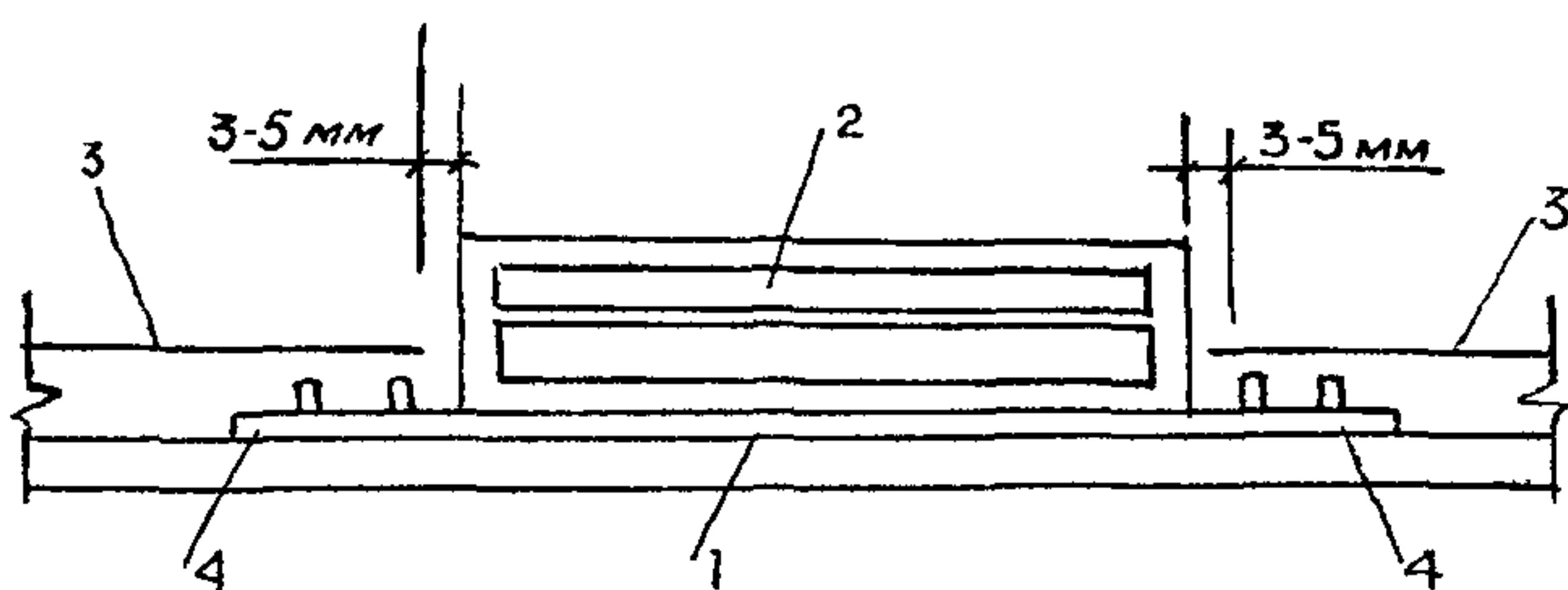
Рис. 13. Примыкание водоизоляционного ковра к мансардным окнам:
