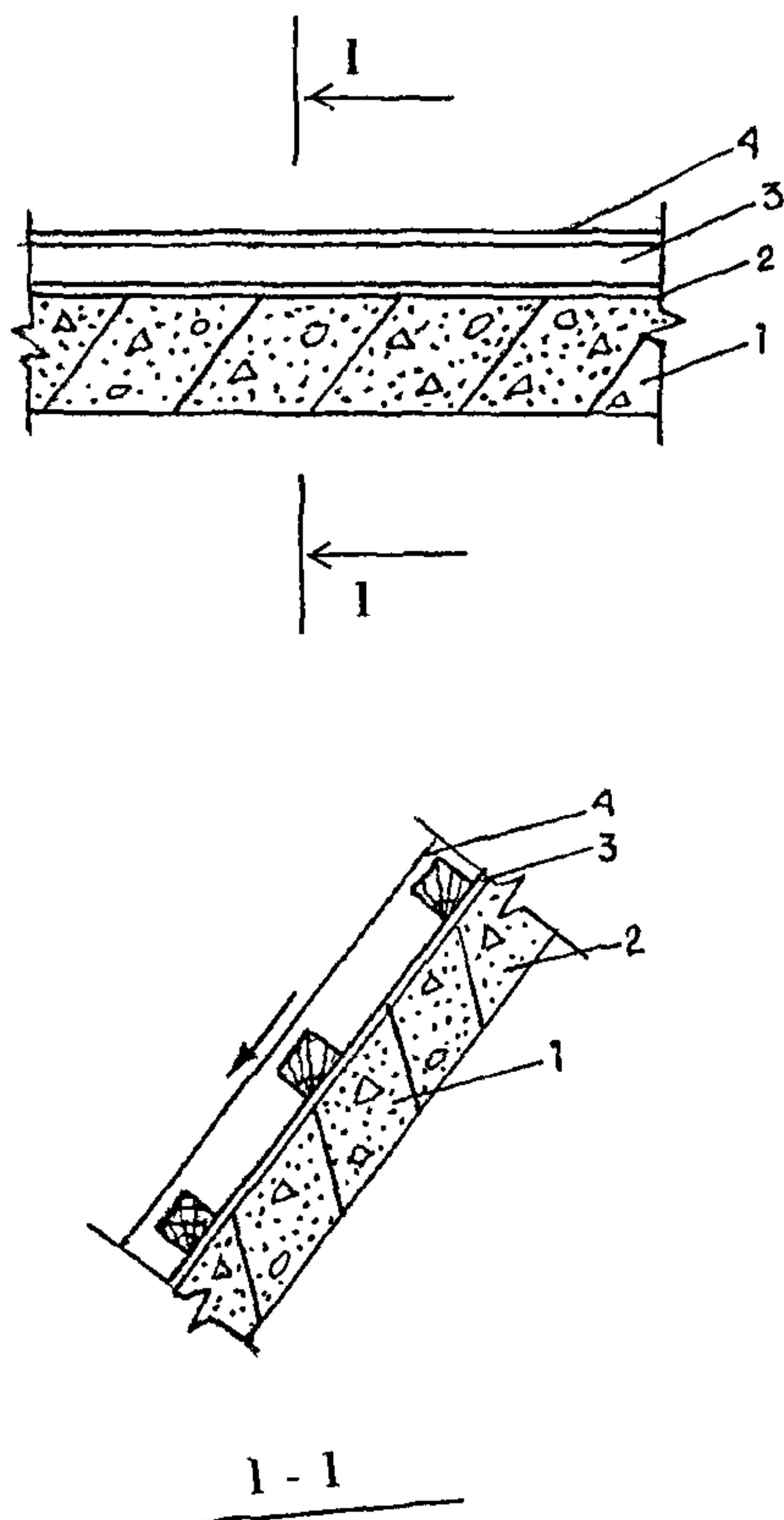
Рис. 5. Кровля с несущей железобетонной плитой: 1 - железобетонная плита; 2 - пароизоляция; 3 - деревянные бруски; 4 - водоизоляционный ковер из плоских или профильных листов, цементно-песчаной черепицы
