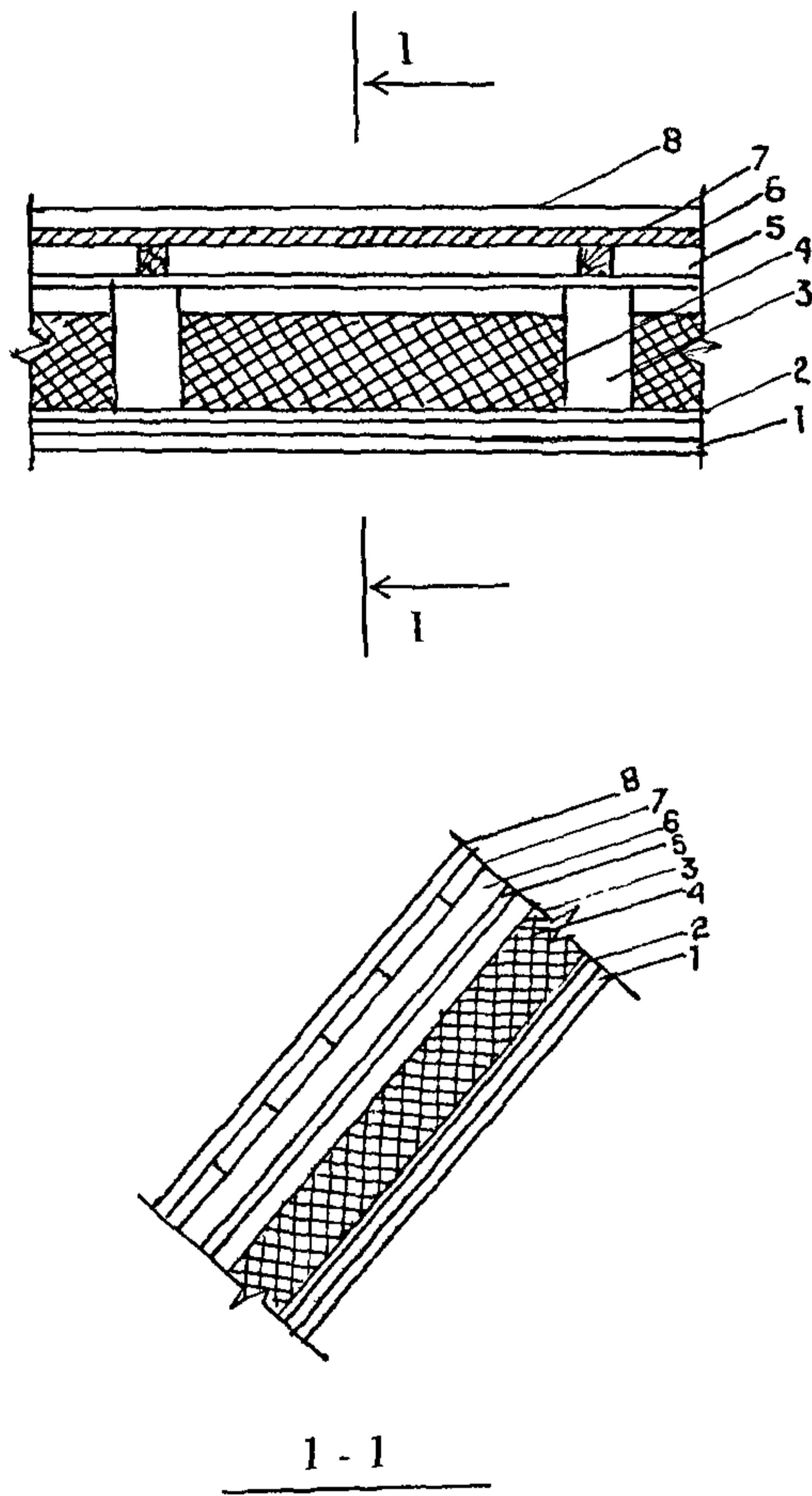
Рис. 7. Конструкция мансардной кровли с несущими деревянными конструкциями: 1 - подшивной потолок; 2 - пароизоляция; 3 - деревянные стропила; 4 - утеплитель; 5 - диффузионная пленка; 6 - обрешетка; 7 - деревянные бруски; 8 - водонизоляционный ковер из плоских или профильных листов, цементно-песчаной черепицы
