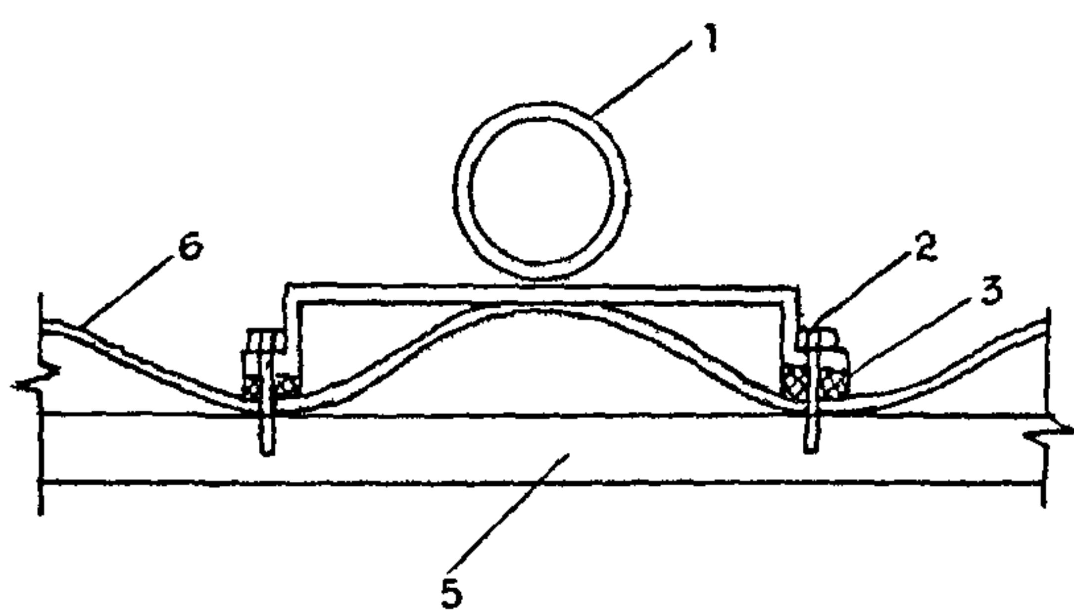
Рис. 16. Узлы крепления анкеров при различных материалах водоизоляционных ковров: 1 - анкер; 2 - саморез; 3 - резиновая прокладка; 4 - плоский лист или мягкая черепица; 5 - обрешетка, брускок или железобетонная плита; 6 - профильный лист
