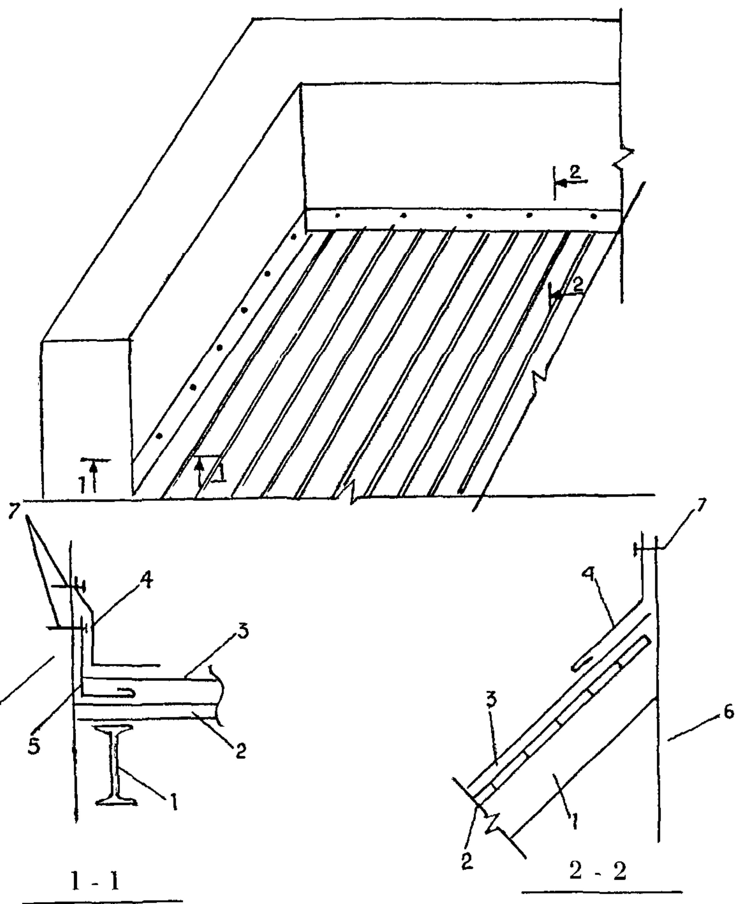
Рис. 12. Места примыкания к стенам и парапетам по уклону и горизонтали:
