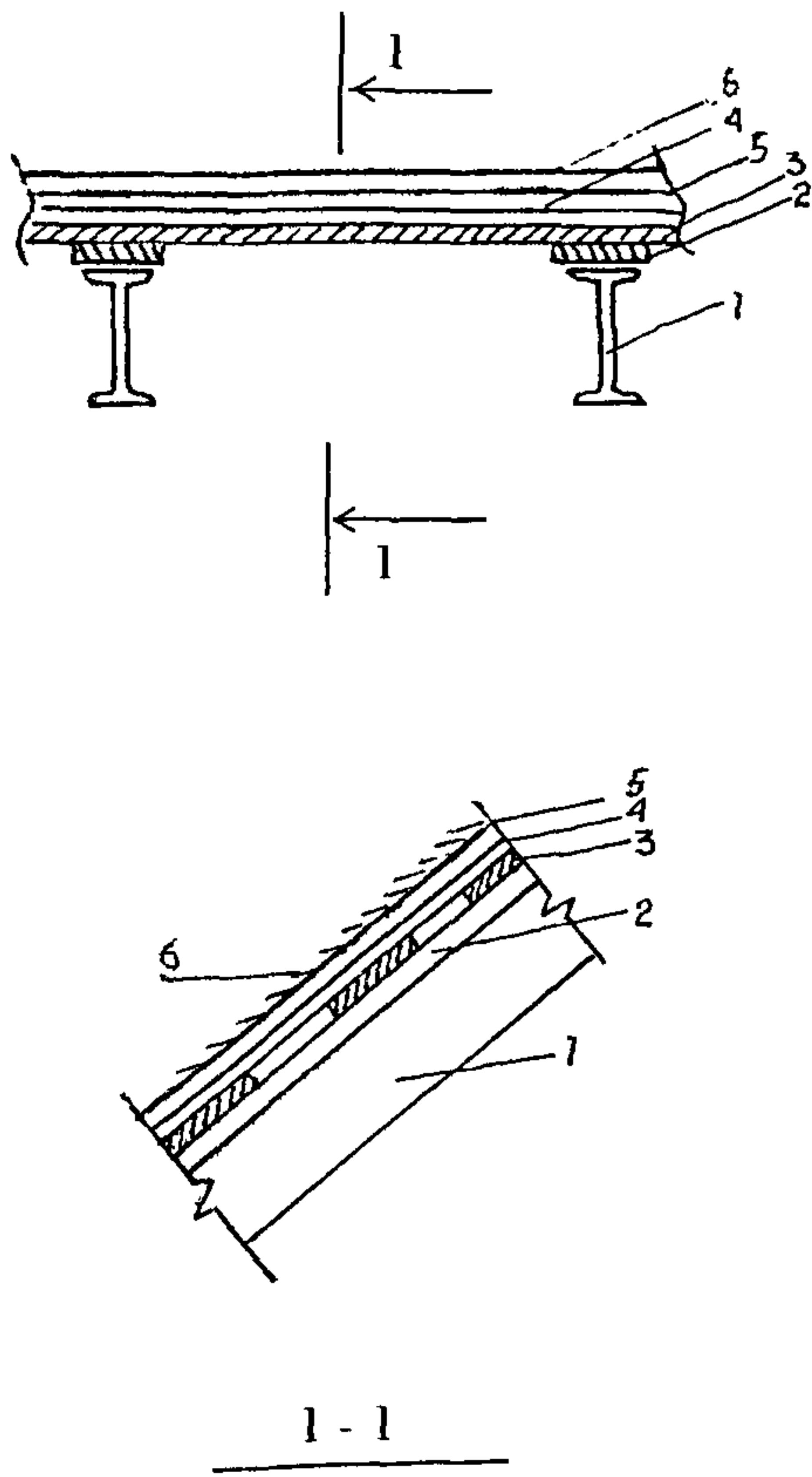
Рис. 10. Кровля с несущими металлическими конструкциями и водоизоляционным ковром из мягкой черепицы: 1 - металлические стропила; 2 - продольные доски или бруски; 3 - обрешетка; 4 - водостойкая фанера; 5 - подкладочный слой; 6 - мягкая черепица
