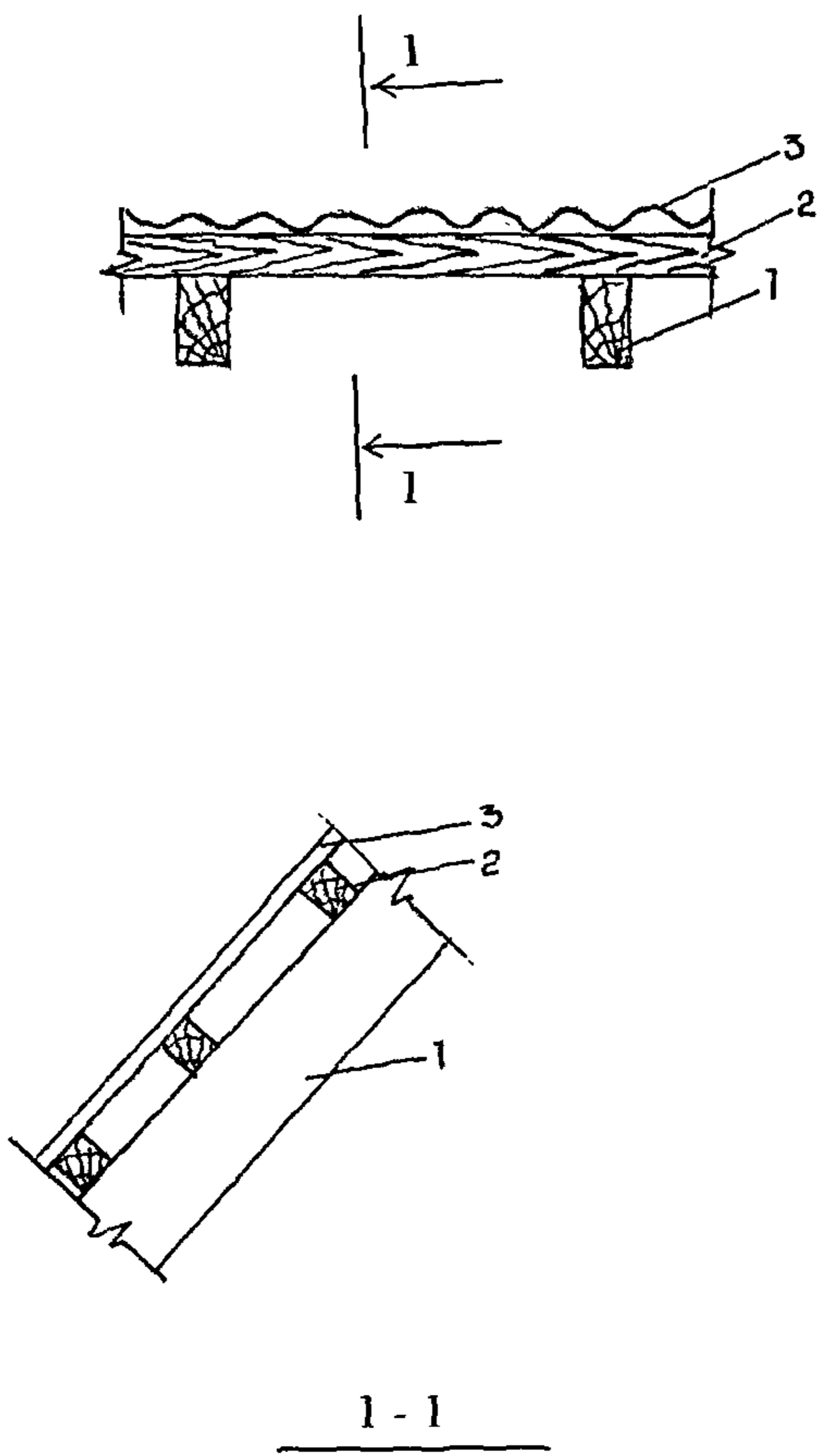
Рис. 3. Кровля с несущими деревянными конструкциями и водоизоляционным ковром из профильных листов: 1- деревянные стропила; 2 обрешетка; 3 - водоизоляционный ковер из профилированных листов, гофрированных листов, металлической черепицы, цементно-песчаной черепицы
