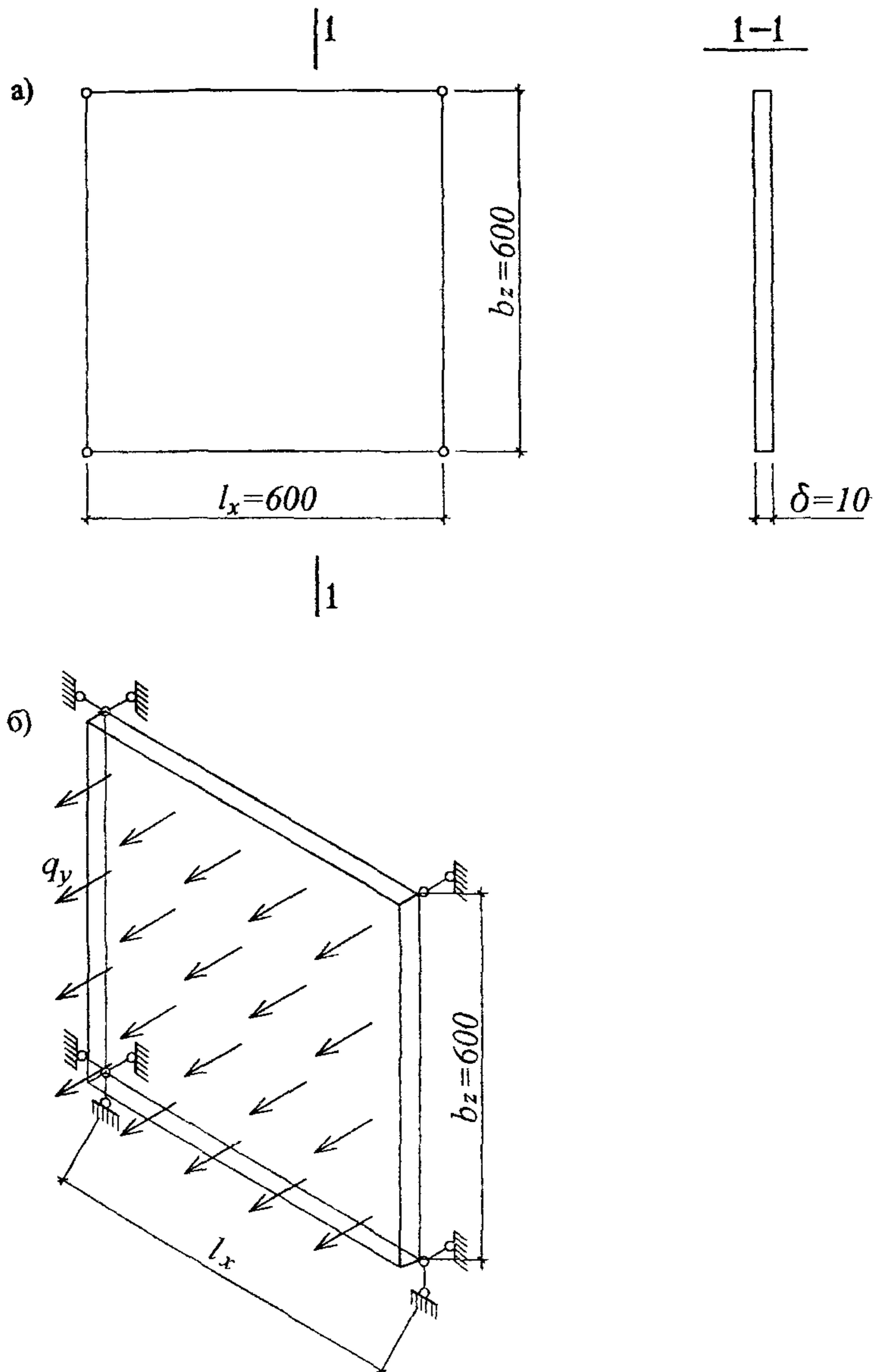
Рис 6.1 Расчетная схема облицовочной плиты
