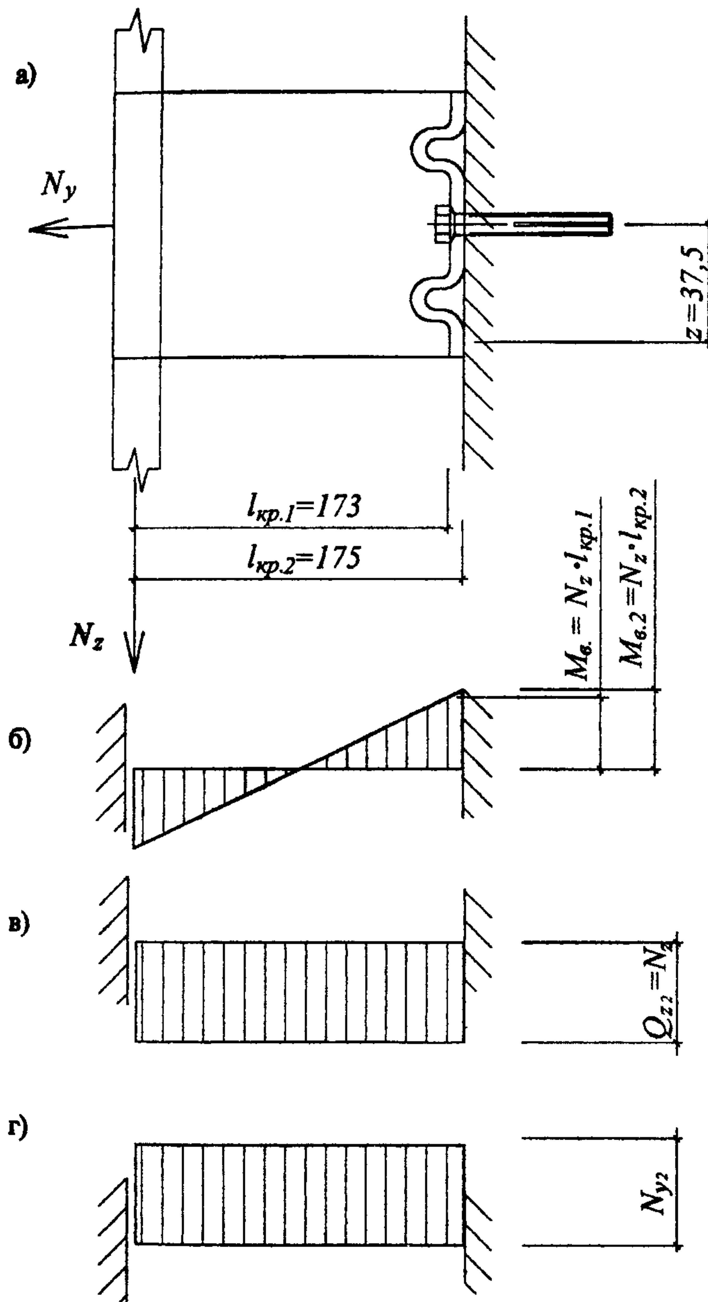
Рис. 6.3. Расчетная схема опорного кронштейна
