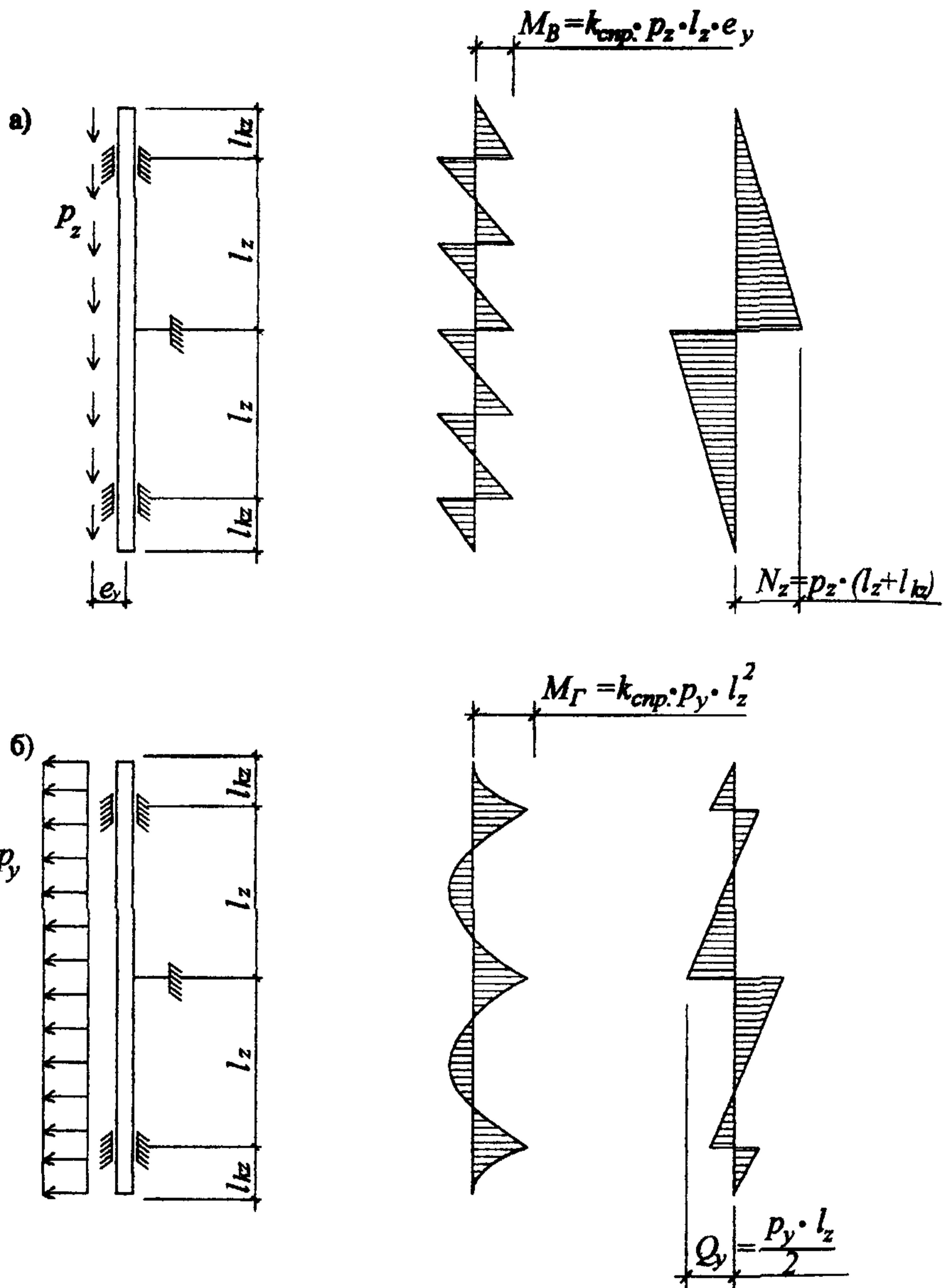
Рис. 6.2. Расчетная схема вертикальной направляющей
