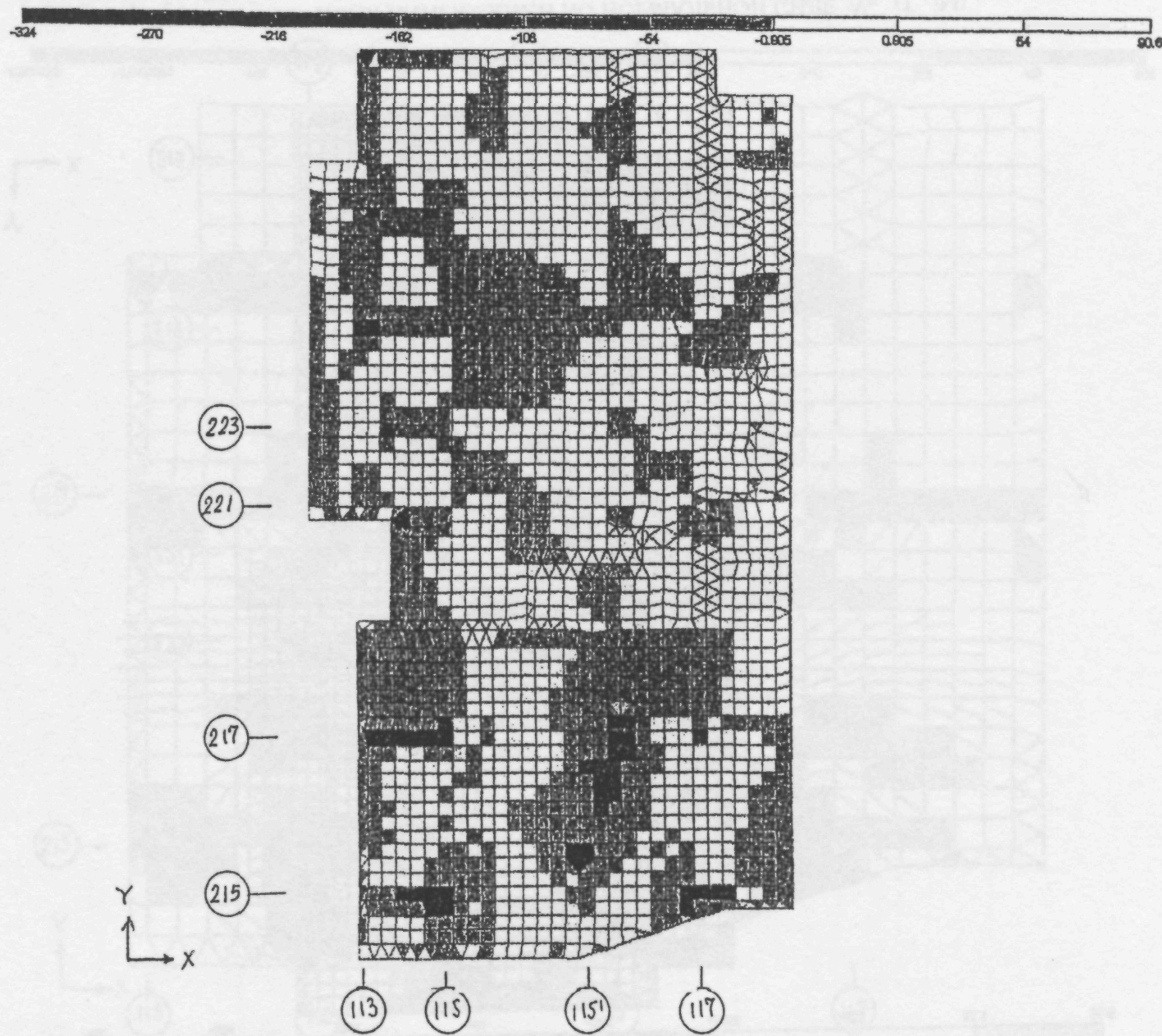
РИСУНОК Б9. ПОЛЯ НАПРЯЖЕНИЙ ПО НОРМАЛЬНОЙ СИЛЕ  $N_y$  ( $\text{Т/м}^2$ )
