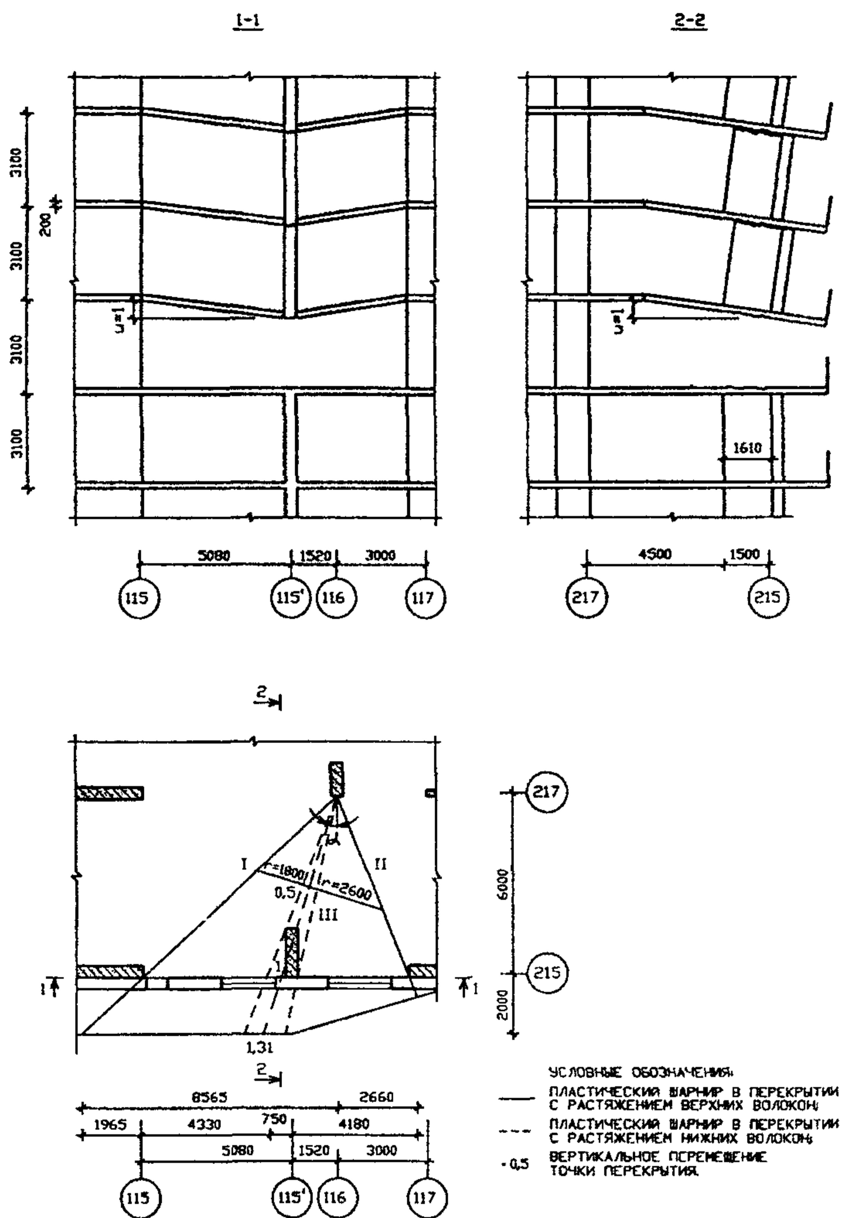
РИСУНОК А2.7. СХЕМА 2. МЕХАНИЗМ ОБРУШЕНИЯ ВТОРОГО ТИПА.
