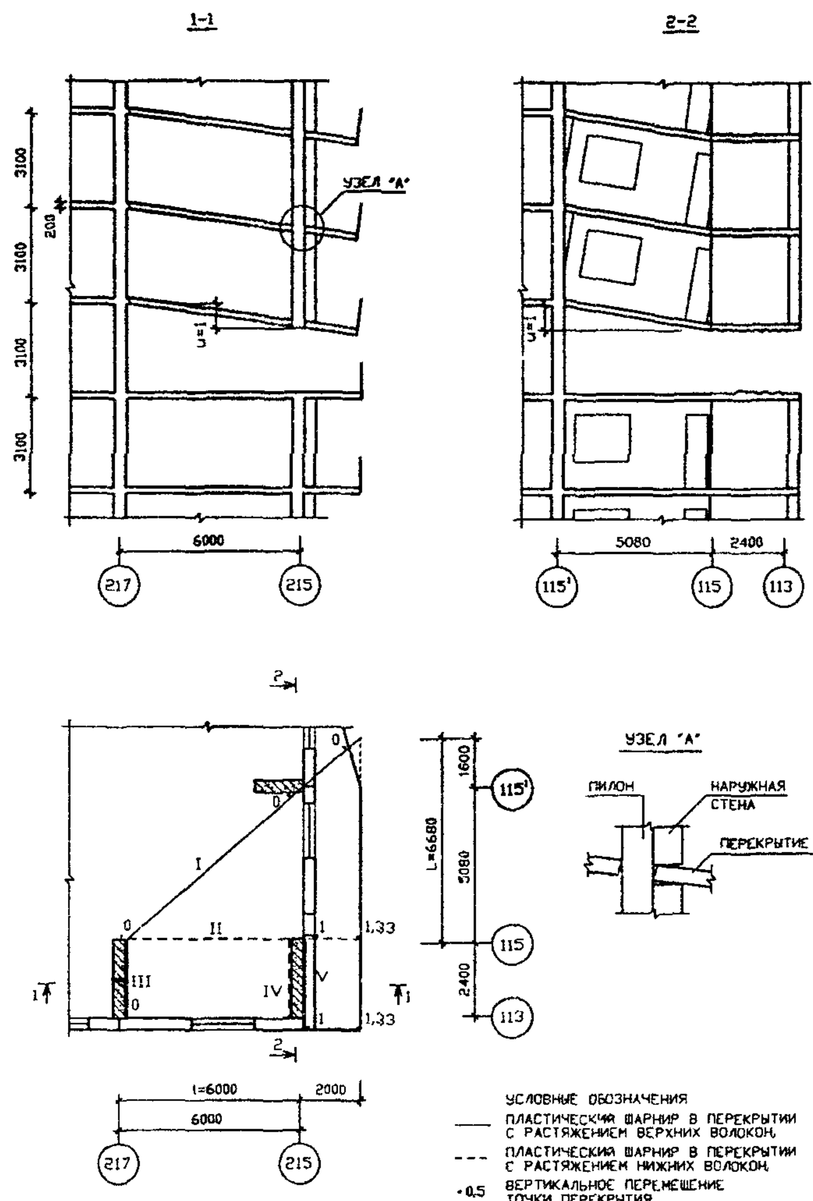
РИСУНОК А2.1 СХЕМА 1 МЕХАНИЗМ ОБРУШЕНИЯ ПЕРВОГО ТИПА
