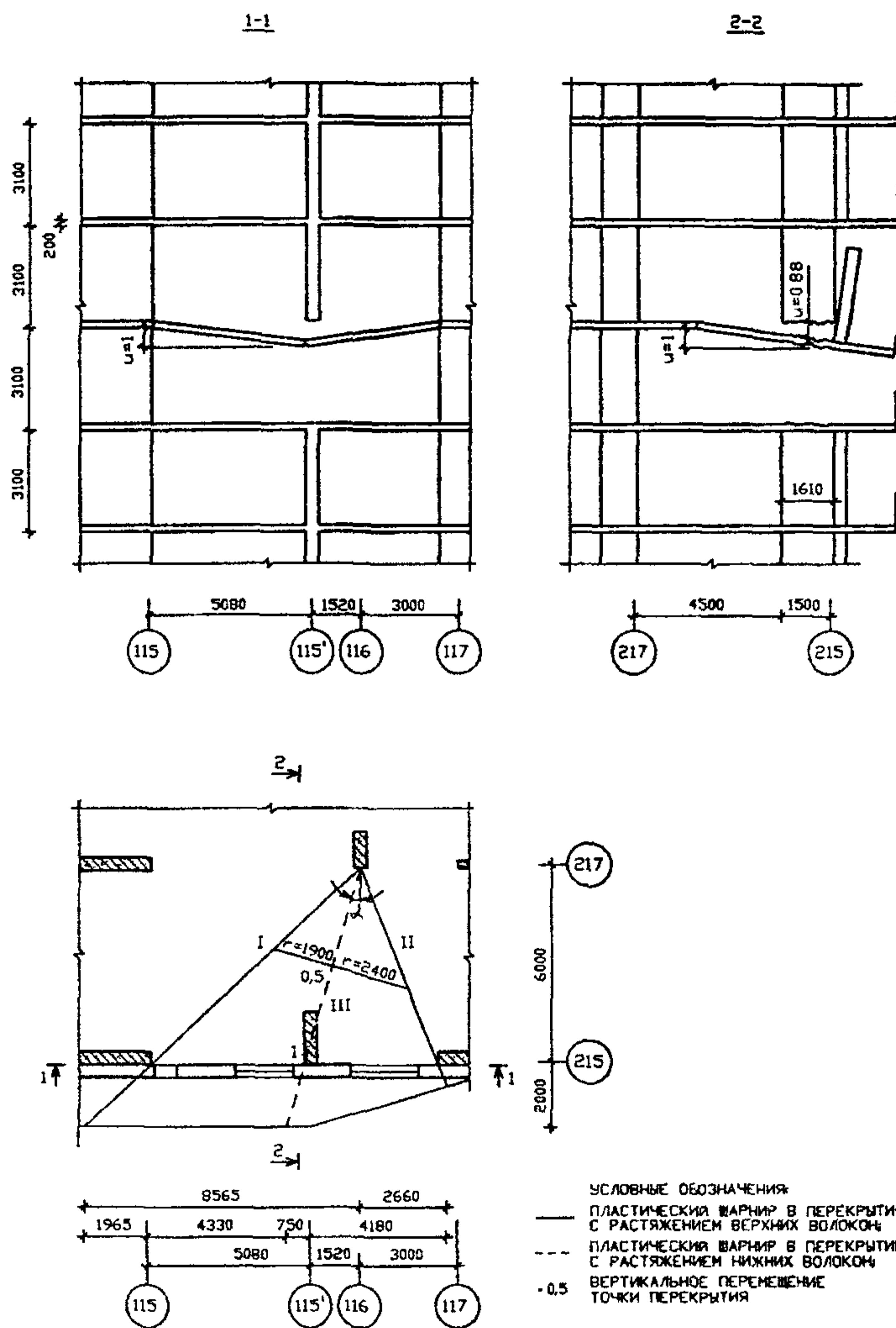
РИСУНОК А2.8 СХЕМА 2 МЕХАНИЗМ ОБРУШЕНИЯ ТРЕТЬЕГО ТИПА
