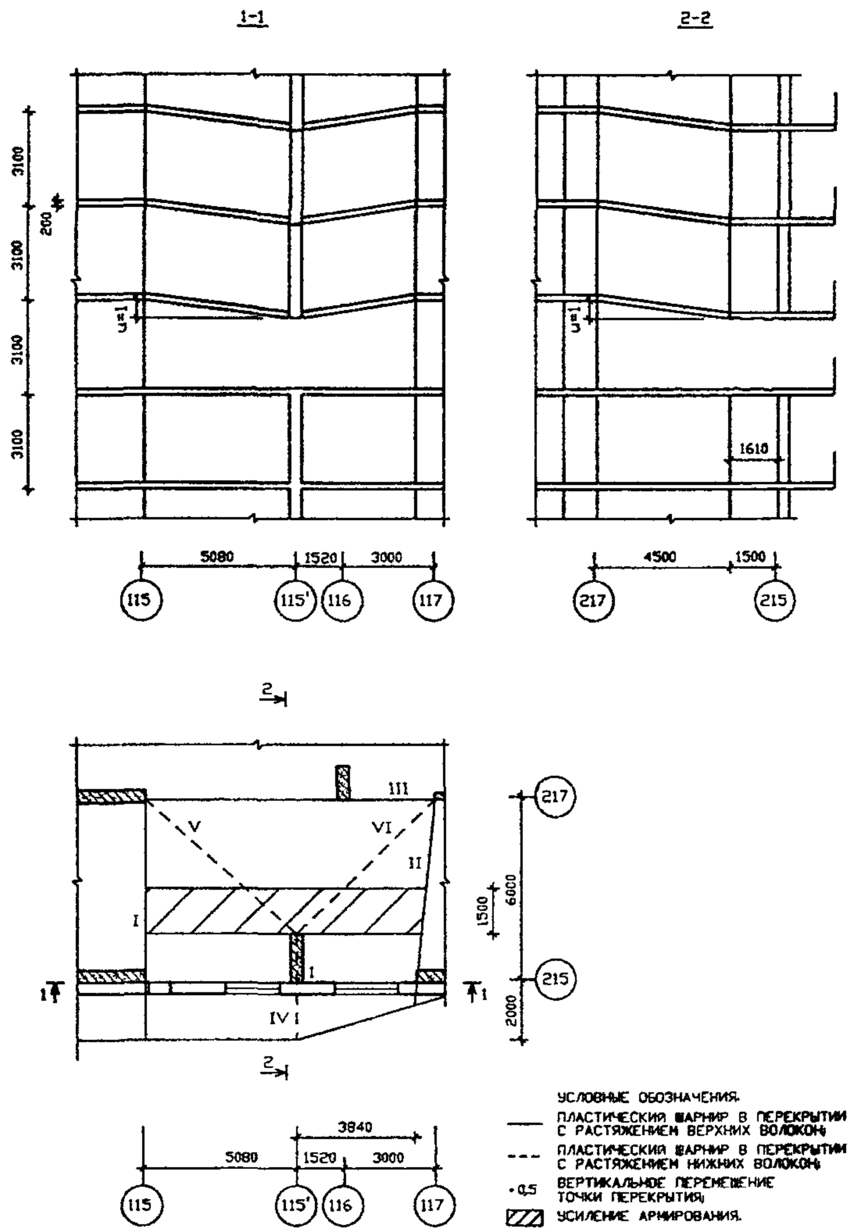
РИСУНОК А26 СХЕМА 2 МЕХАНИЗМ ОБРУШЕНИЯ ПЕРВОГО ТИПА.
