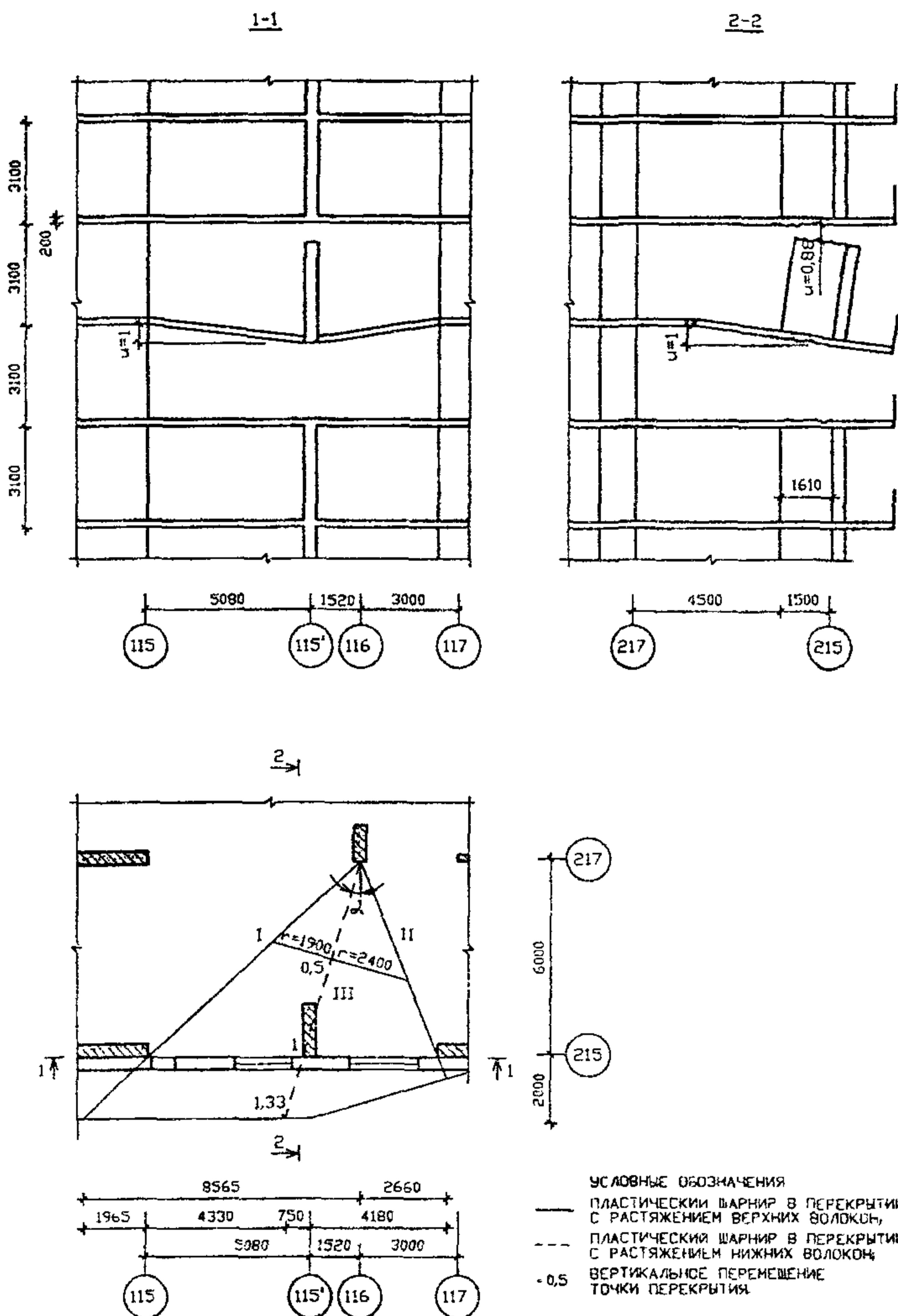
РИСУНОК А2.9. СХЕМА 2. МЕХАНИЗМ ОБРУШЕНИЯ ЧЕТВЕРТОГО ТИПА
