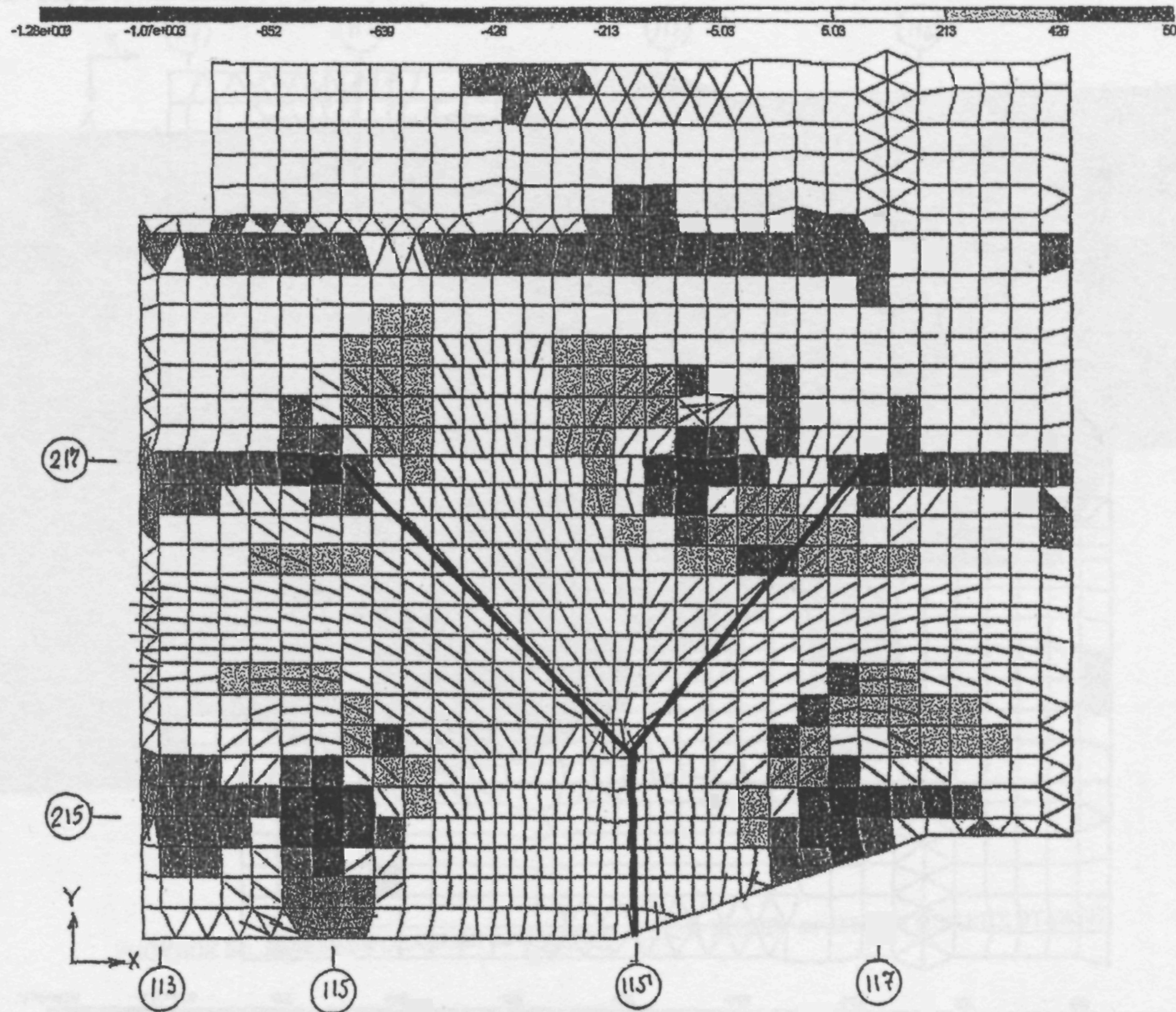
РИСУНОК Б7. ГЛАВНЫЕ НАПРЯЖЕНИЯ  $N_1$  ( $\text{тм}^2$ ) И РАСЧЕТНЫЕ СХЕМЫ РАЗВИТИЯ ТРЕЩИН НА НИЖНÉЙ ПОВЕРХНОСТИ ПЕРЕКРЫТИЯ
