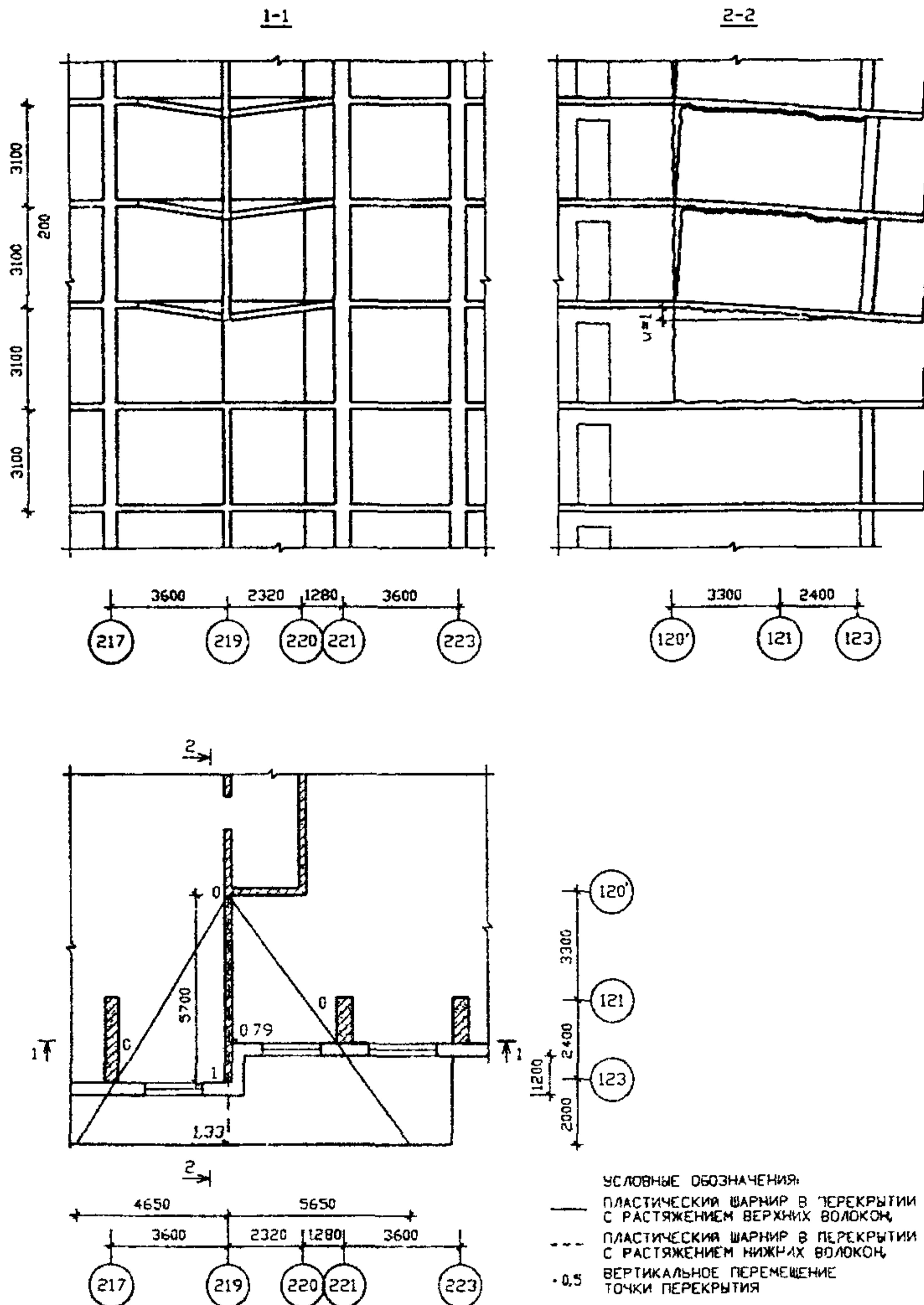
РИСУНОК А210 СХЕМА 5 МЕХАНИЗМ ОБРУШЕНИЯ ВТОРОГО ТИПА.
