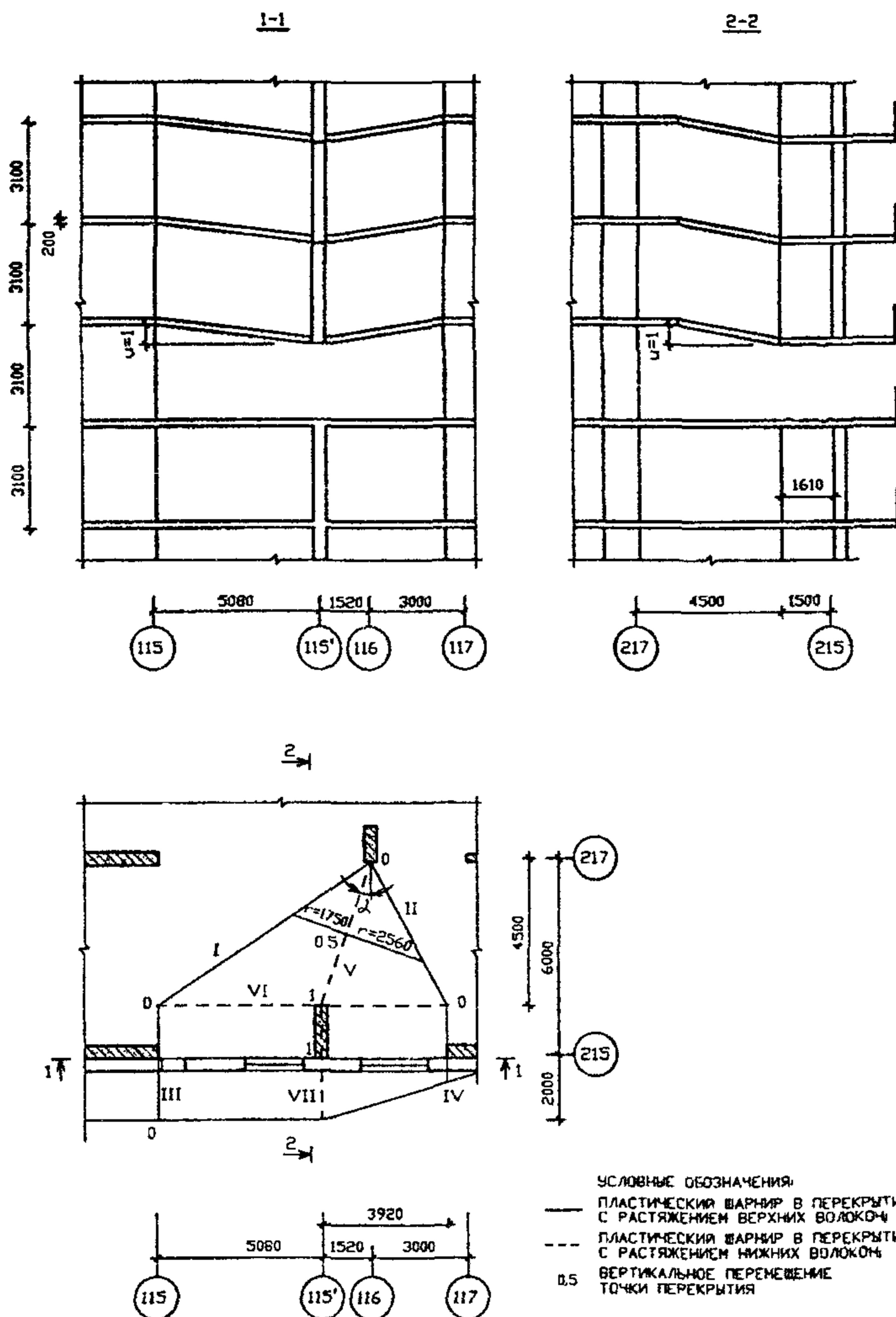
РИСУНОК А2.5 СХЕМА 2 МЕХАНИЗМ ОБРУШЕНИЯ ПЕРВОГО ТИПА
