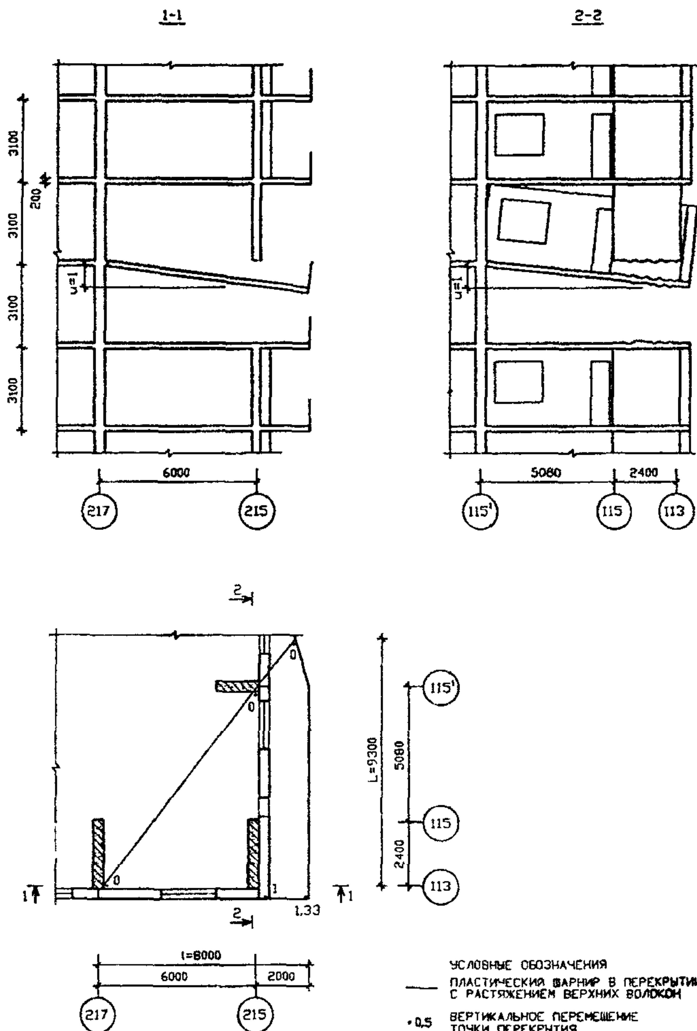
РИСУНОК А2.3. СХЕМА 1 МЕХАНИЗМ ОБРУШЕНИЯ ТРЕТЬЕГО ТИПА
