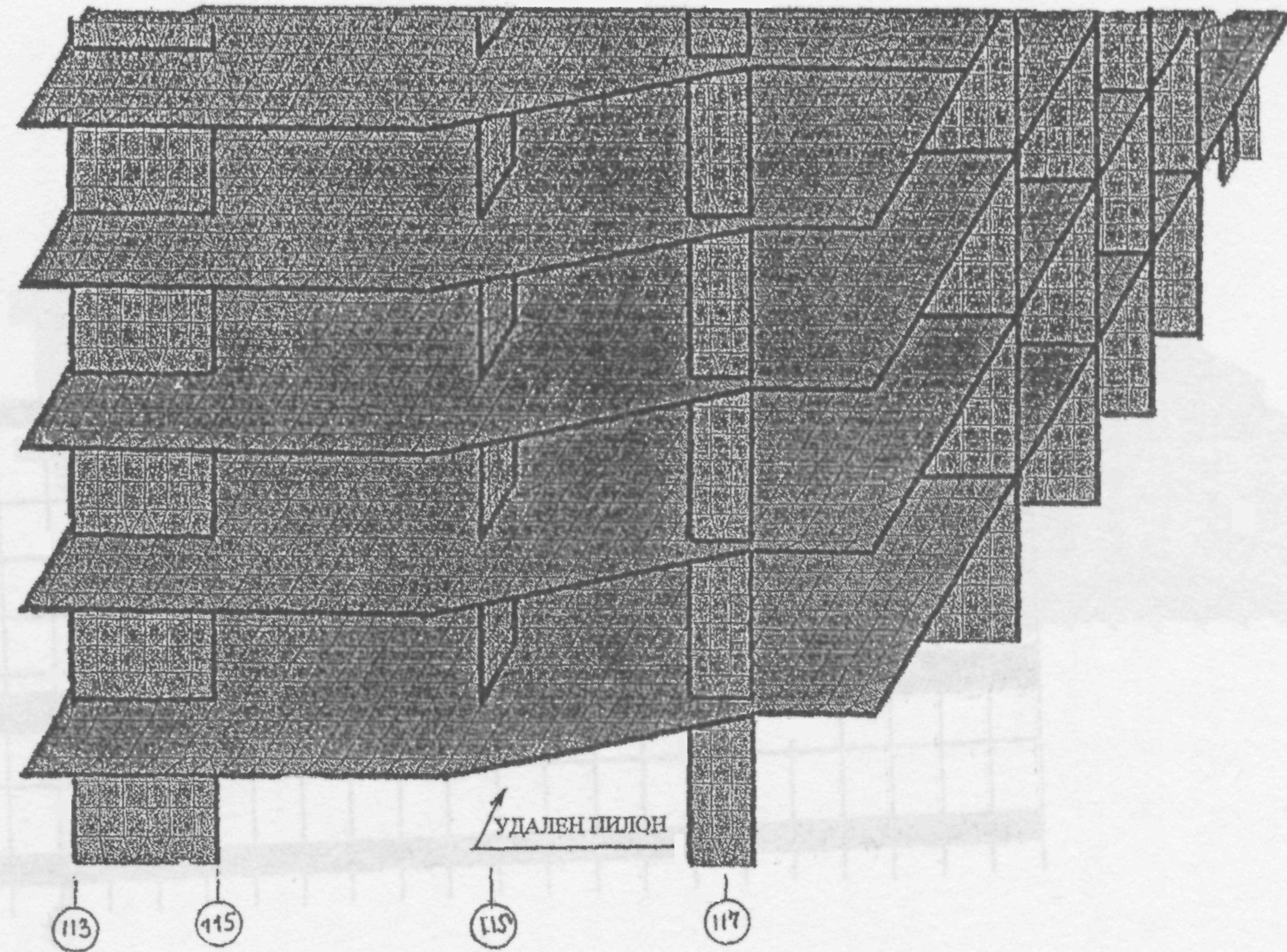
РИСУНОК Б3. ФРАГМЕНТ РАСЧЕТНОЙ МОДЕЛИ (НИЖНИЕ ЭТАЖИ)
