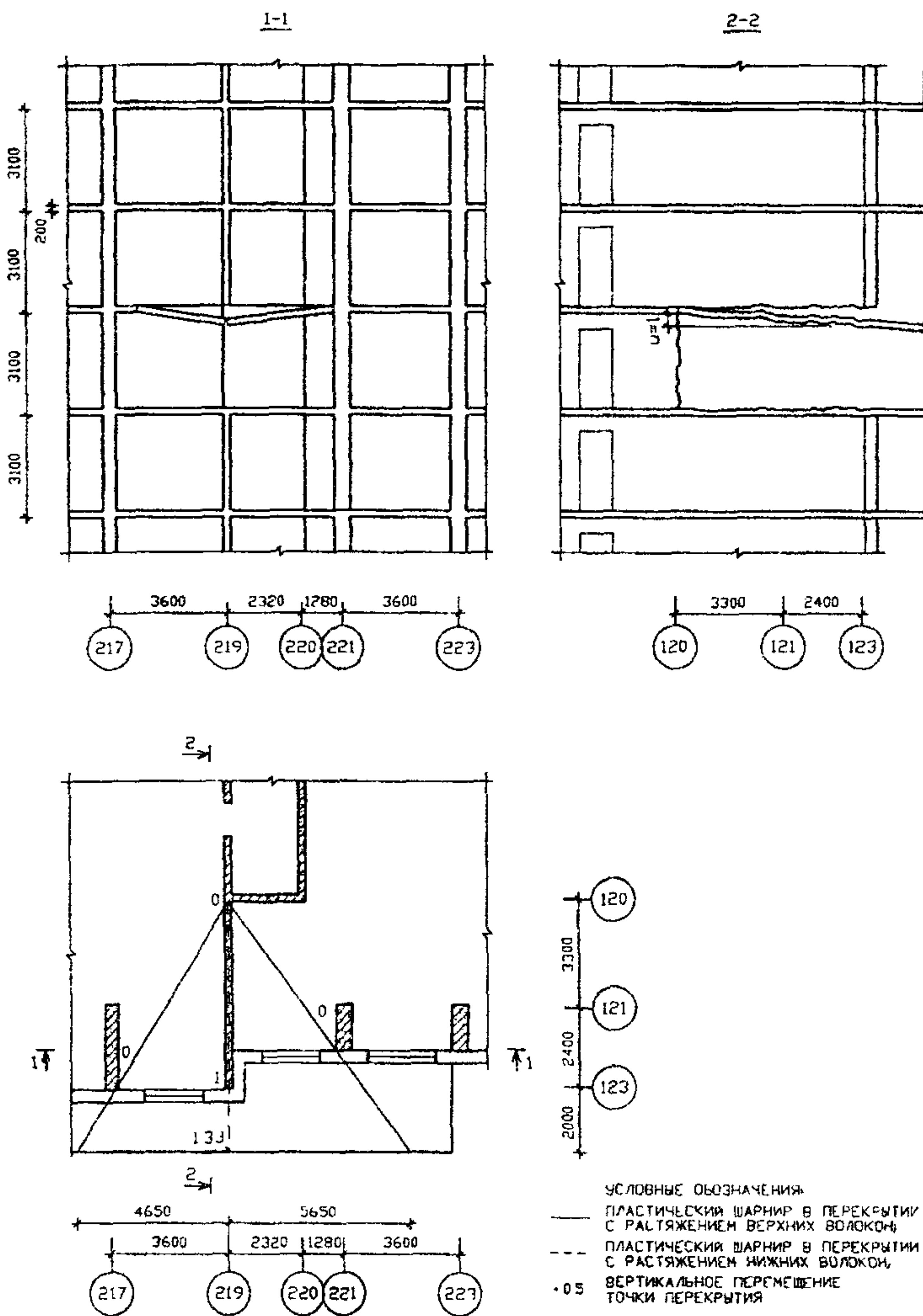
РИСУНОК А2.12 СХЕМА 5 МЕХАНИЗМ ОБРУШЕНИЯ ТРЕТЬЕГО ИПА
