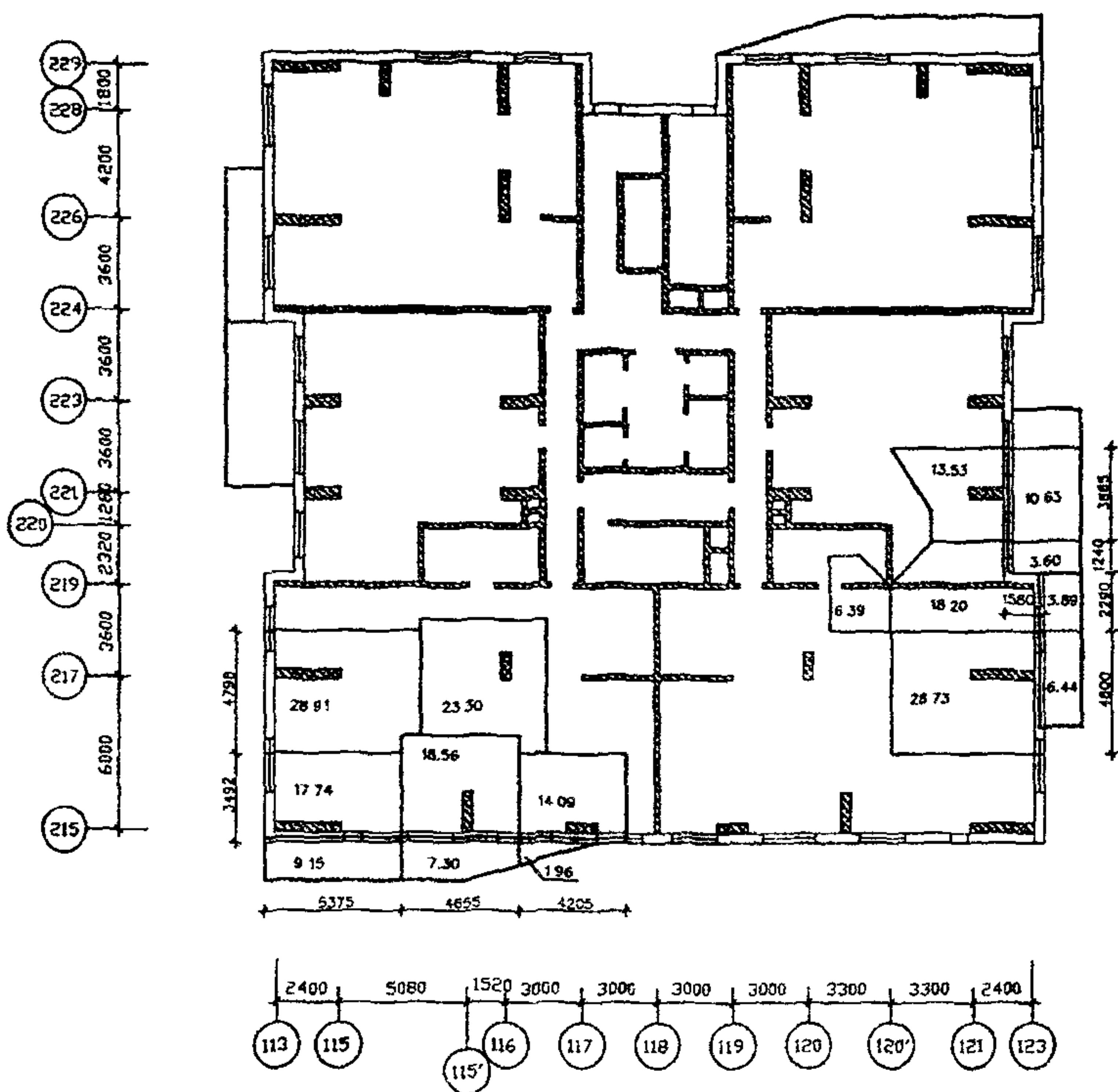
РИСУНОК А.12. СХЕМА ГРУЗОВЫХ ПЛОЩАДЕЙ В ЗДАНИИ БЕЗ ПОВРЕЖДЕНИЯ.
