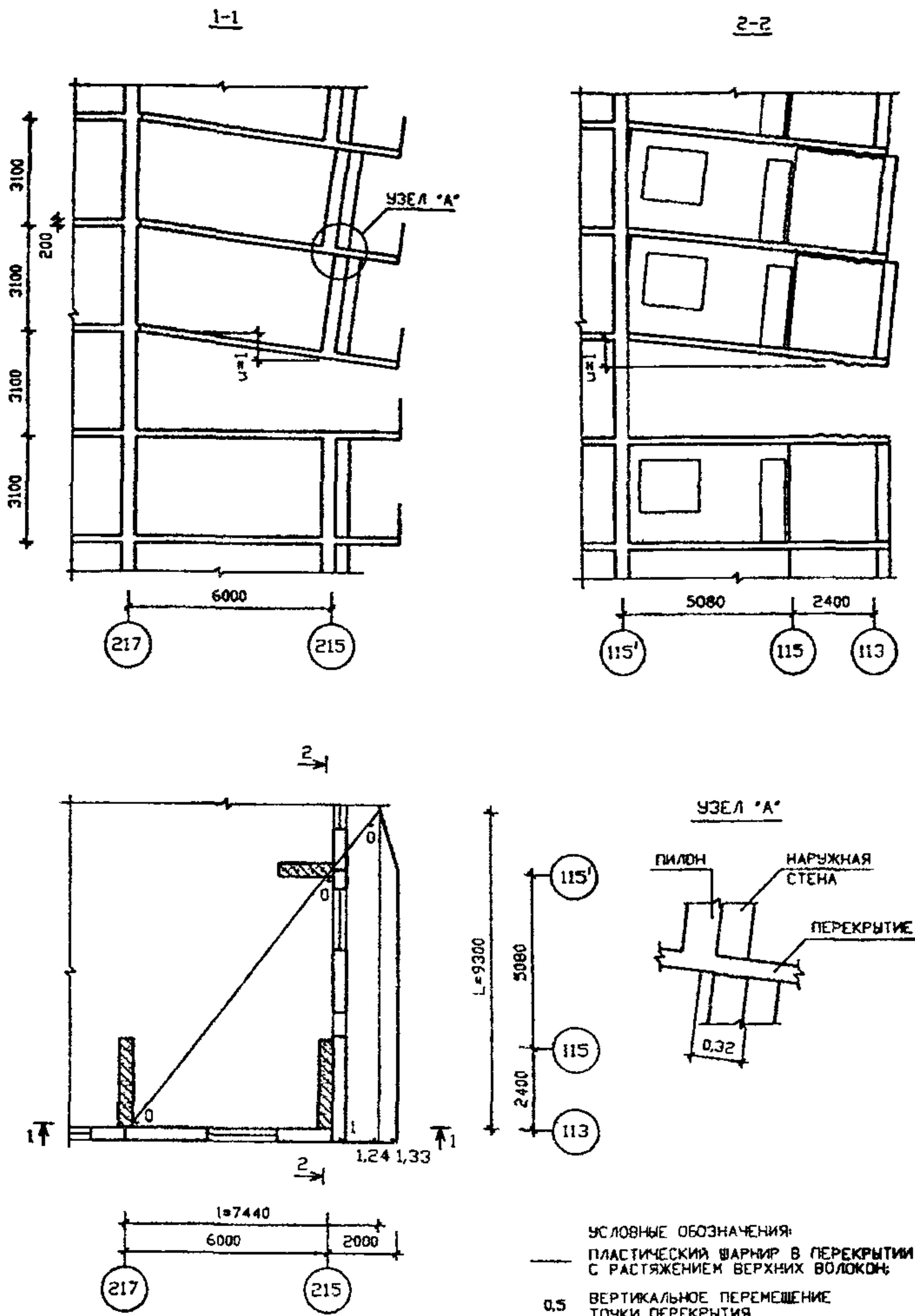
РИСУНОК А2.2. СХЕМА 1 МЕХАНИЗМ ОБРУШЕНИЯ ВТОРОГО ТИПА
