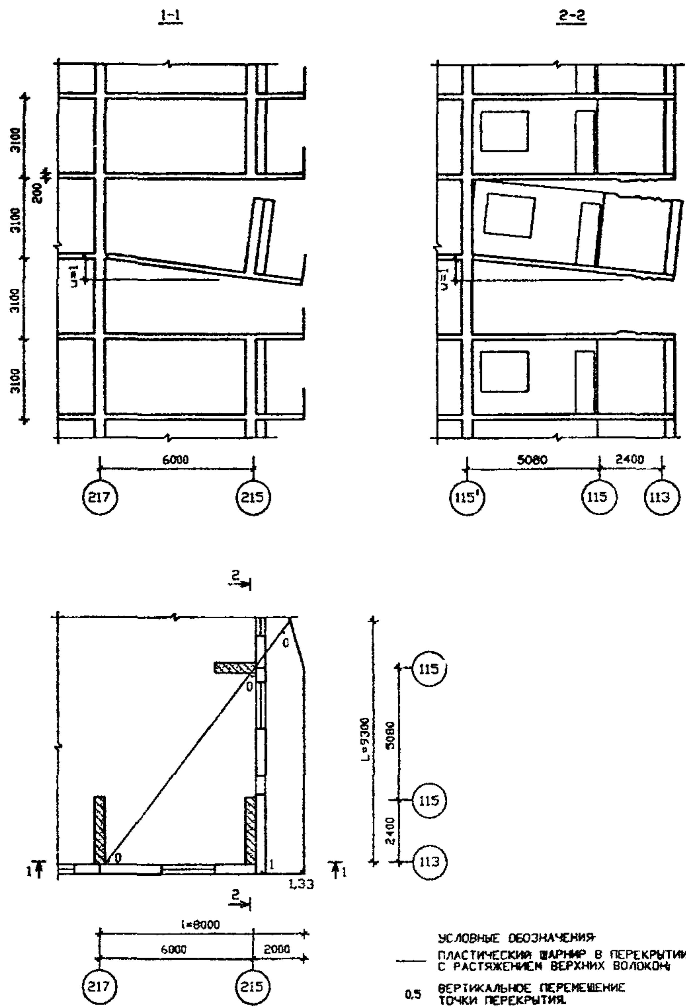
РИСУНОК А2.4 СХЕМА 1. МЕХАНИЗМ ОБРАЖЕНИЯ ЧЕТВЕРТОГО ТИПА.
