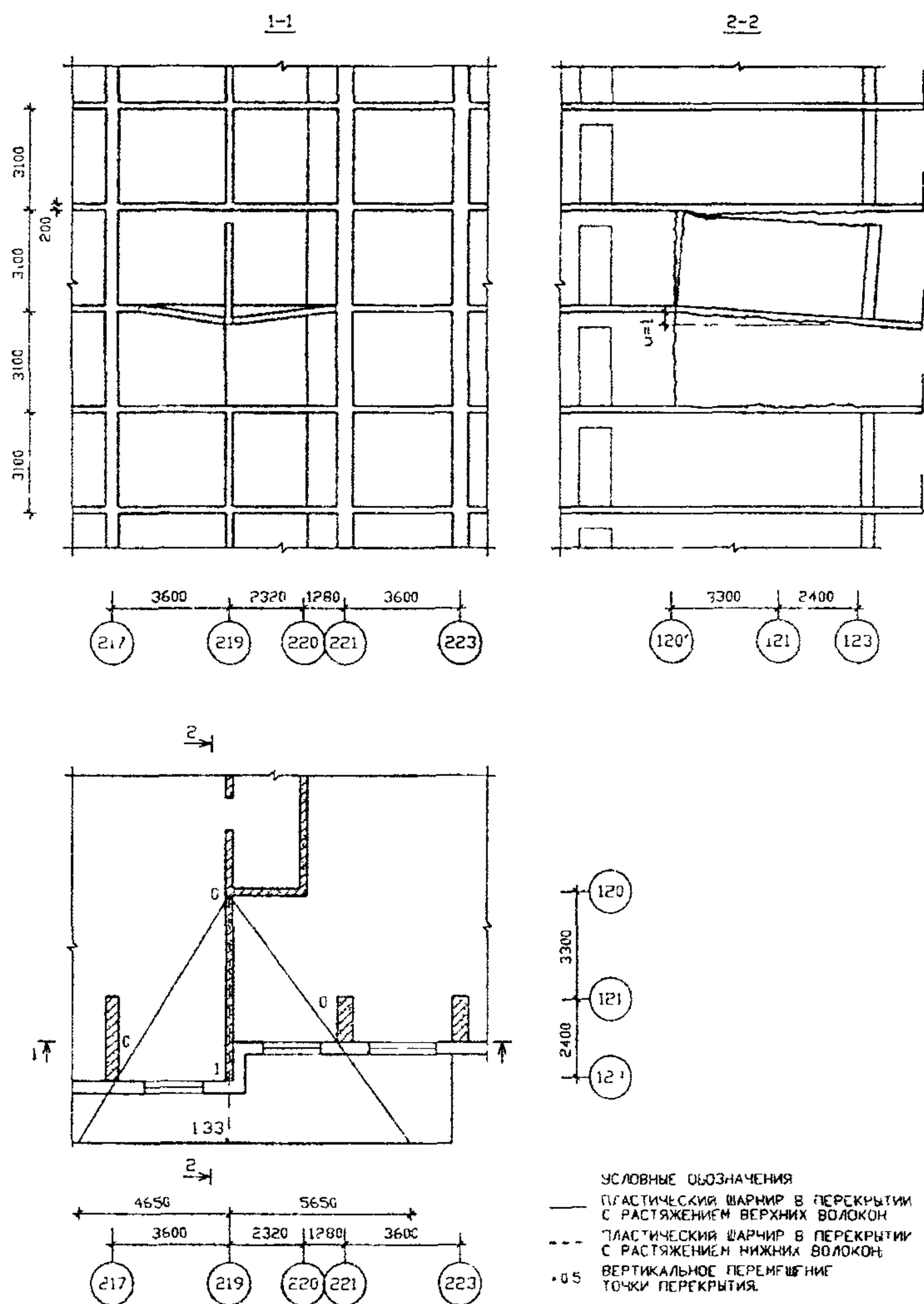
РИСУНОК АР13 СХЕМА 5 МЕХАНИЗМ ОБРУШЕНИЯ ЧЕТВЕРТОГО ТИПА
