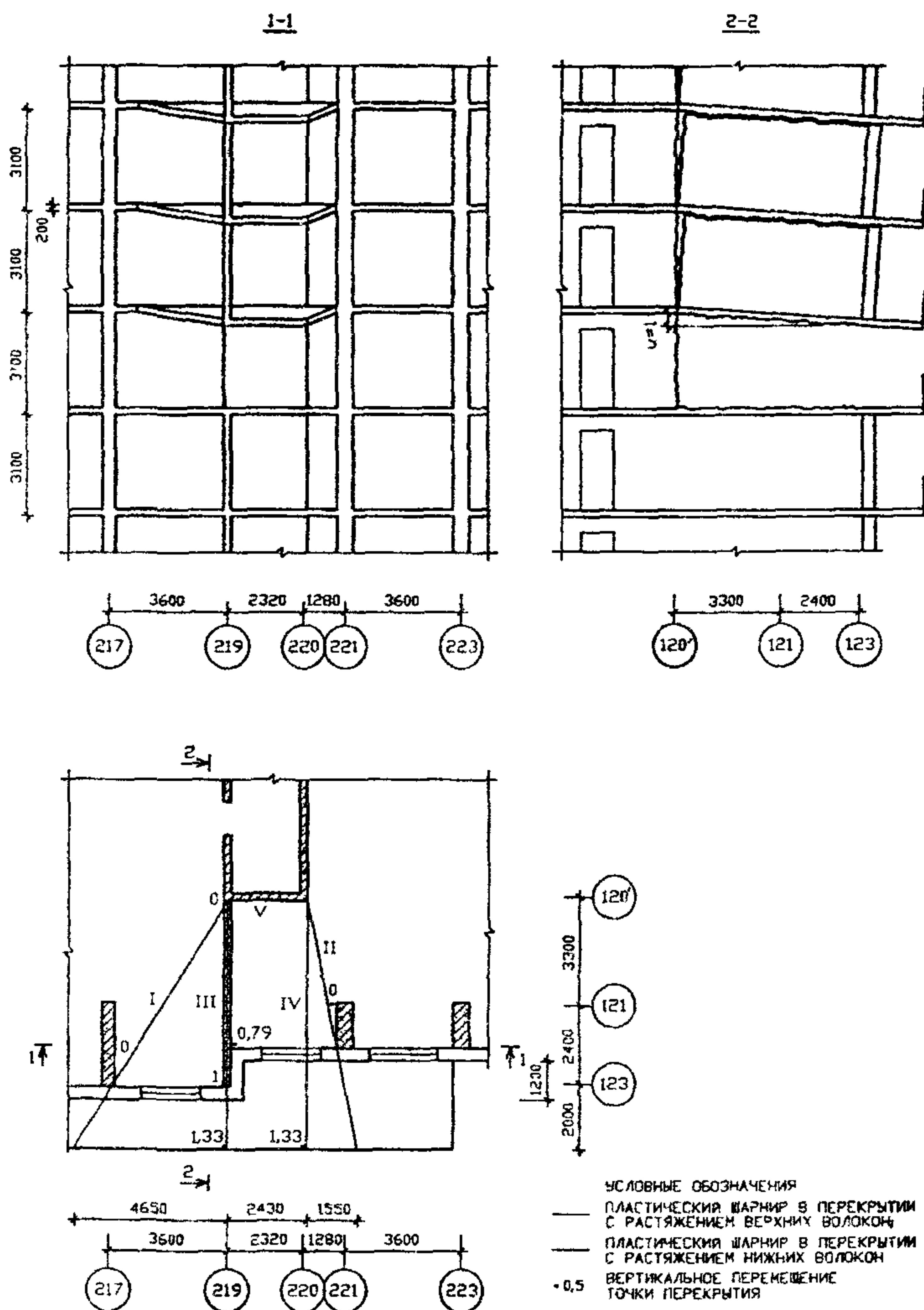
РИСУНОК А211 СХЕМА 5 МЕХАНИЗМ ОБРУШЕНИЯ ВТОРОГО ТИПА
