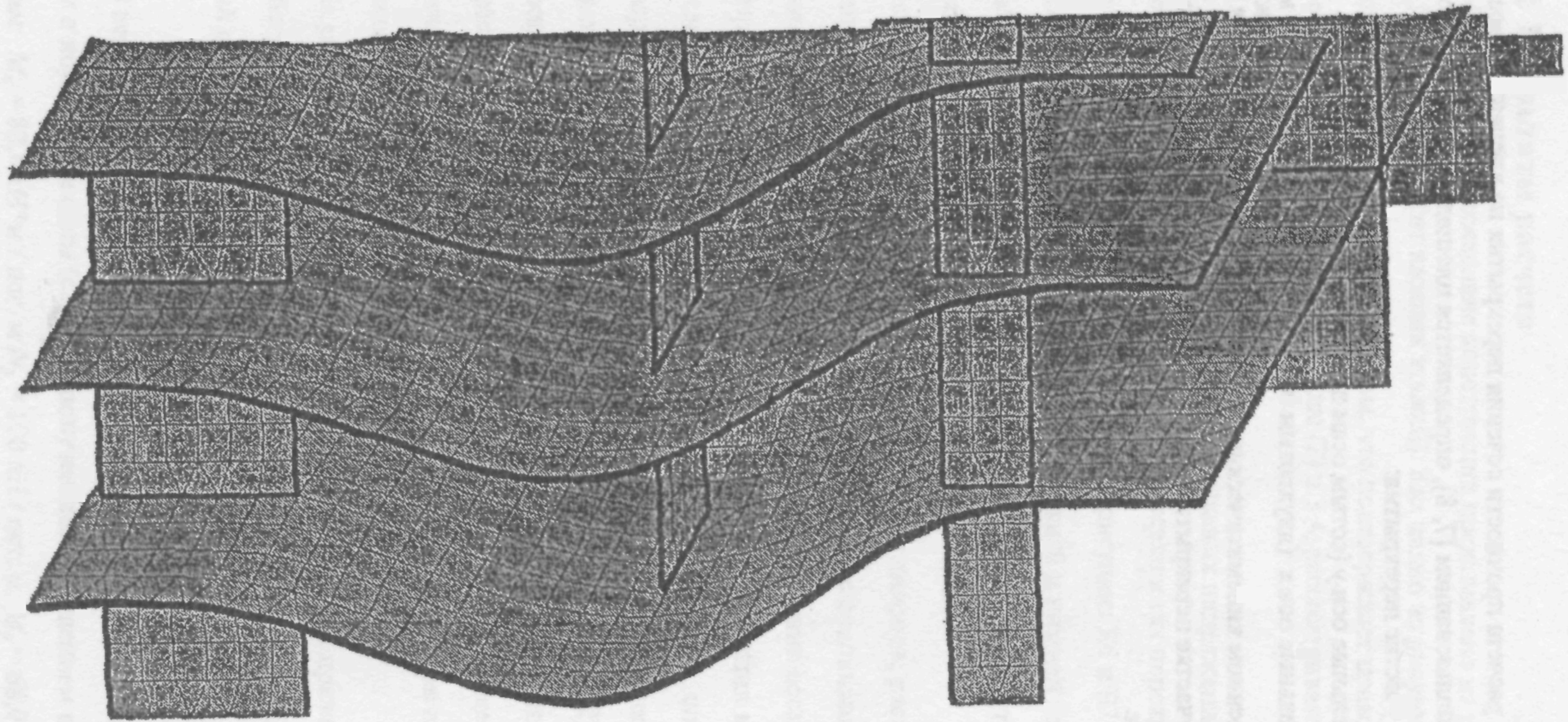
РИСУНОК 65. ДЕФОРМИРОВАННОЕ СОСТОЯНИЕ КОНСТРУКЦИЙ, ФРАГМЕНТ НИЖНИХ ЭТАЖЕЙ
