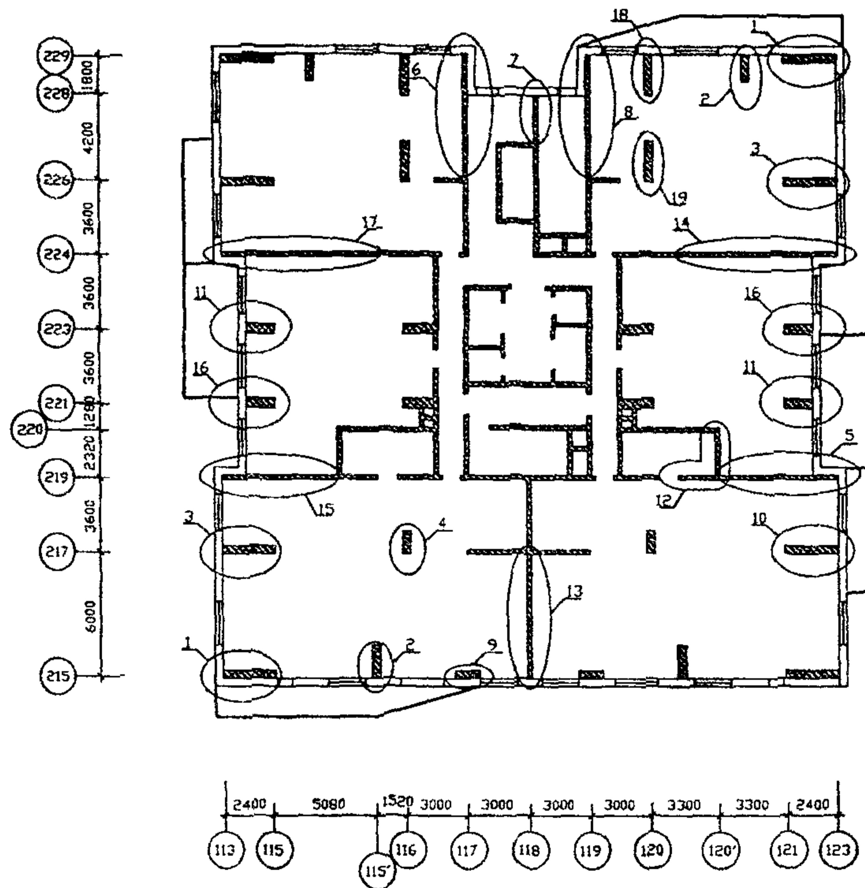
РИСУНОК А11 РАСЧЕТНЫЕ СХЕМЫ ЛОКАЛЬНОГО РАЗРУШЕНИЯ ТИПОВОГО ЭТАЖА
