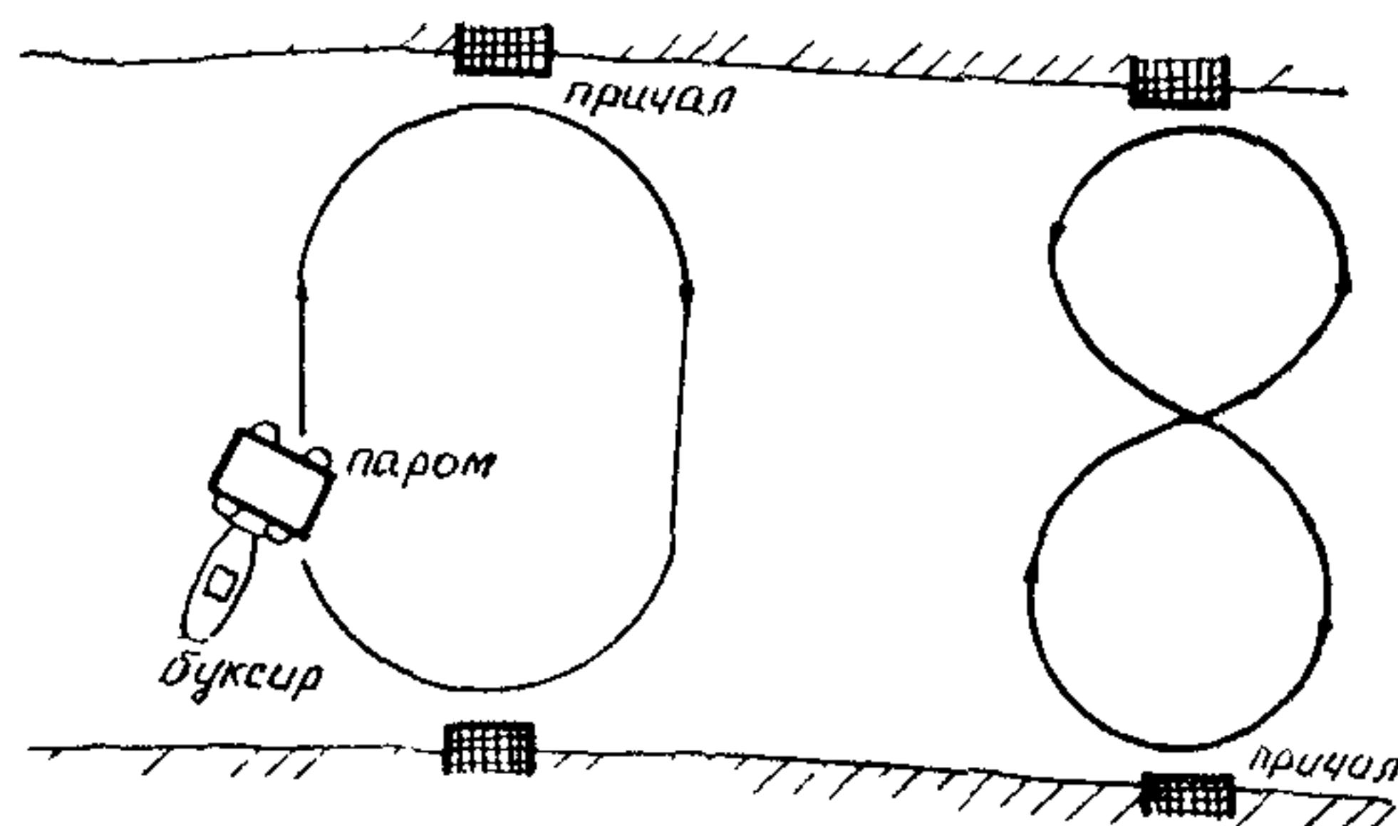
Рис. 2. Схема работы буксирного парома
