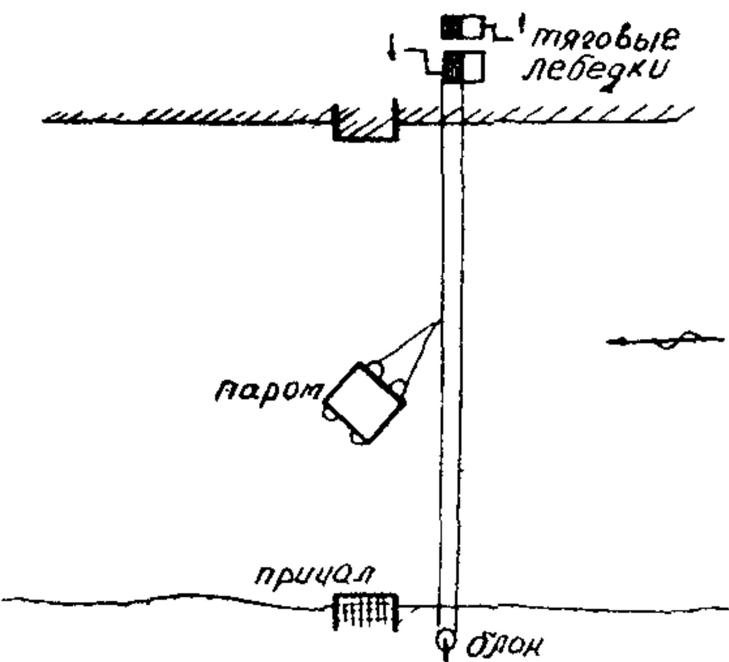
Рис. 1. Принципиальная схема канатной паромной переправы
