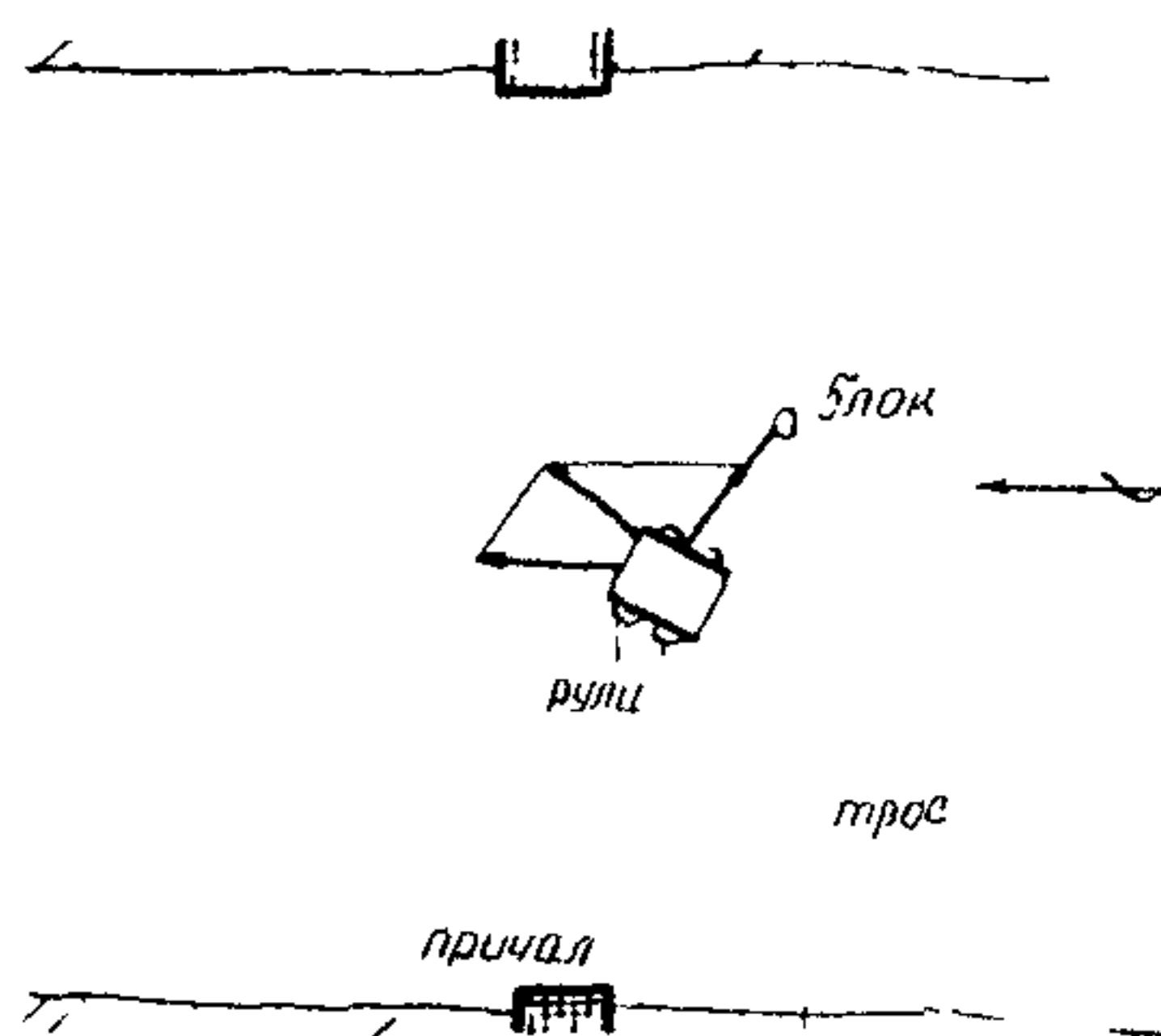
Рис. 3. Схема работы парома-самохода
