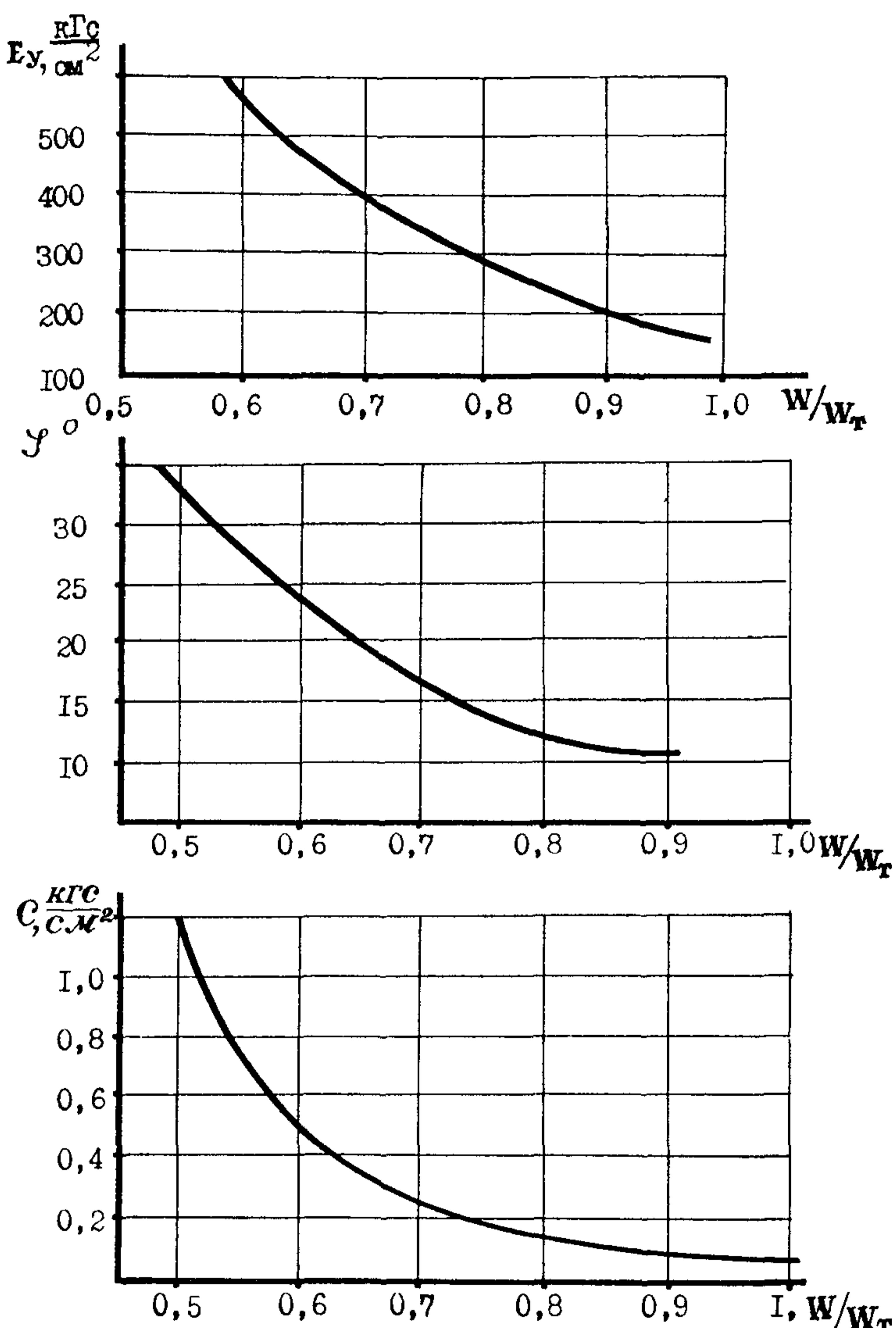
Рис. 3 Графики зависимостей модуля упругости ( $E_y$ ), коэффициента сцепления (С) и угла внутреннего трения ( $\phi$ ) суглинистых грунтов Юго-Востока Западной Сибири от относительной влажности
