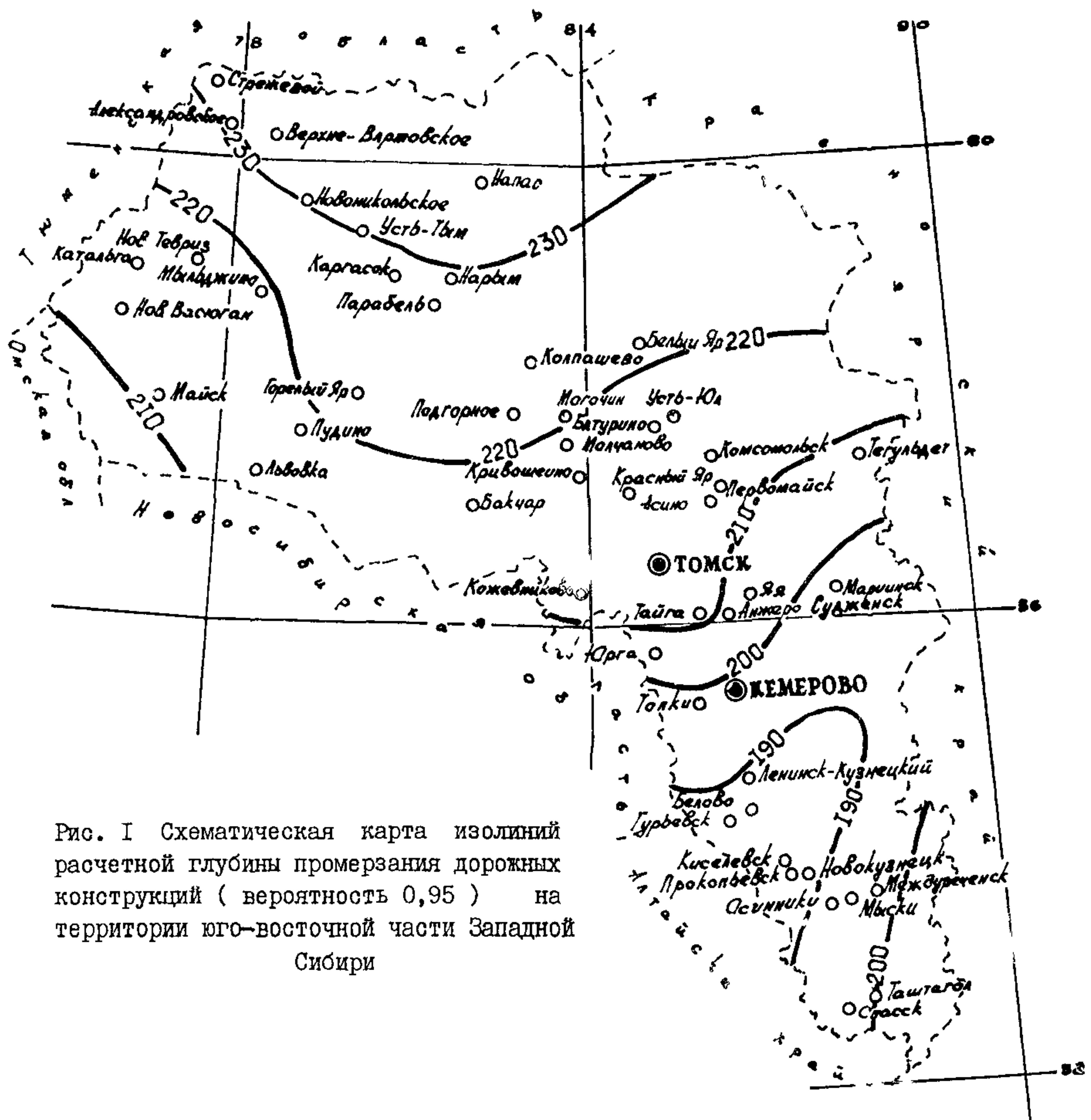
Рис. I Схематическая карта изолиний расчетной глубины промерзания дорожных конструкций ( вероятность 0,95 ) на территории юго-восточной части Западной Сибири
