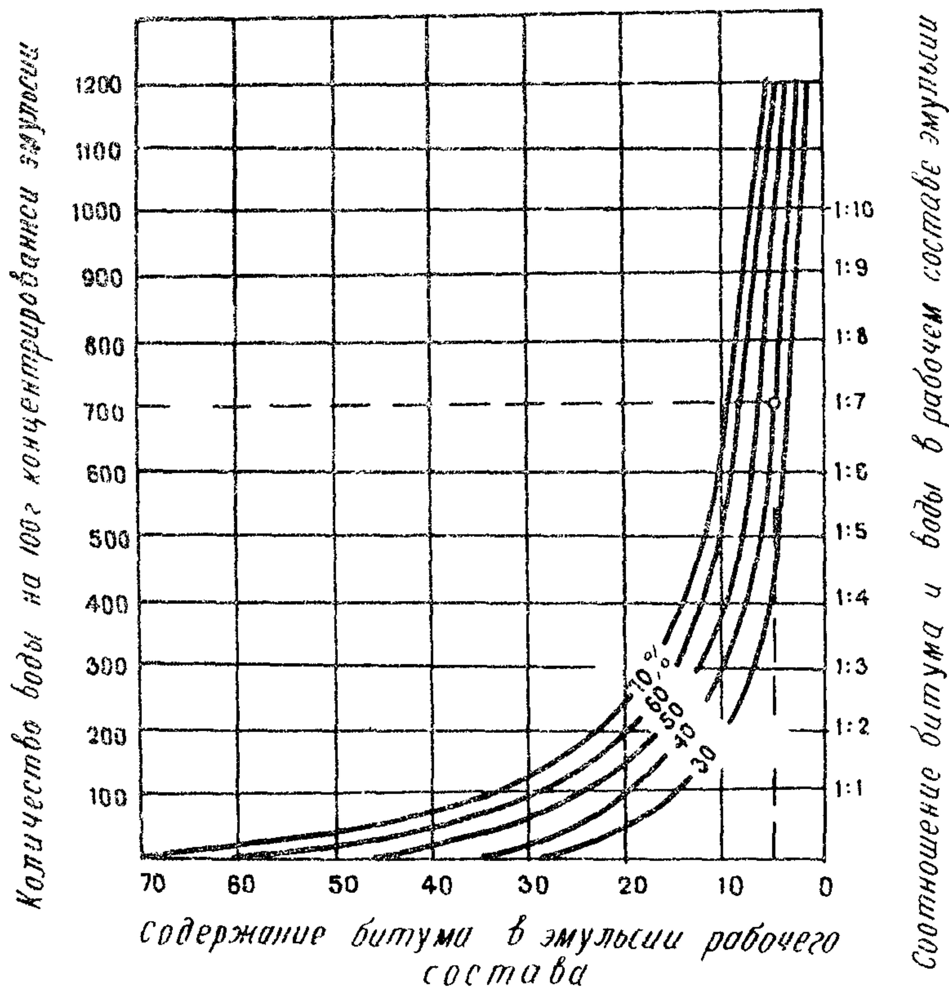
Рис.6. Номограмма для ускоренного подбора рабочего состава эмульсии
