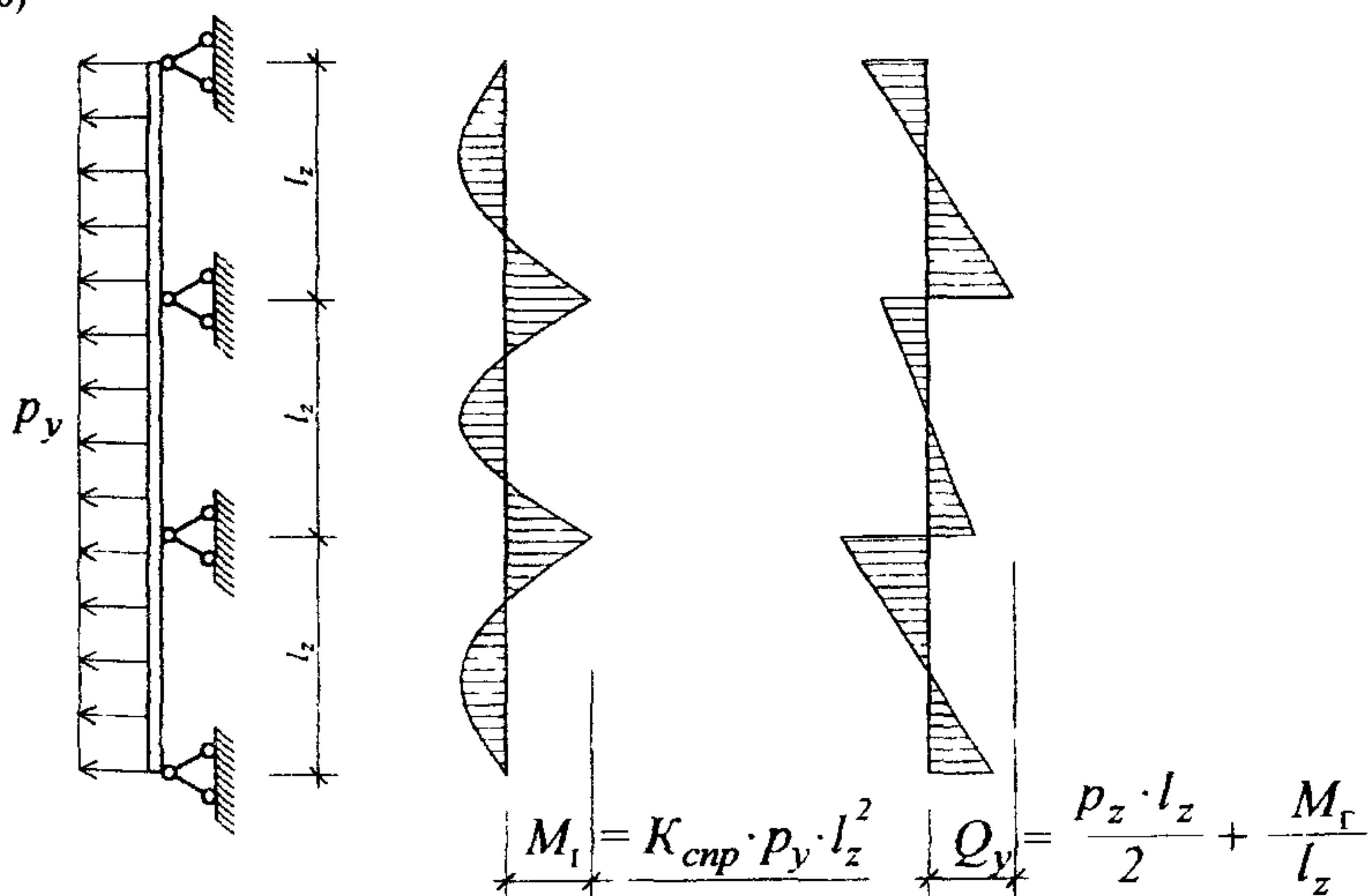
Рис. 6.2. Расчетные схемы вертикальной направляющей
