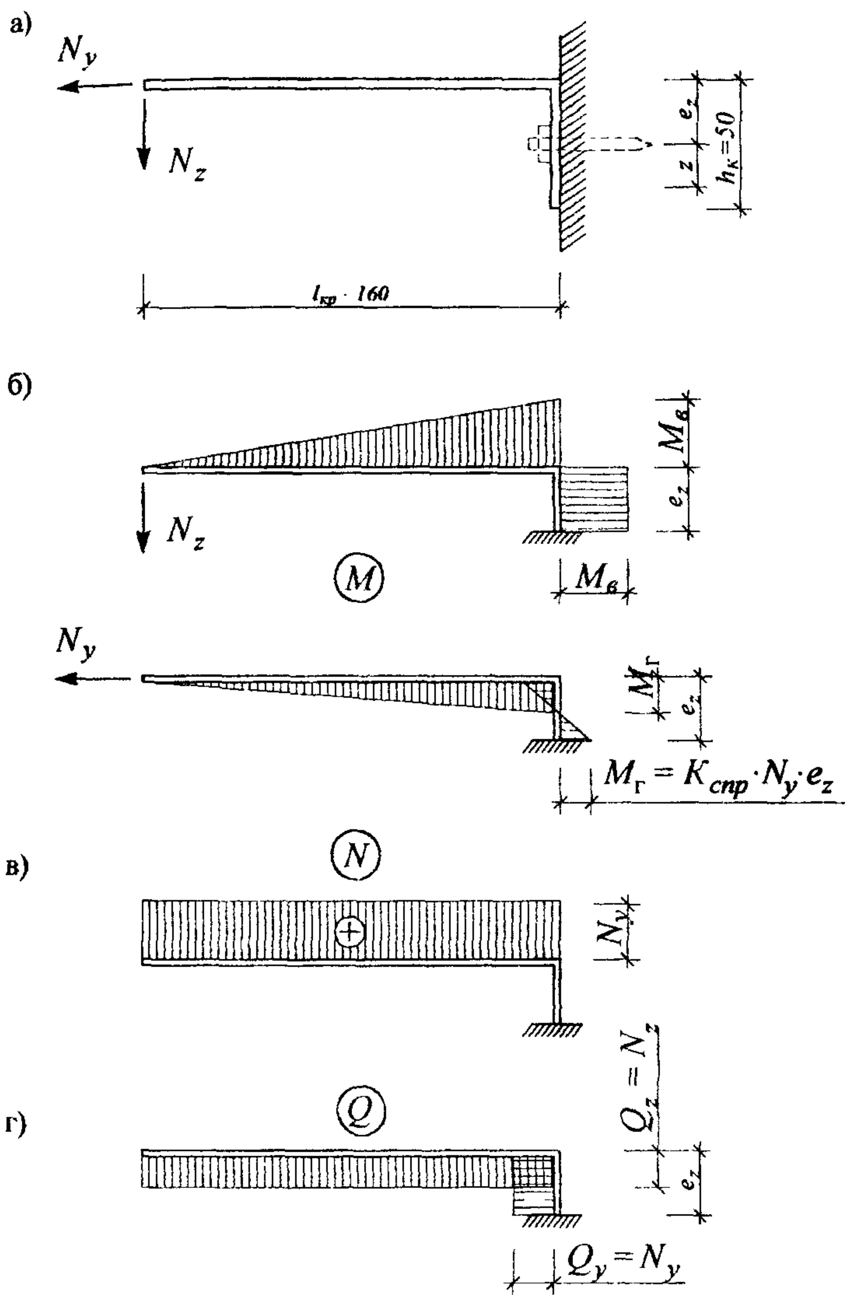
Рис. 6.4. Расчетная схема кронштейна.
