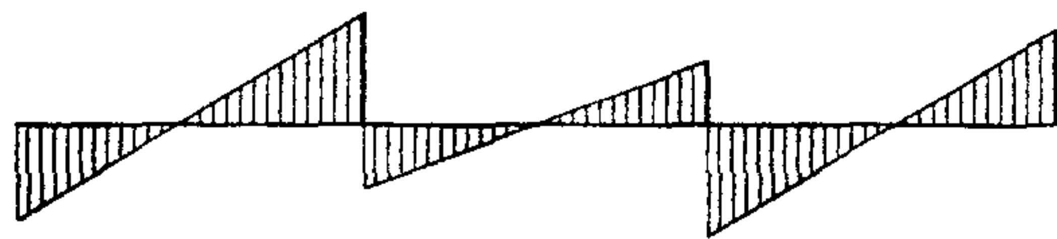
Рис. 6.1. Расчетная схема фиброцементной облицовки на действие горизонтальной ветровой нагрузки.
