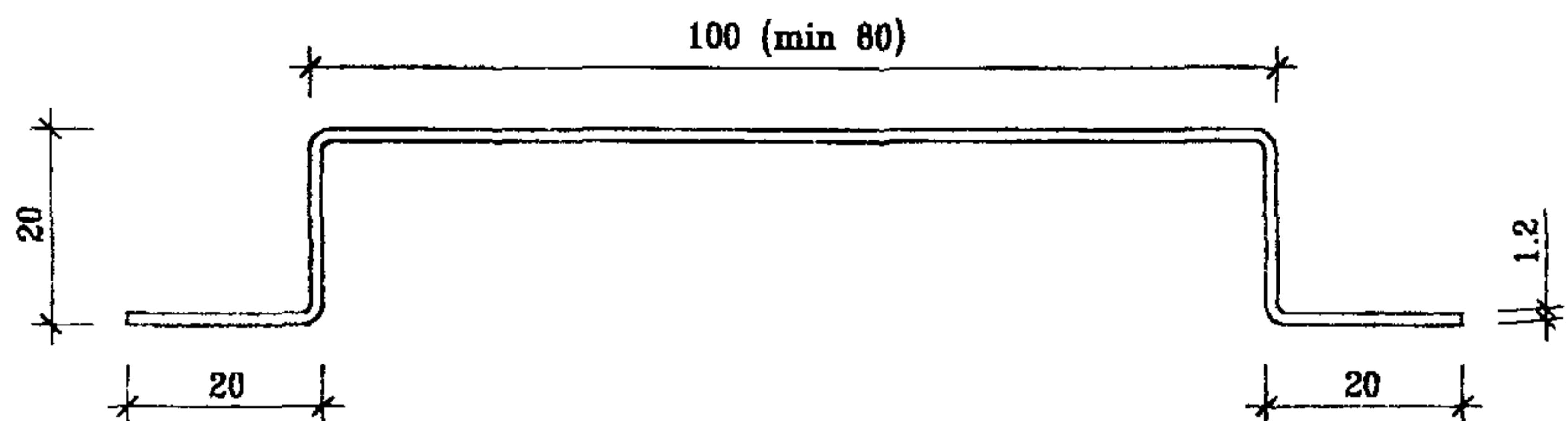
Рис. 3.4. Несущие вертикальные и горизонтальные профили (поперечное сечение).
