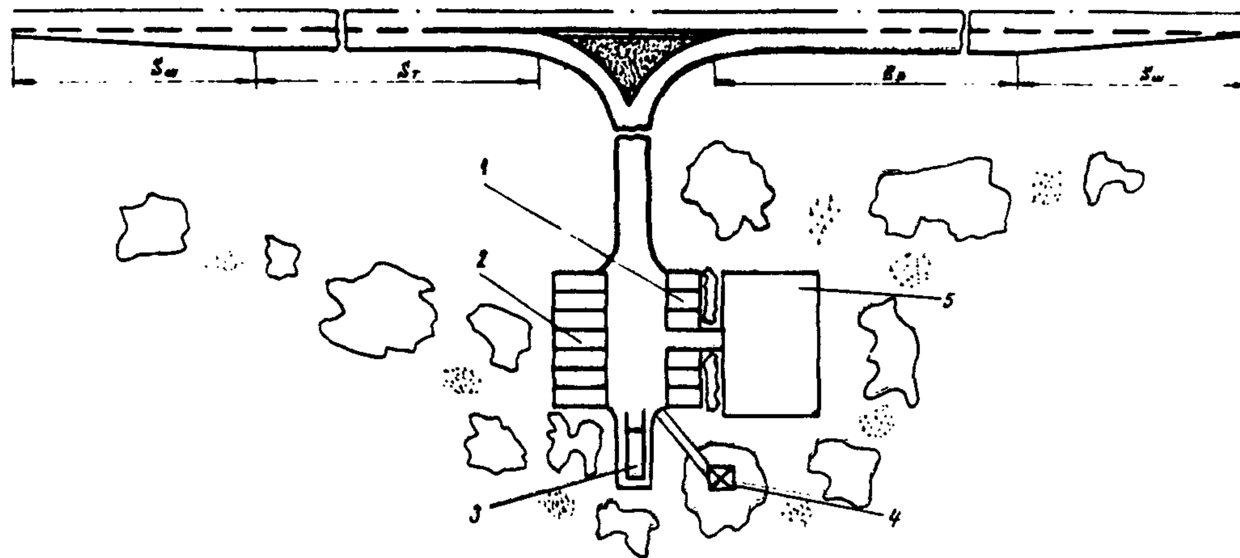
Рис.4. Схема площадки для стоянок автомобилей у магазинов, столбовых и т.п.: 1—грузовые автомобили; 2—легковые; 3—смотровая эстакада; 4—туалет; 5—кафе
