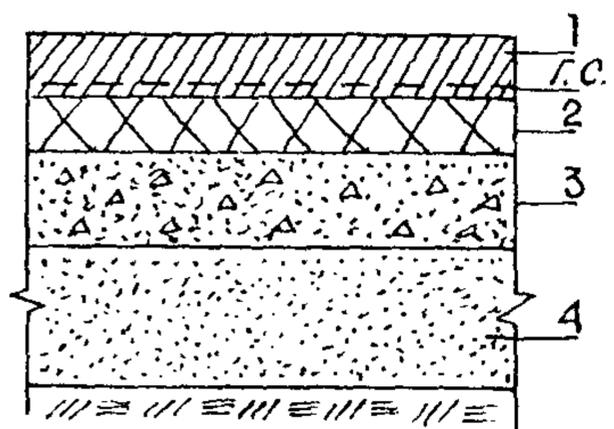
в) геосетка располагается под верхним слоем асфальтобетонного покрытия укладывается по нижнему слою покрытия
