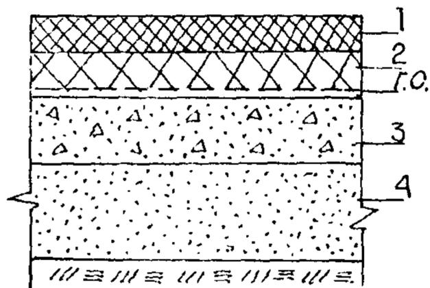
б) геосетка располагается под двухслойным асфальтобетонным покрытием, укладывается по бетонному основанию
