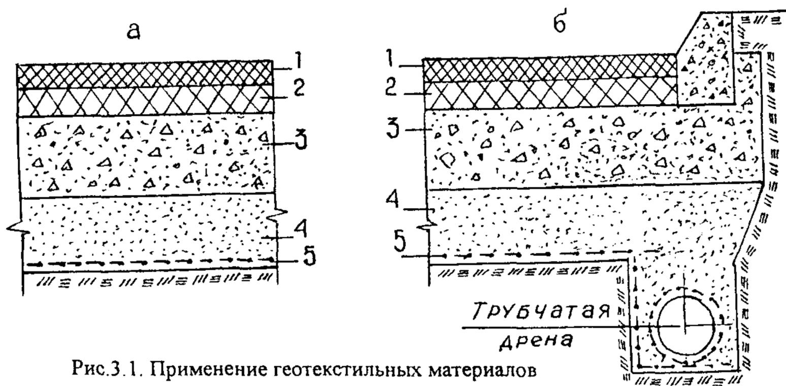
Рис.3.1. Применение геотекстильных материалов в качестве дренирующей прослойки:
