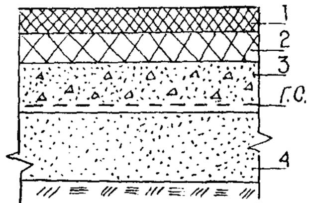
а) геосетка располагается под жестким основанием, укладывается по подготовленному песчаному подстилающему слою
