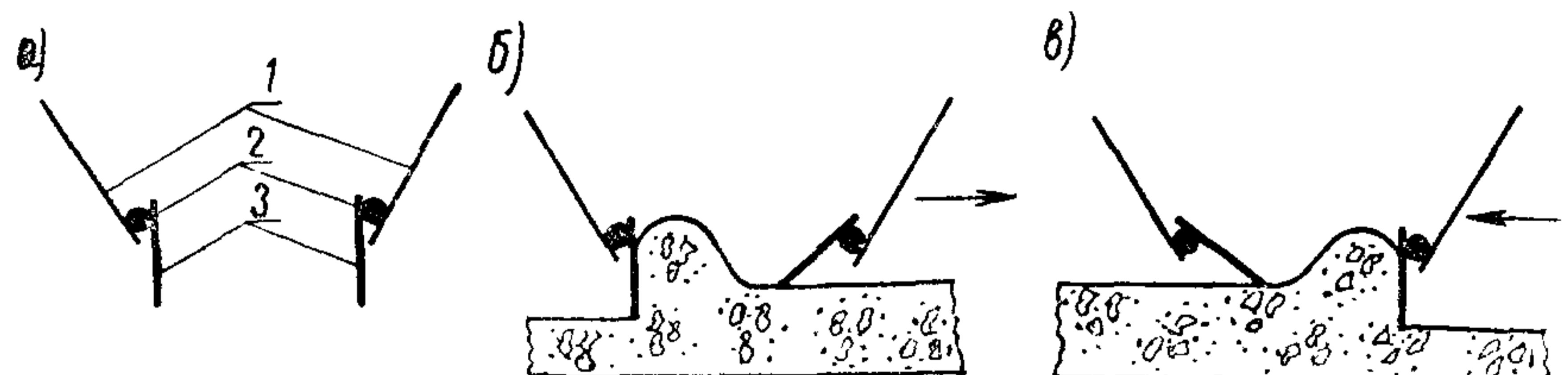
Рис. 8. Схема работы откидных щитков при разравнивании бетона, выгруженного на основание, модернизированным распределителем ДС-503А (Д-375):
