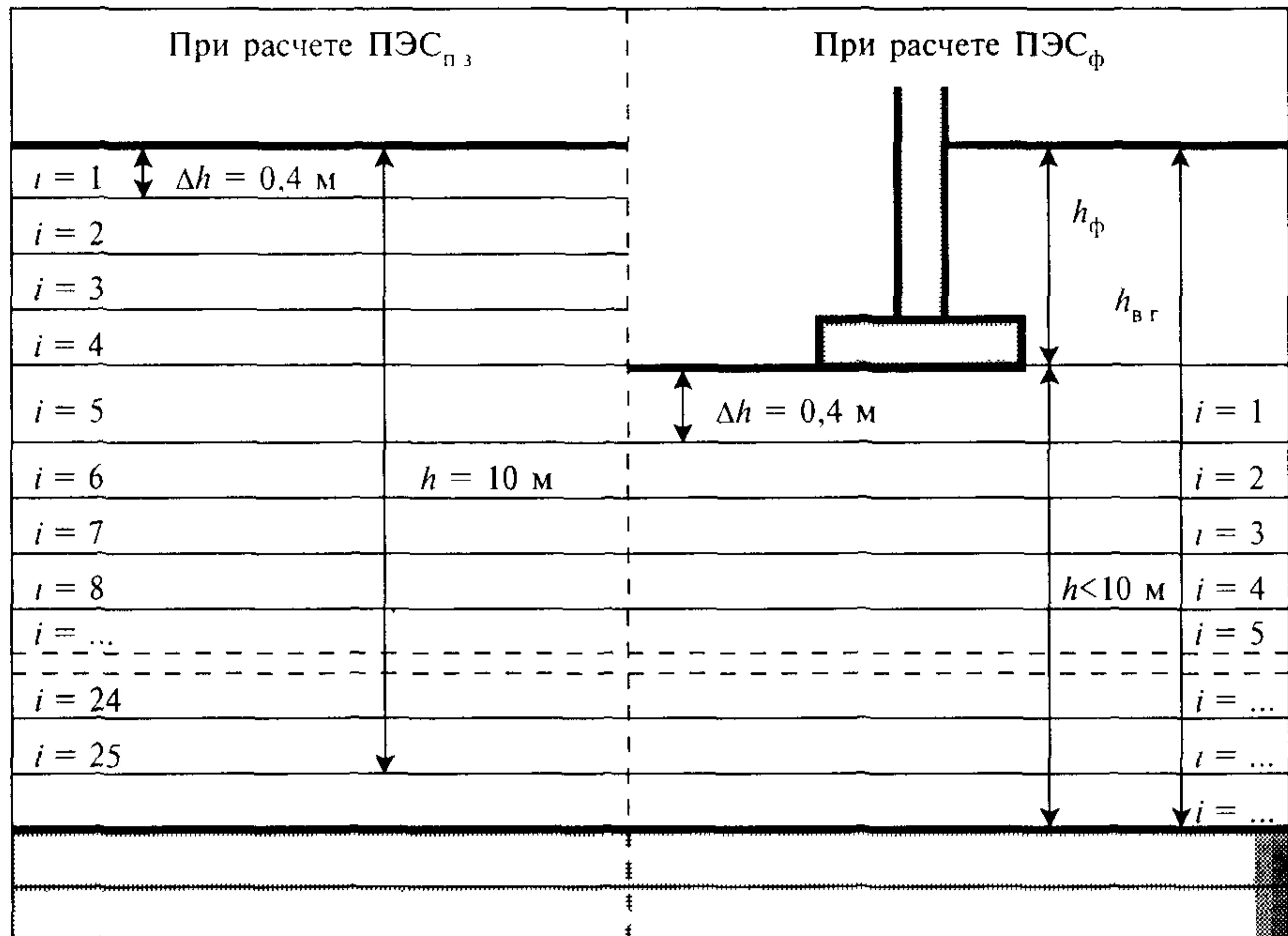
**Рисунок А.1 — Определение расстояний для расчета ПЭС**
