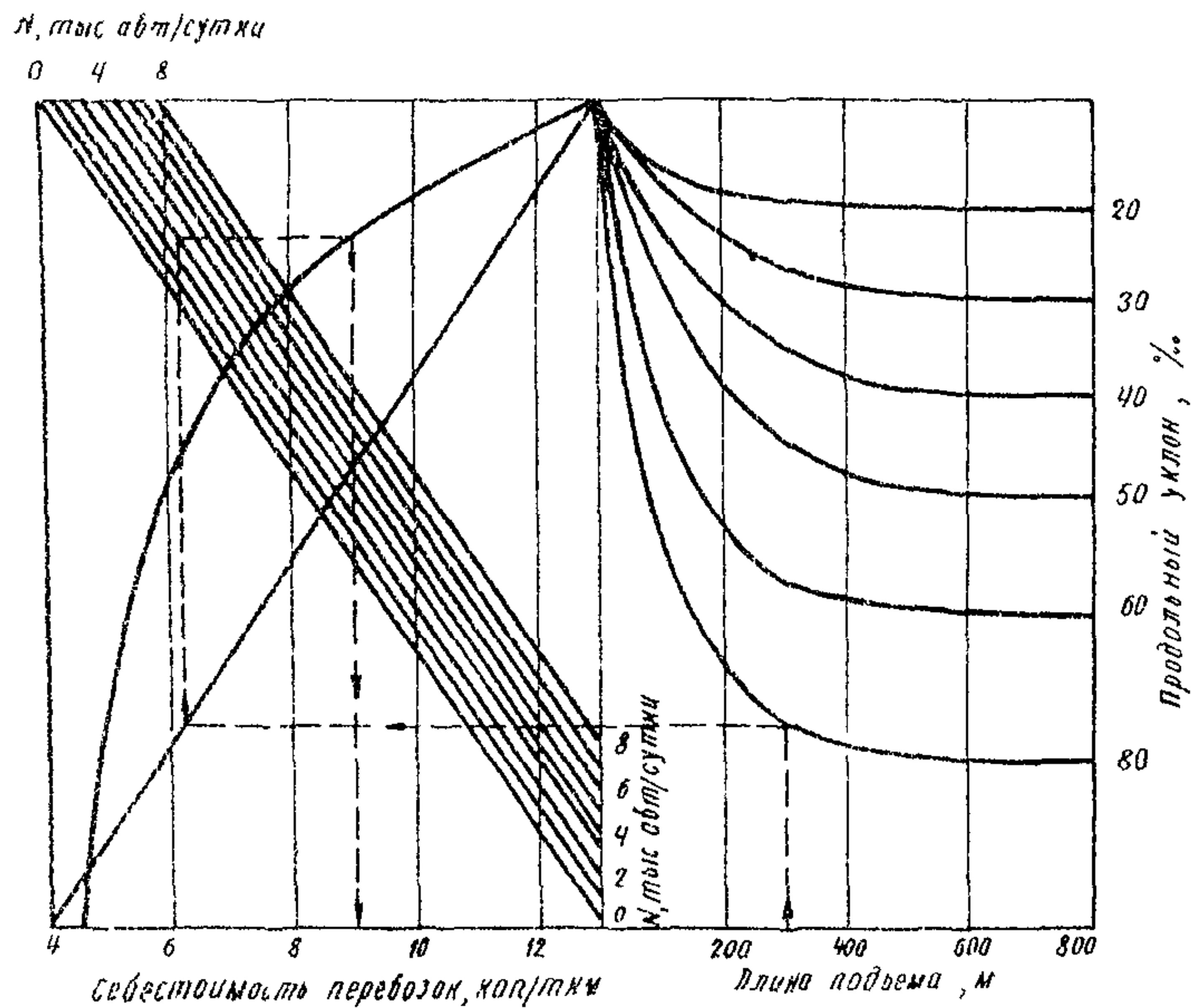
Рис.1. Номограмма для определения себестоимости перевозок на подъемах
