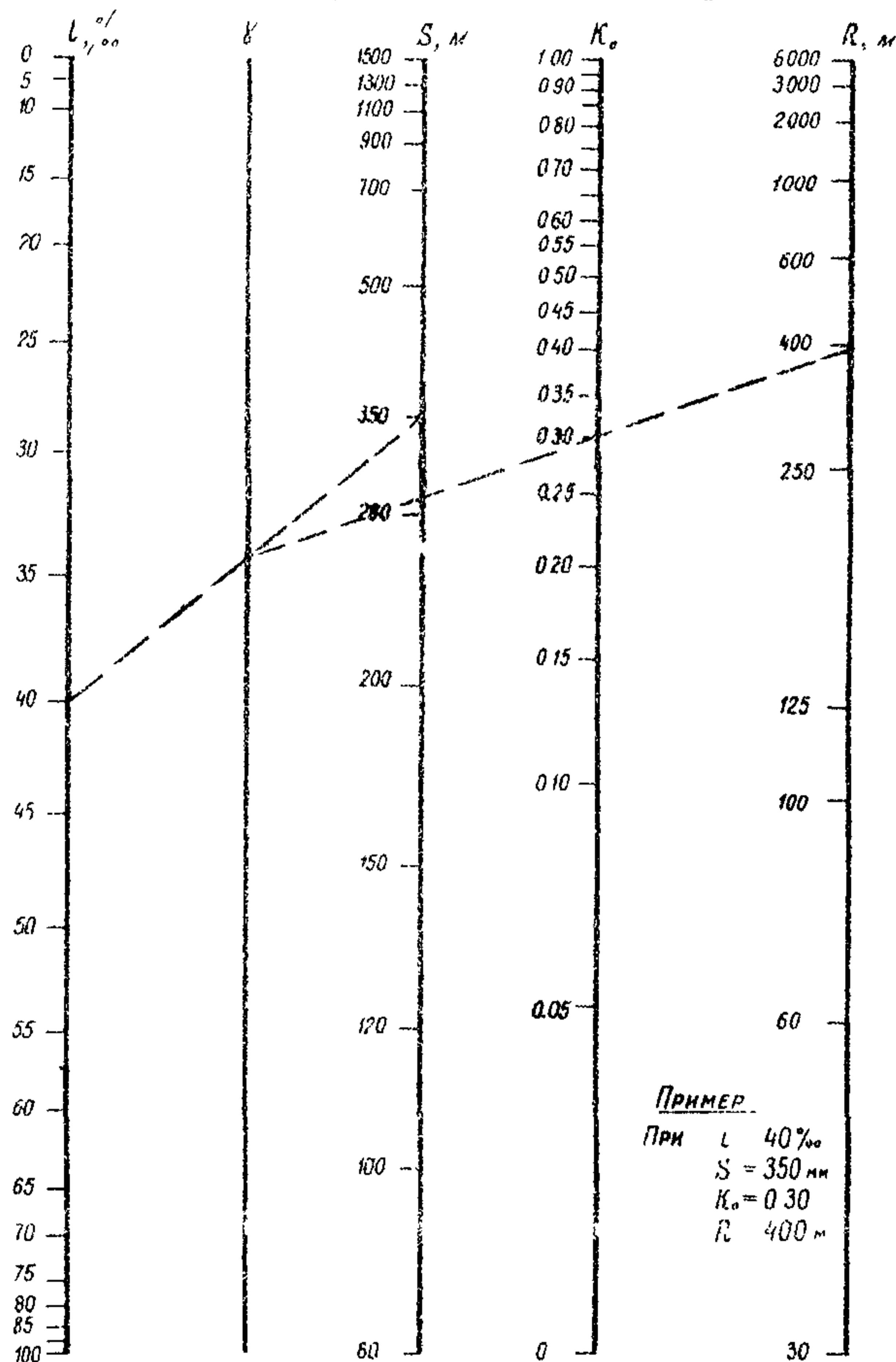
Рис.3. Номограмма для выбора продольного уклона  $i$  или радиуса кривой в плане  $R$  с учетом коэффициентов относительной безопасности движения  $K_o$  ( $S$  -расстояние видимости, м;  $v$  -коэффициент)
