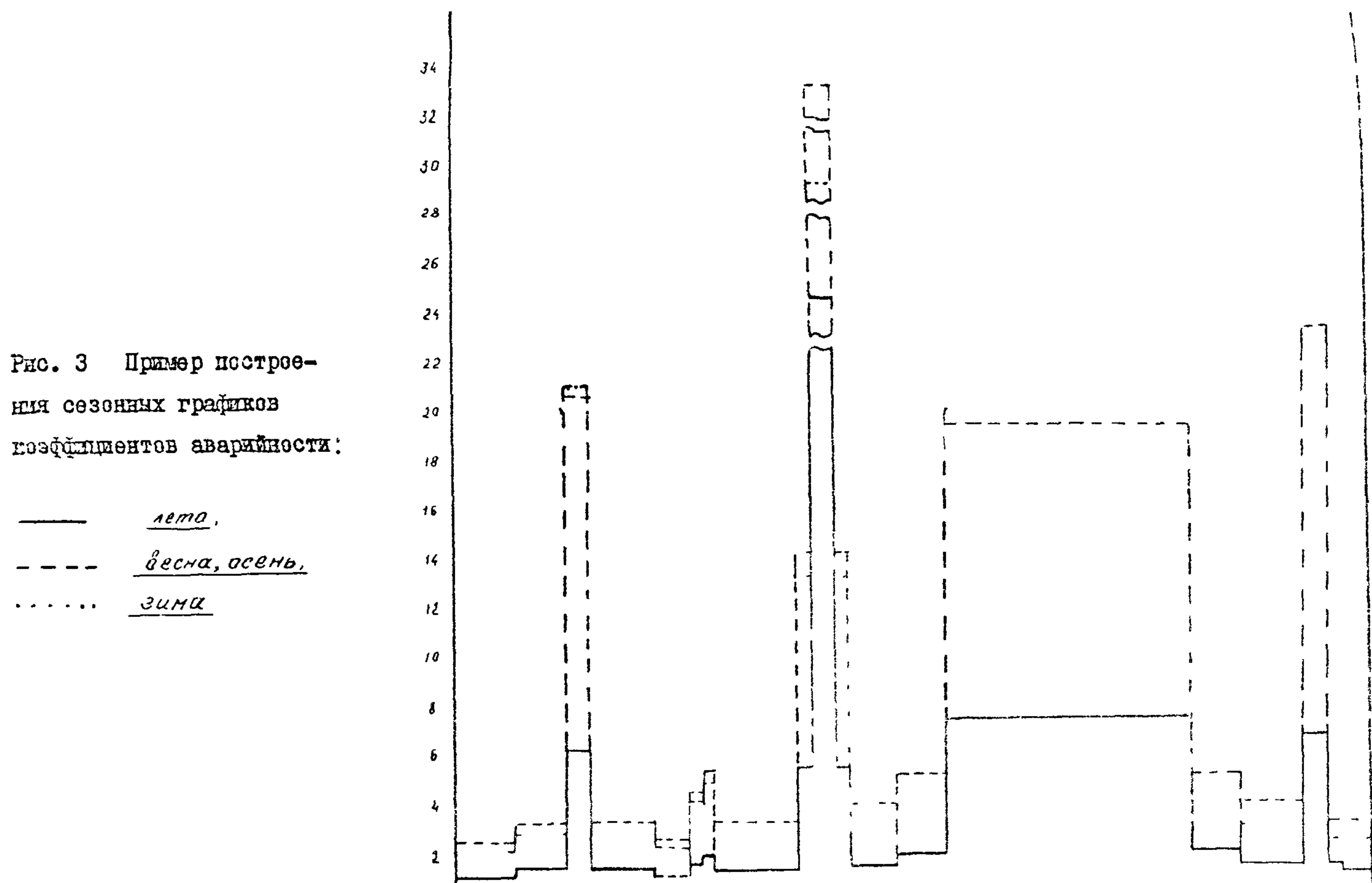
2. С учетом зон различия дорожных условий определяются величины частных коэффициентов аварийности для каждой дорожной ситуации и записываются в соответствующие строки формы графиков коэффициентов аварийности.
