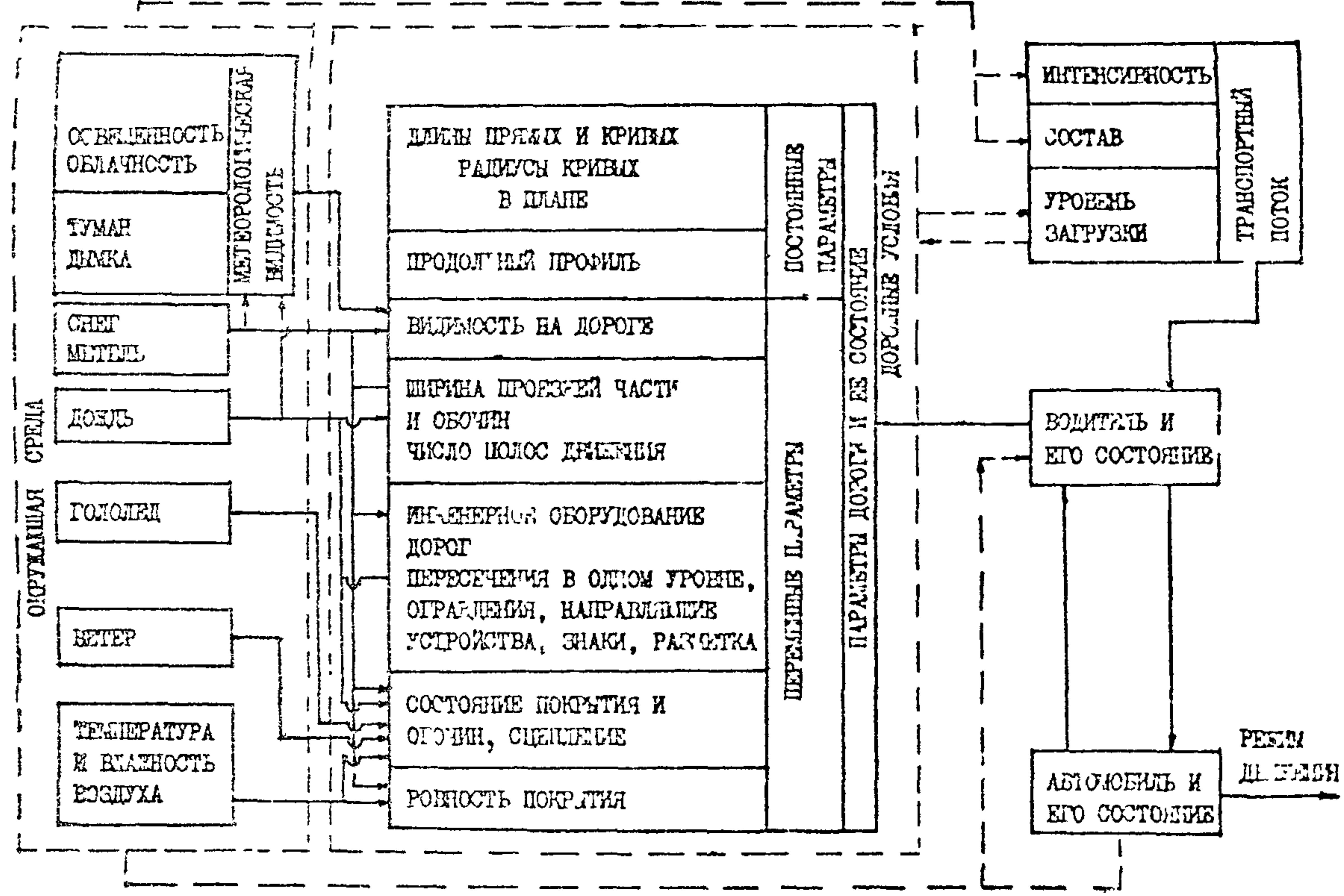
Рис. 1 Схема взаимодействия комплекса "автомобиль-водитель-дорога-среда"
