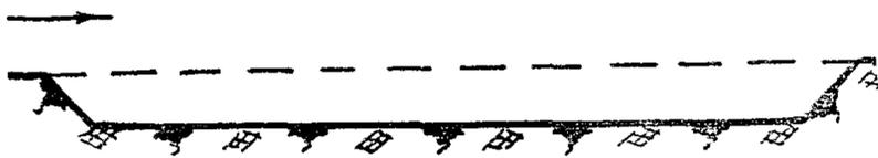
Рис 3 Прямоугольная схема зарезания грунта
