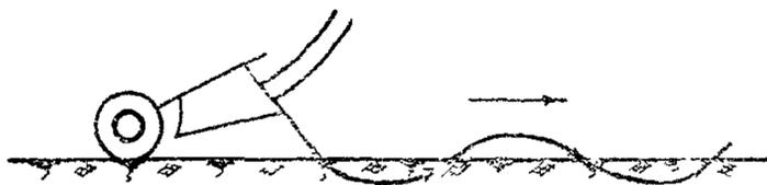
Рис 4 Схема зарезания грунта «клевками»
