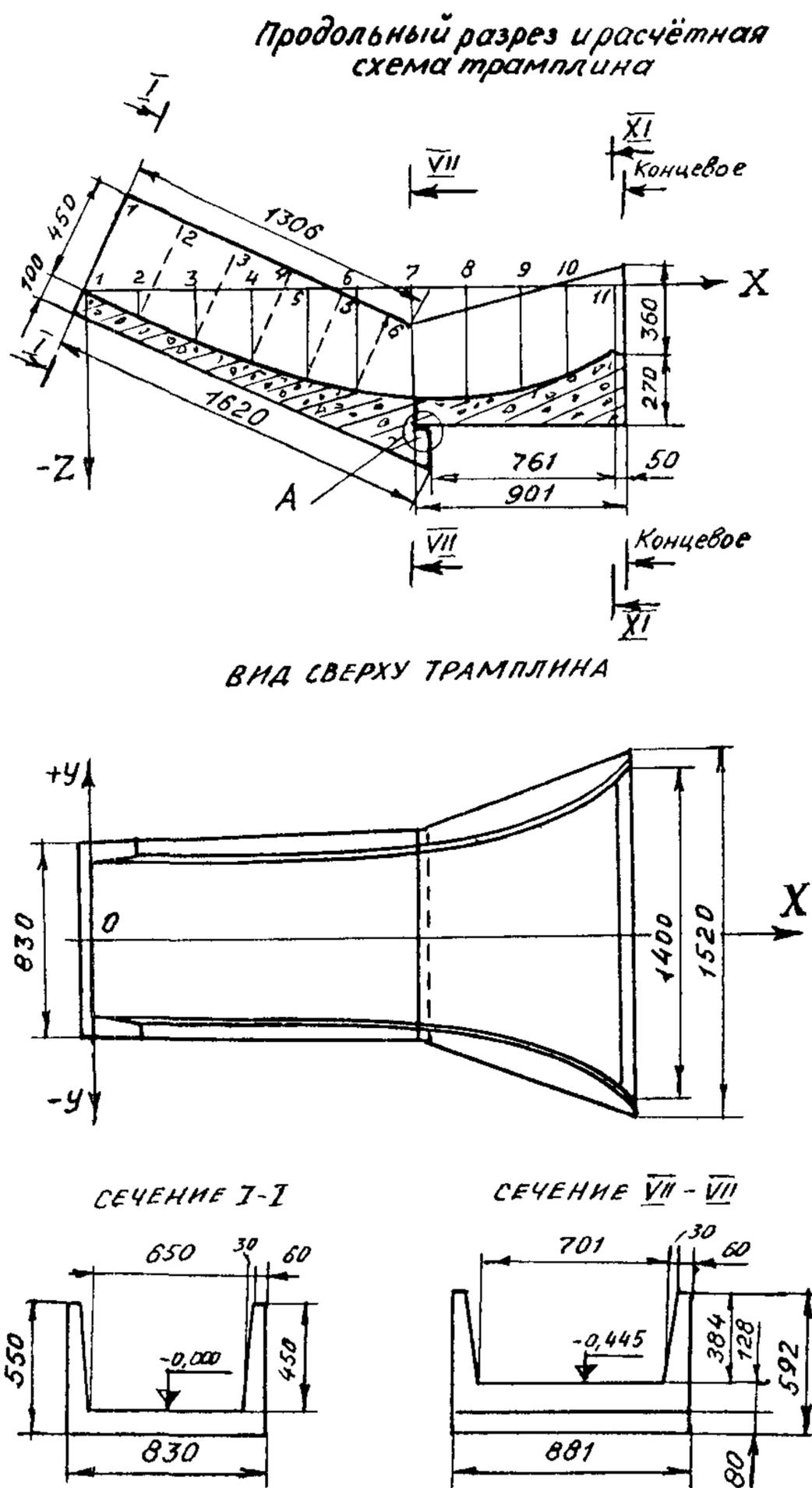
Рис. 3. Конструкция рассеивающего трамплина цилиндрической формы ( типоразмер I)
