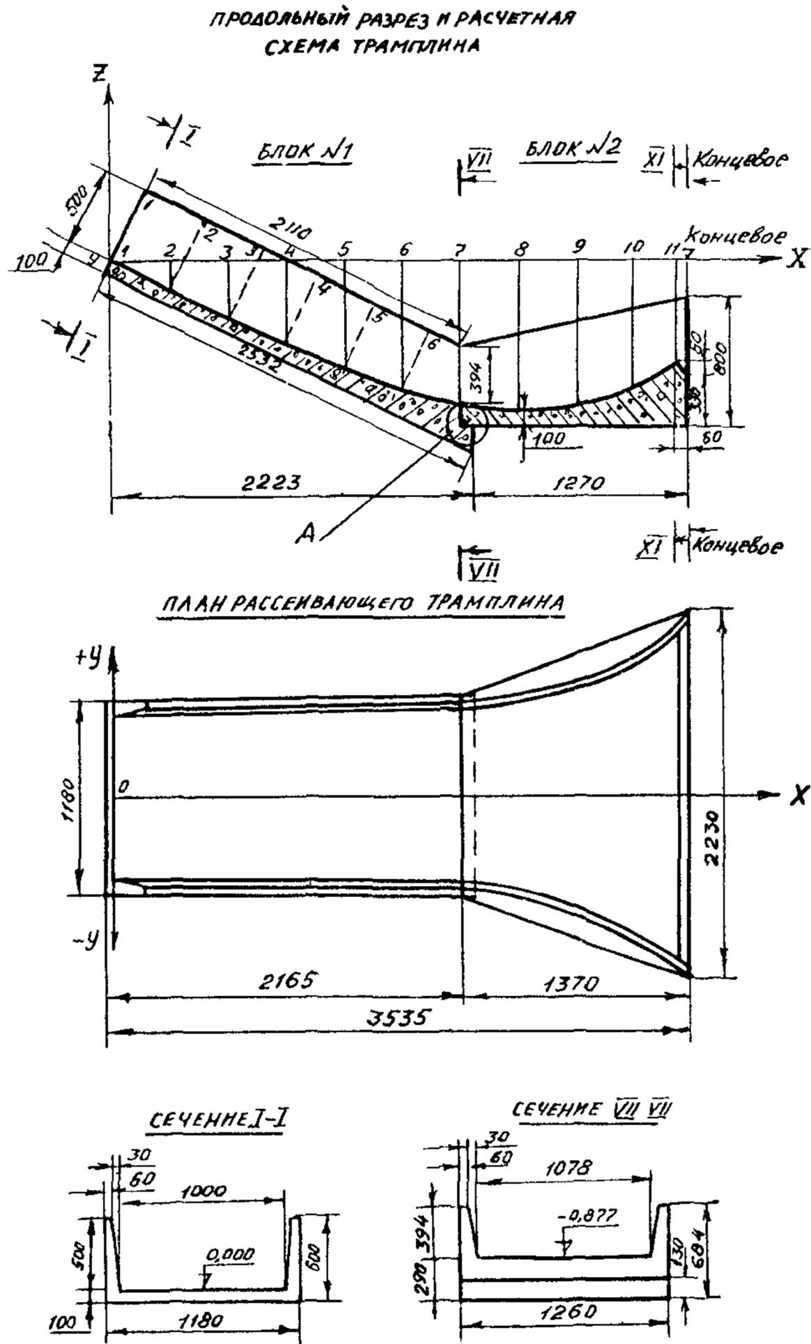
Рис. 4. Конструкция рассеивающего трамплина цилиндрической формы (типоразмер П)
