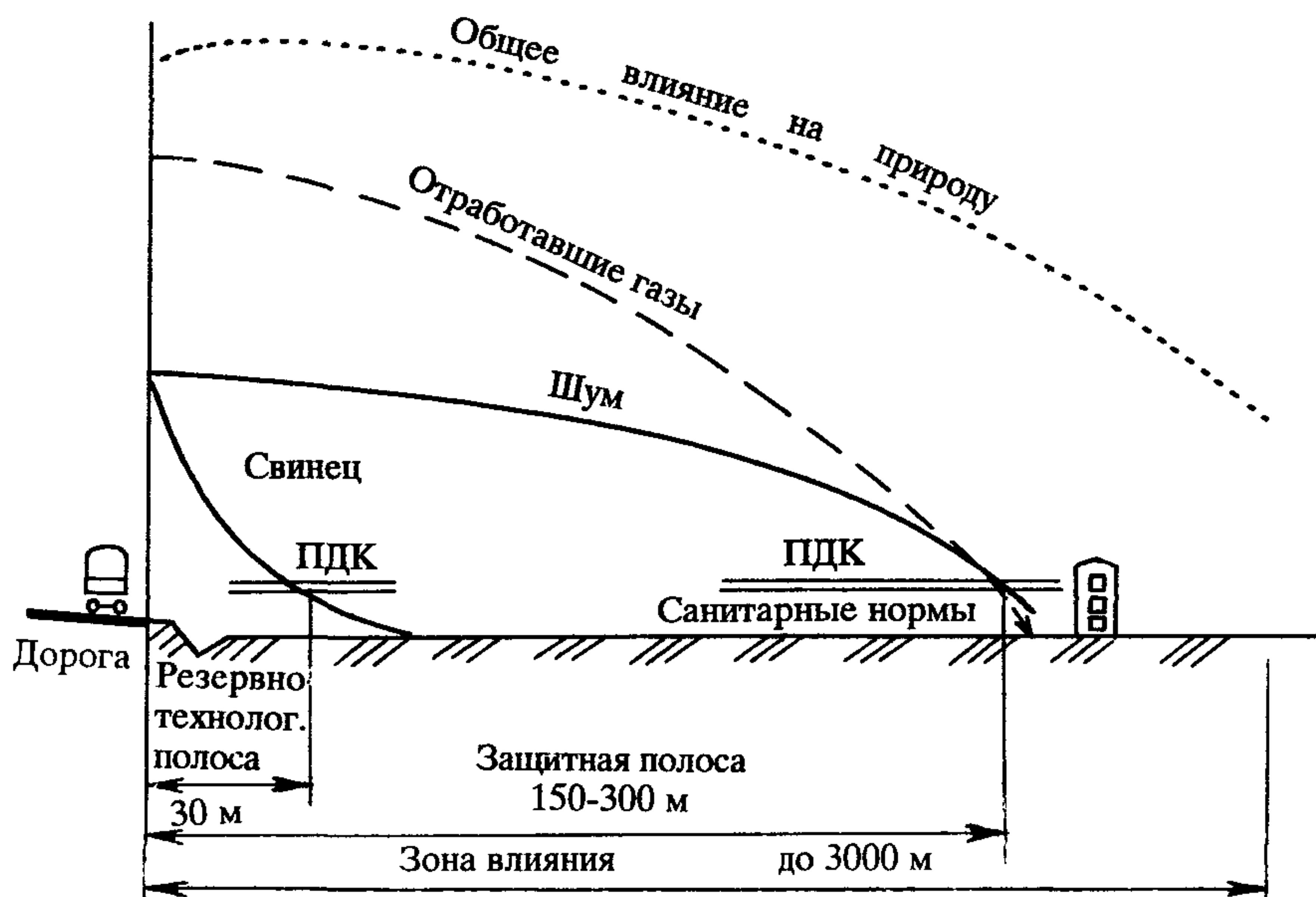
Рис. 2. Распространение автомобильно-дорожных воздействий на придорожной территории
