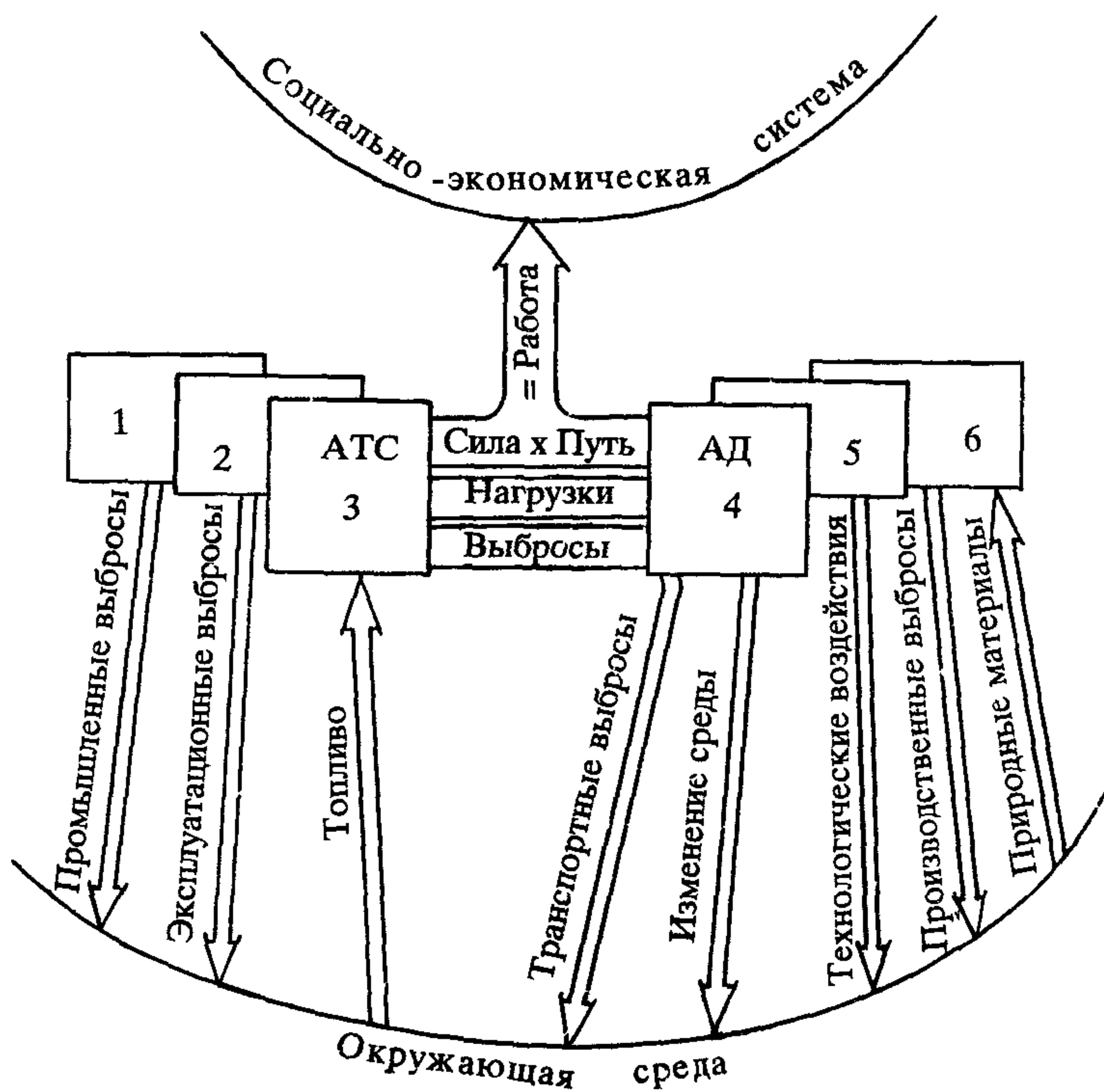
Рис. 1. Взаимодействие автомобильно-дорожного комплекса с окружающей средой:
