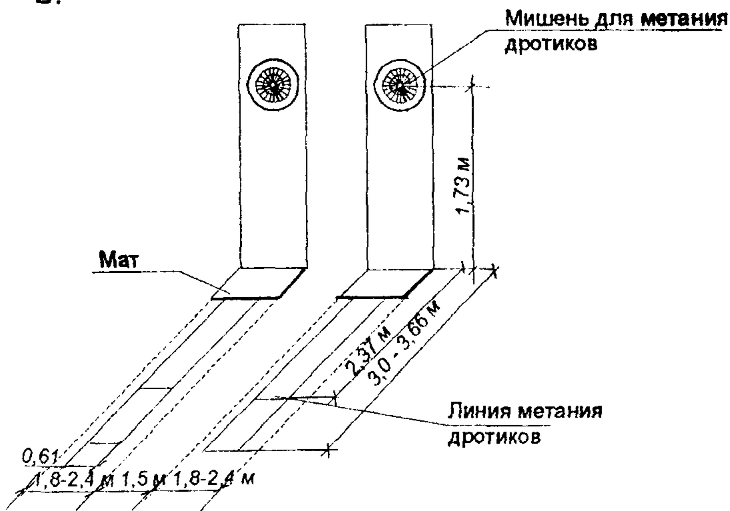
Рис. 10. Размещение оборудования в зале дартса. А. Схема размещения дорожек для метания дартса и мест для зрителей. Б. Разметка дорожек для метания дротиков.
