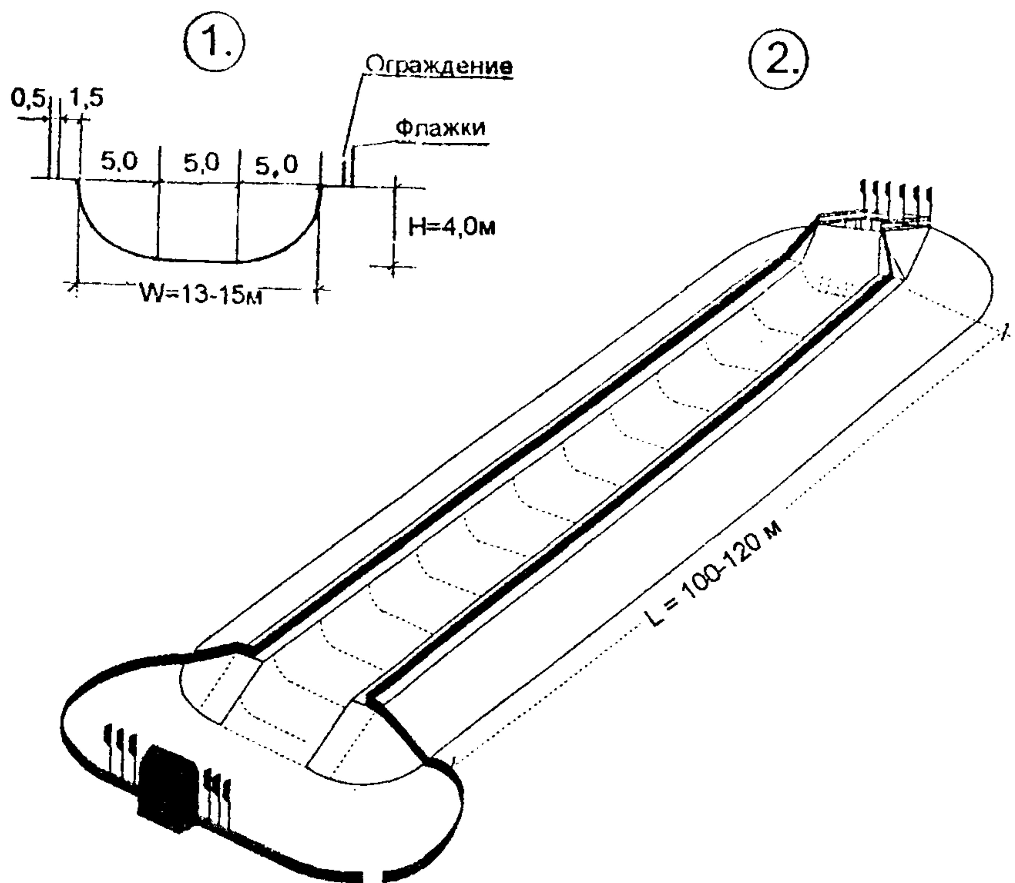
Рис.11. Схема трассы сноуборда "хальфпайп" (полутруба).
