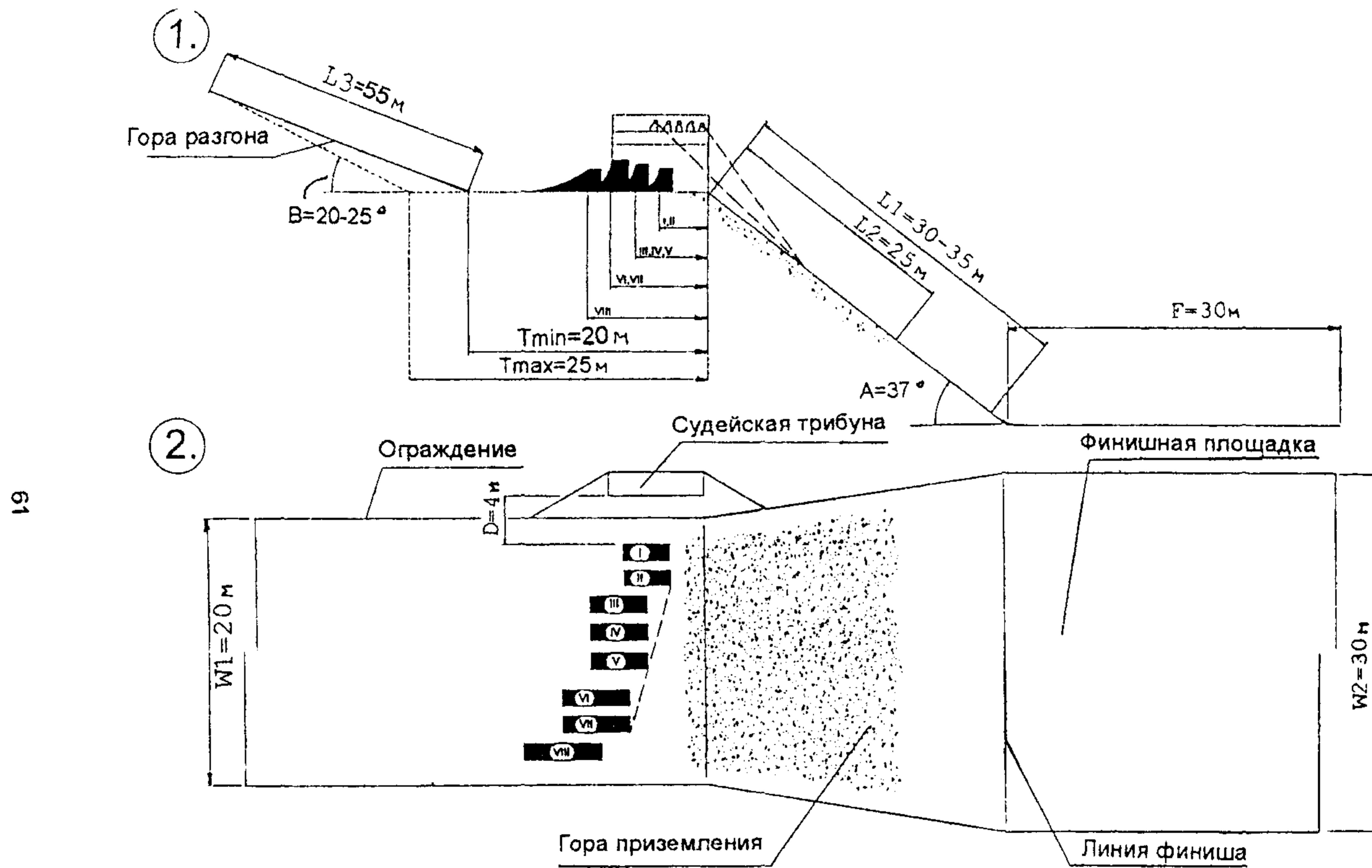
Рис.12. Схема трассы лыжной акробатики. 1. Профиль трассы. 2. План трассы.
