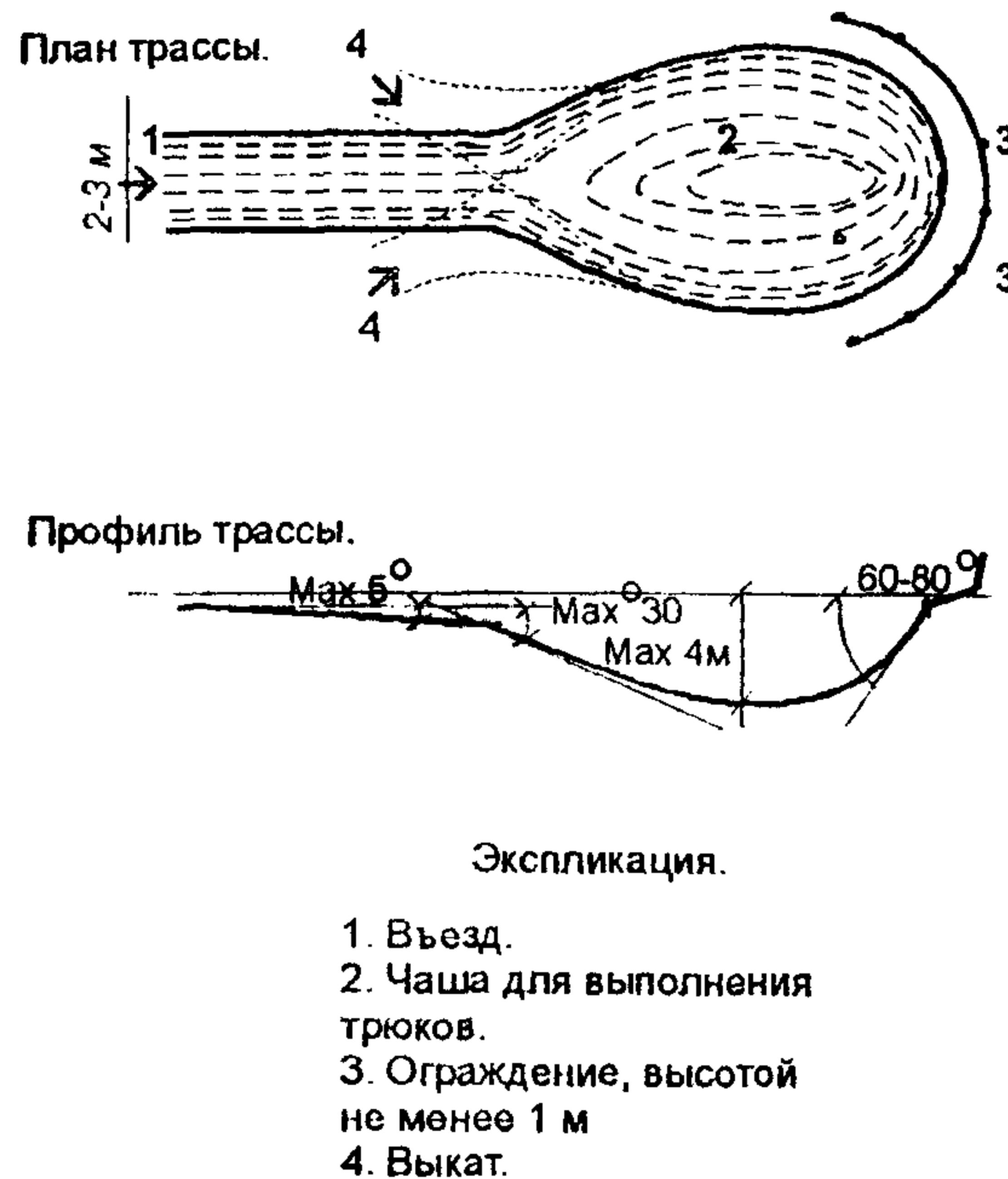
Рис.19. Схемы сооружений для роллерспорта и скейтбординга.
