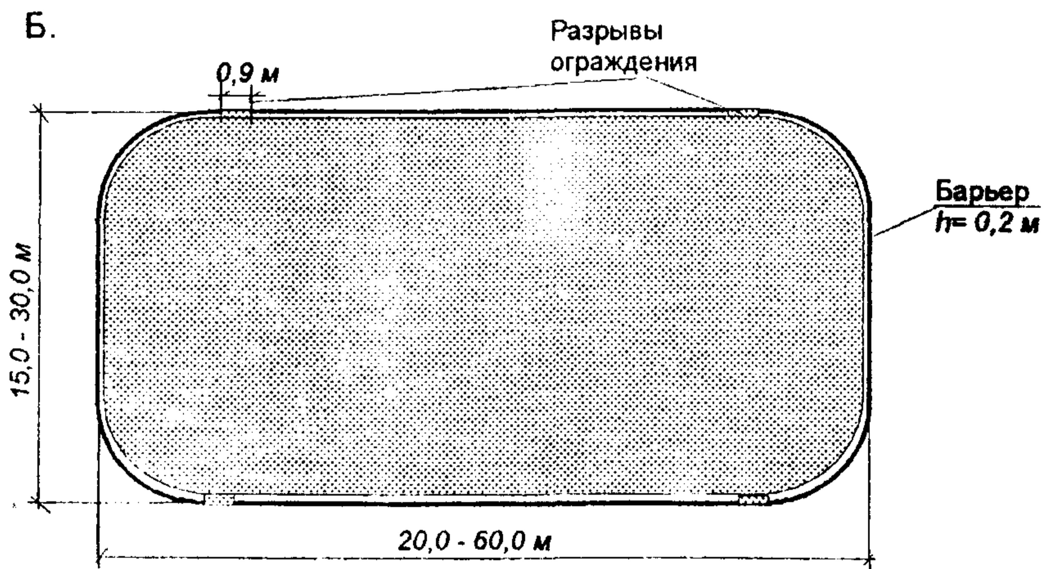
Рис.17. Схемы сооружений для роллерспорта. А. Круговая дорожка для скоростного бега на роликовых коньках (для закрытых помещений). Б. Площадка для фигурного и массового произвольного катания на роликовых коньках.
