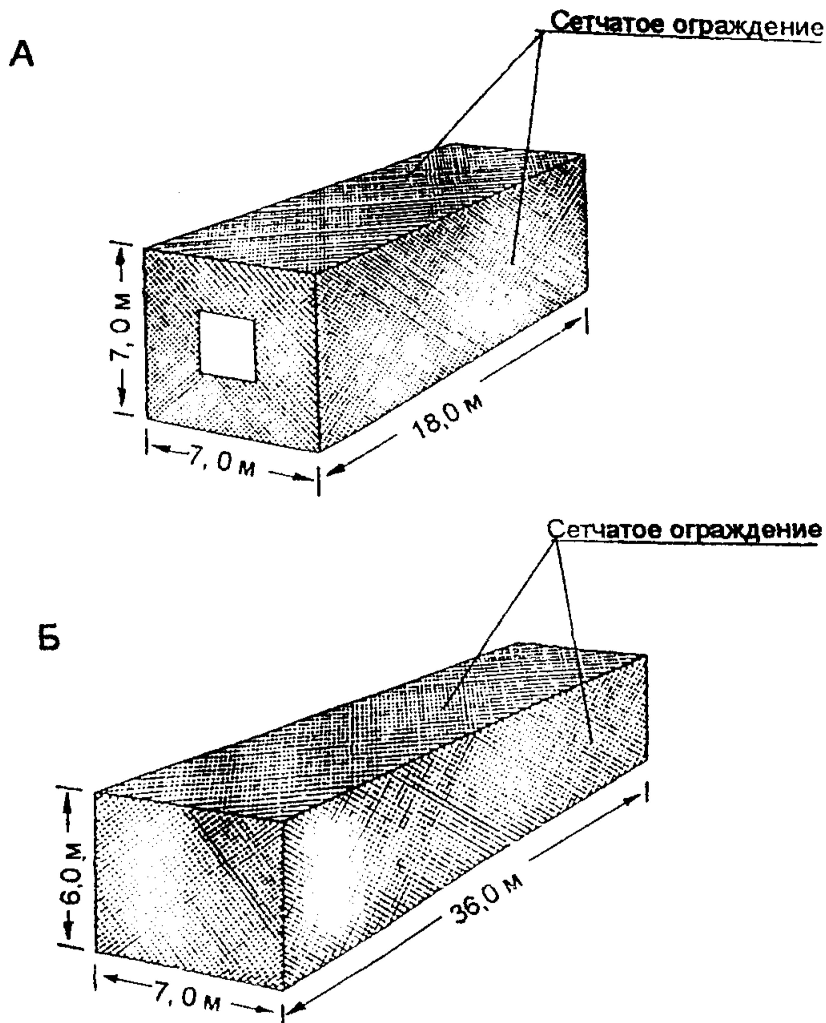
Рис. 22. Габаритные схемы тренировочных коридоров для тренировочных занятий по отработке ударов битой при бейсболе и софтболе с габаритами: А- 18,0 x 7,0 x 7,0 м; Б - 36,0 x 7,0 x 6,0 м.
