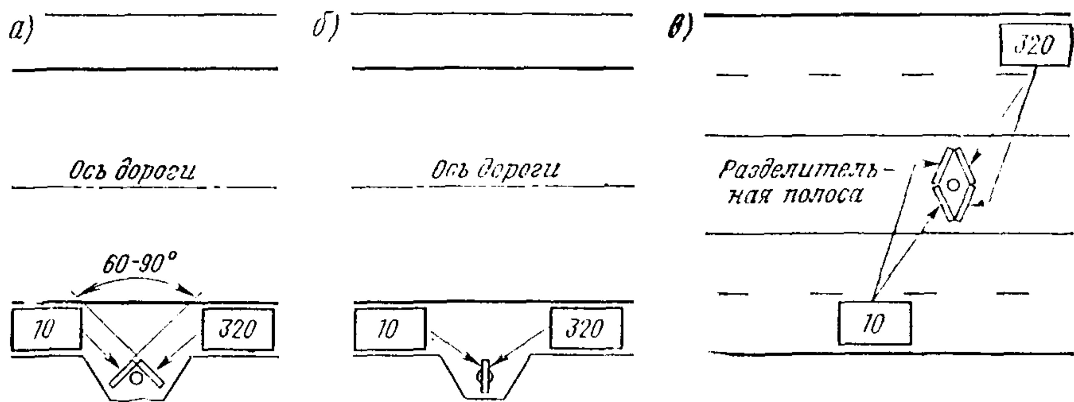
Рис. 8.13. Способы установки километровых знаков на автомобильных дорогах
