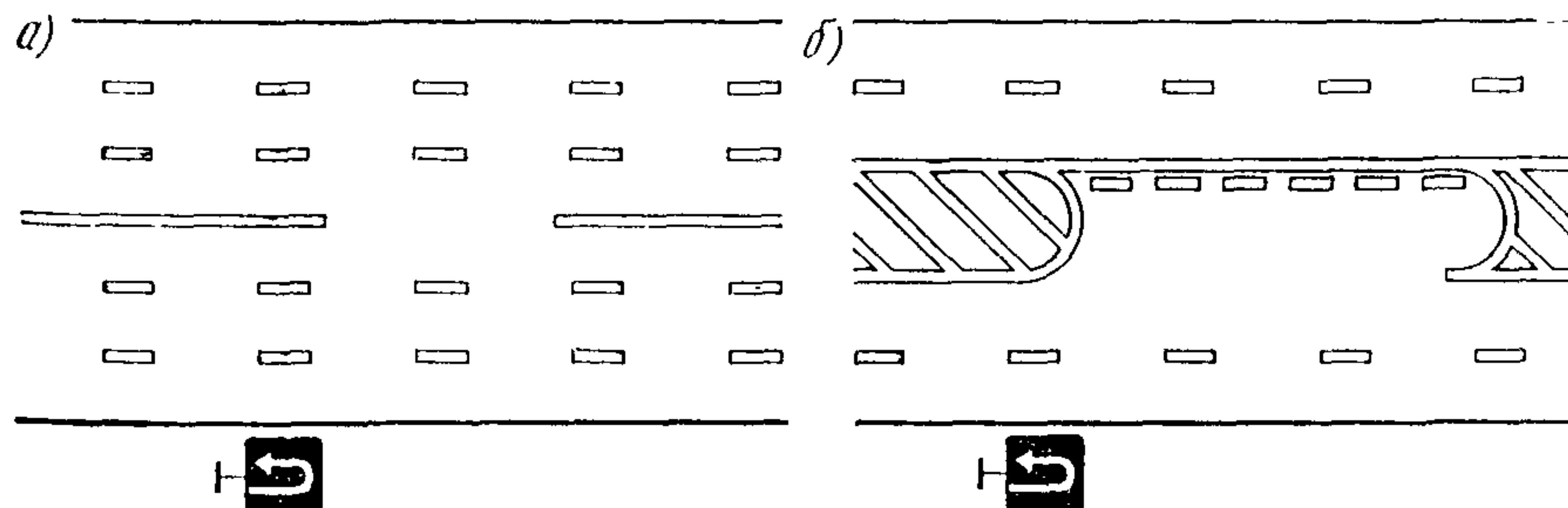
Рис. 8.9. Схемы установки знака 5.11 «Место разворота»
