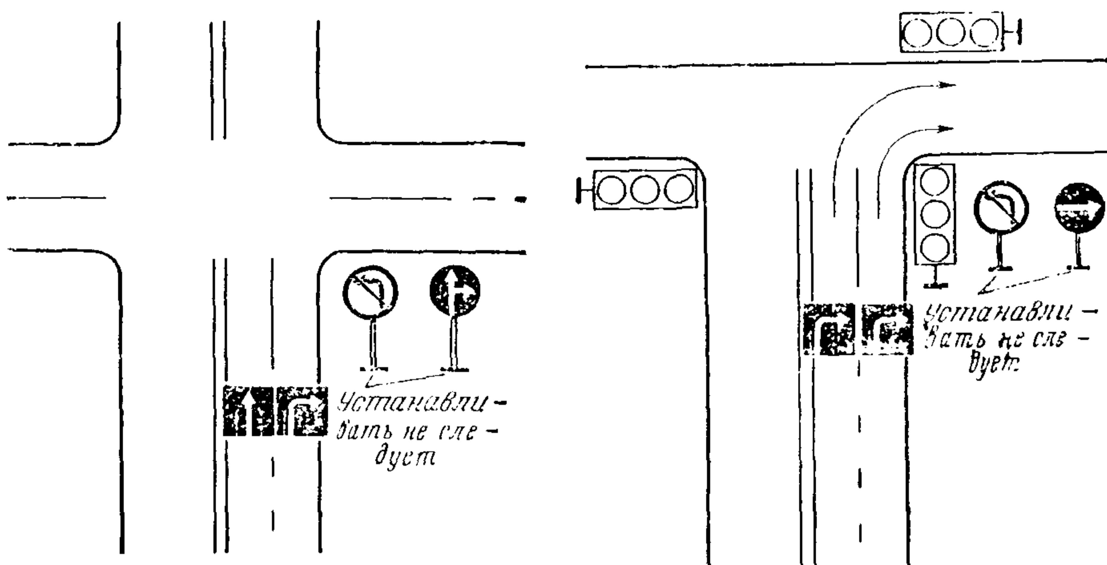
Рис. 8.6. Пример применения знаков 5.8.1 или 5.8.2, установка знаков 3.18 или 4.1 при этом исключается
