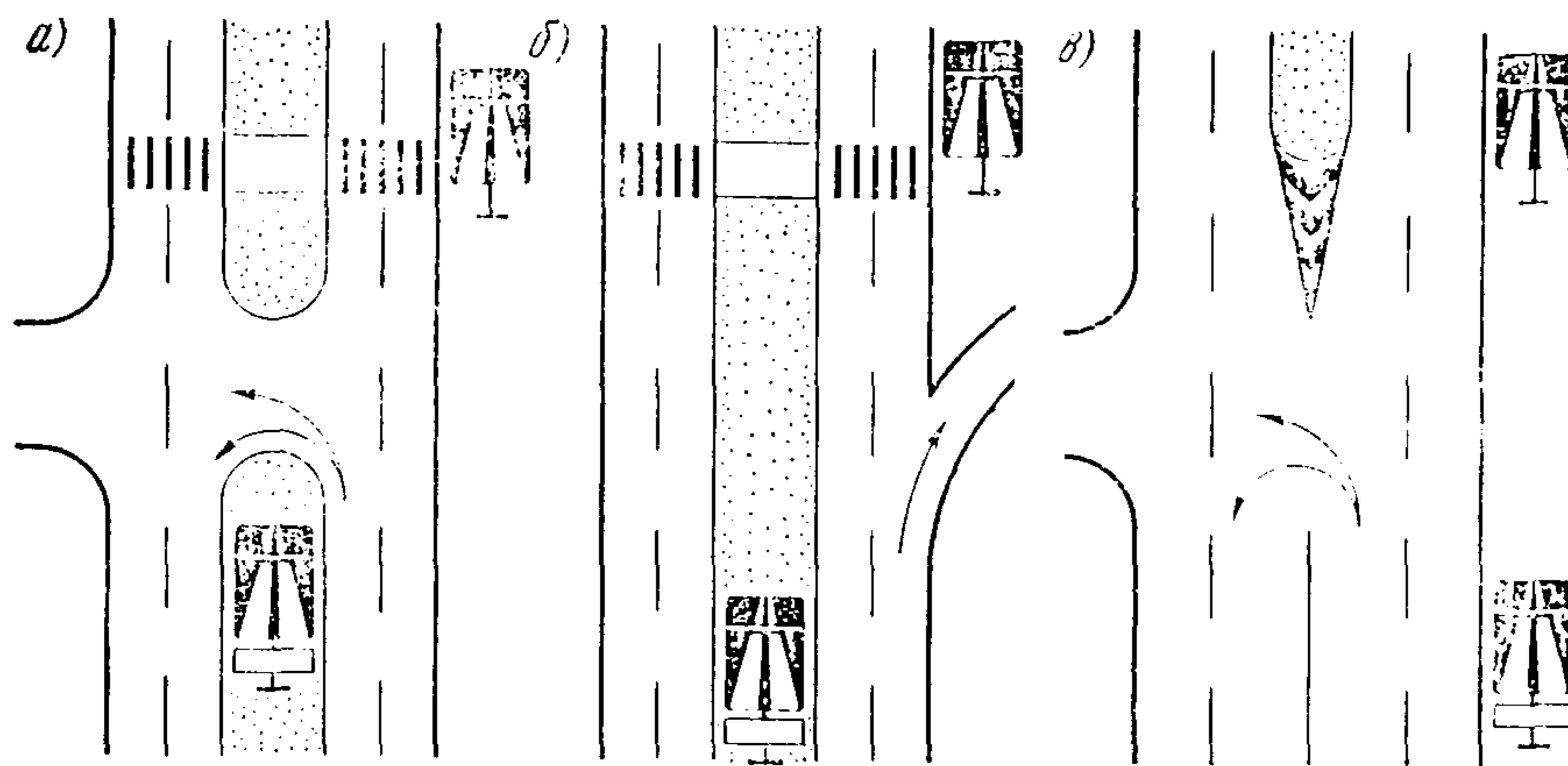
Рис. 8.1. Схемы установки знака 5.1 «Автомагистраль»
