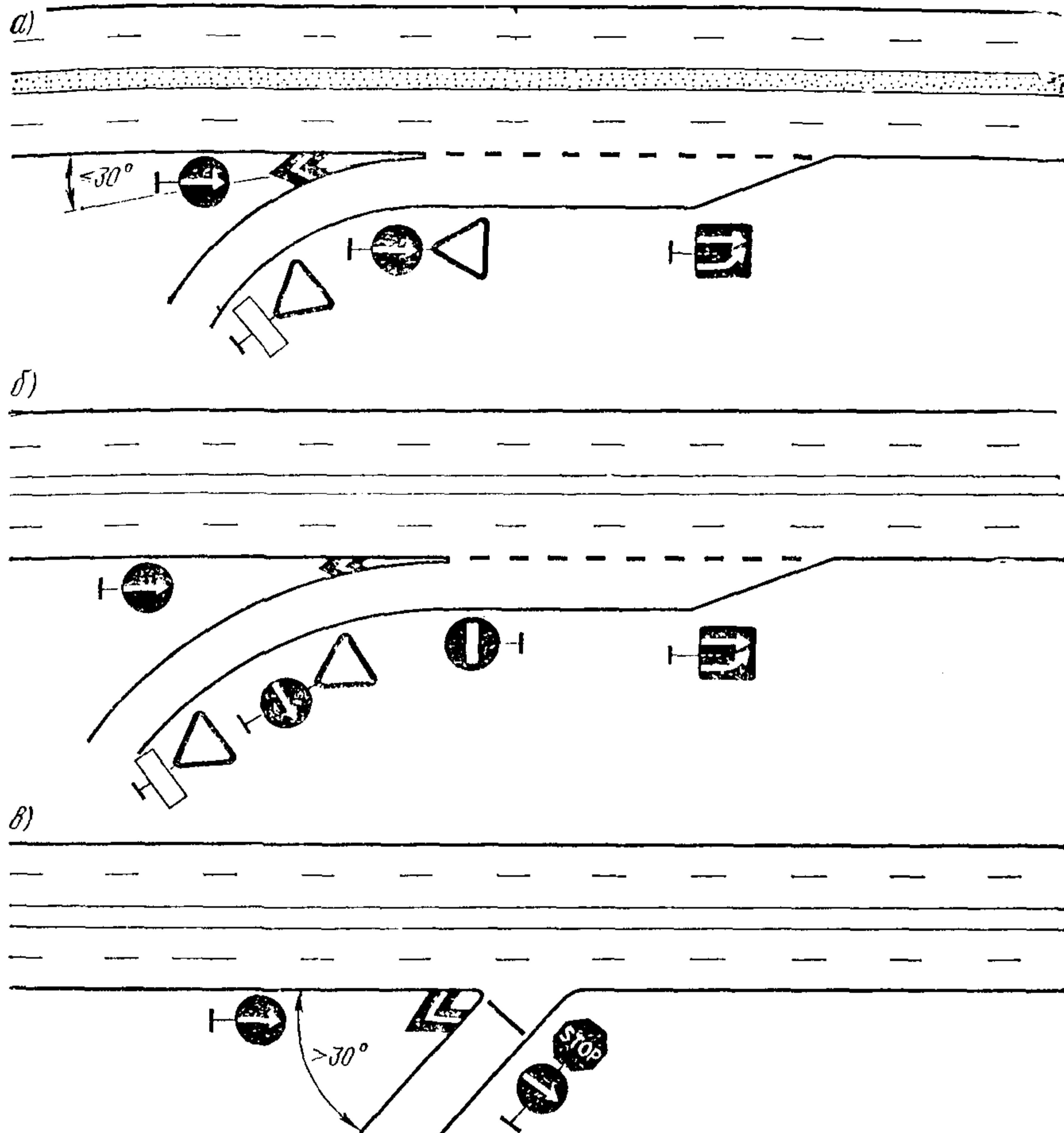
Рис. 14.2. Примеры применения знаков на примыканиях соединительных съездов:
