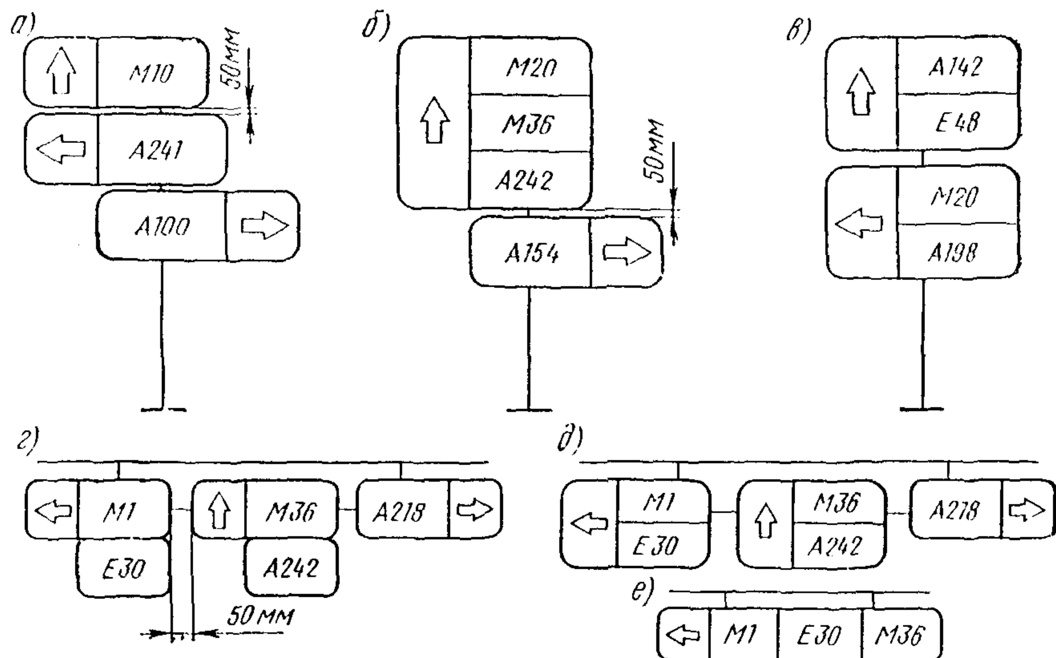
Допускается одновременное расположение знаков 5.28 и одного 5.29.1 на одной стойке. При этом знак 5.29.1 располагается сверху.
