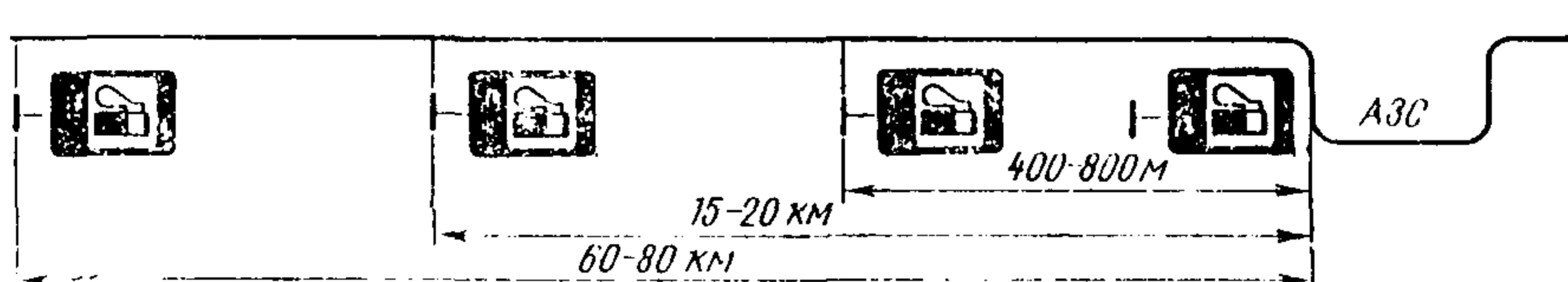
Рис. 9.1. Расположение знаков сервиса относительно обозначаемого объекта
