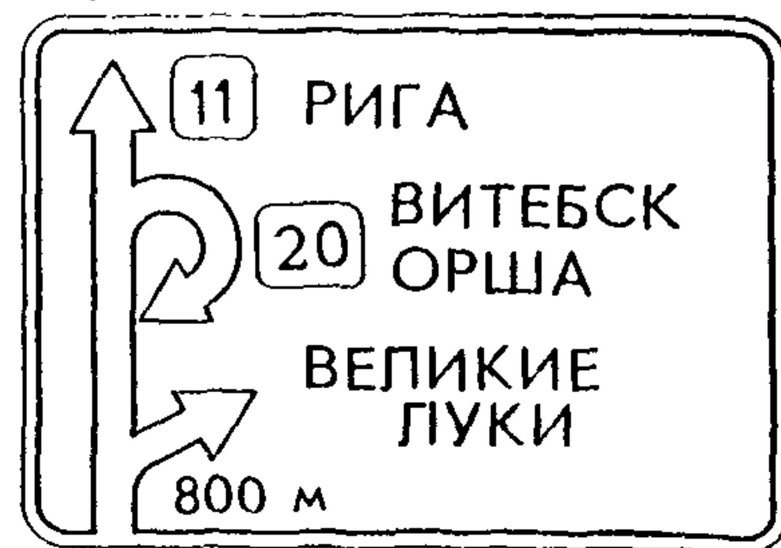
между надписью ОРША и каймой знака —  $1,5h_{\text{п}}$ , между надписью РИГА и ВЕЛИКИЕ —  $2,5h_{\text{п}}$ . При этом размеры знака составят  $2457 \times 5036$  мм. При данной компоновке стрелок (их центральное размещение) такой вариант является оптимальным;
