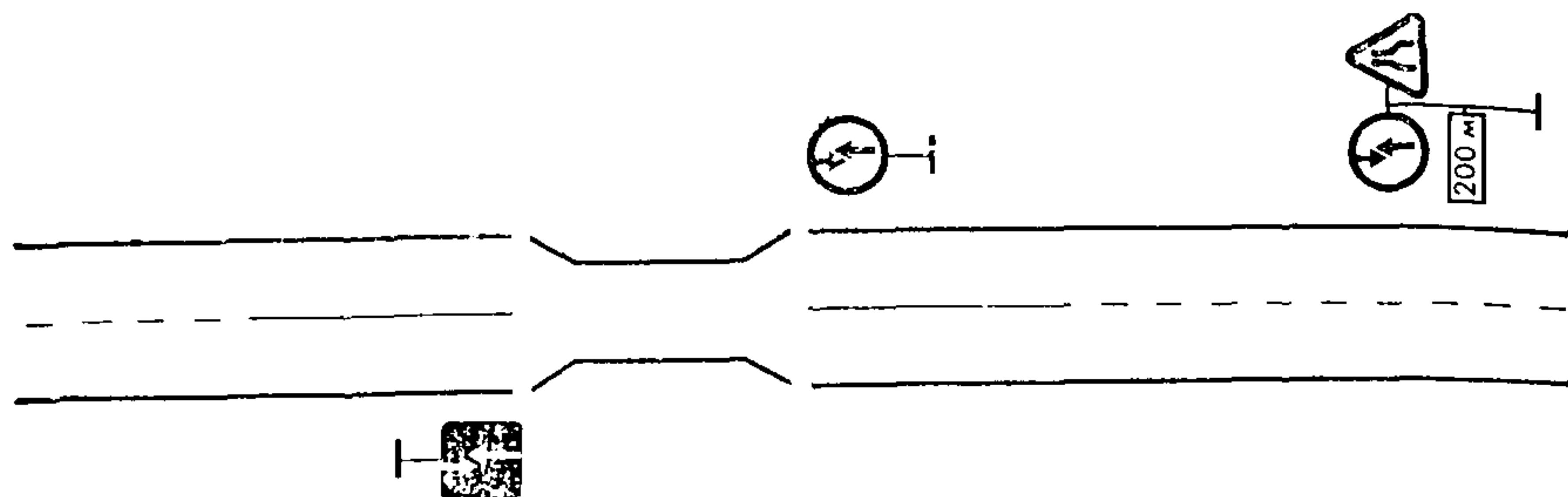
Рис. 5.3. Пример предварительной установки знака 2.6
