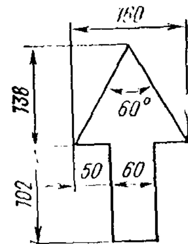
Рис. 19.9. Размеры стрелки для знака 5.29.2
