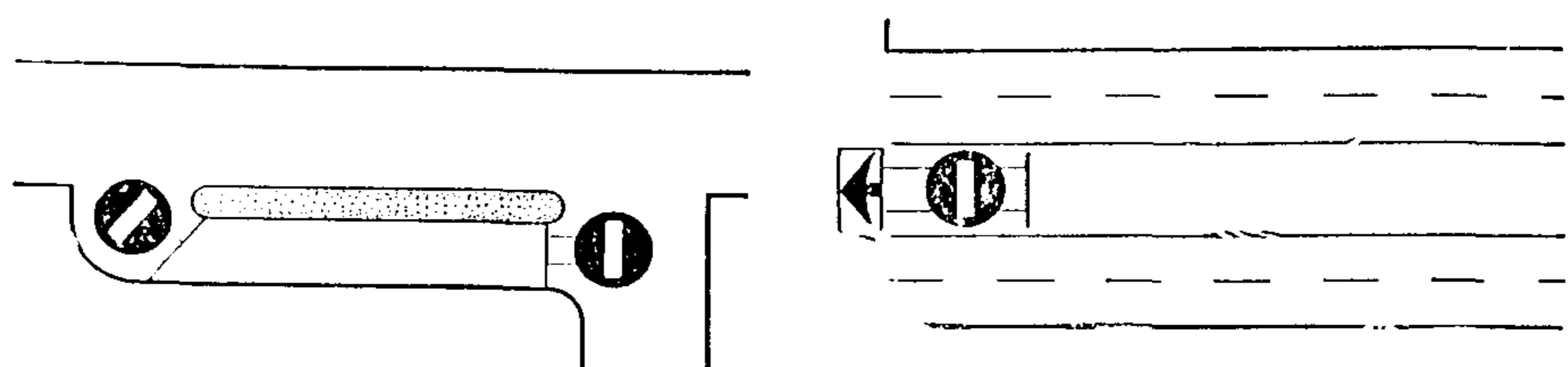
Рис. 6.5. Установка знаков 3.1 на разворотно-отстойных площадках, предназначенных для транспортных средств общего пользования, движущихся по установленным маршрутам
