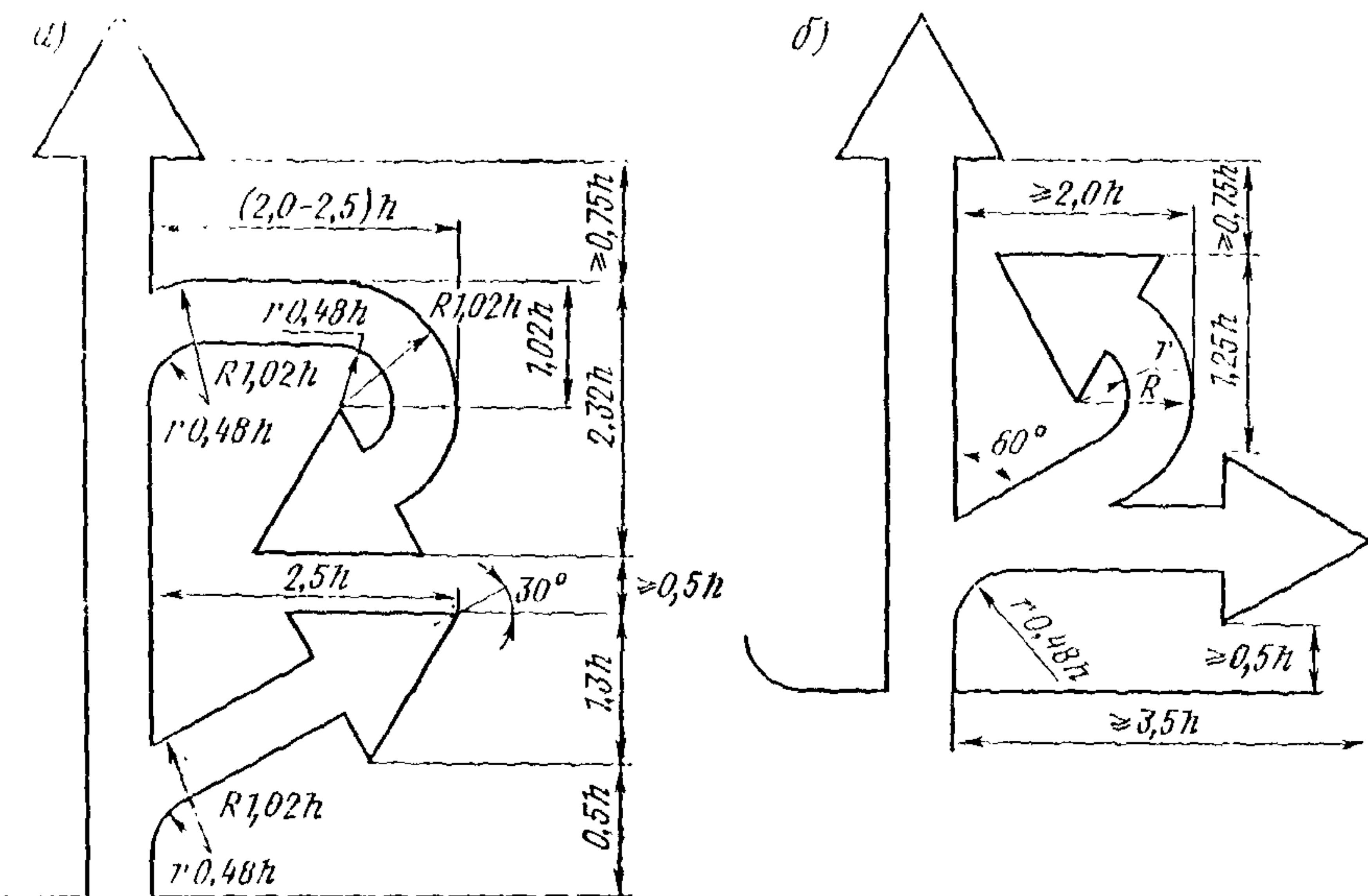
Рис. 19.2. Рекомендуемая конфигурация стрелок на знаке 5.20.1, устанавливаемом перед развязкой в разных уровнях, с точки зрения сокращения размеров знака и улучшения его информативности (возможно горизонтальное расположение нижней стрелки в варианте а)
