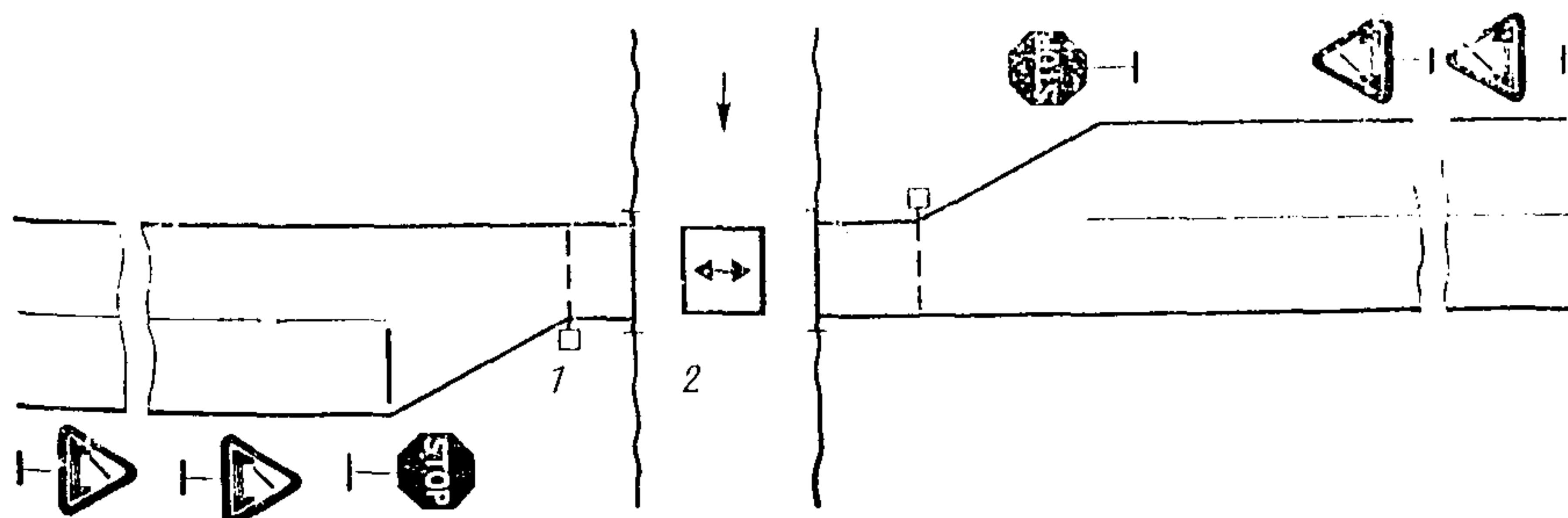
Рис. 17.1. Схема установки знаков на паромной переправе:
