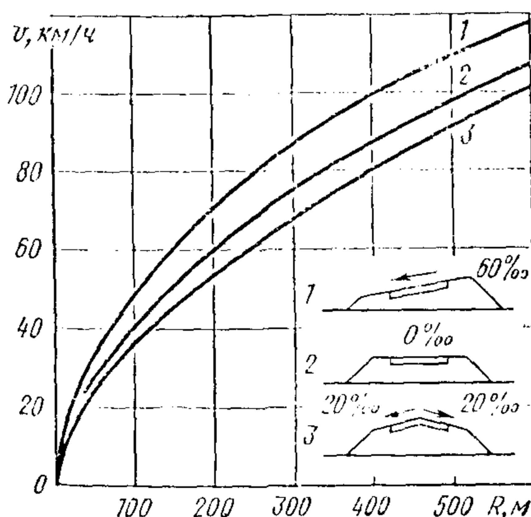
Рис. 6.11. Выбор верхнего предела скорости движения на кривых в плане:
