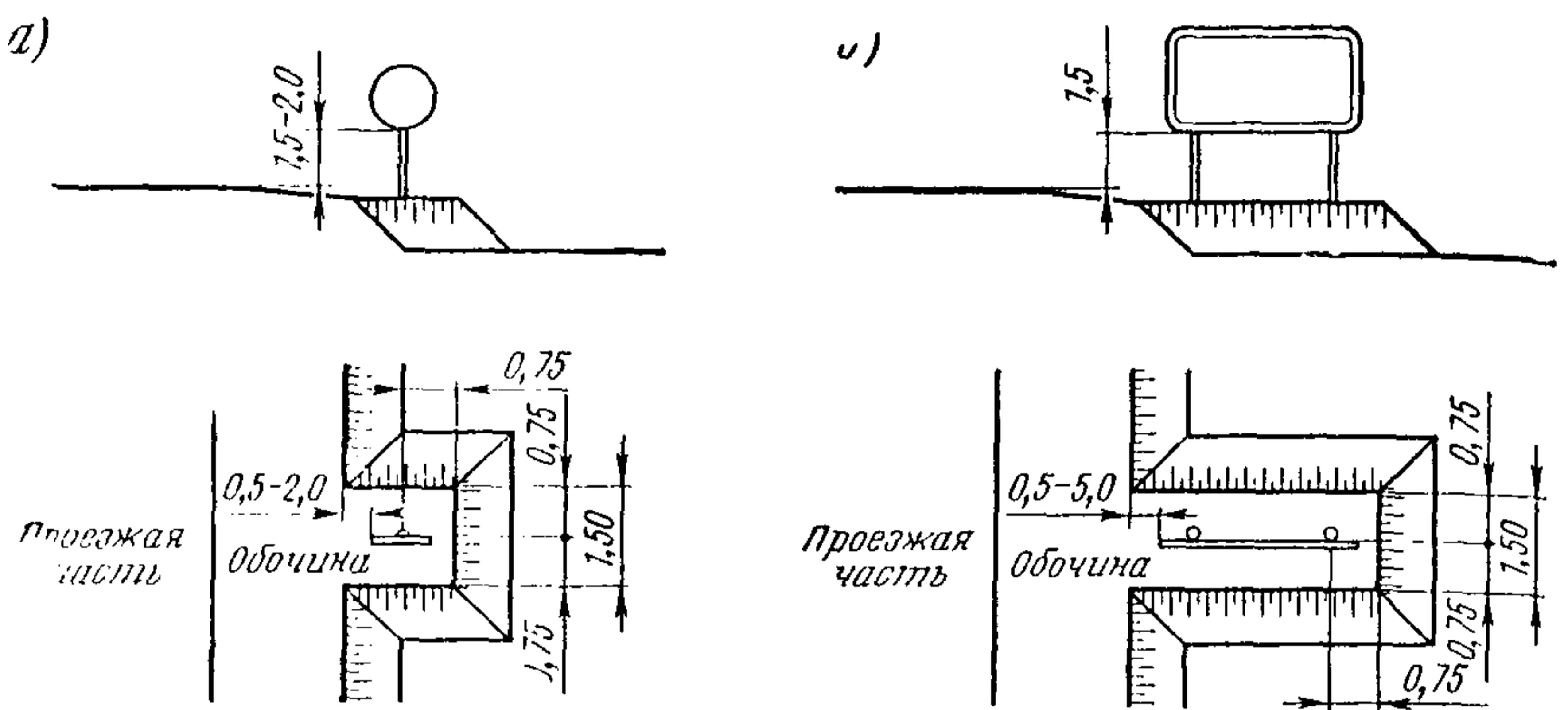
Рис. 3.5. Устройство берм для установки знаков:
