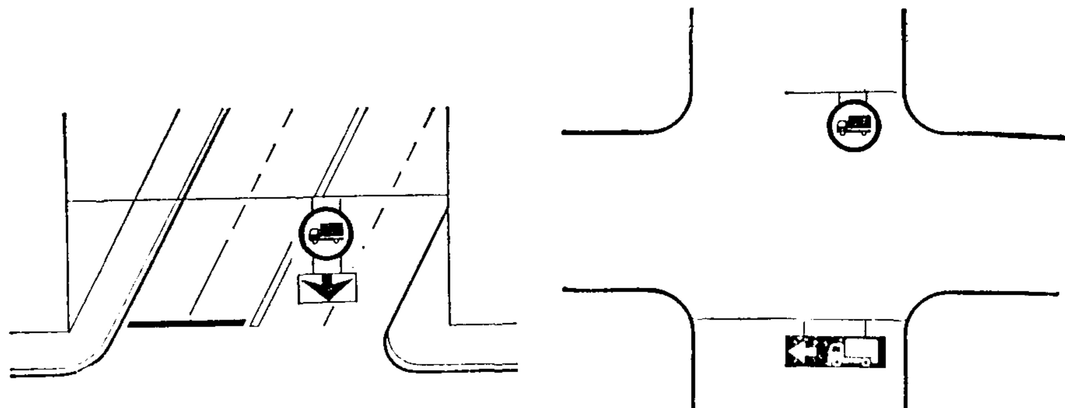
Рис. 6.8. Установка знака 3.4 с табличкой 7.14 для запрещения движения грузовых автомобилей по отдельной полосе проезжей части
