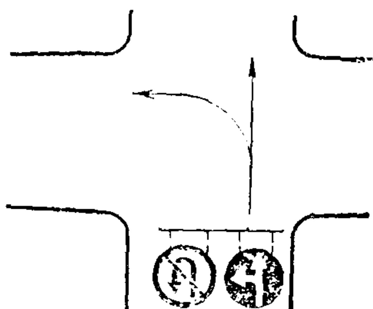
Рис. 6.10. Совместное применение знака 3.19 со знаком 4.1.3 при разрешении левых поворотов и запрещении разворотов на перекрестках
