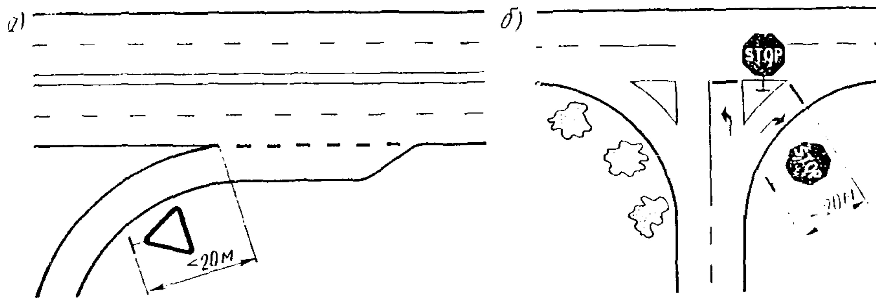
Рис. 5.2. Установка знаков 2.4 и 2.5 при выезде на пересекаемую дорогу под острым углом:
