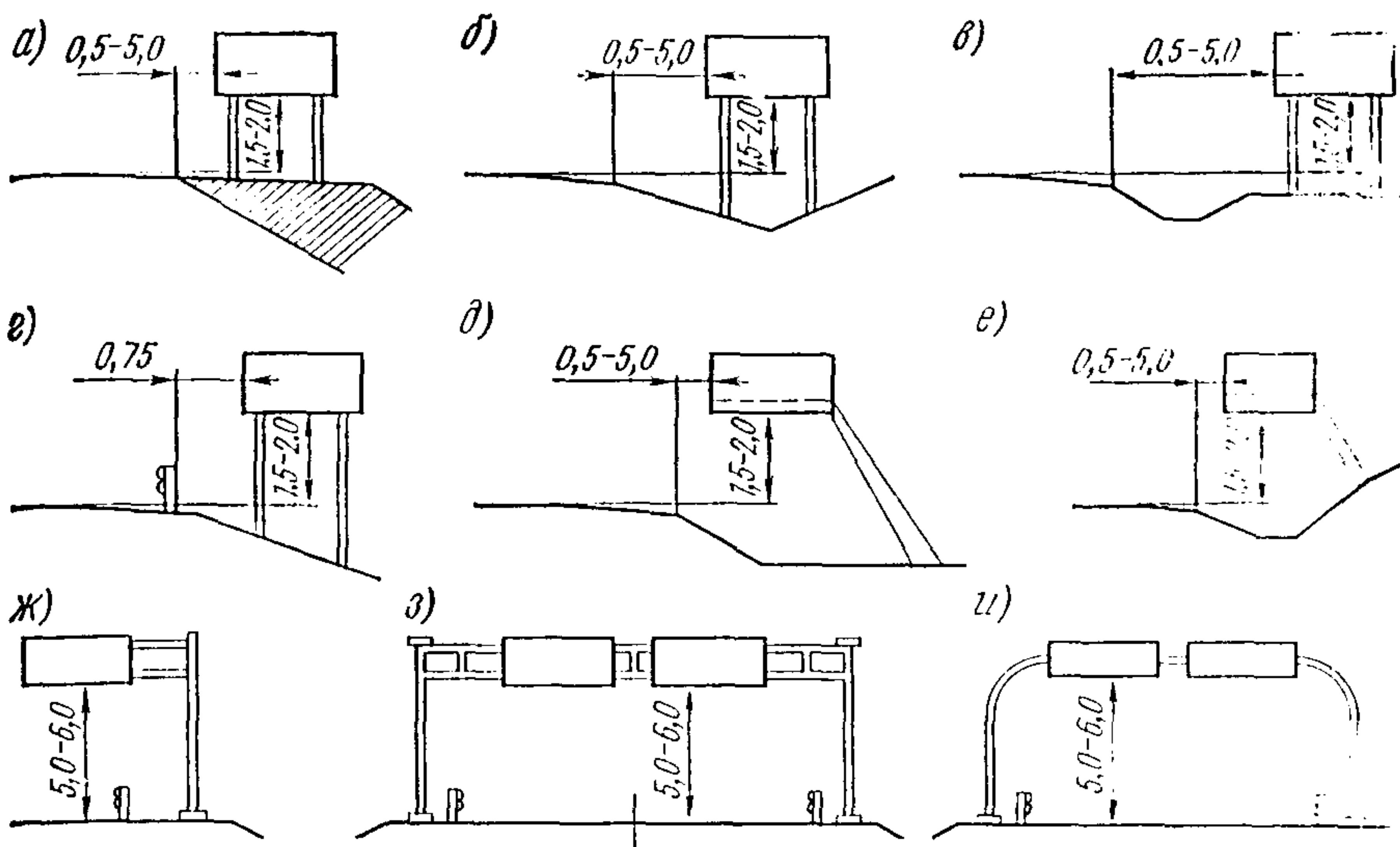
Рис. 3.4. Способы установки предварительных указателей направлений
