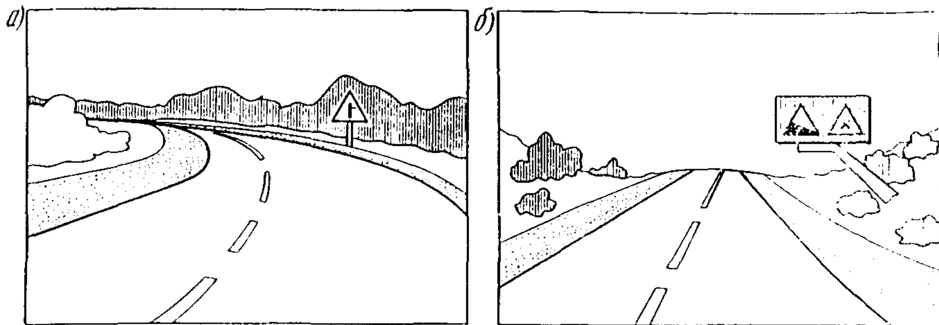
Рис. 3.1. Экранирование фона за знаком:
