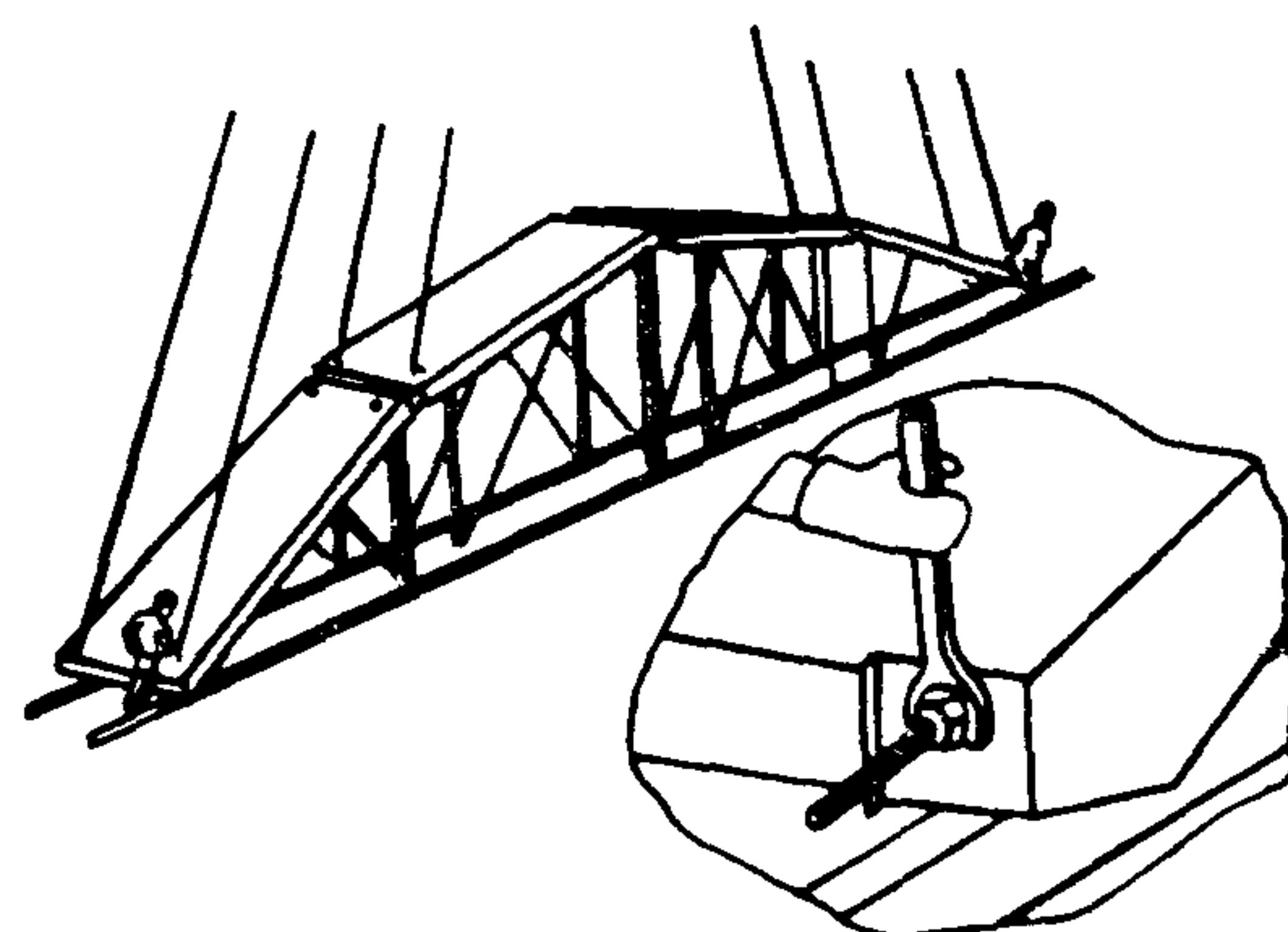
Закрепив подвесы, монтажники  $M_1$  и  $M_4$  цепляют крюки стропов за монтажные петли и затем спускаются на землю. После этого монтажники  $M_1, M_2, M_3$  и  $M_4$  для окончательного натяжения затяжек гаечными ключами подкручивают гайки на болтах
