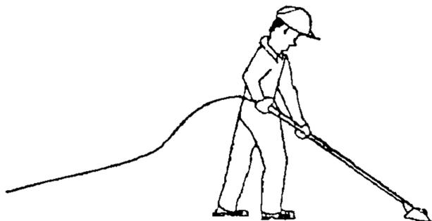
Оператор-металлизатор (О-М) отсоединяет пневмошлем от компрессора и снимает средства защиты.
