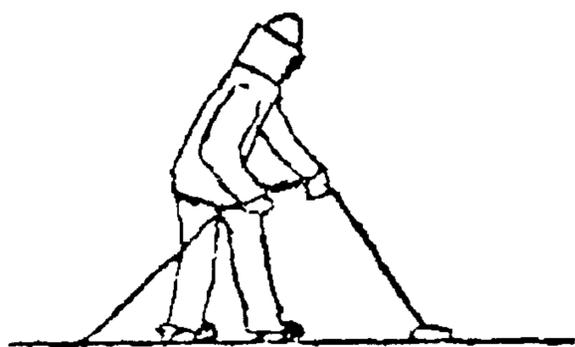
Оператор-пескоструйщик (О-П)<sub>2</sub> отключает пескоструйно-дробеструйный аппарат от электросети. Убирает рабочее место от песка и пыли. Операторы-пескоструйщики (О-П)<sub>1</sub> и (О-П)<sub>2</sub> снимают пневмошлемы.
