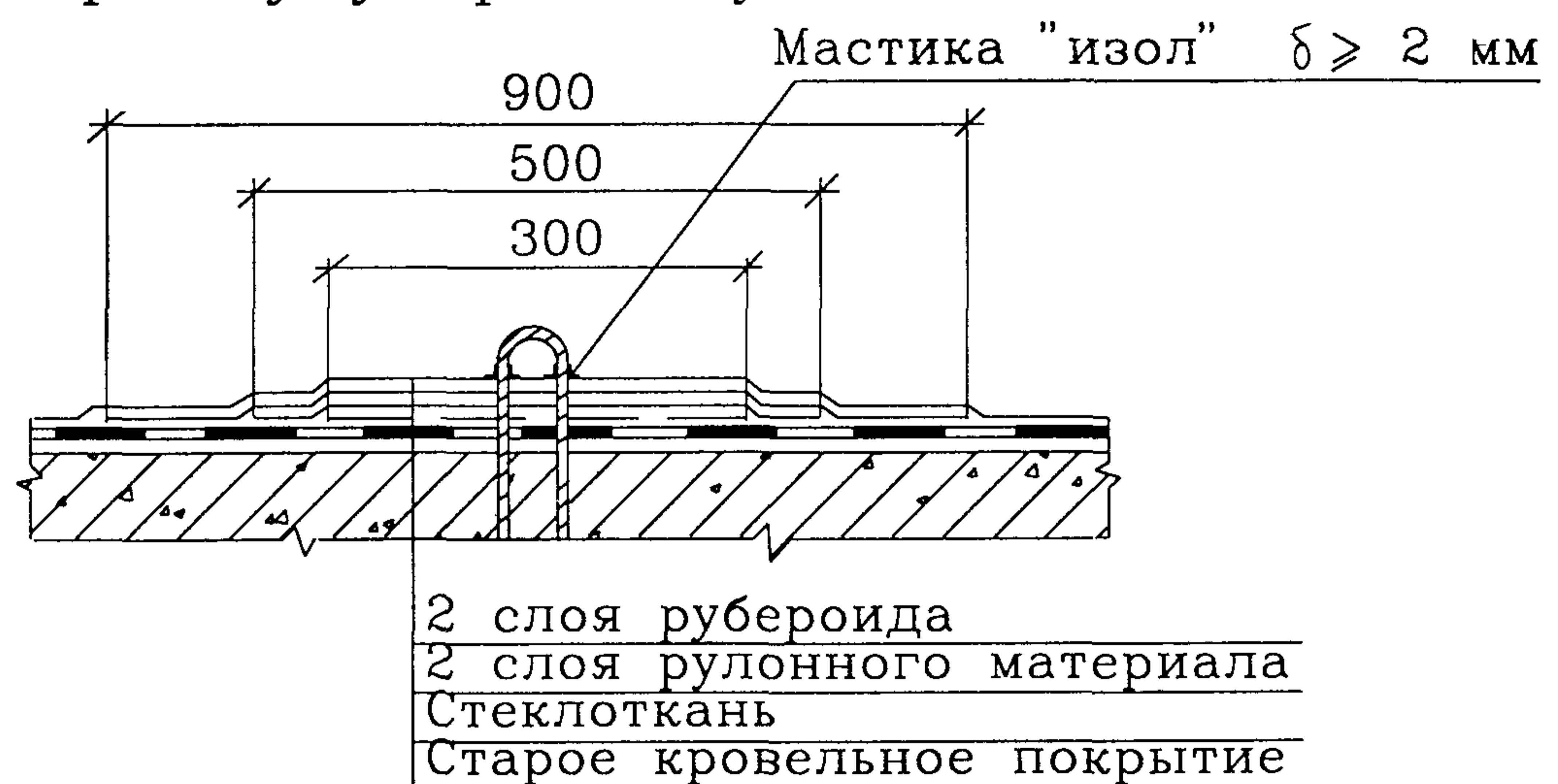
Рисунок 2 – Устройство мест примыканий
