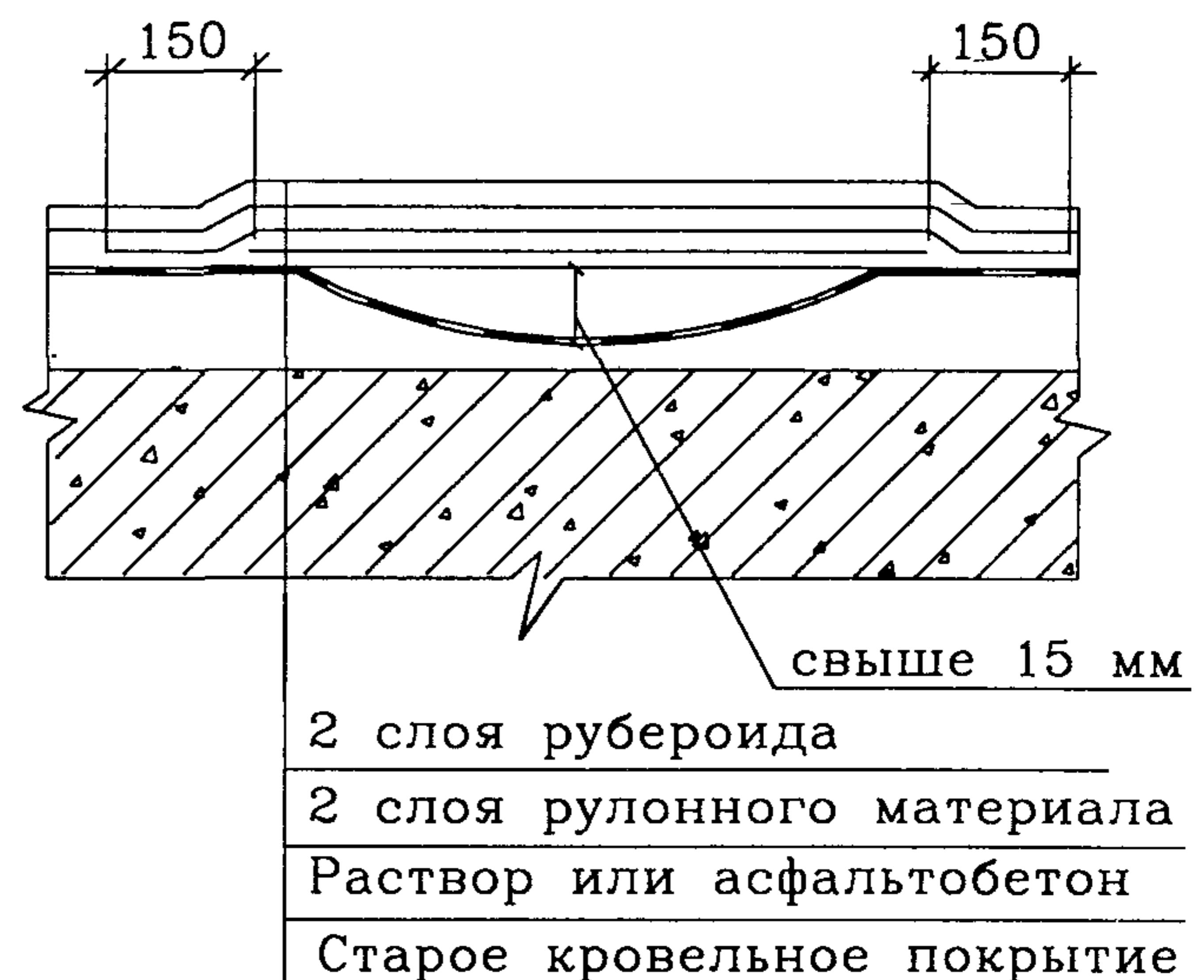
Рисунок 1 – Ремонт кровельного ковра
