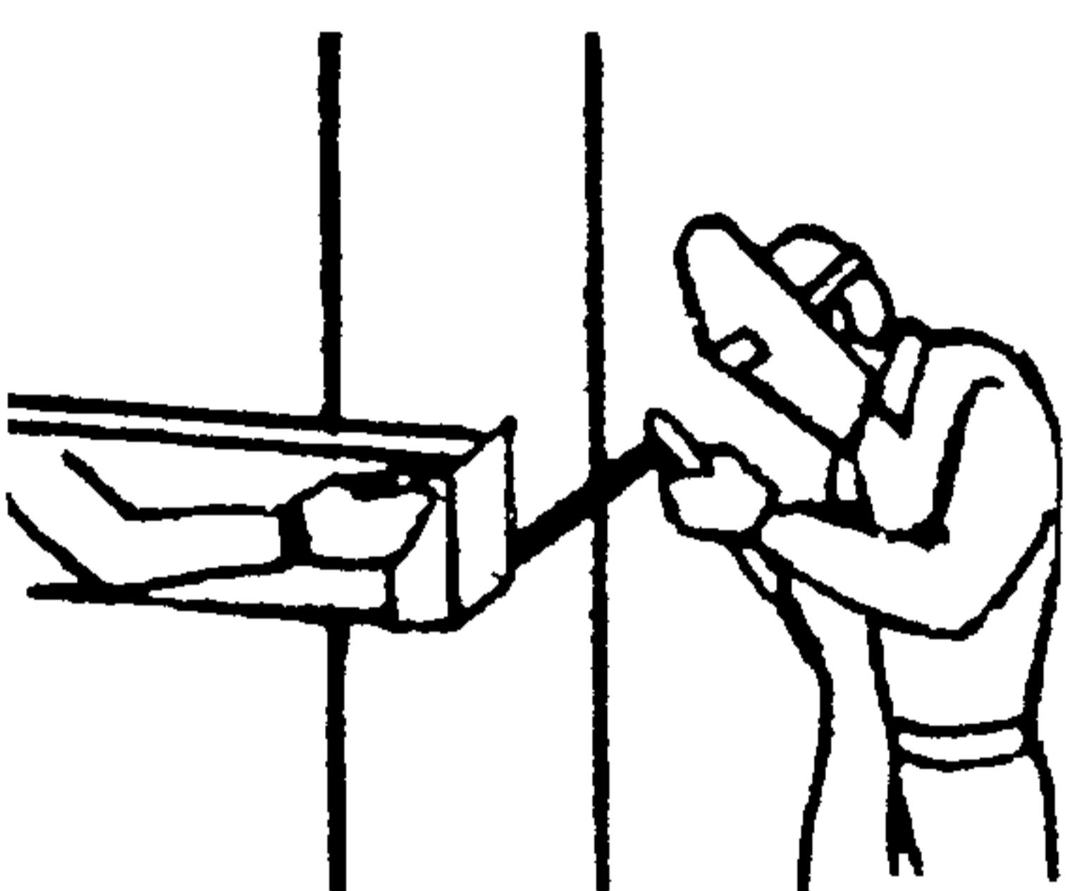
а затем накладывает уголок на другой конец доски и прижимает его к стальной трубе. Сварщик (С) приваривает этот уголок к стальной трубе.
