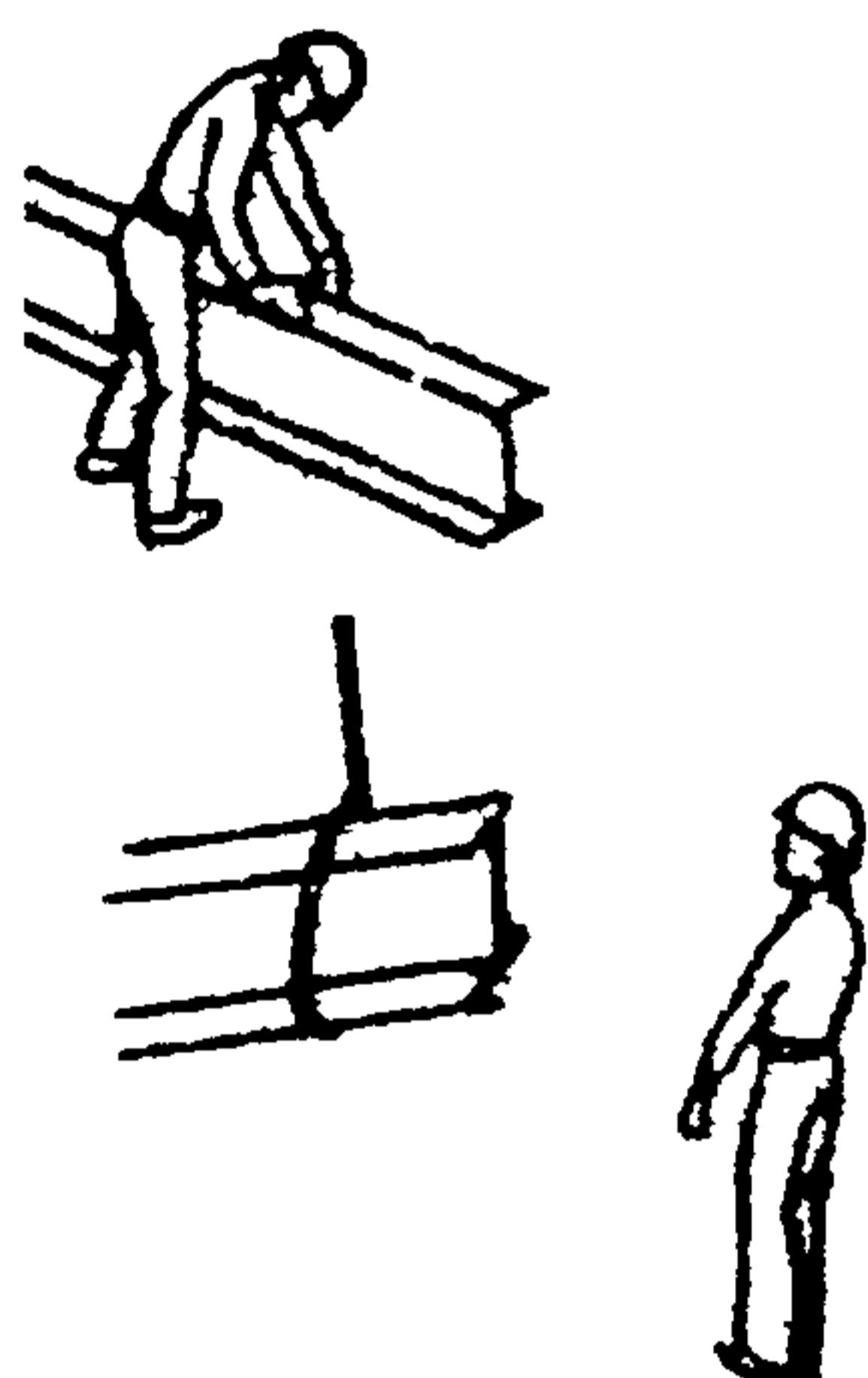
Копровщик (К2) надевает кольцевой строп на двутавровую балку и затягивает его. Затем второй конец кольцевого стропа набрасывает на крюк лебедки перемещения свай.
