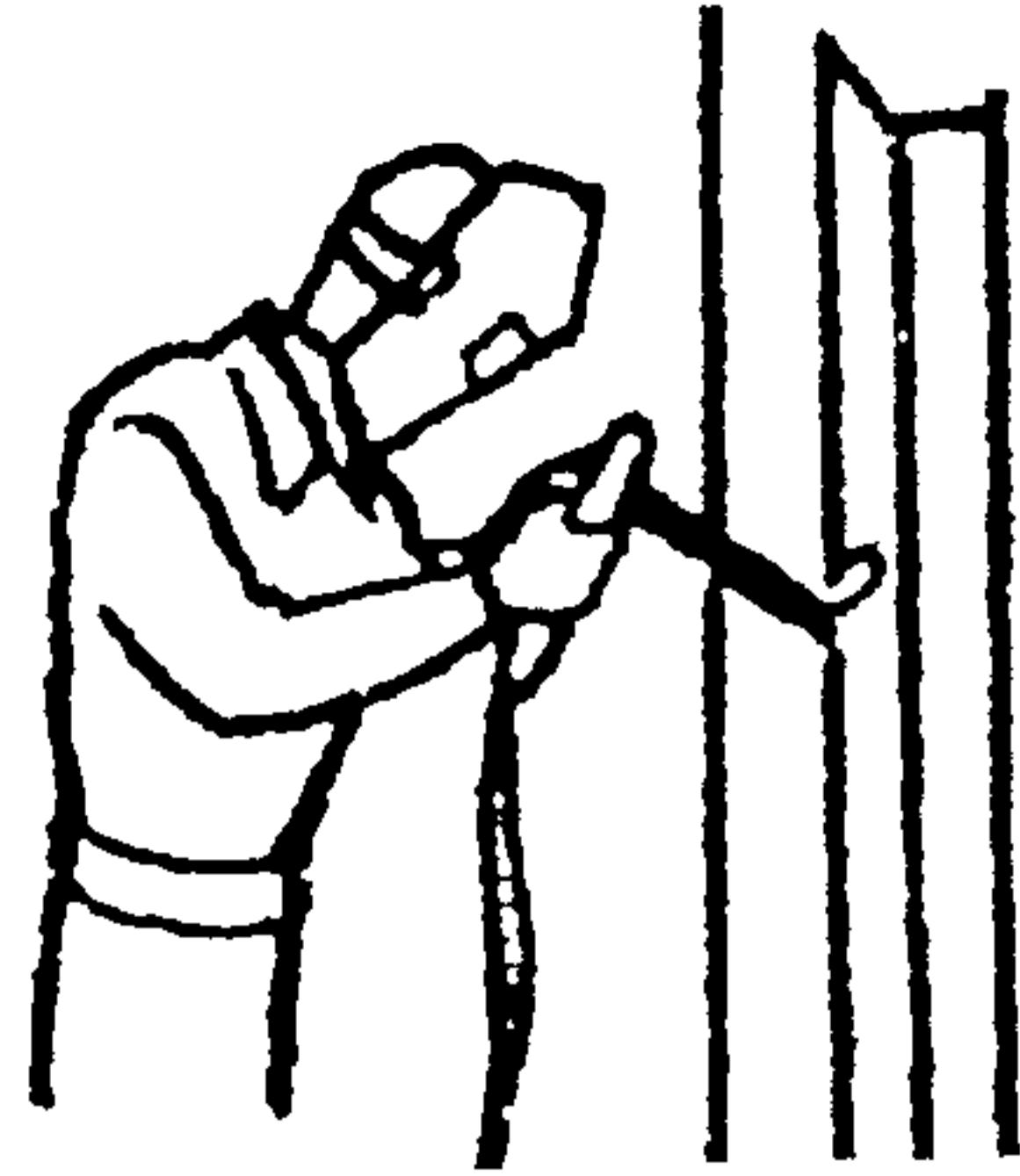
Сварщик (С) приваривает уголок к стальной трубе.
