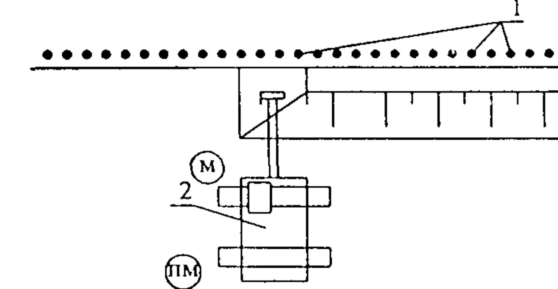
Схема организации рабочего места при разработке участков котлована экскаватором, оборудованным грейфером 1-установленные стальные трубы, 2-экскаватор ЭО-4121, **М**-машинист экскаватора, **ПМ**-помощник машиниста экскаватора
