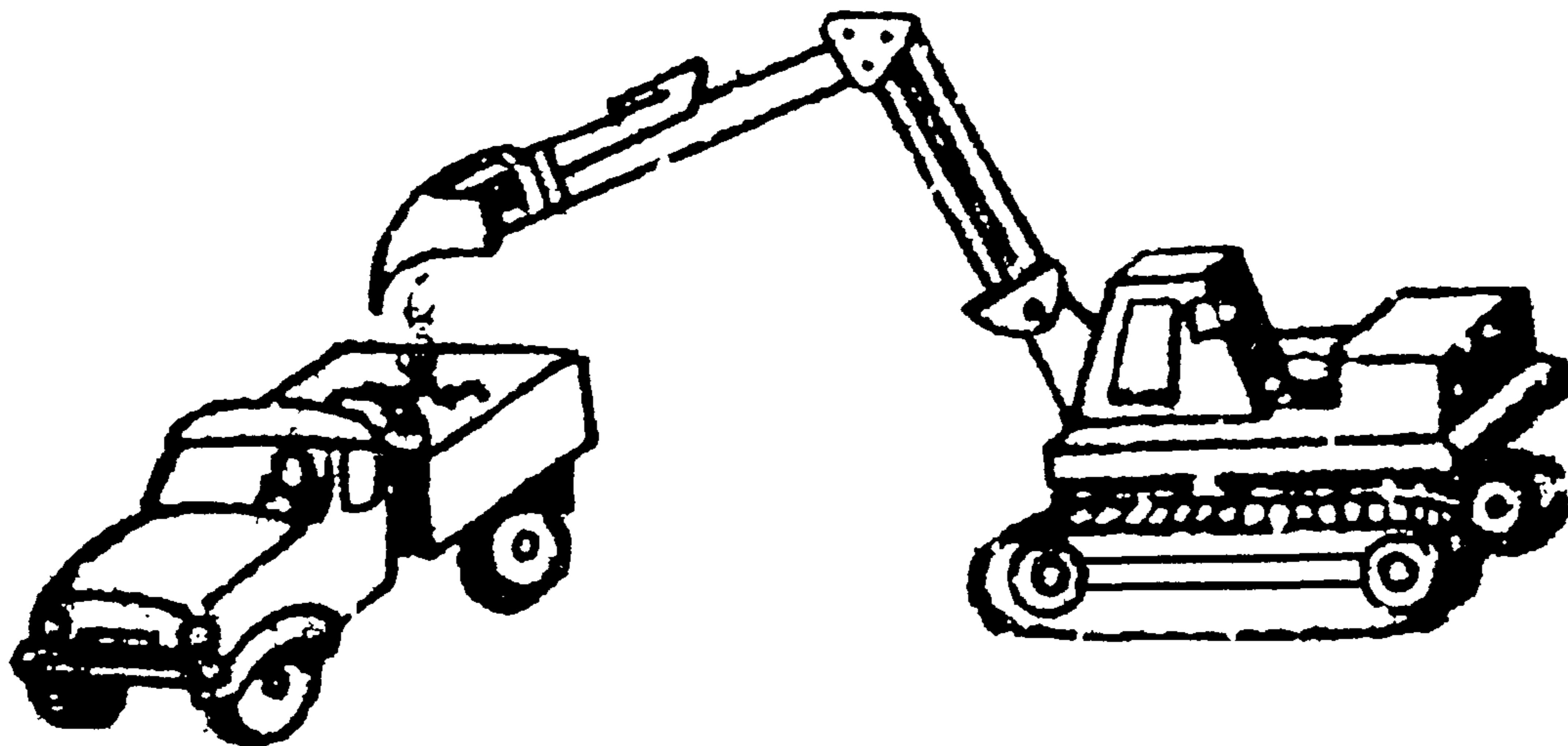
Экскаватор ЭО-4121, оборудованный обратной лопатой, послойно разрабатывает грунт с погрузкой его в транспортное средство.
