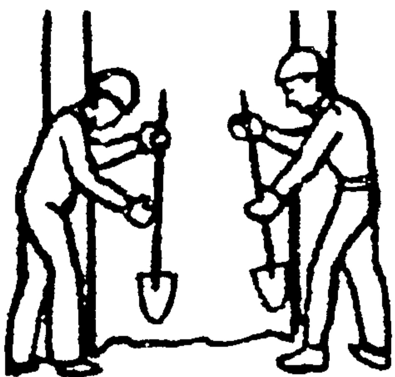
Плотники (П2) и (П3) лопатами удаляют излишки грунта, находящегося за вертикальной плоскостью забирки.
