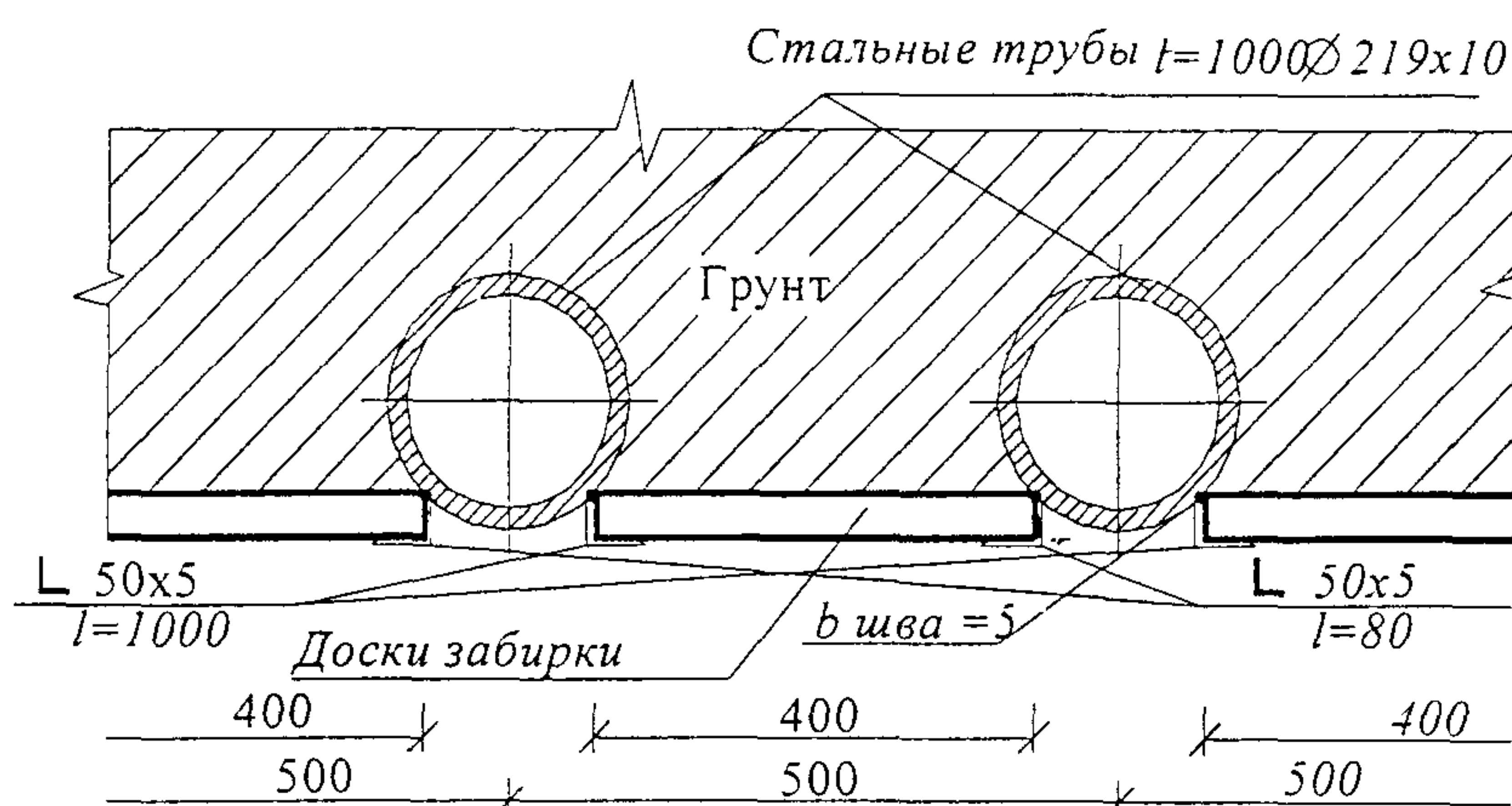
Рисунок 2 - Крепление стенок котлована с применением труб
