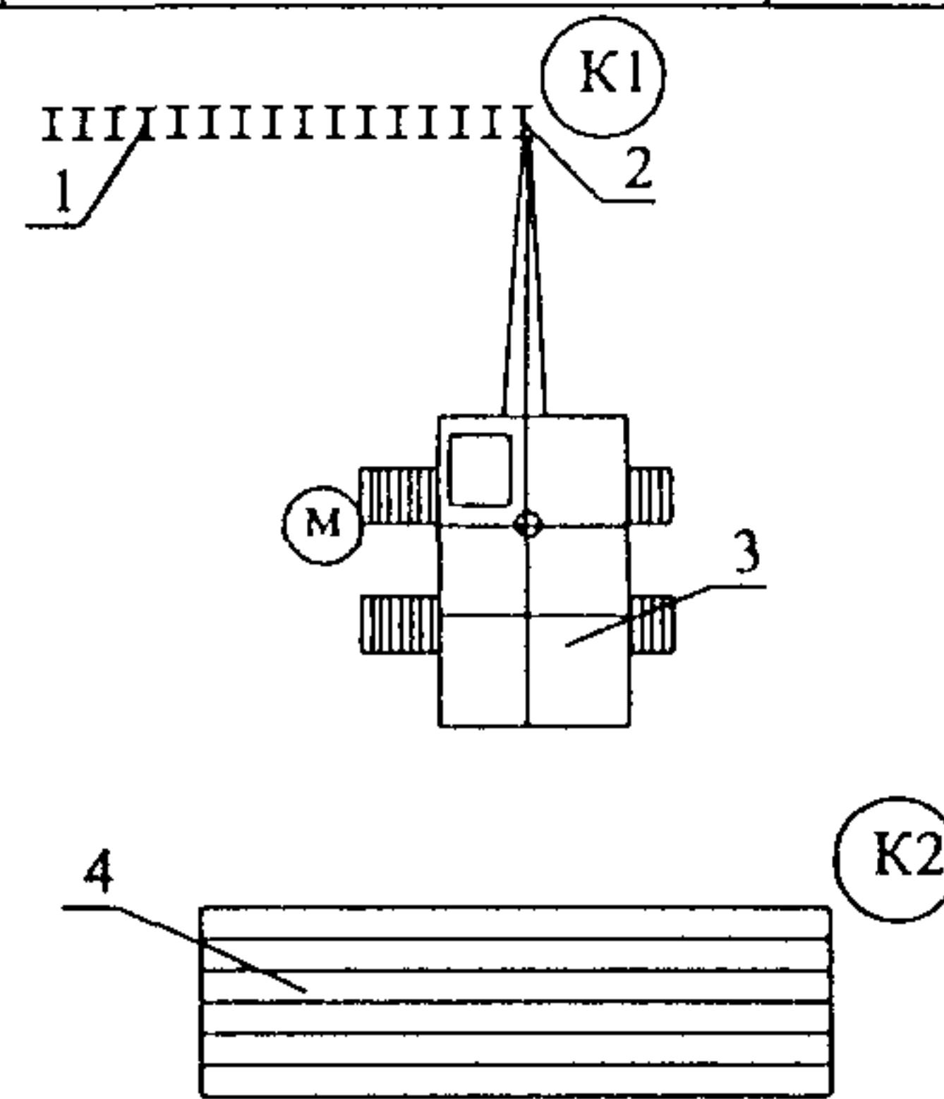
Схема организации рабочего места при забивке двутавровых балок 1-забитые двутавровые балки, 2-забиваемая двутавровая балка, 3-копровая установка на базе экскаватора Э-10011, 4-склад двутавровых балок, **М**-машинист копровой установки, **K1**, **K2**- копровщики
