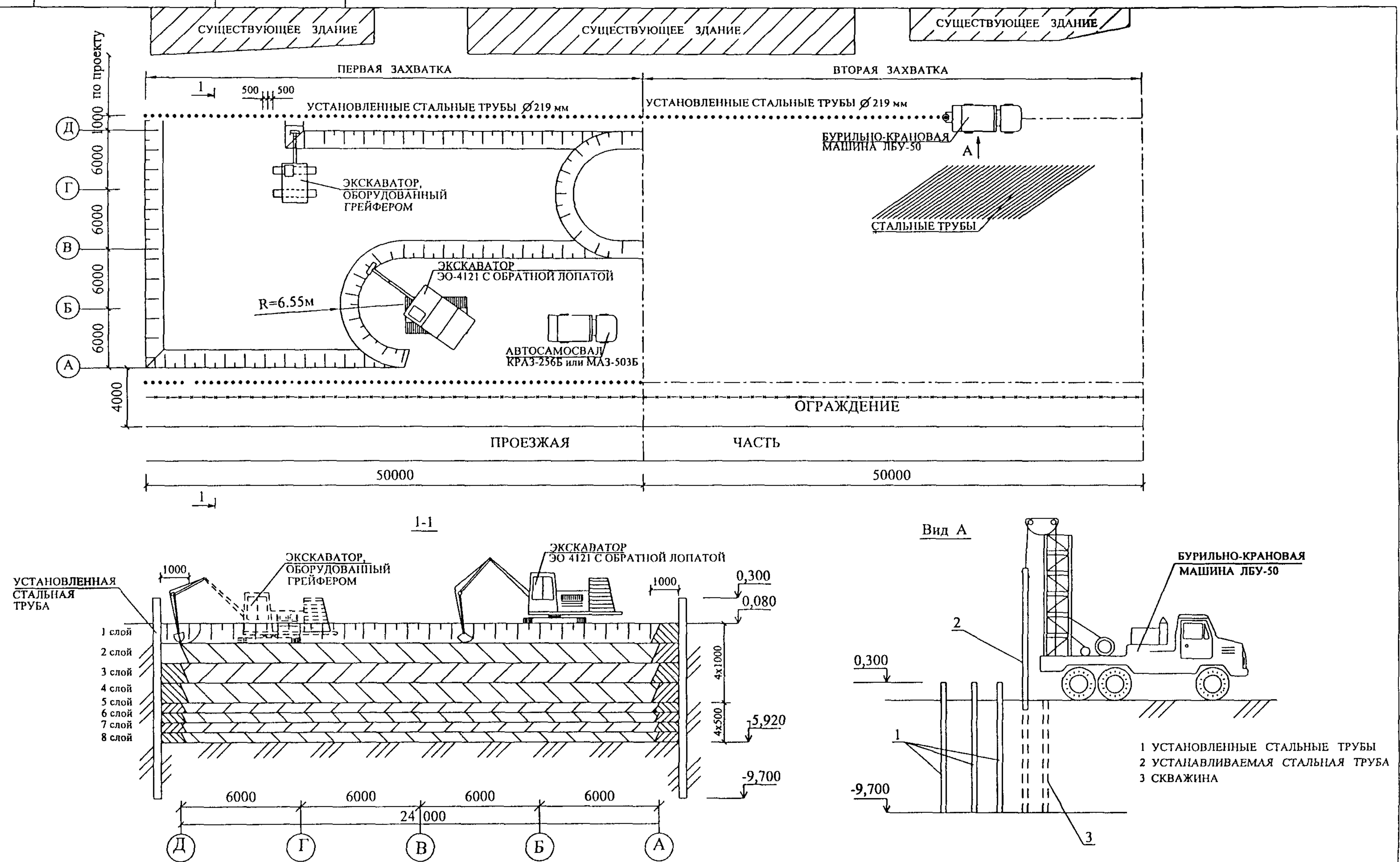
Рисунок 4 - Схема производства работ по погружению стальных труб с предварительным забуриванием и схема производство земляных работ
