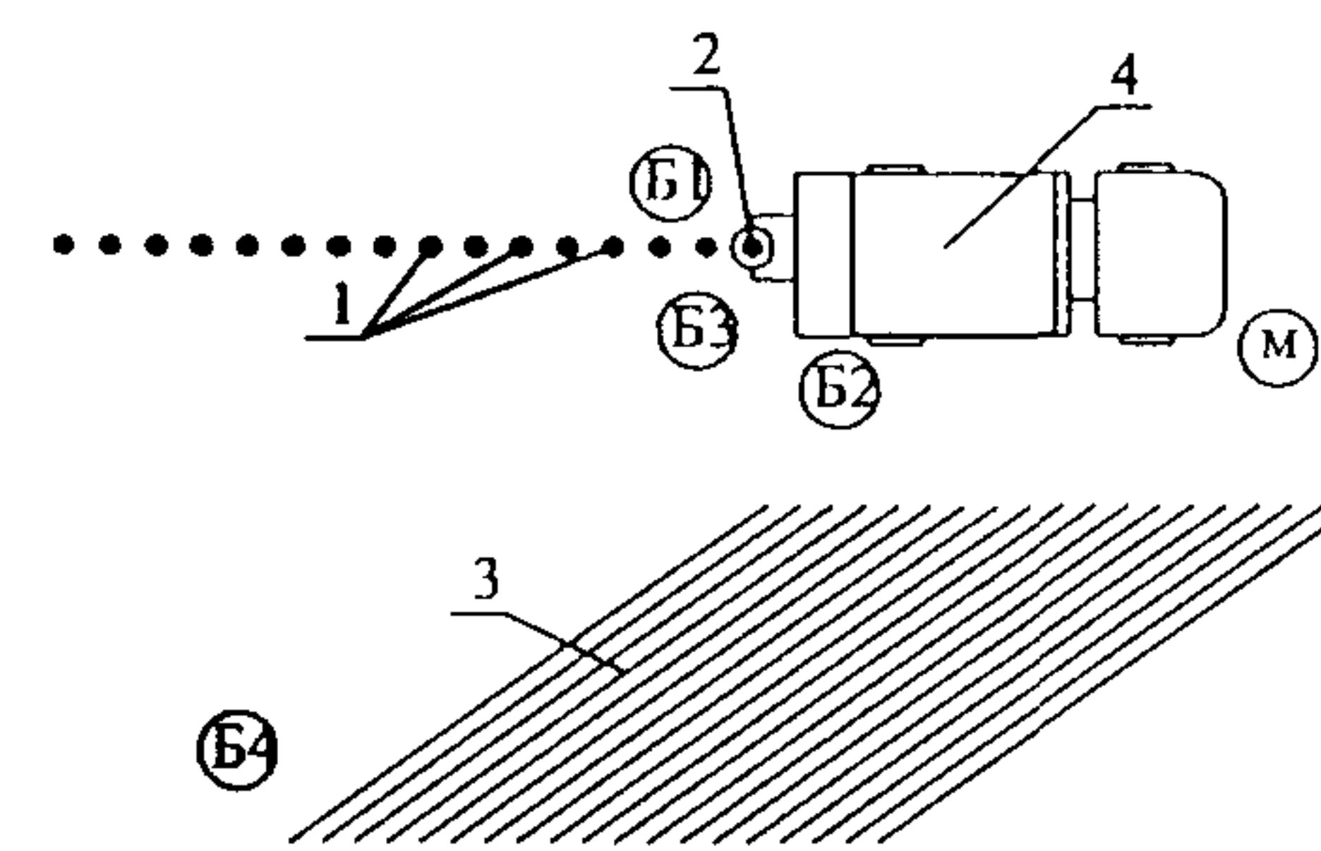
Схема организации рабочего места при установке стальных труб 1-установленные стальные трубы, 2-пробуренная скважина, 3-склад труб, 4-бурильно-крановая машина ЛБУ-50, **М1**-машинист бурильно-крановой манипулятора, **Б1**, **Б2**, **Б3**, **Б4**-бурильщики
