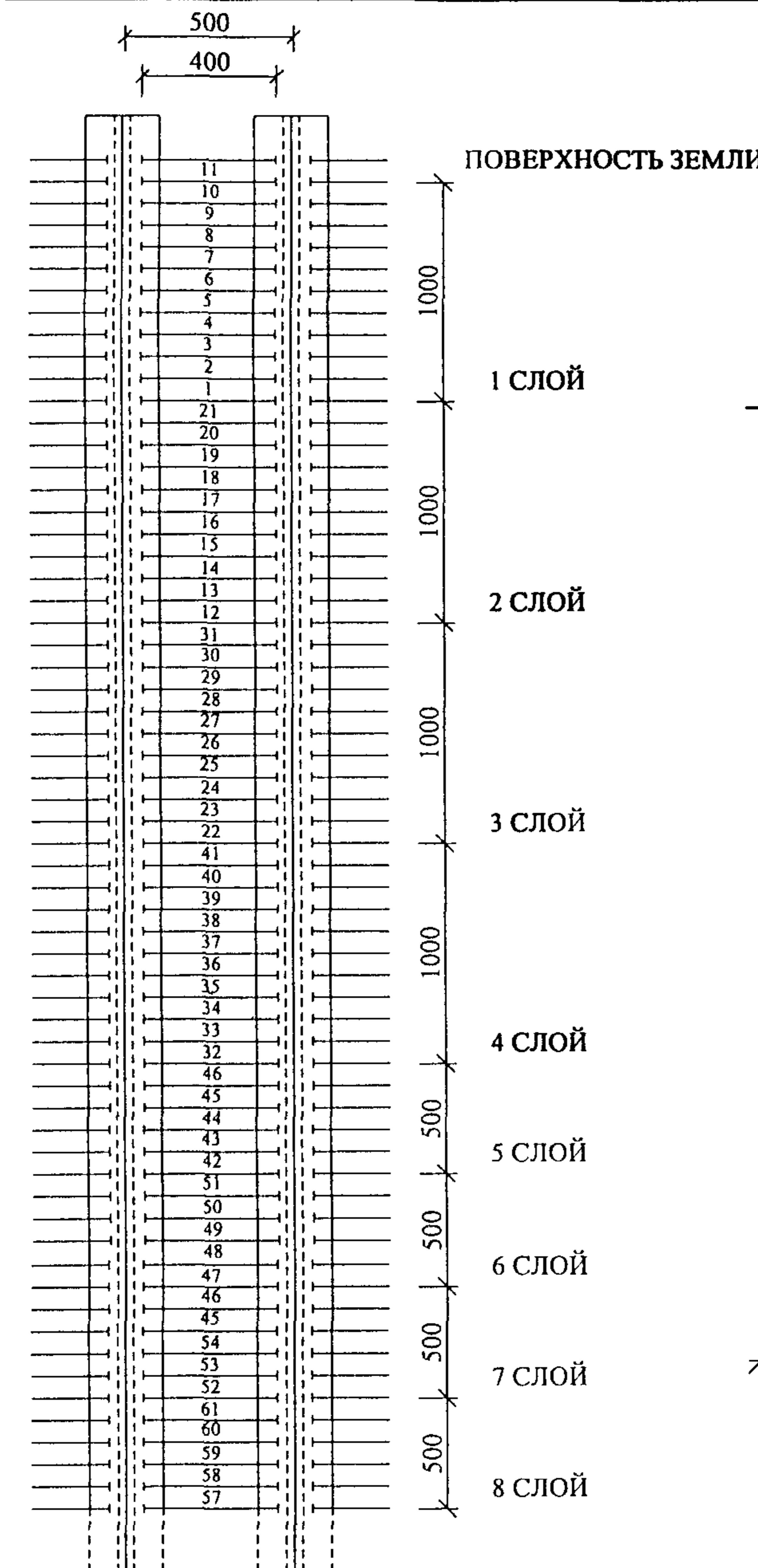
Рисунок 5 - Последовательность установки досок забирки
