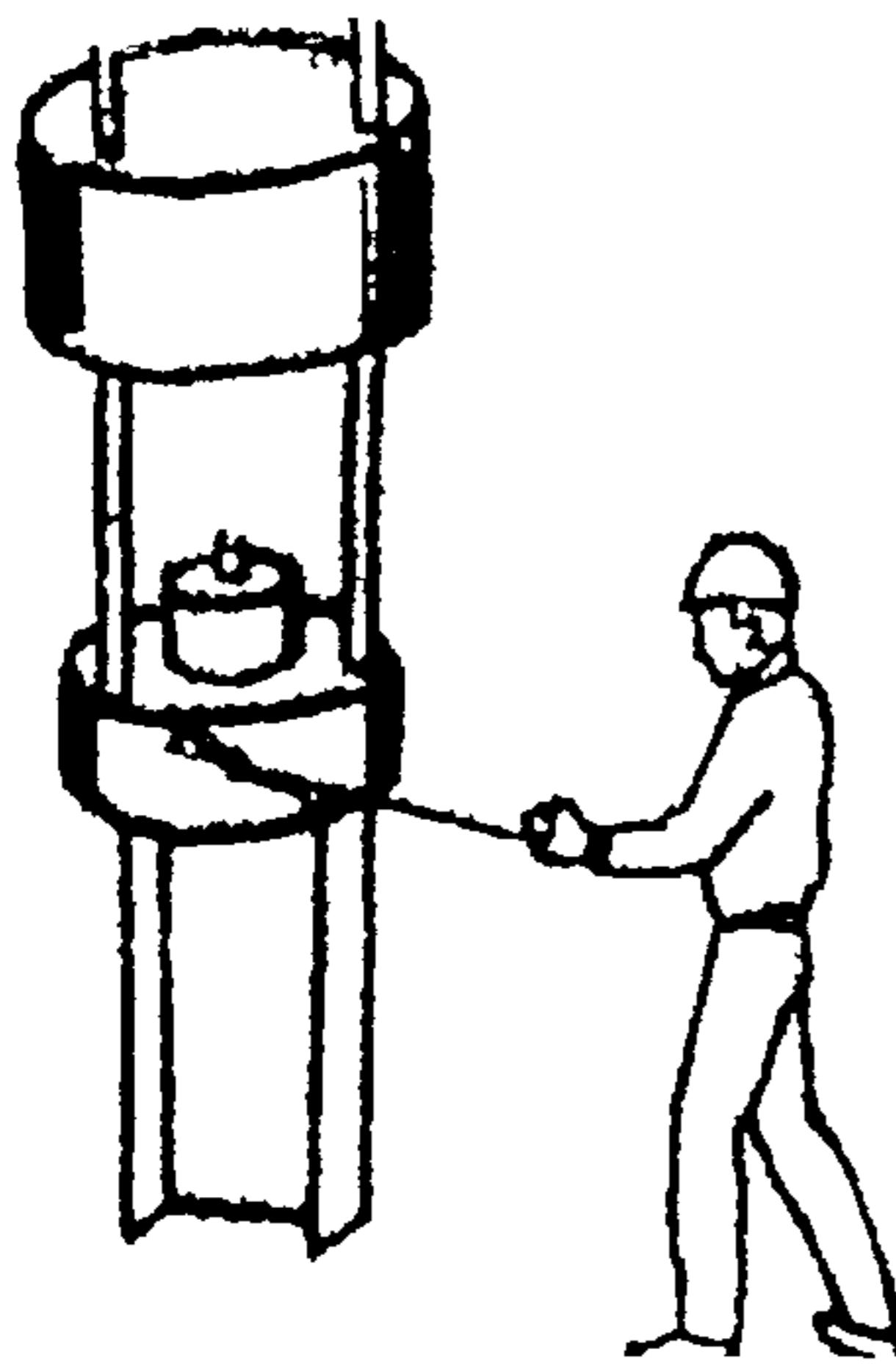
Машинист копровой установки по команде копровщика (К2) запускает дизель-молот при сбросе ударной части молота с высоты 0,6-0,8 м. Копровщик (К2) системой подачи топлива регулирует режим работы дизель-молота так, чтобы высота подскока его ударной части была 0,8-1,0 м. Копровщик (К1) следит за вертикальным положением забиваемой двутавровой балки
