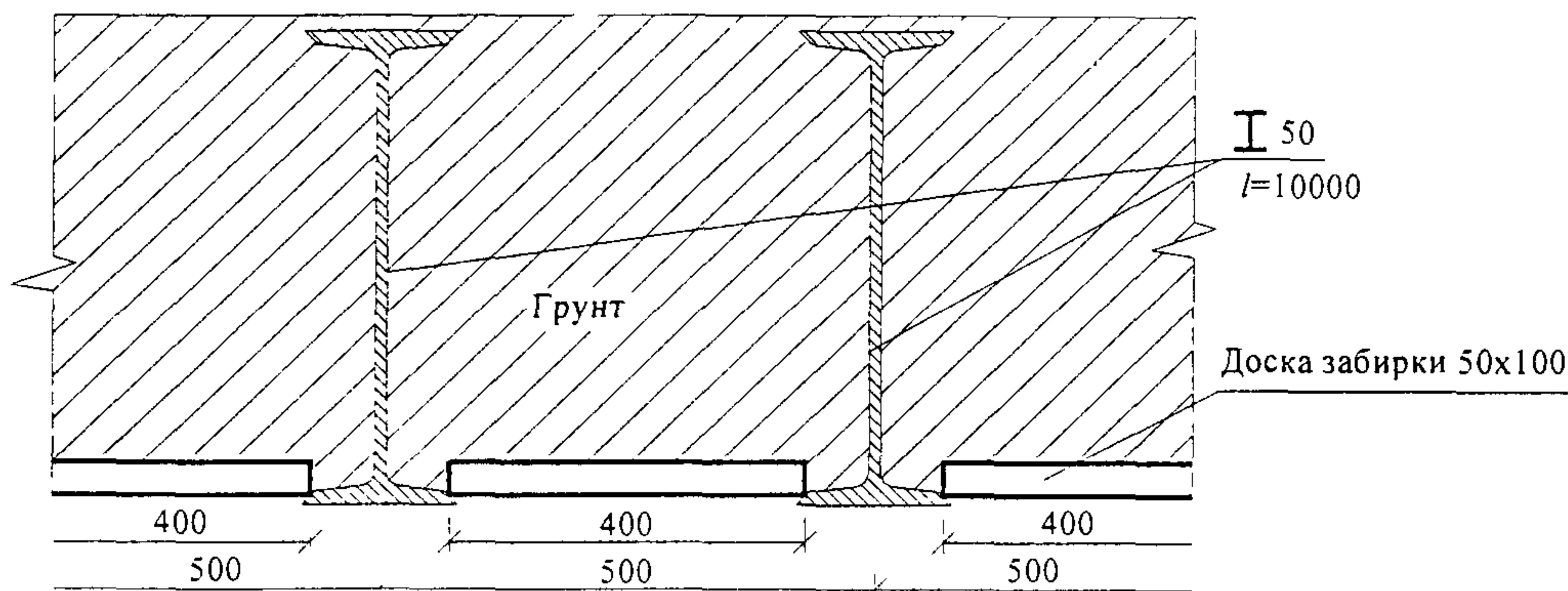
Рисунок 1 - Крепление стенок котлована с применением двутавровых балок
