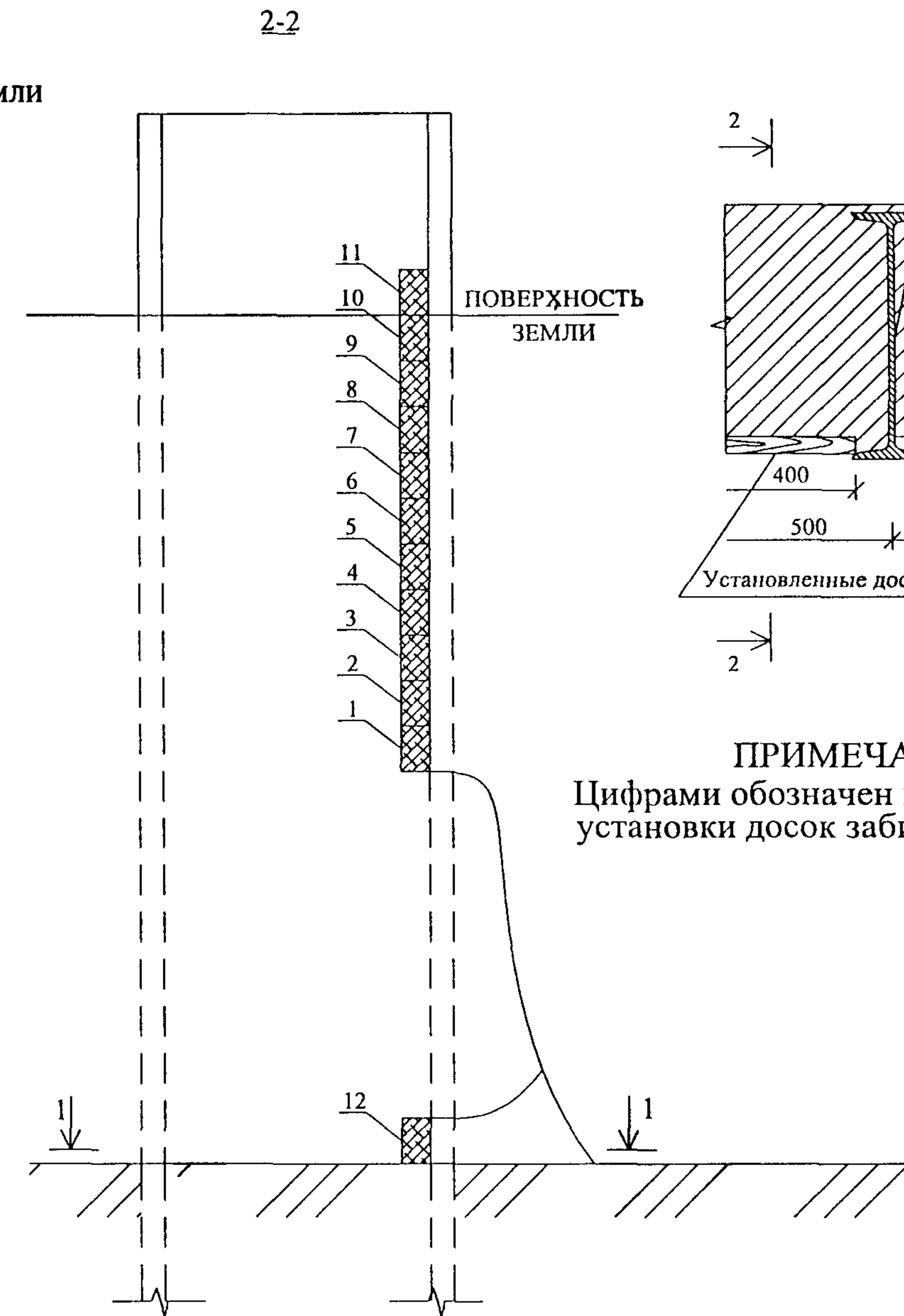
Рисунок 6 - Схема установки досок забирки
