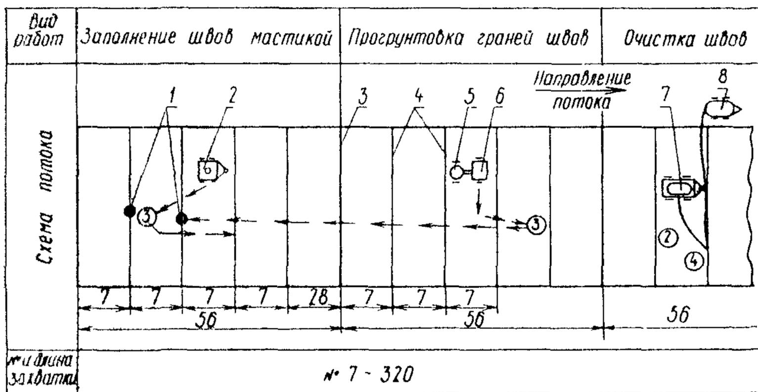
Рис. 14. Технологическая схема заполнения швов битумно-полимерной мастикой:
