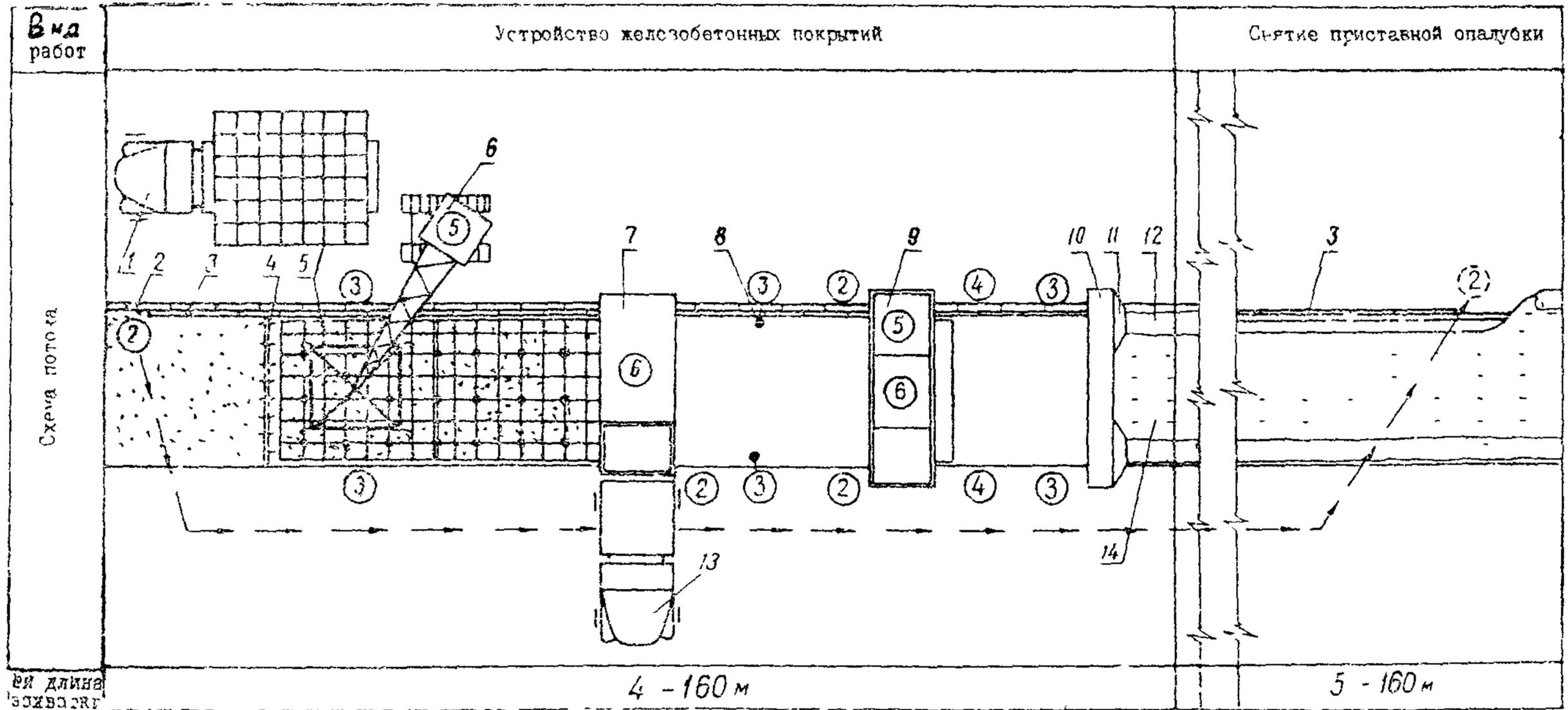
Рис 12 Технологическая схема устройства железобетонных покрытий
