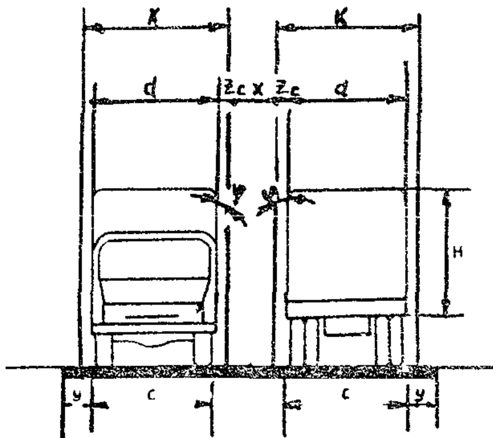
Рис.1. Расчетная схема назначения ширины проезжей части при движении седельных автопоездов
