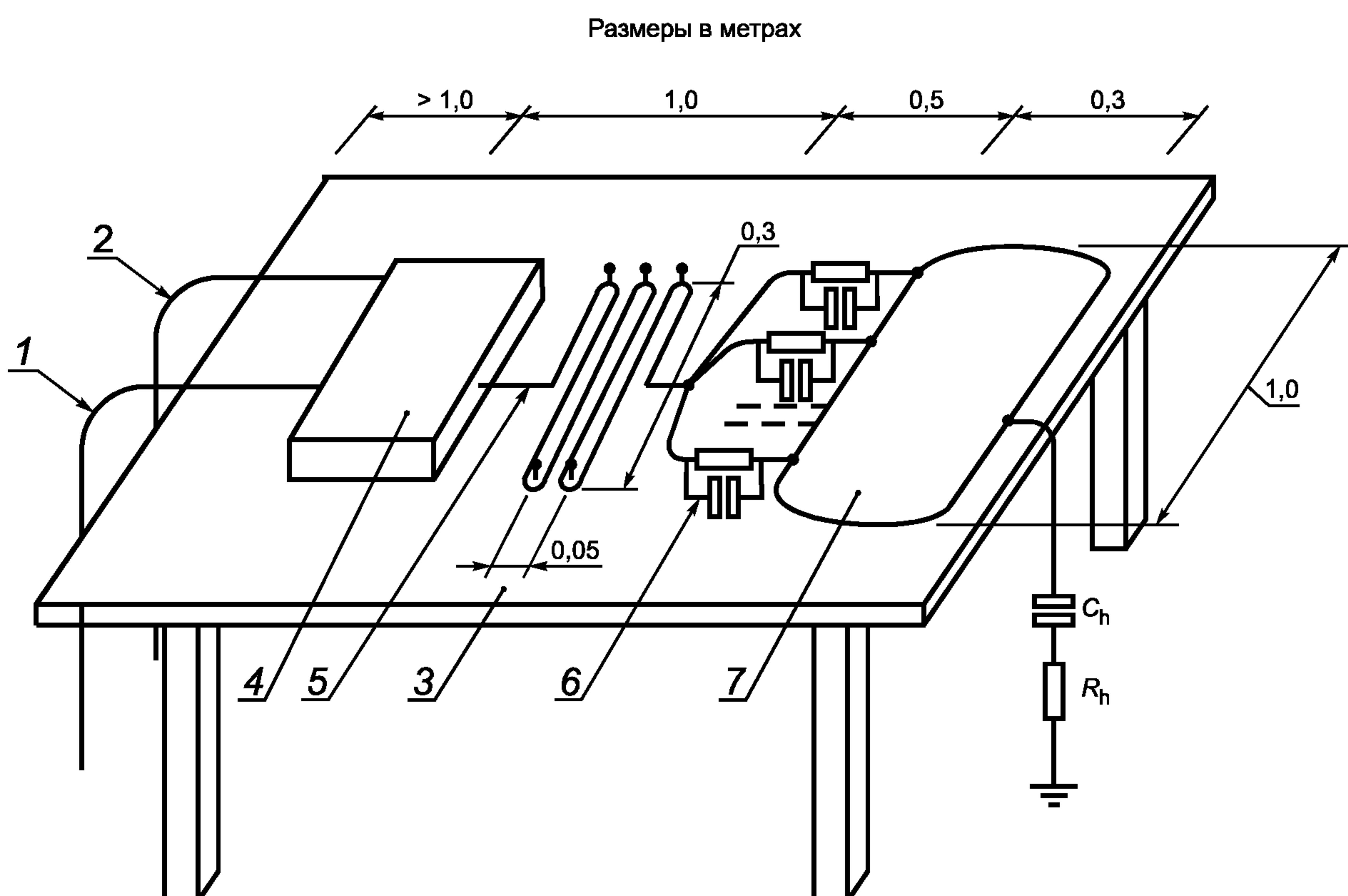
1 — ШНУР ПИТАНИЯ; 2 — сигнальный провод; 3 — стол, изготовленный из изолирующего материала;
