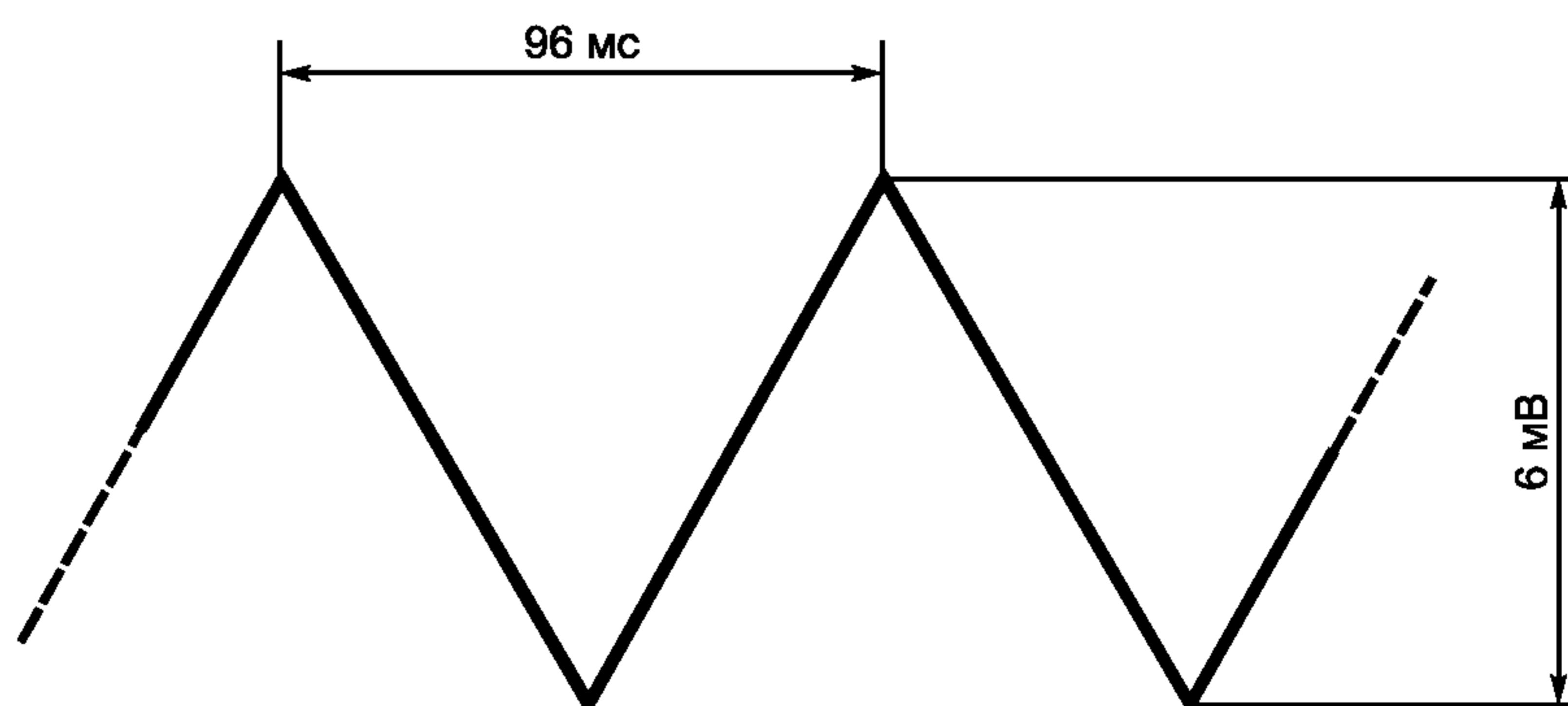
Рисунок 103 — Сигнал для испытания динамического диапазона входных сигналов (51.5.1)
