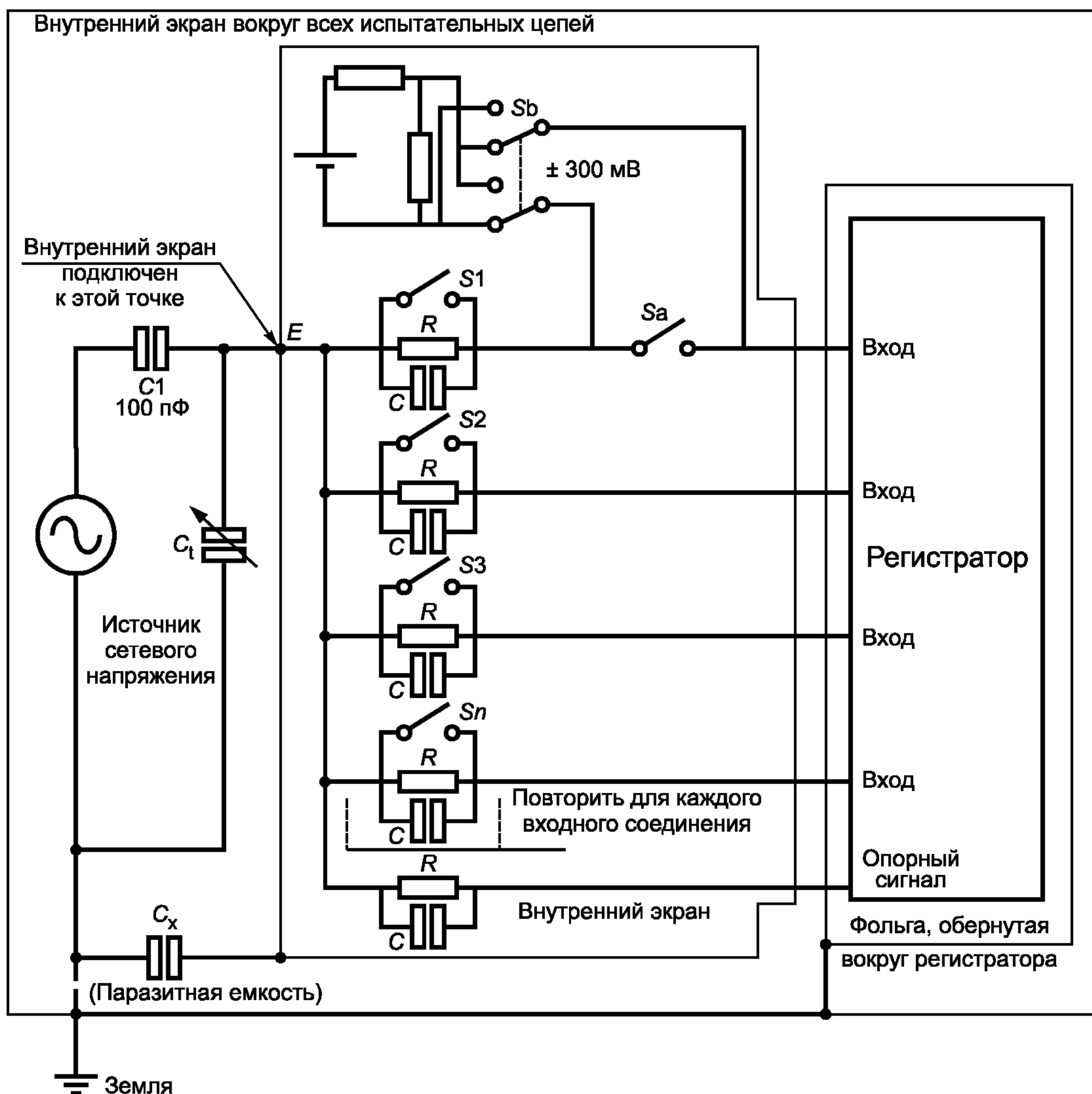
$R$  — сопротивление 51 кОм;  $C$  — конденсатор 47 нФ;  $C_t$  — регулируемый конденсатор
