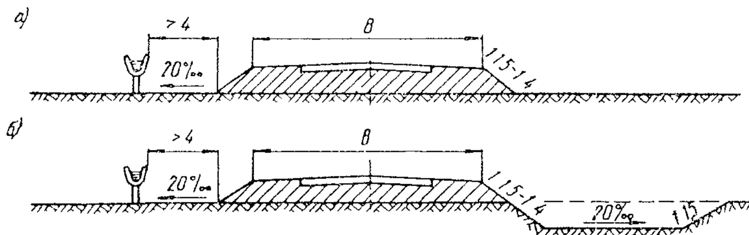
Рис. 2. Поперечные профили земляного полога, устраиваемого из привозных грунтов (а) и из боковых резервов (б) вдоль каналов из железобетонных лотков
