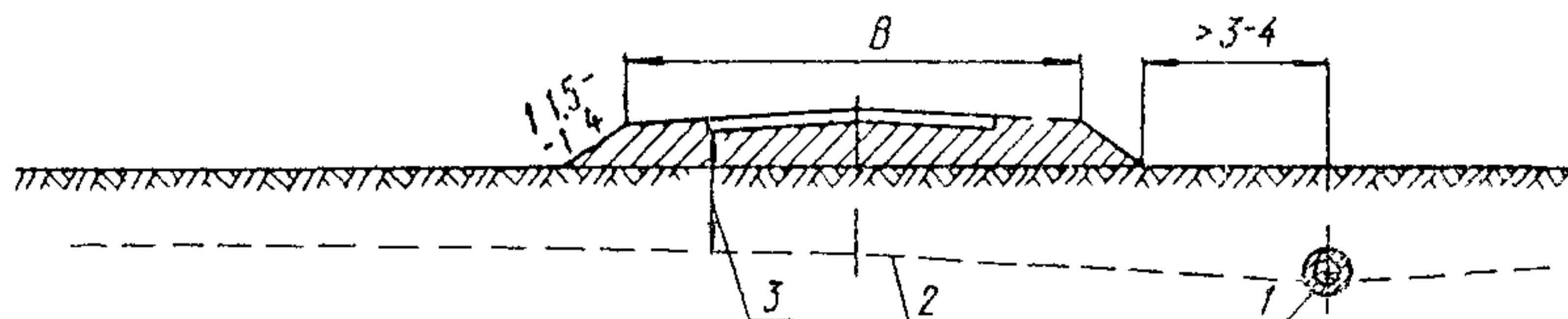
Рис. 1. Безрезервный поперечный профиль земляного полотна
