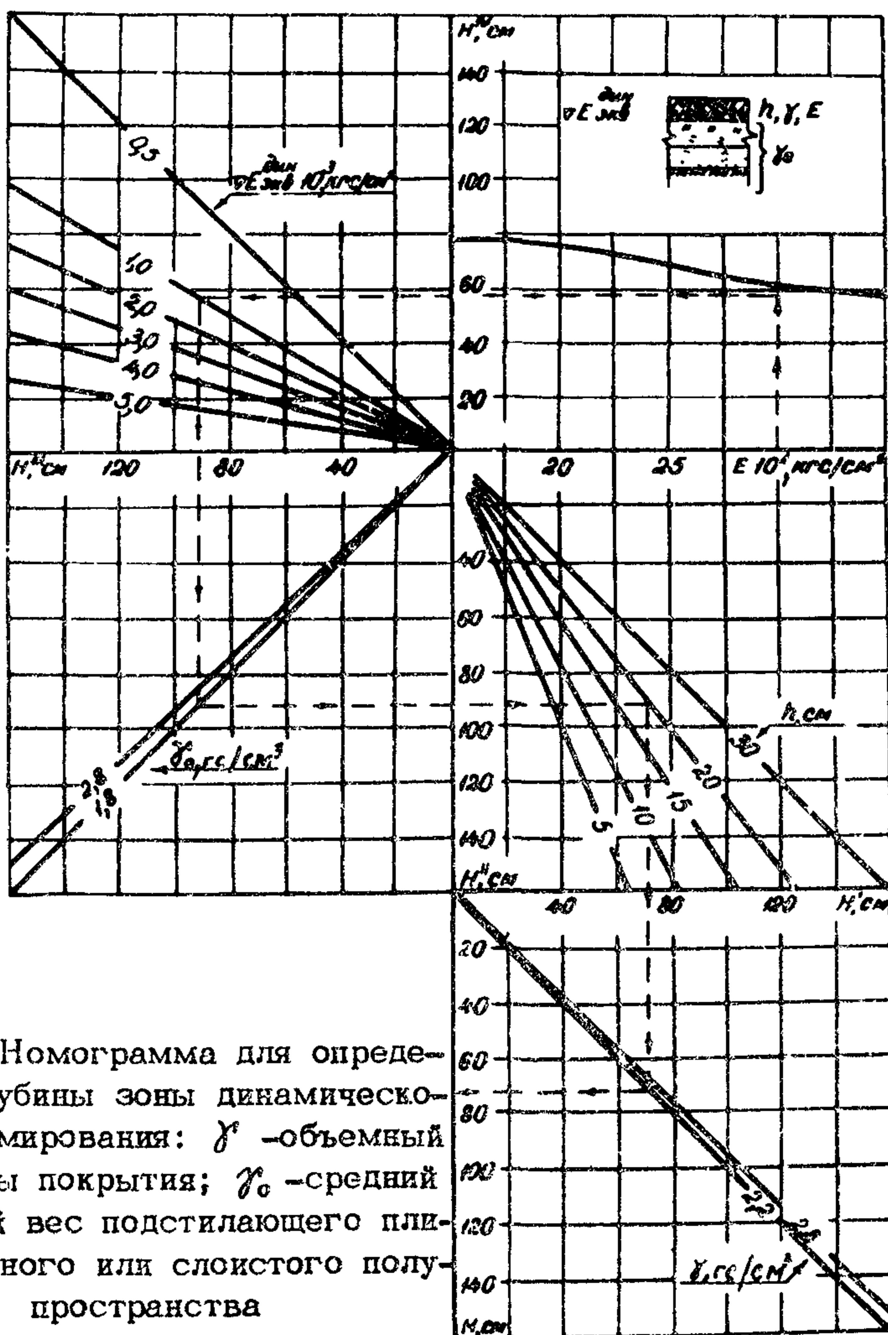
Рис.4.1. Номограмма для определения глубины зоны динамического деформирования:  $\gamma'$  - объемный вес плиты покрытия;  $\gamma_0$  - средний объемный вес подстилающего пли- ту сплошного или слоистого полу- пространства
