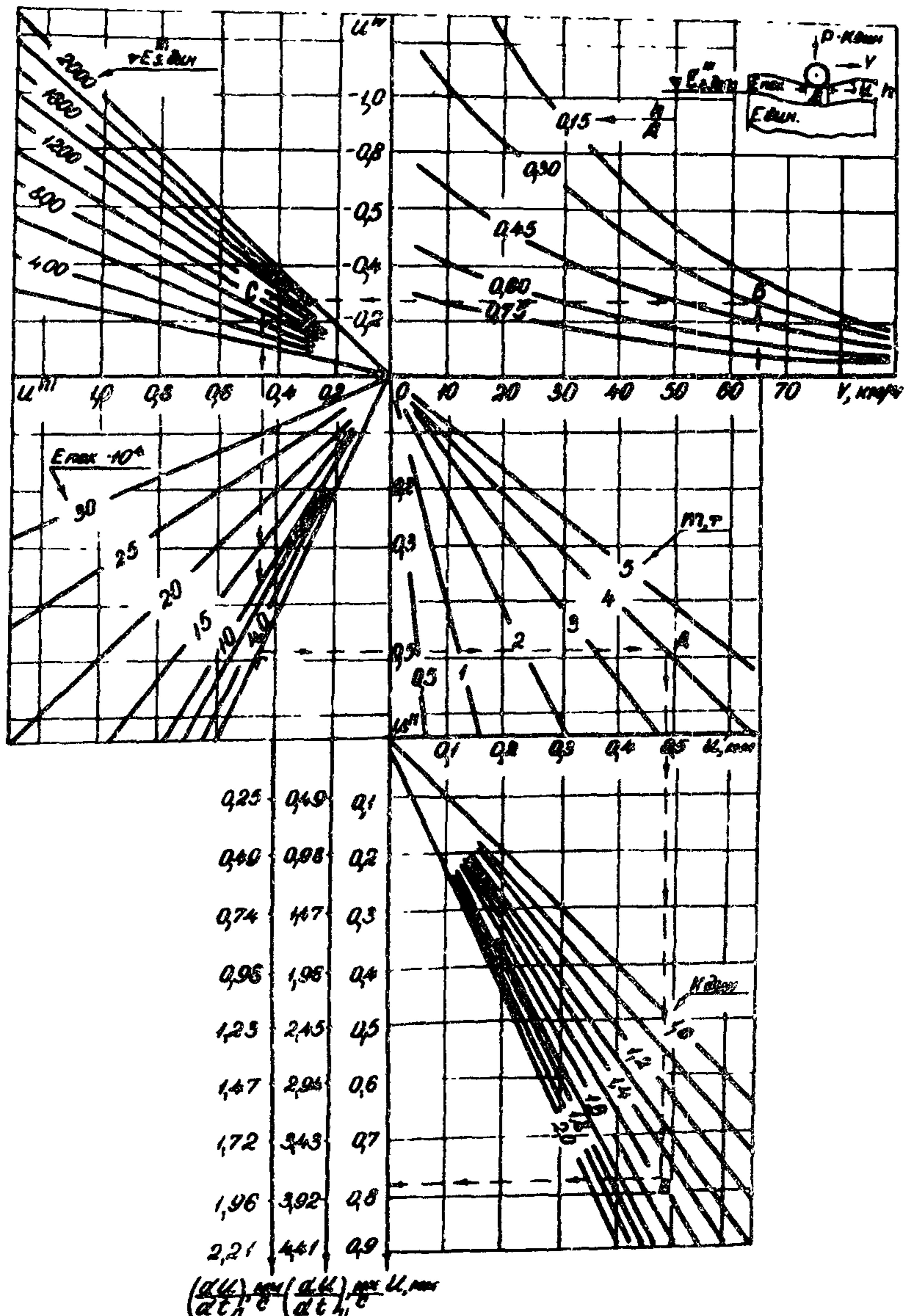
Рис.2. Номограмма для определения скоростей колебаний дорожных одежд: $(\frac{du}{dt})_I$  - жесткого типа;  $(\frac{du}{dt})_{II}$  - нежесткого типа
