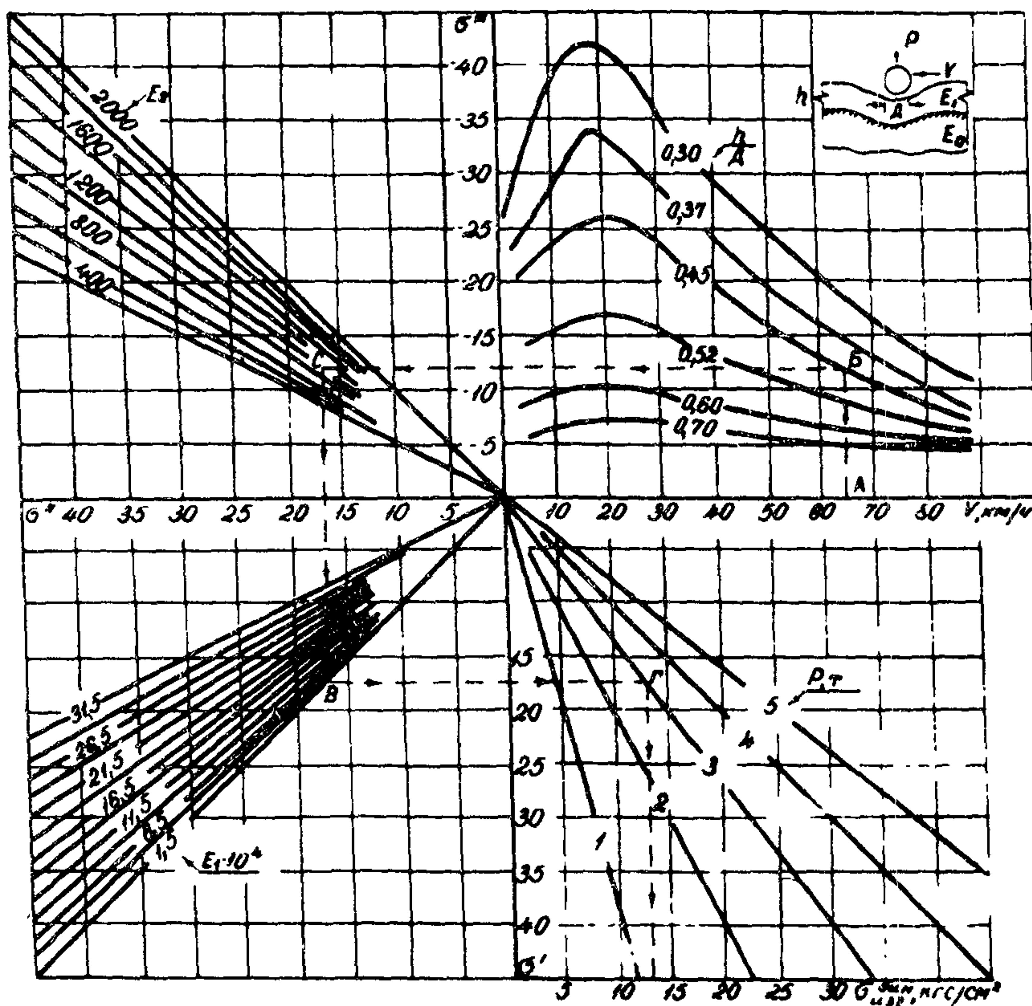
Рис.4.3. Номограмма для определения динамических изгибающих напряжений от подвижной нагрузки
