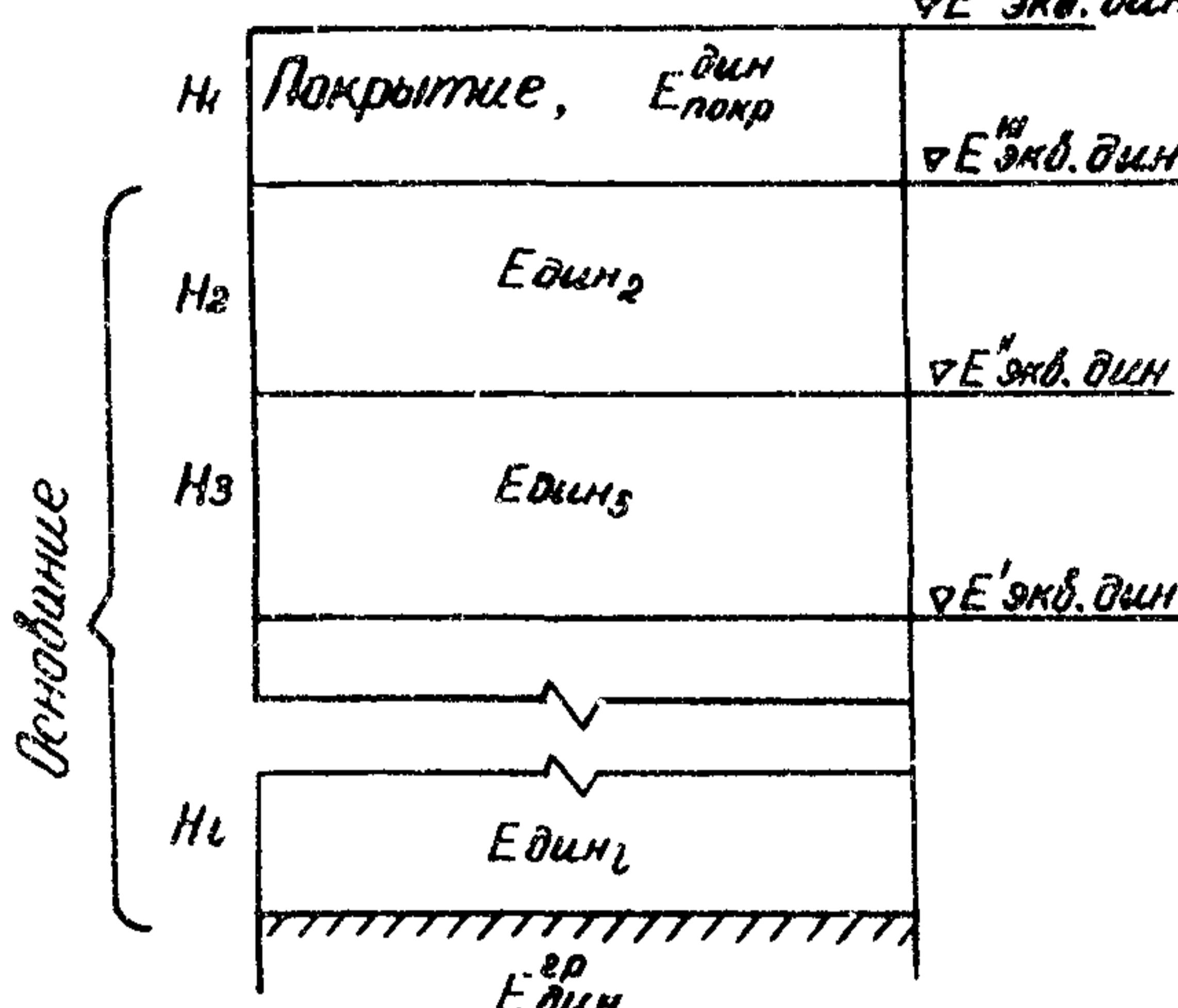
Рис.1. Схема для определения эквивалентного динамического модуля упругости основания
