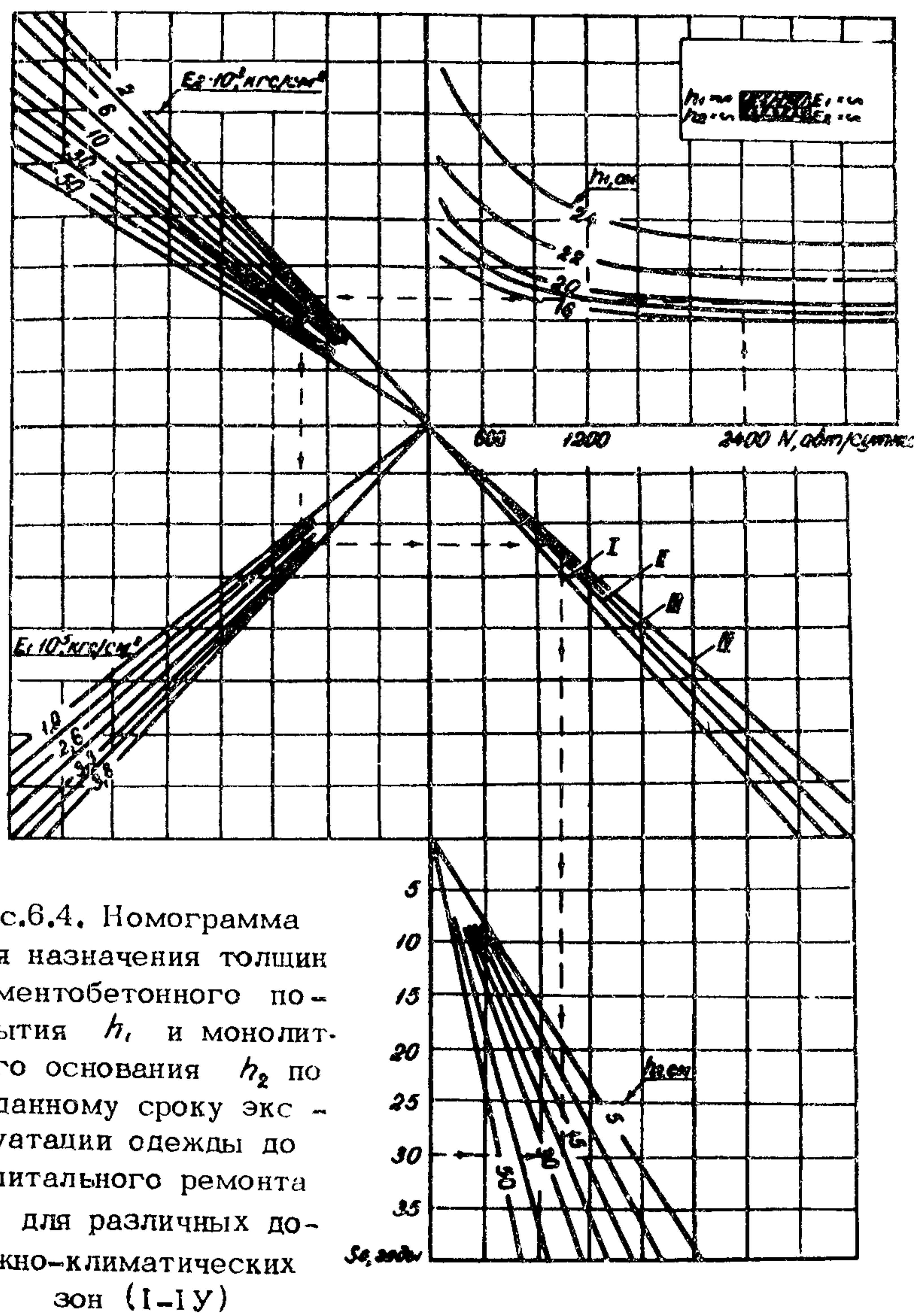
Рис.6.4. Номограмма для назначения толщин цементобетонного покрытия  $h_1$  и монолитного основания  $h_2$  по заданному сроку эксплуатации одежды до капитального ремонта  $S_0$  для различных дорожно-климатических зон (I-IY)
