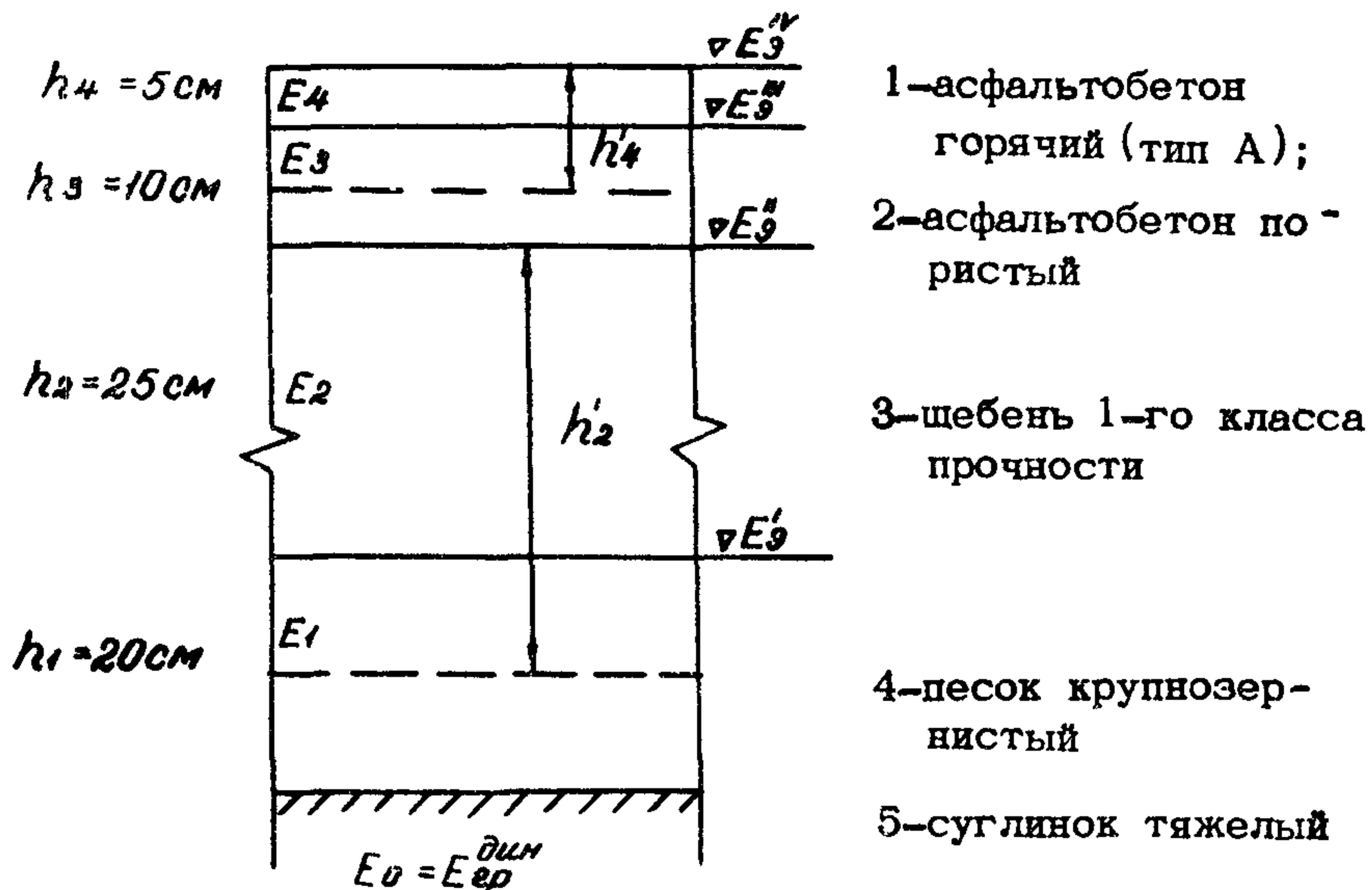
3. Определяем длительность работы дорожной одежды на талом основании. Для этого сначала устанавливаем дату перехода температуры воздуха через  $0^\circ \text{C}$  (14/1У и 18/X). Тогда длительность теплого периода  $T^{>0^\circ\text{C}} = 182$  дня. Длительность работы дорожной одежды в году на талом основании по п.2.6 "Методических рекомендаций"
