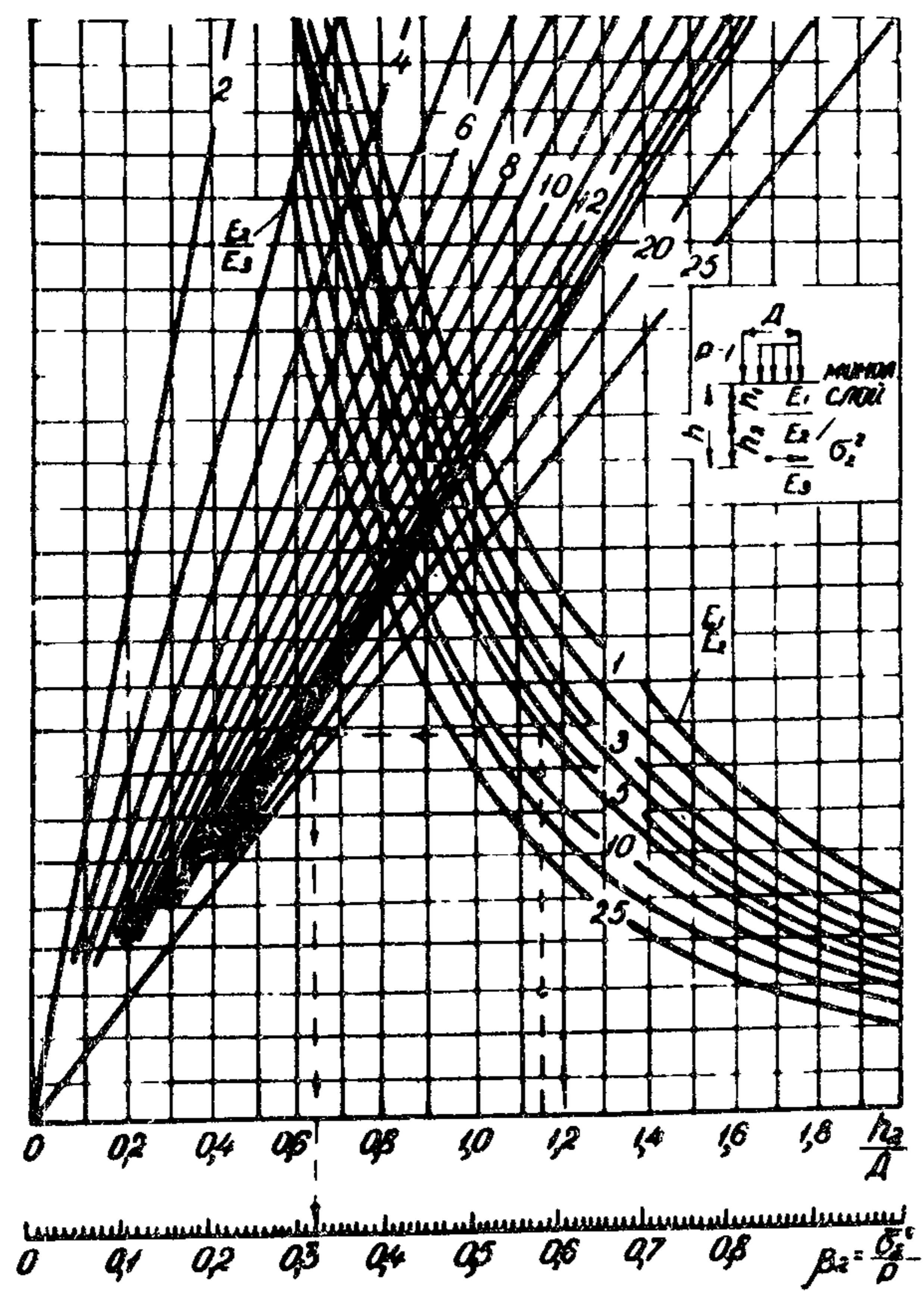
Рис.4.4. Номограмма для определения функции  $\beta_2$
