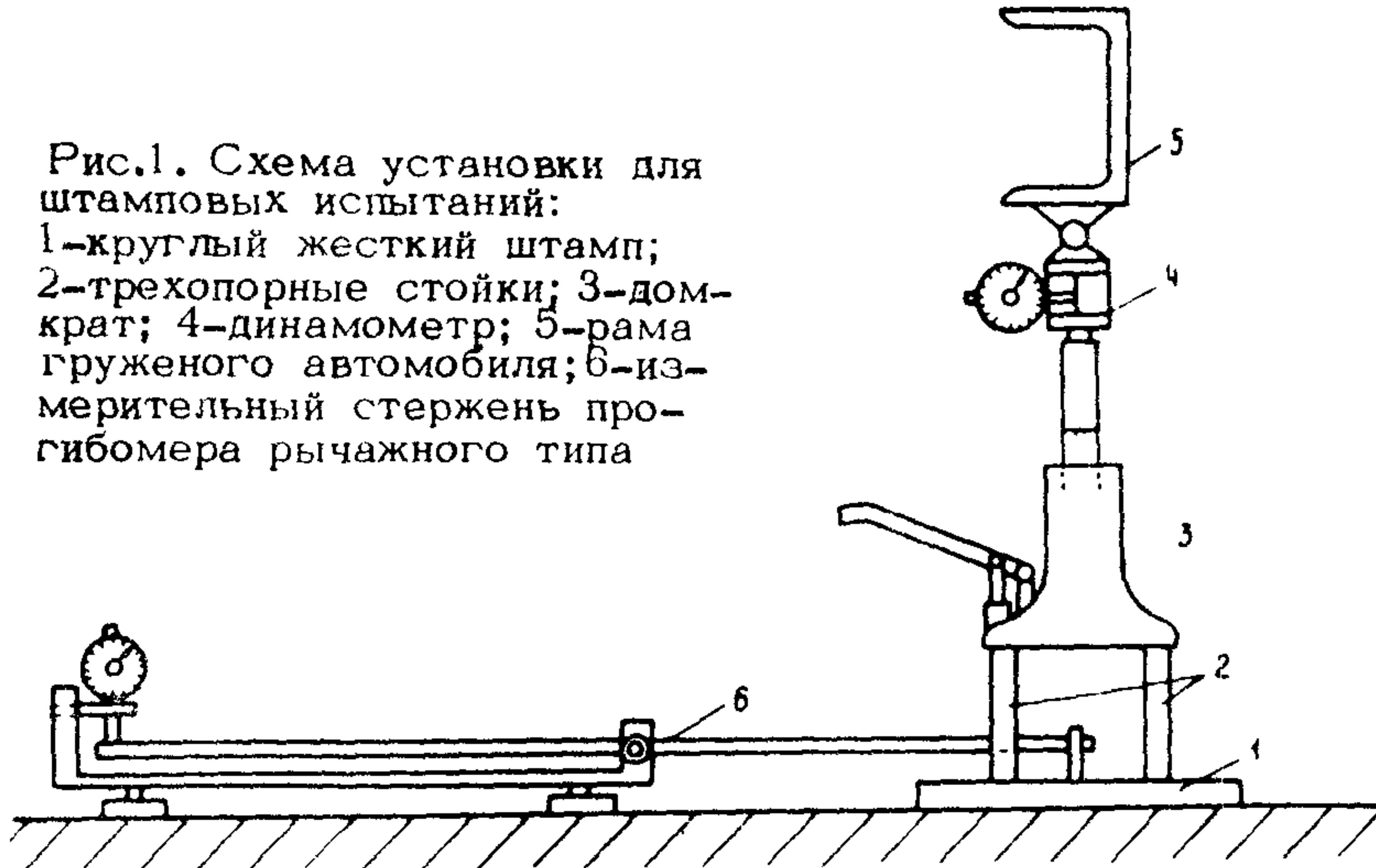
Нагрузка на поверхность испытуемой конструкции передается через круглый жесткий штамп (1) и домкрат (3), упираемый в раму груженого автомобиля (5). Величина нагрузки на штамп измеряется с помощью механического динамометра (4). Домкрат устанавливается соосно на трехпорных стойках (2).
