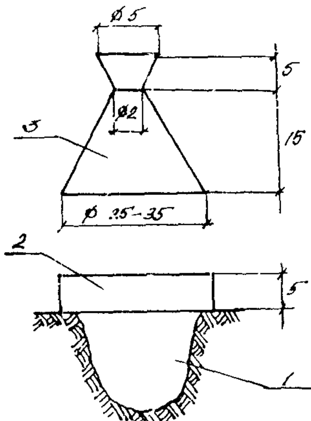
Определение плотности свежеуложенного бетона методом засыпки лунки песком:
