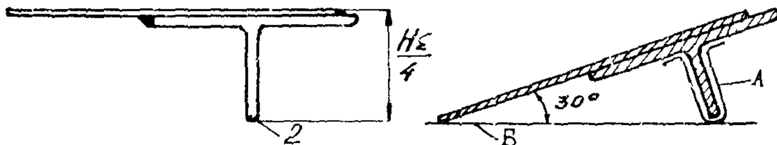
Шаблон для устройства швов в свежеуложенном бетоне
