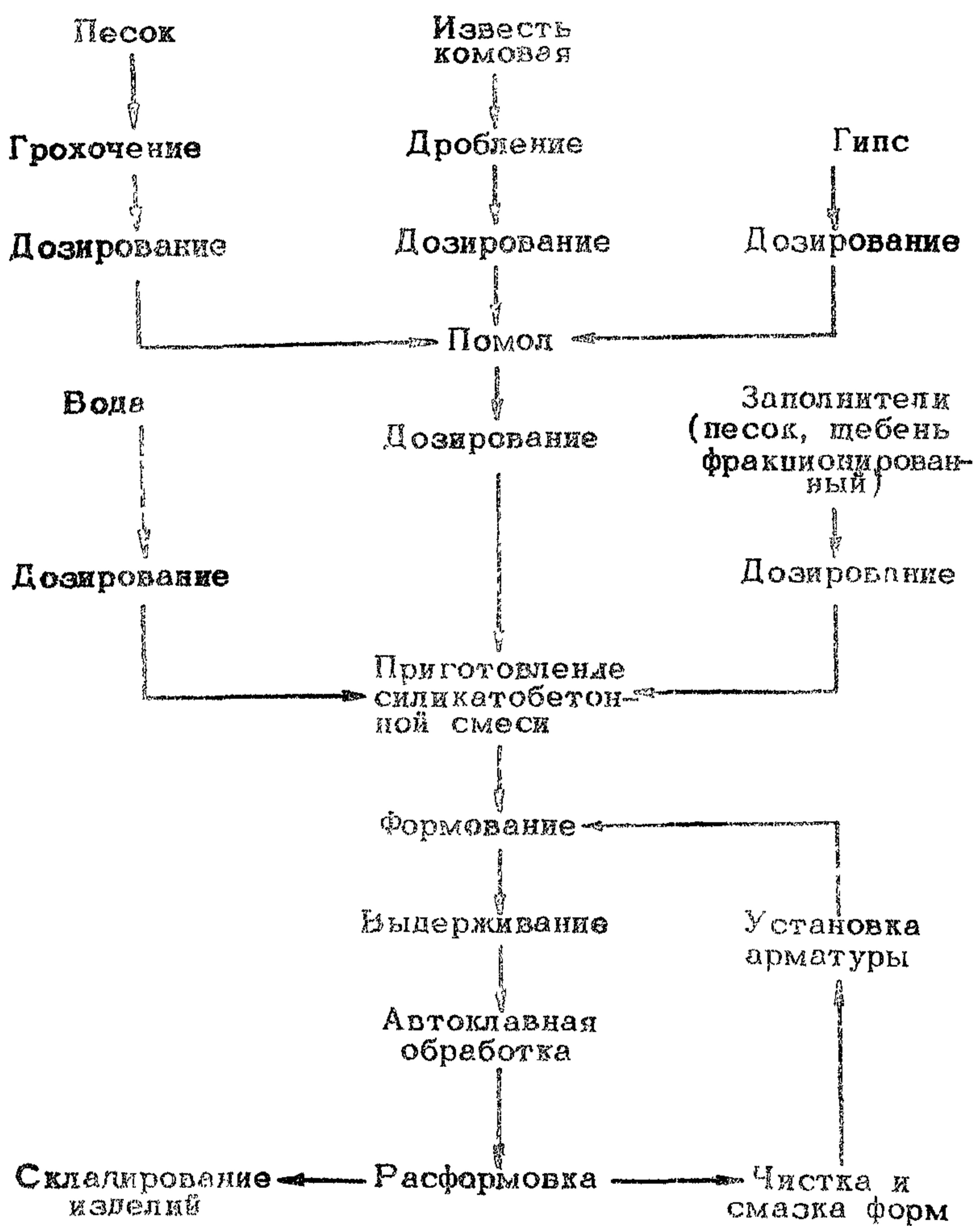
Рис.1. Технологическая схема производства дорожных изделий кипелочным способом
