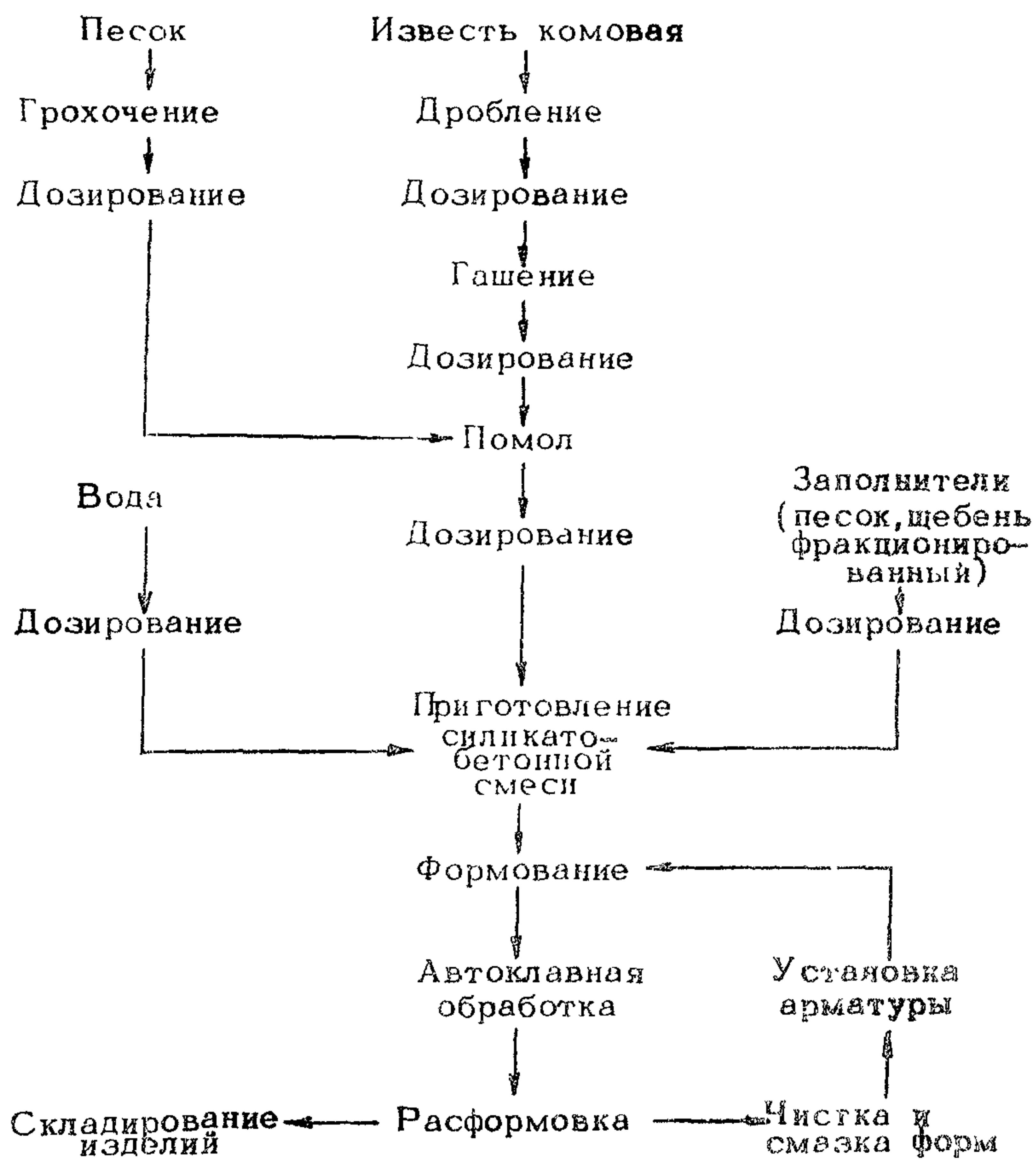
Рис. 2. Технологическая схема производства дорожных изделий гидратным способом
