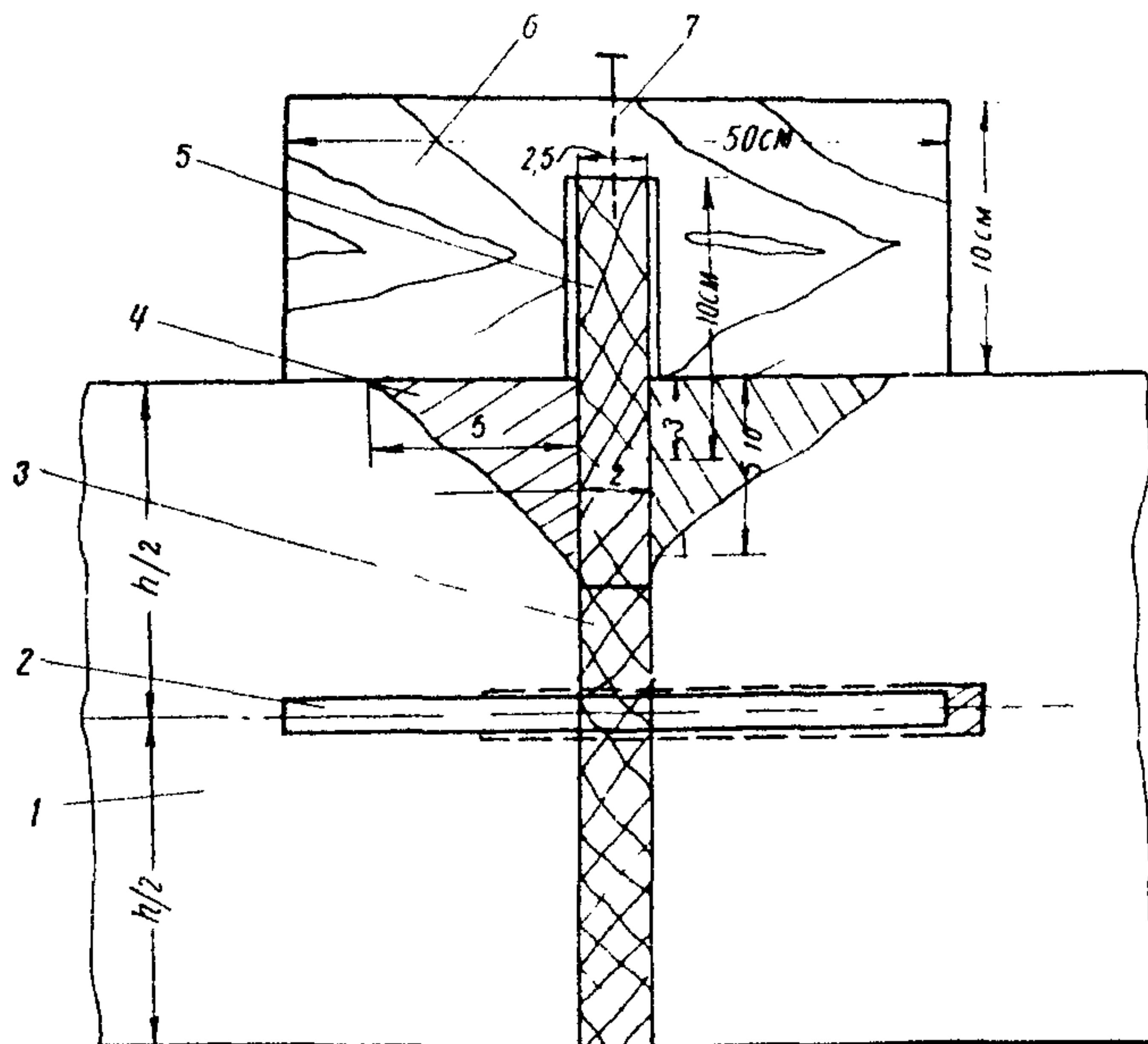
Рис.1. Схема ремонта шва расширения цементобетонного покрытия:
