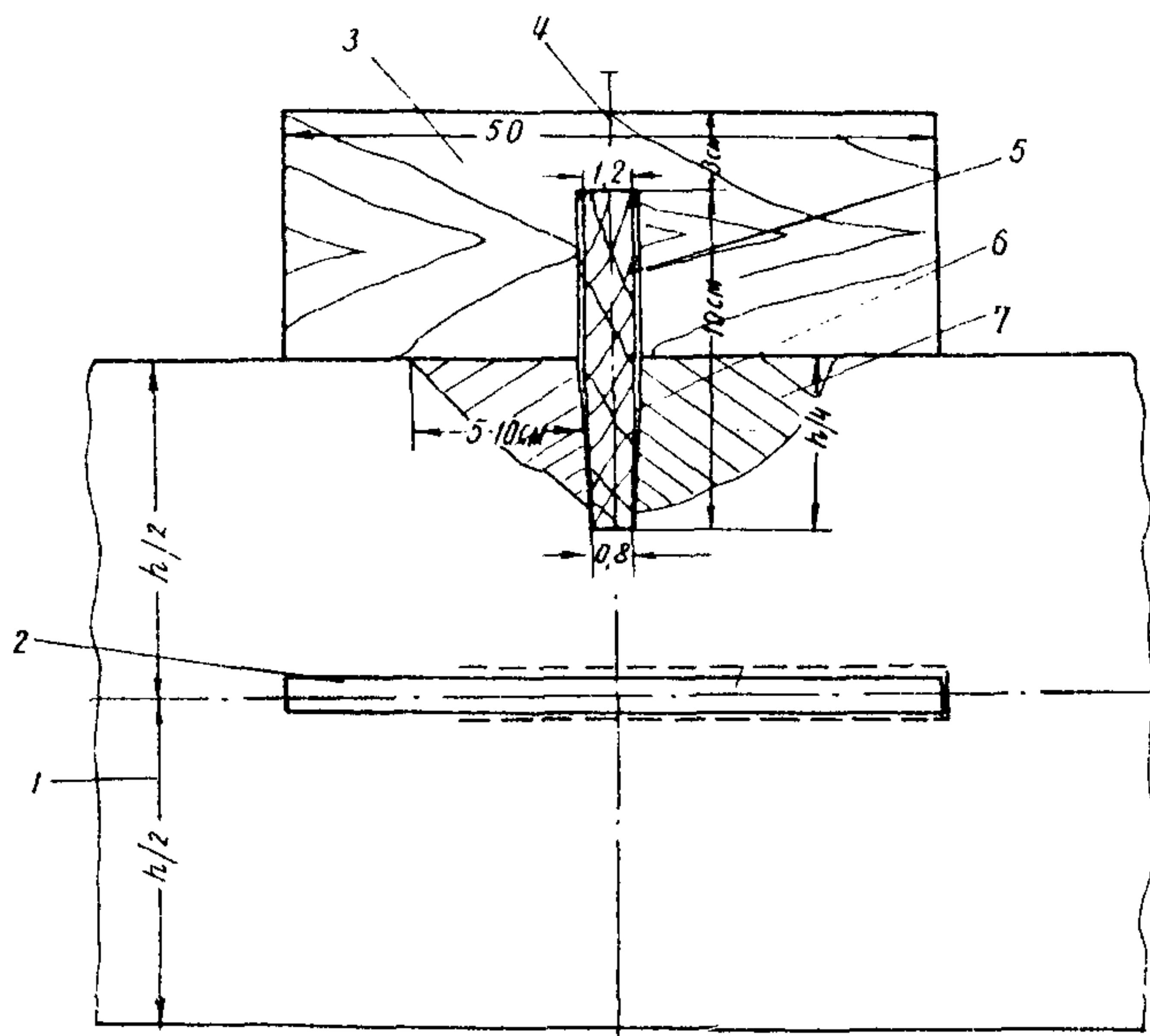
Рис.2. Схема ремонта шва сжатия цементобетонного покрытия:
