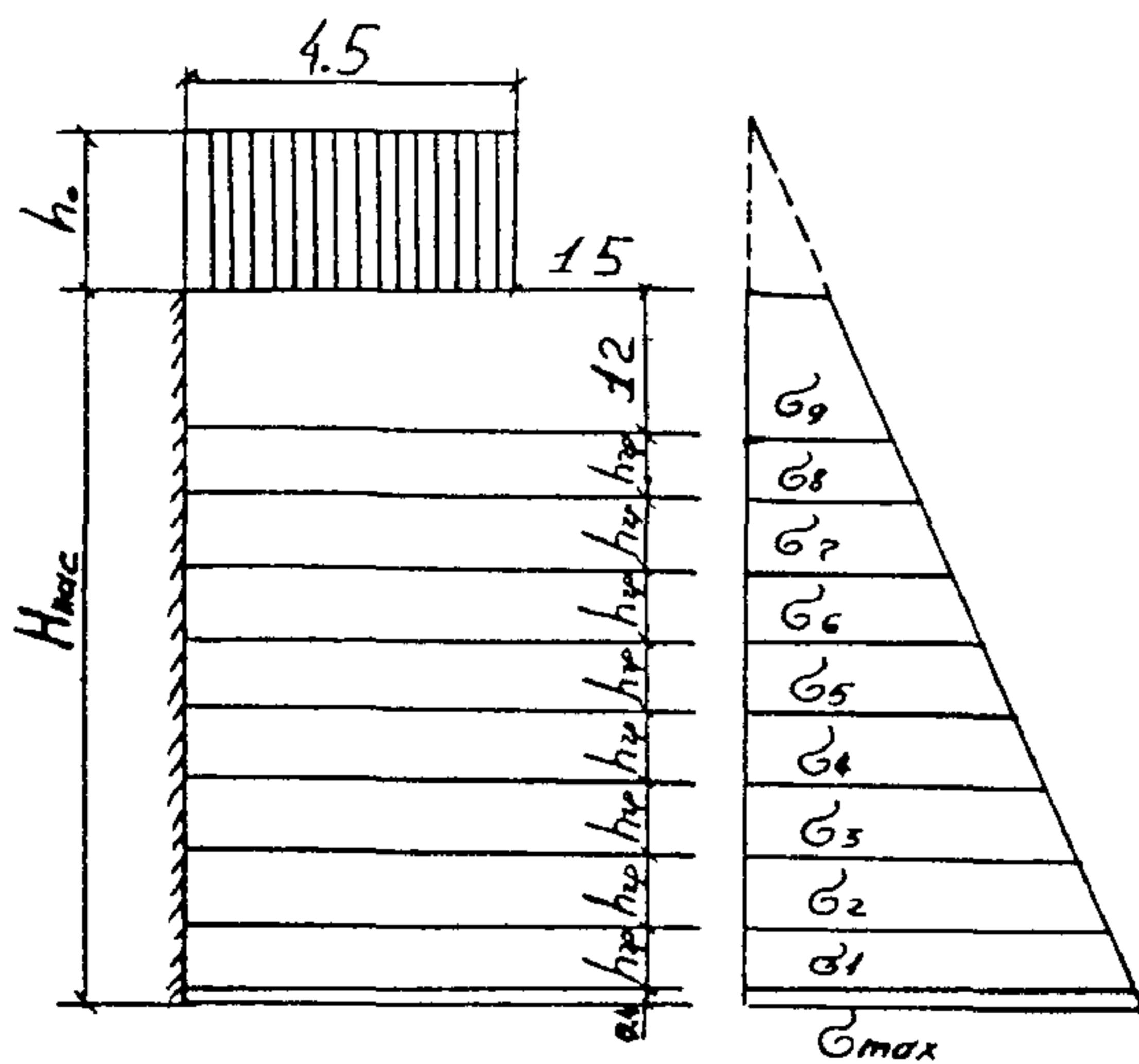
Рис. 3.4. Эпюра распределения горизонтальных усилий по армирующим горизонтам
