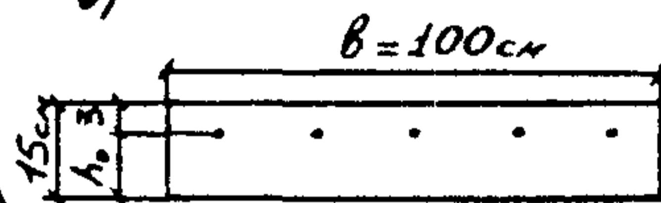
Рис. 3.6. К расчету прочности блока подпорной стенки на изгиб:
