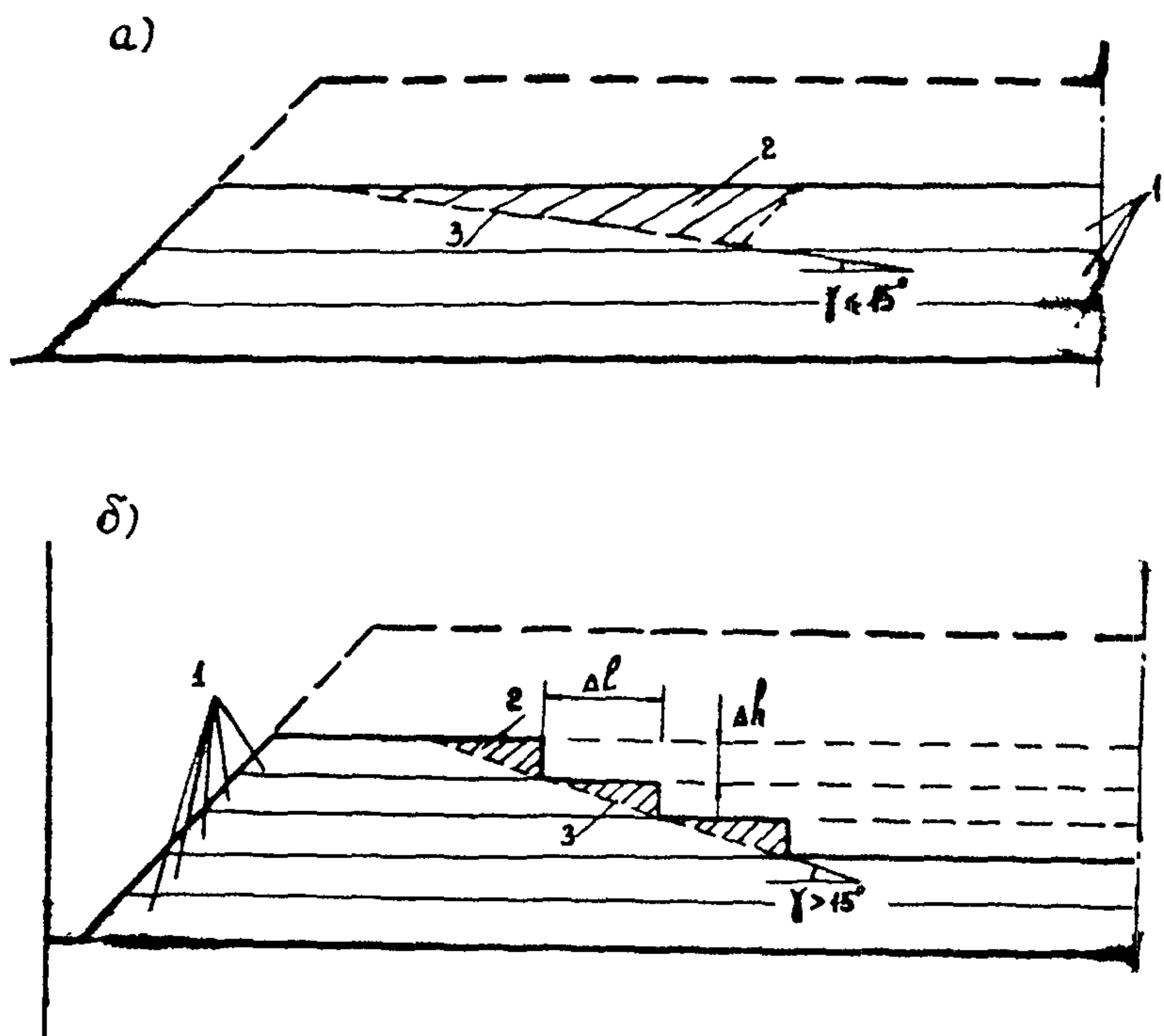
Рис. 2.4. Способы подготовки основания под укладку арматуры (а - срезкой; б - отсыпкой):
