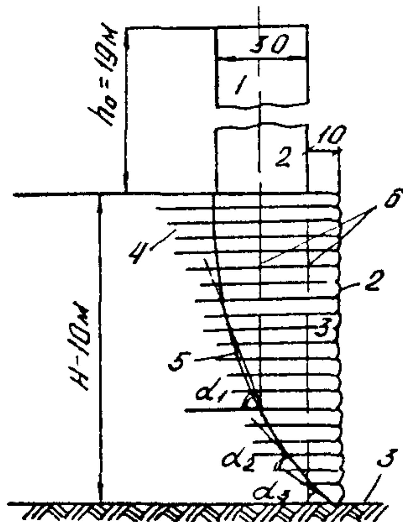
Рис. 2. К примеру расчета общей устойчивости армогрунтового откоса диванного типа:
