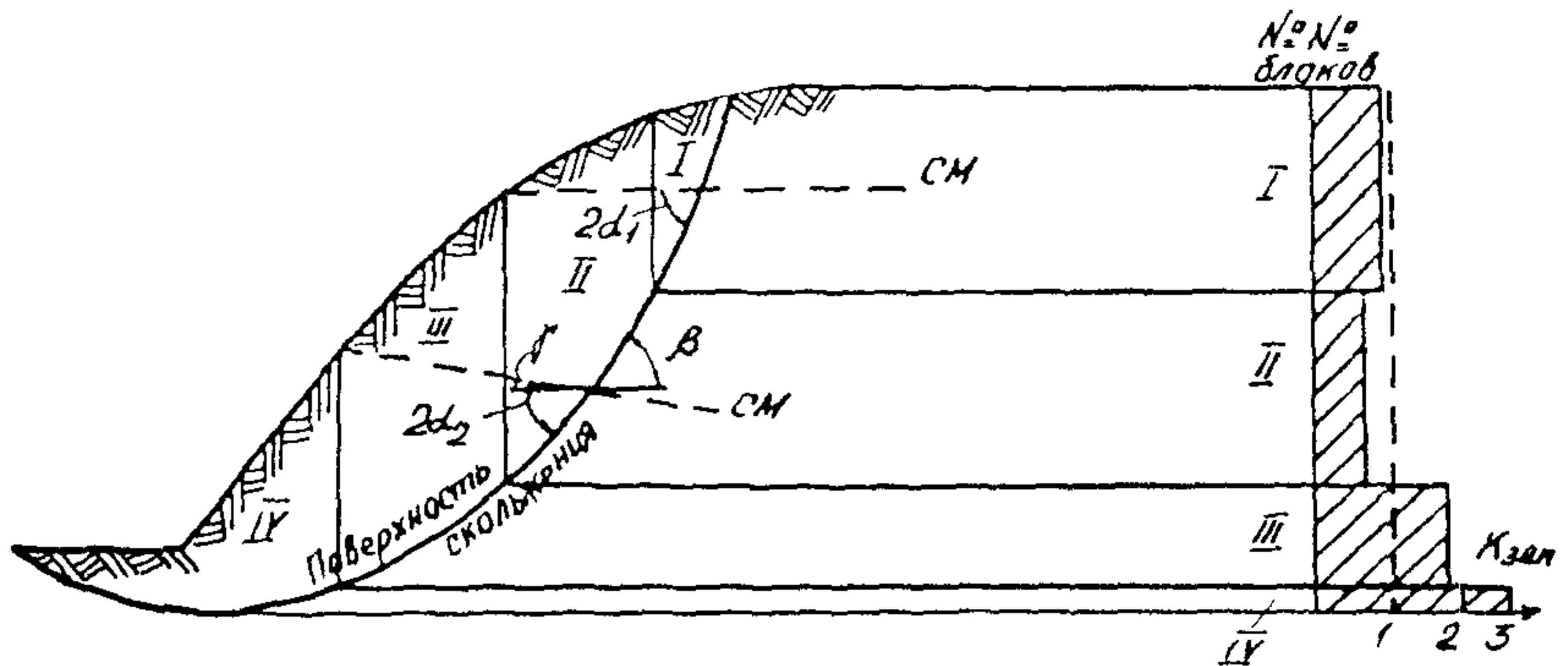
Рис. 2.3. Схема к расчету армированного откоса
