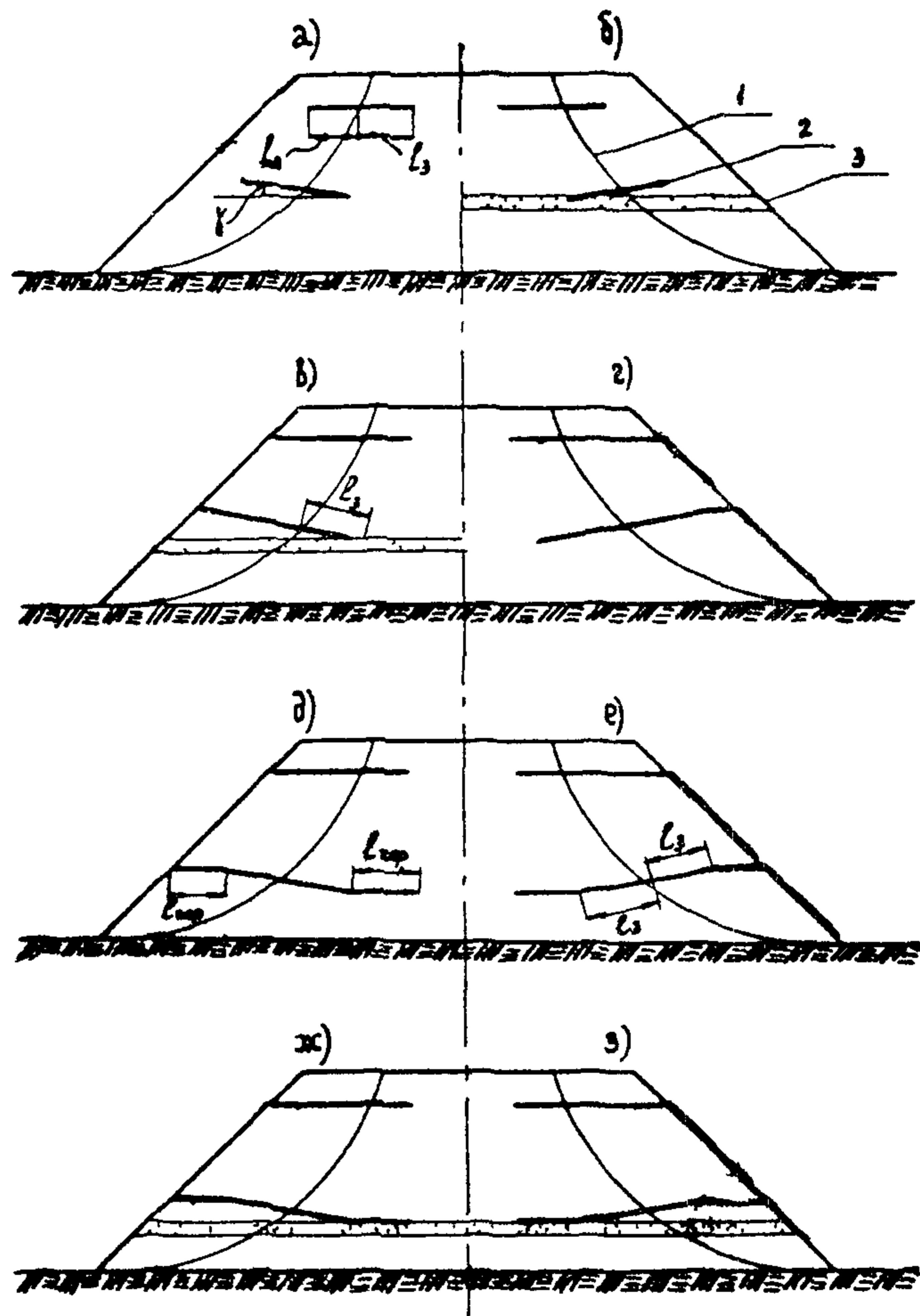
Рис. 2.1. Конструкция насыпей, армированных прослойками синтетических материалов:
