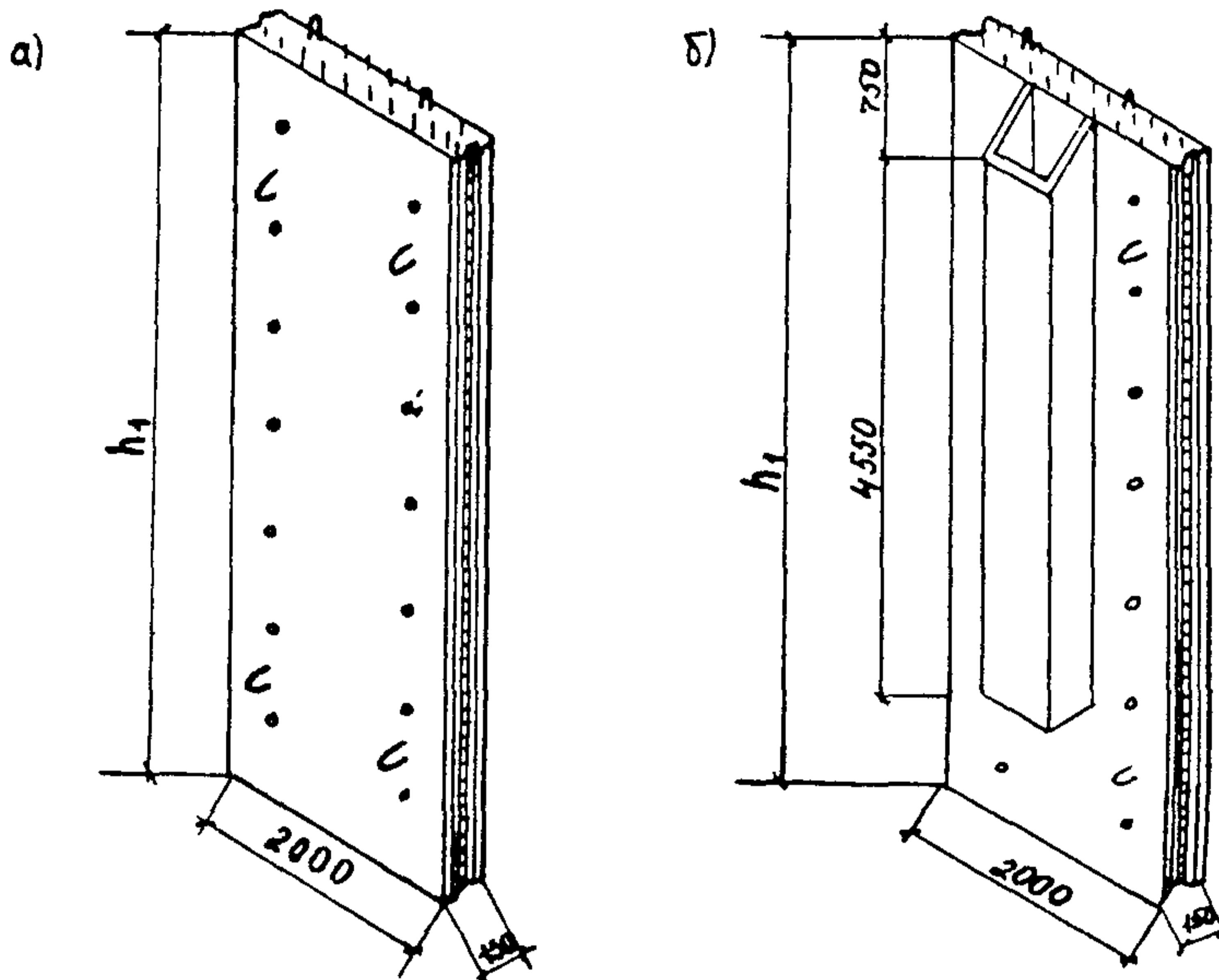
Рис. 3.3. Конструкция блоков подпорной стенки:
