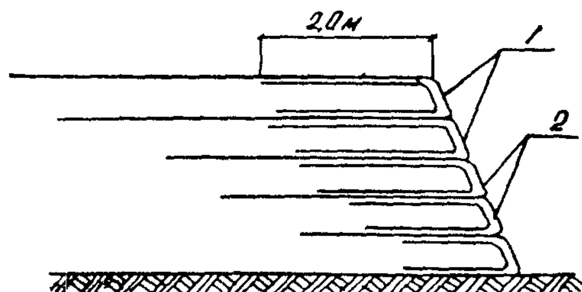
Рис. 4.2. Защита торцевых частей конструктивных слоев дорнитом:
