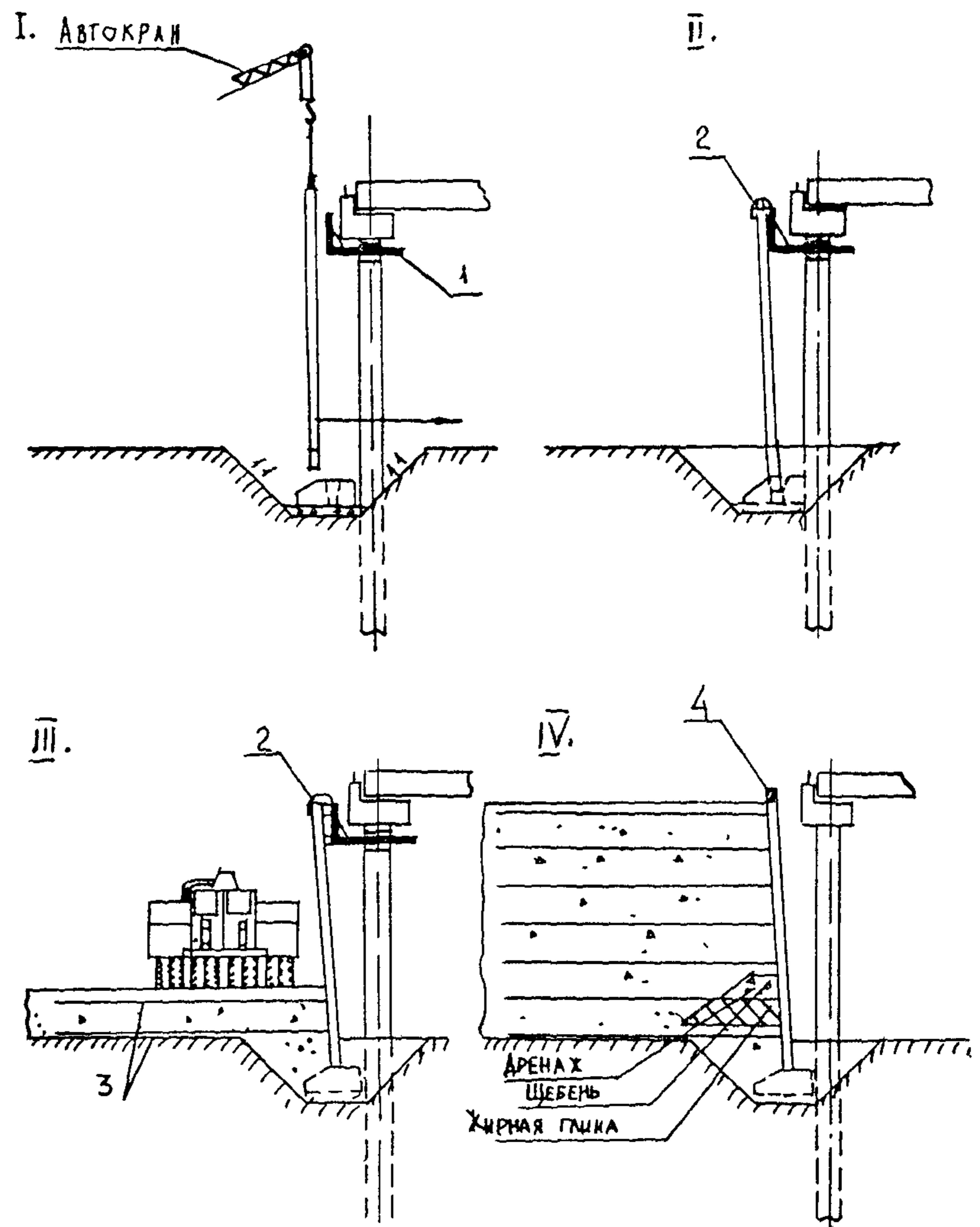
Рис. 3.8. Стадии строительства подпорных стенок:
