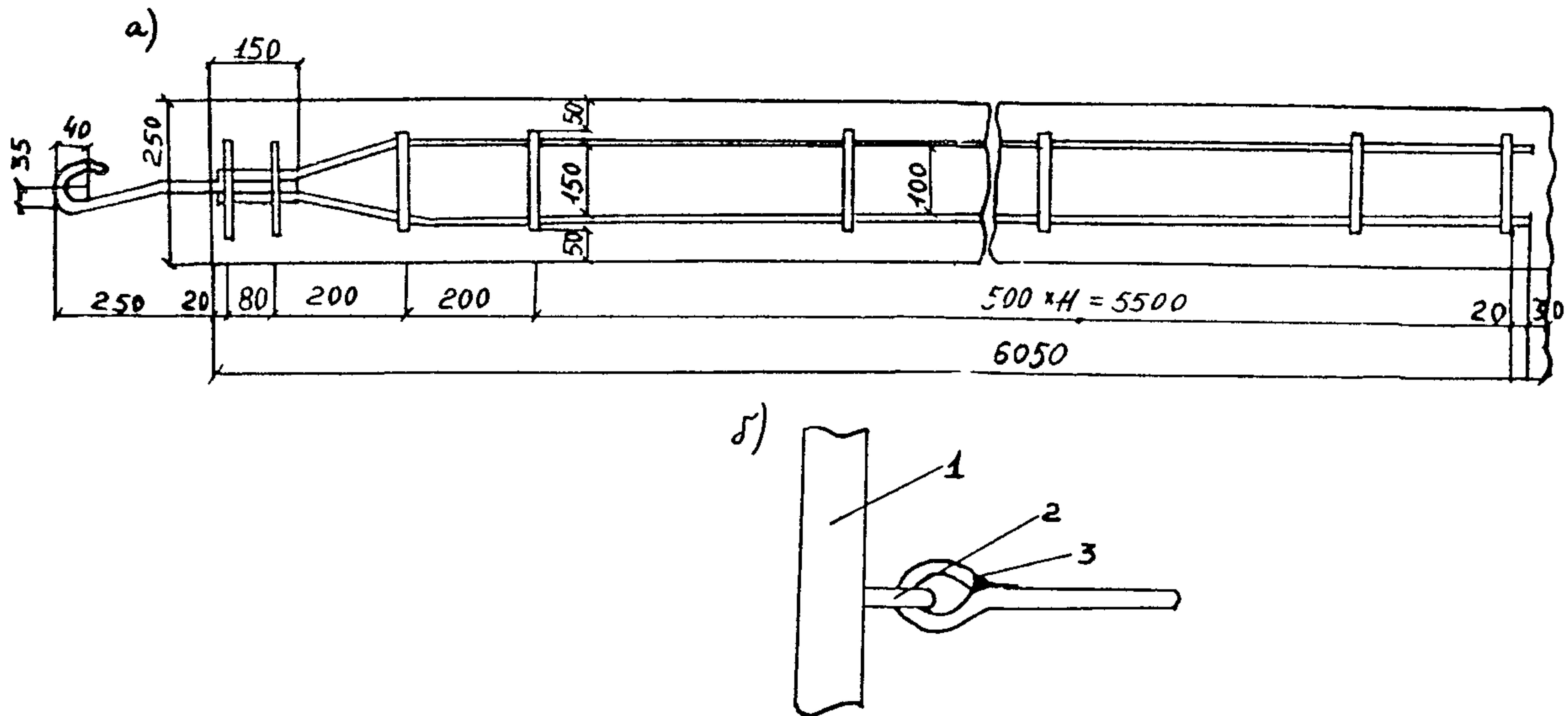
Рис. 3.2. Конструкция армирующей ленты и ее прикрепления к блоку подпорной стенки:
