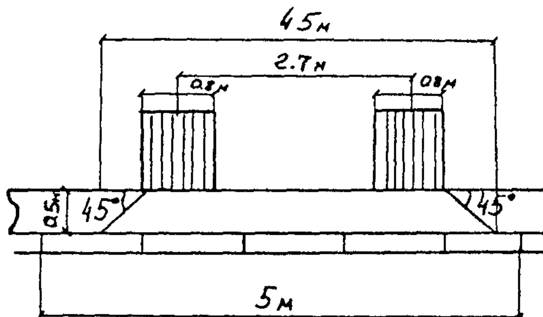
Рис. 3.5. Расположение переходных плит под нагрузкой НК-80 (распределение напряжений в дорожной одежде под углом 45°)
