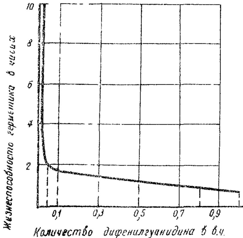
Рис. 4. Жизнеспособность герметика в зависимости от количества дифенилгуанидина при постоянной температуре вулканизации, равной  $+20^{\circ}\text{C}$ . Без дифенилгуанидина вулканизация наступает через 4–5 суток
