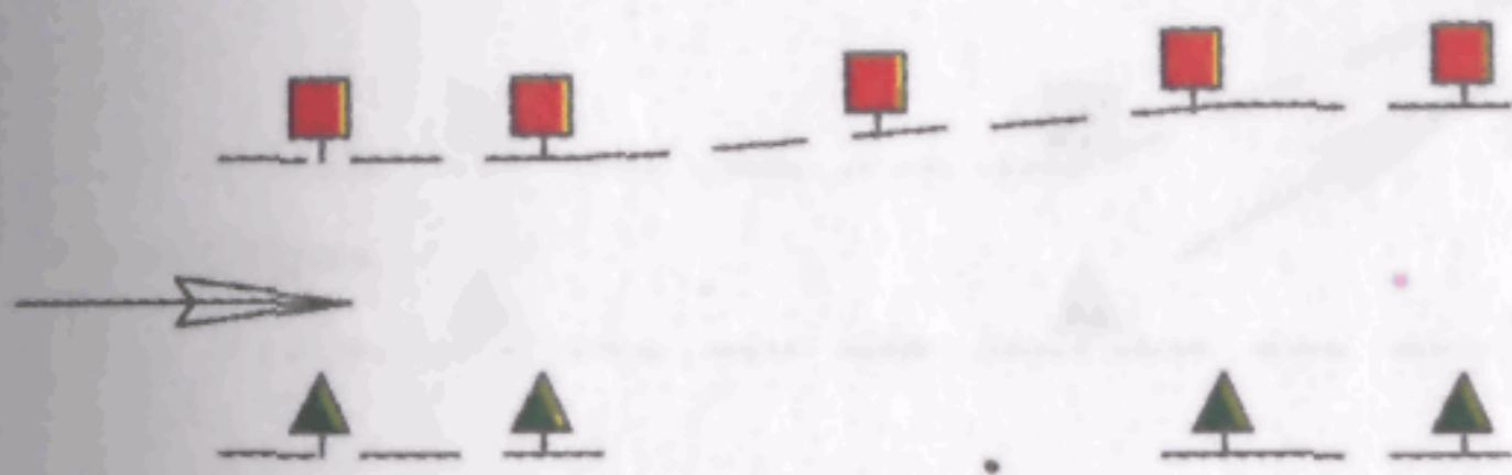
Рисунок Б.2 - Правая бровка канала (фарватера) на больших глубинах отсутствует
