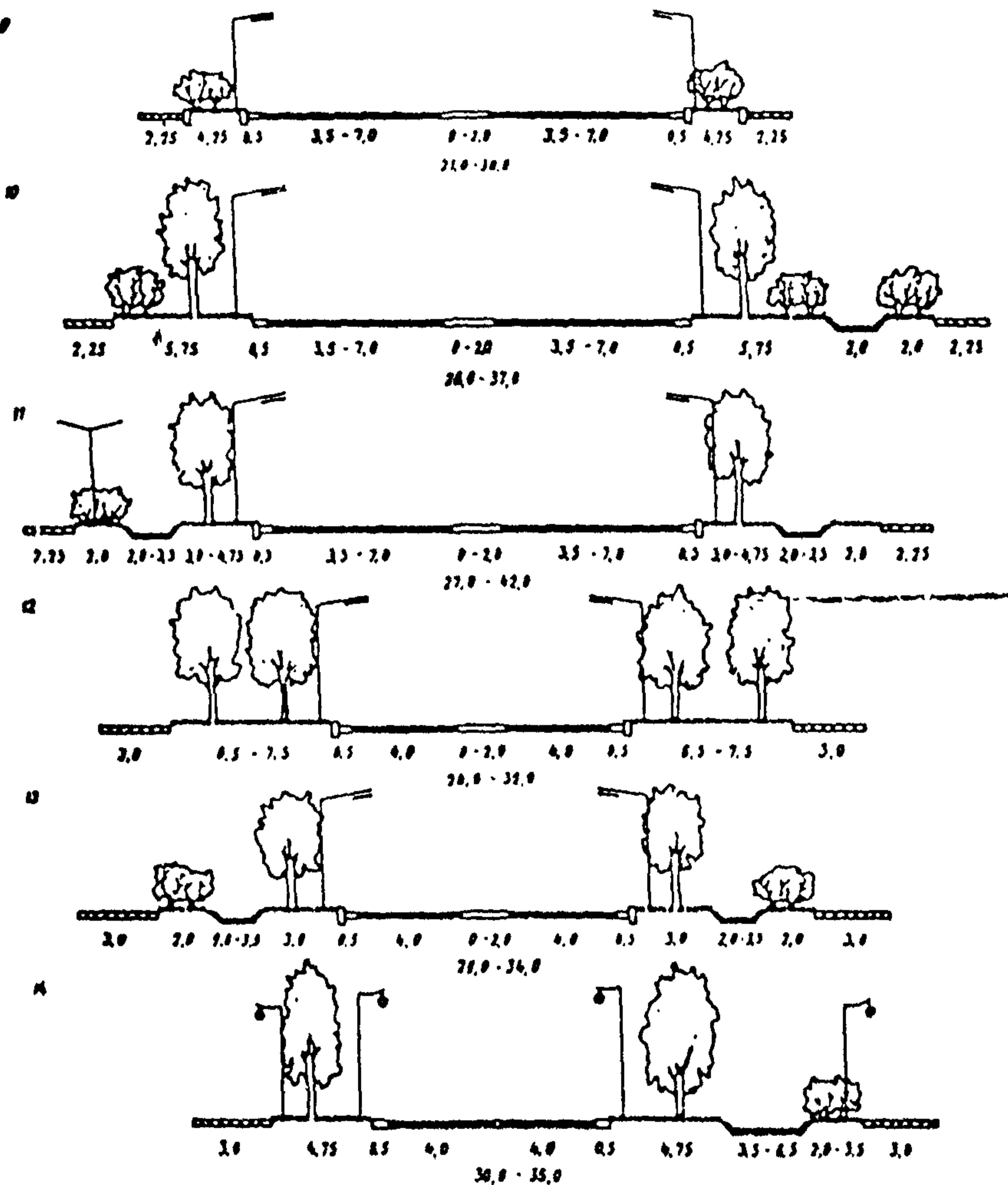
РИС. 3. ТИПОВЫЕ ПОПЕРЕЧНЫЕ ПРОФИЛИ МАГИСТРАЛЬНЫХ УЛИЦ
