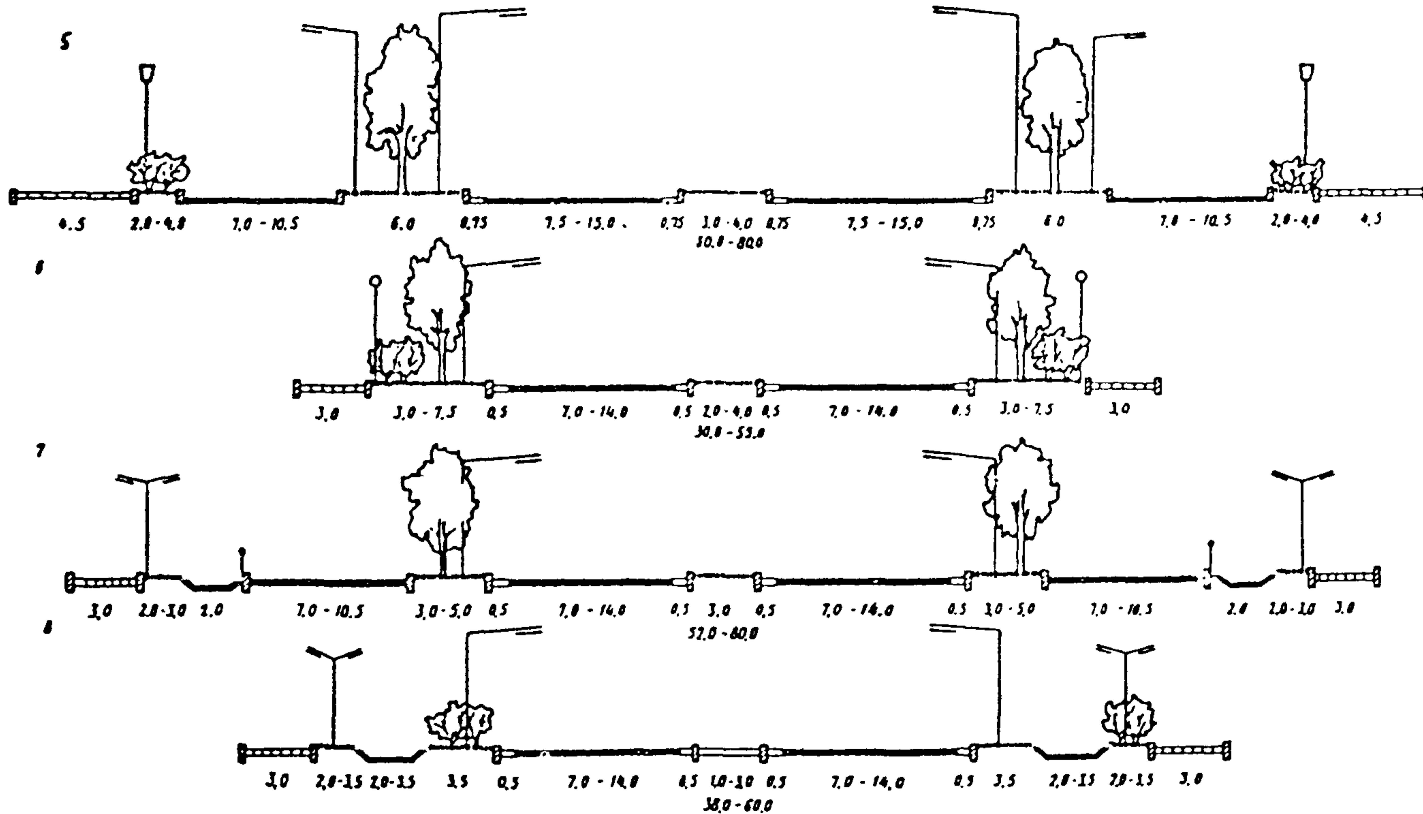
РИС. 2. ТИПОВЫЕ ПОПЕРЕЧНЫЕ ПРОФИЛИ МАГИСТРАЛЬНЫХ УЛИЦ
