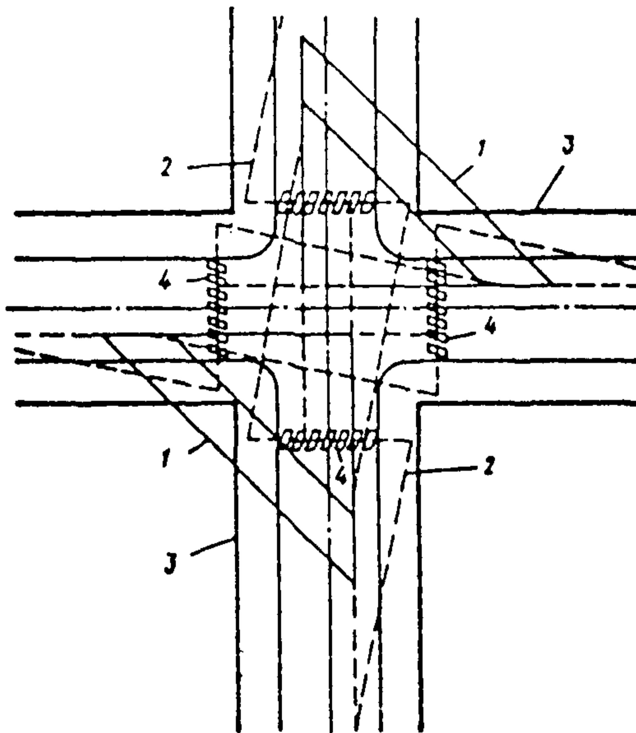
РИС. 7. ПОСТРОЕНИЕ ТРЕУГОЛЬНИКОВ ВИДИМОСТИ:
