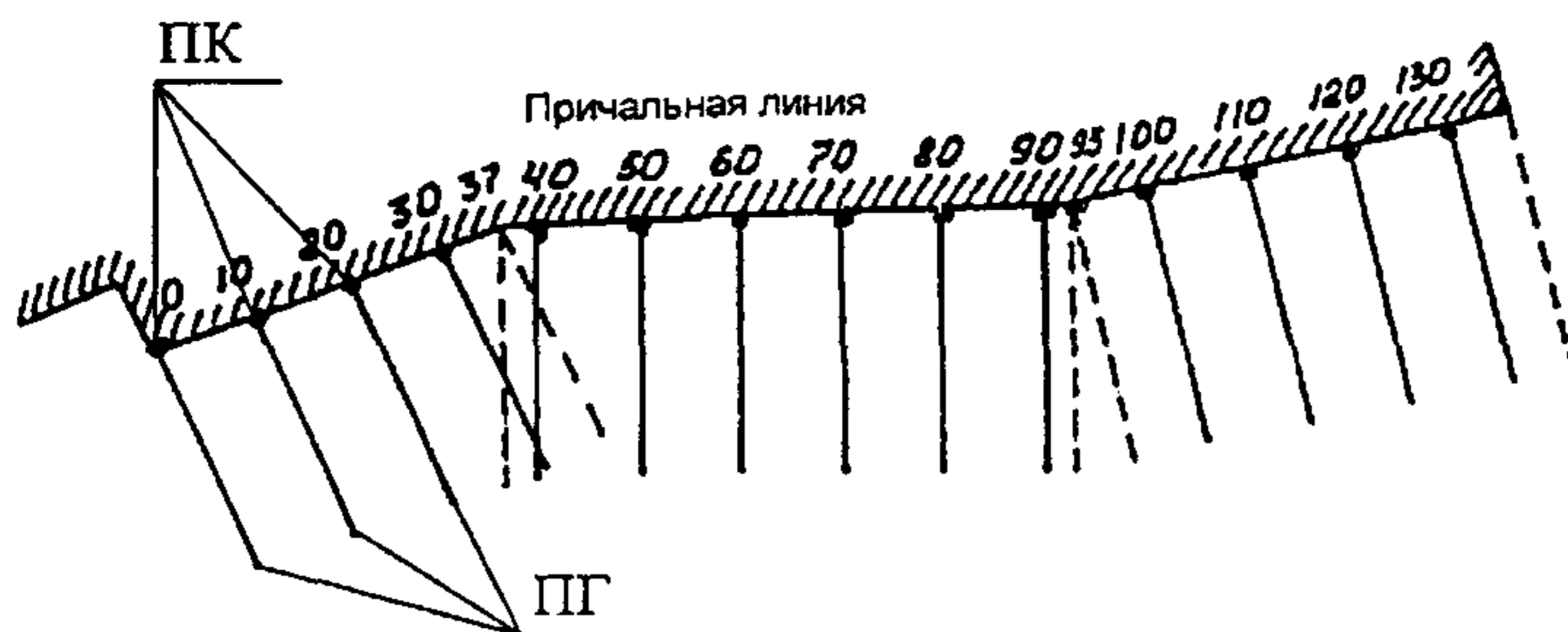
Рисунок 6 - Схема расположения промерных галсов и нумерация пикетов у причалов с продольным изломанным направлением.
