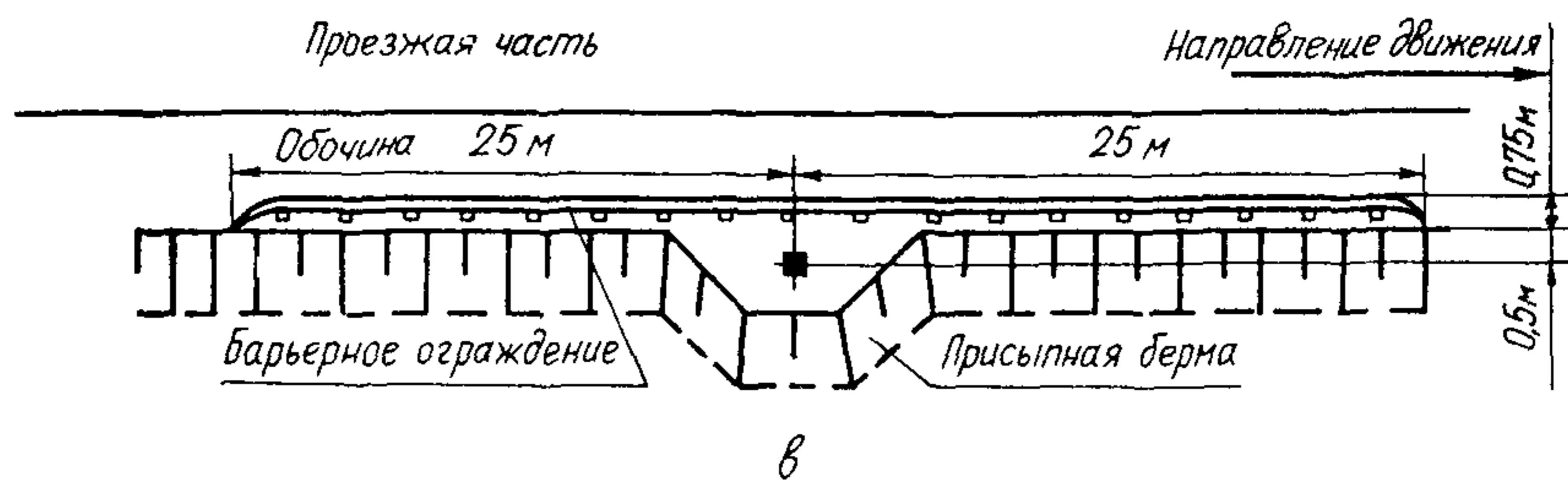
Рис. 5. Установка ограждений:
