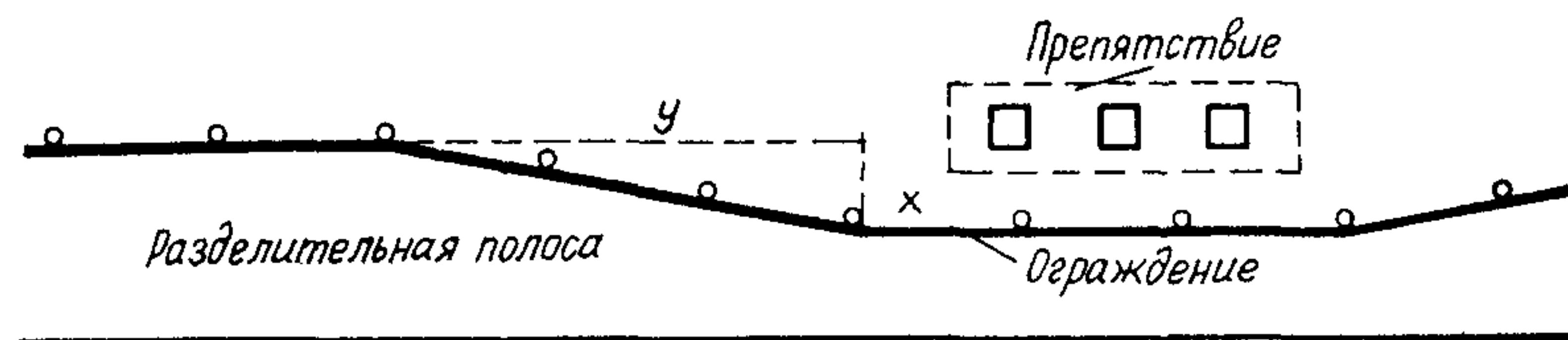
Рис. 2. Отклонение ограждения в плане от первоначального направления
