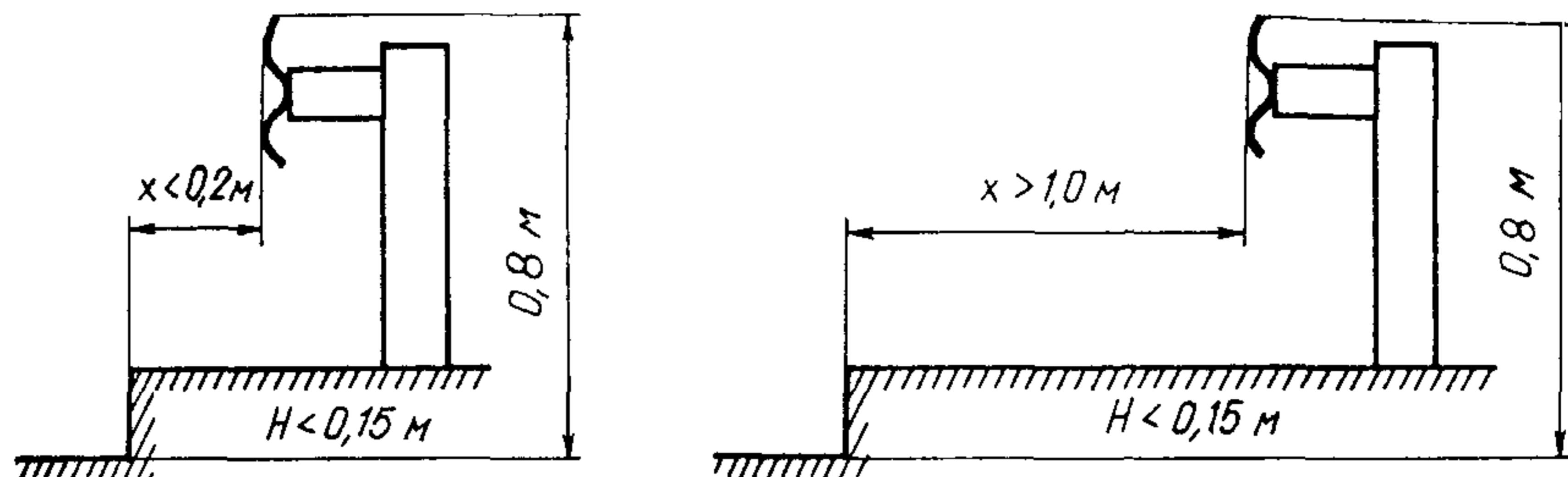
Рис. 3. Размещение ограждения относительно низкого бордюра
