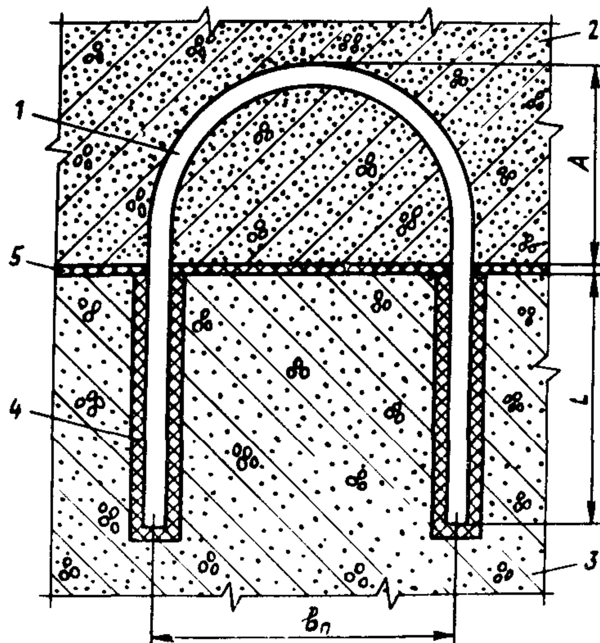
Рис.4. Схема скобы, служащей для связи бетона усиления с ос- лабленной конструкци- ей: 1 - скоба; 2 - бе- тон усиления; 3 - бетон ослабленной конструк- ции; 4 - скважина, за- полненная kleем; 5 - kleевая обмазка
