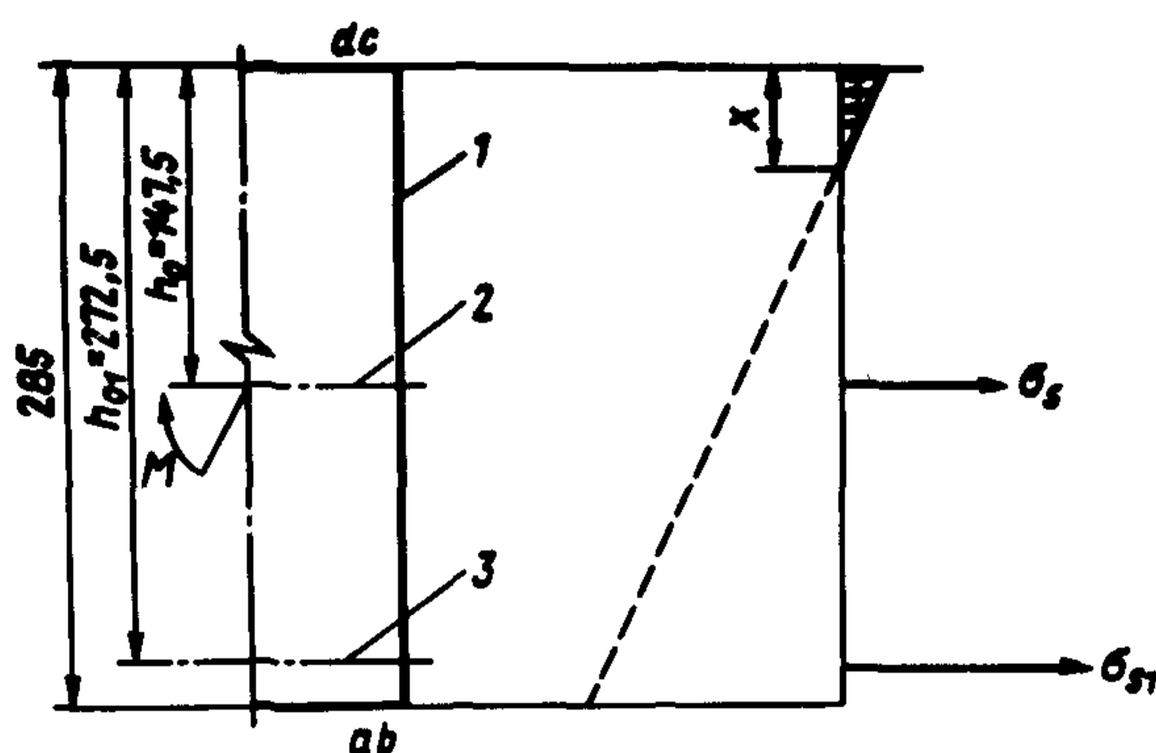
Рис. 3. Расчетная схема к определению напряжений в арматуре в упругой стадии работы сечения: 1 – плоскость отсеченной части клеештыревого стыка ( $a'b'c'd'$ ); 2 – центр тяжести штырей; 3 – центр тяжести первого ряда штырей
