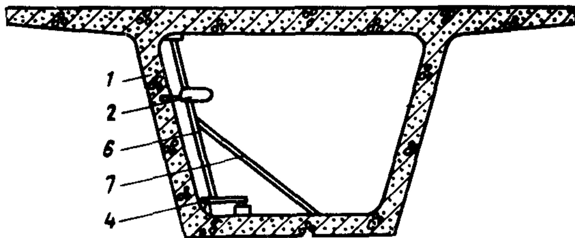
Рис.5. Схема сверления отверстий в ребрах балки: а - сверление с подмостей; б - с использованием штанги Союздорнии; 1 - ребро; 2 - сверлильный станок; 3 - распорная штанга; 4 - станина станка; 5 - подмости; 6 - штанга-удлинитель; 7 - лестница
