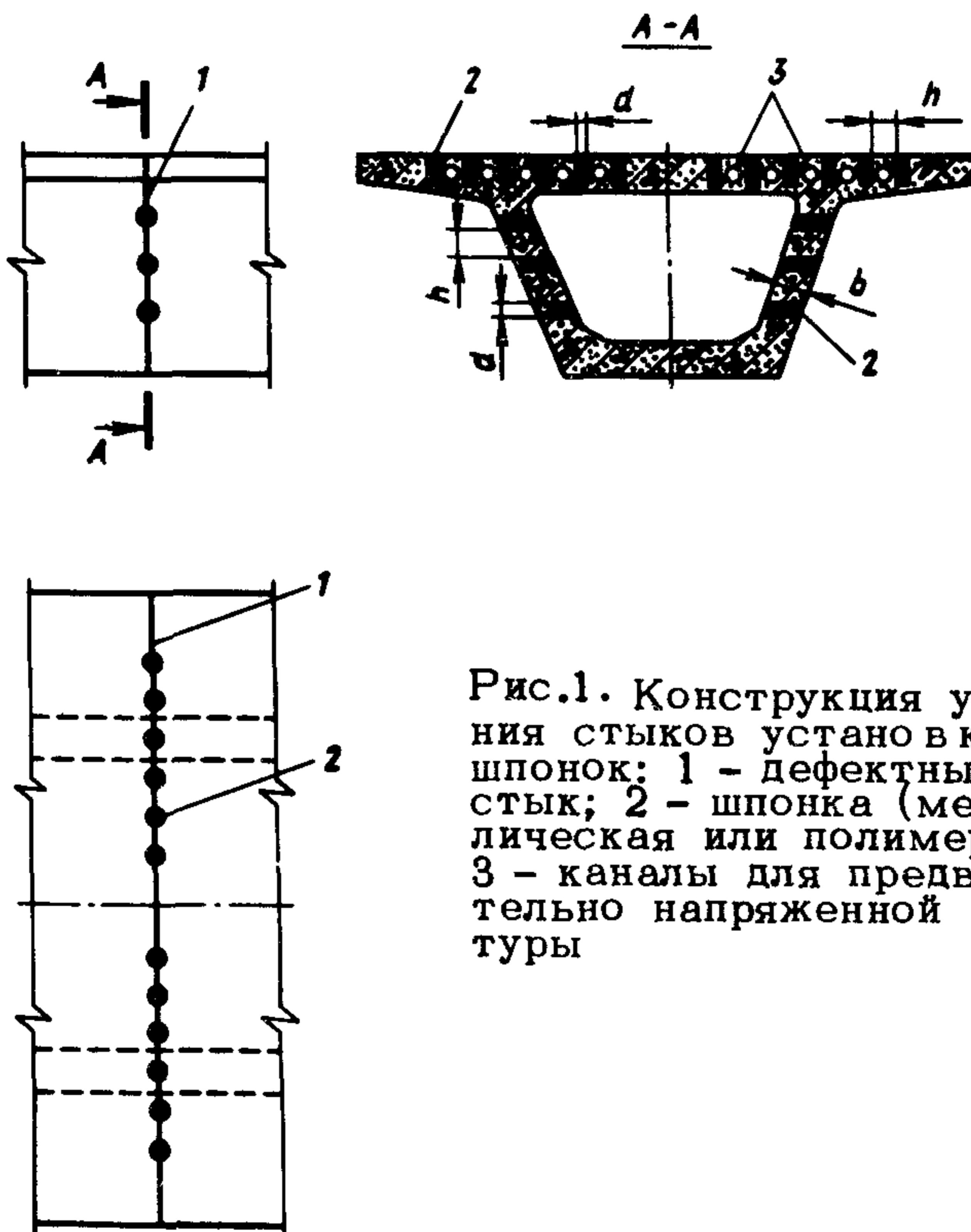
Рис.1. Конструкция усиления стыков установкой шпонок: 1 - дефектный стык; 2 - шпонка (металлическая или полимерная); 3 - каналы для предварительно напряженной арматуры
