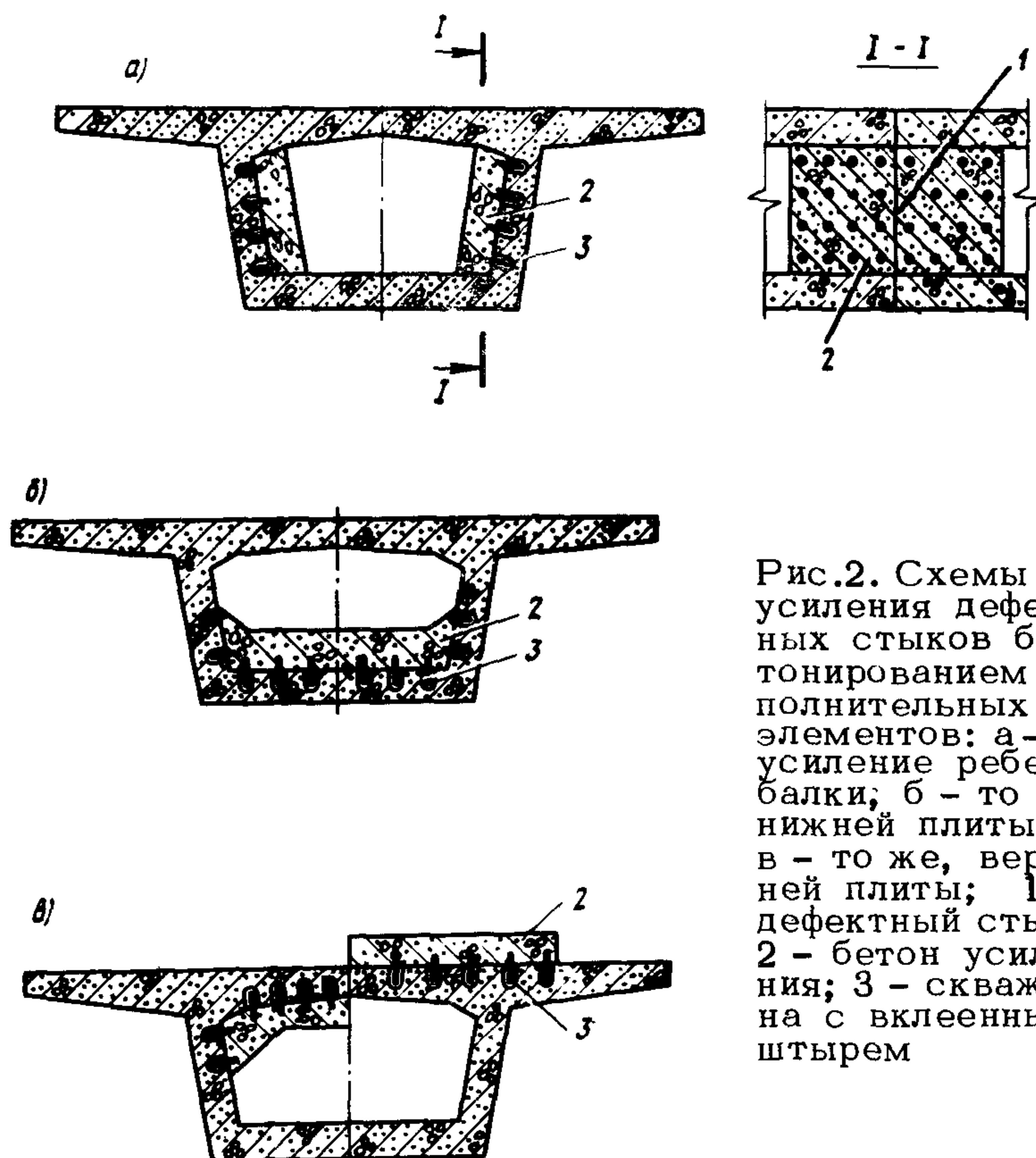
Рис.2. Схемы усиления дефектных стыков бетонированием дополнительных элементов: а - усиление ребер балки; б - то же, нижней плиты; в - то же, верхней плиты; 1 - дефектный стык; 2 - бетон усиления; 3 - скважина с вклешенным штырем
