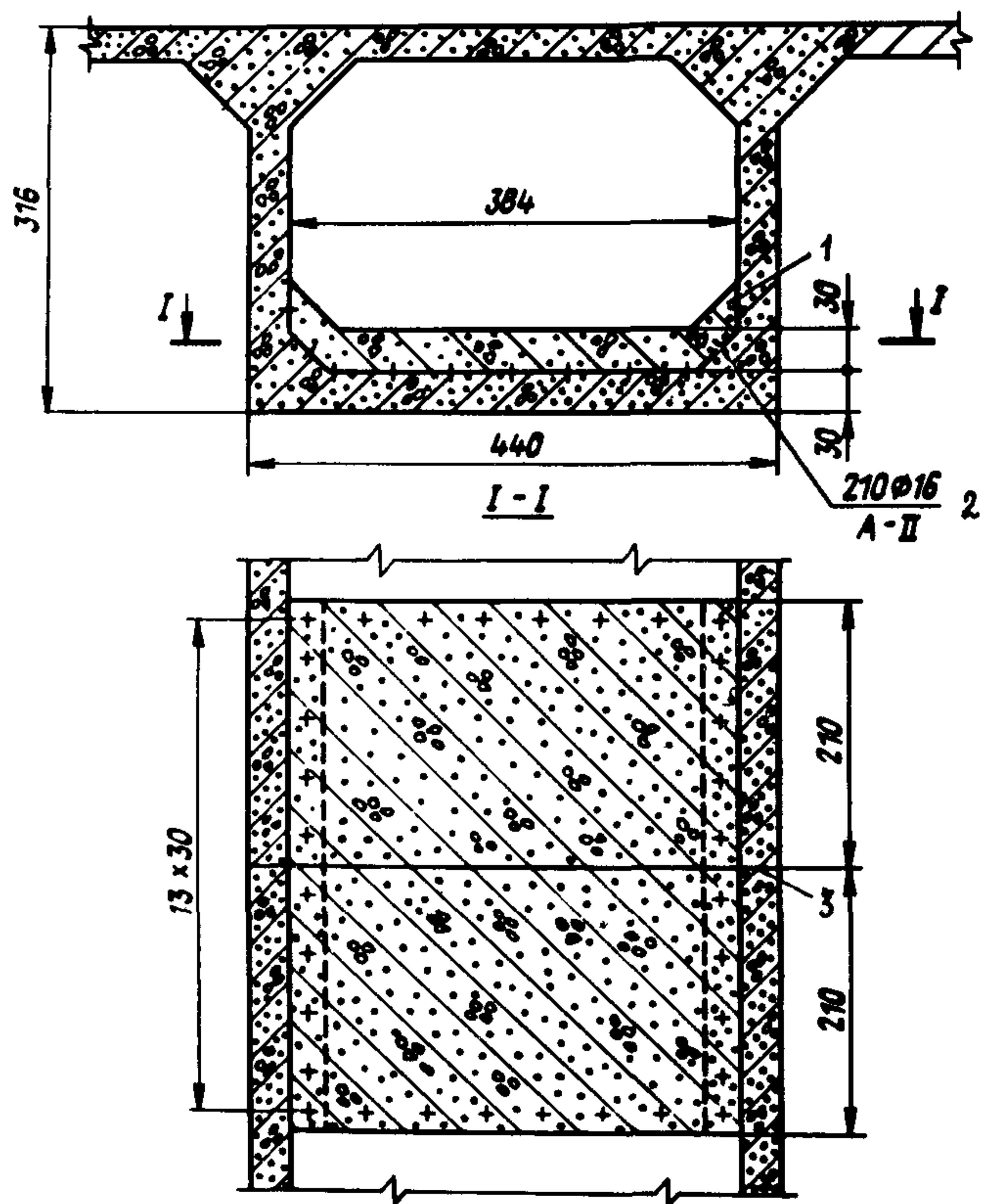
Рис. 1. Схема усиления нижней плиты балки составного по длине пролетного строения в зоне дефектного стыка: 1 – бетон усиления; 2 – штыри диаметром 16 мм из арматурной стали кл. А-III; 3 – дефектный стык
