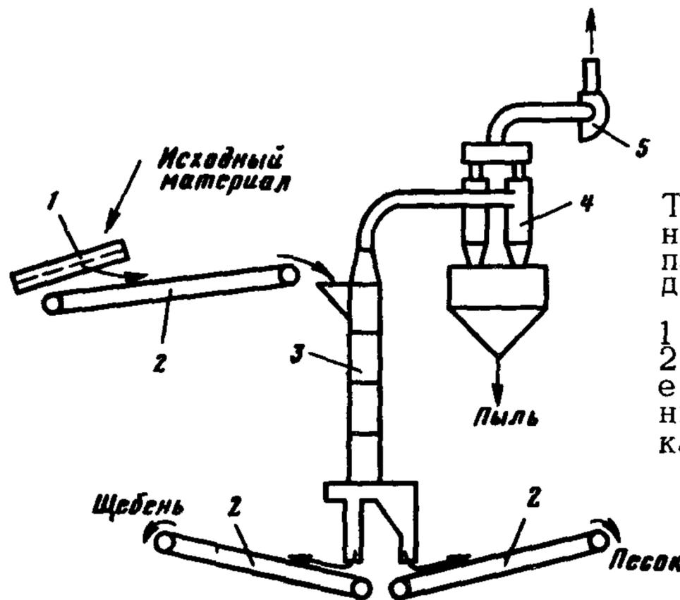
Технологическая линия ВНИИнеруда для переработки отсевов дробления сухим способом:
