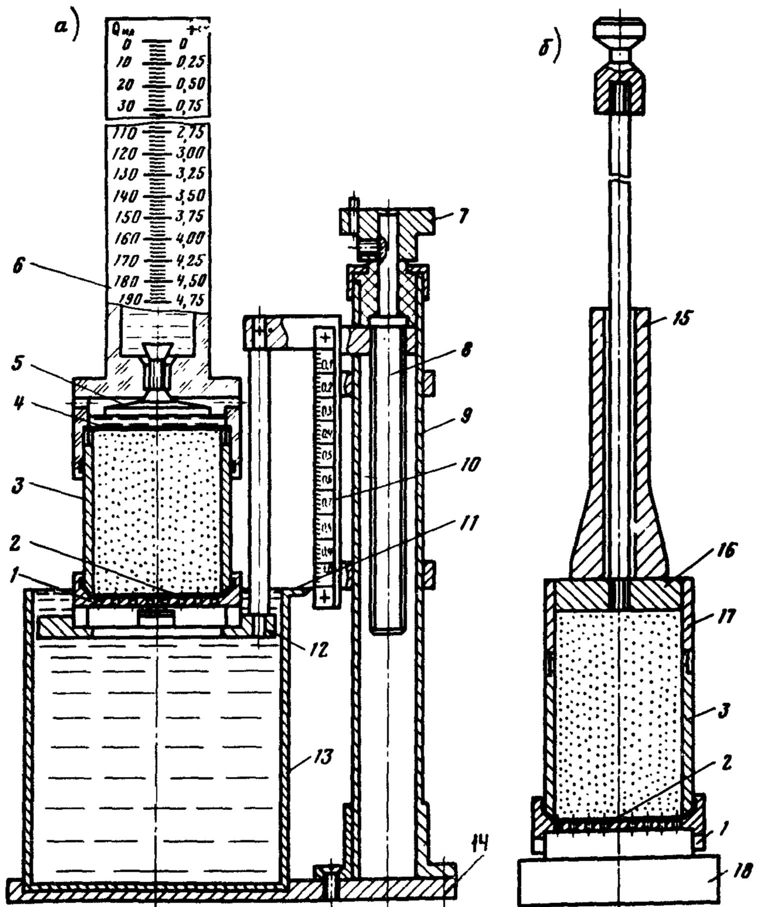
Прибор ПКФ-Союздорнии: а-фильтрационная трубка и винтовой телескопический штатив; б-приспособление для стандартного уплотнения: 1-поддон; 2-латунная сетка; 3-цилиндр ( $d = 71 \text{ мм}$ ;  $h = 100 \text{ мм}$ ); 4-сито; 5-поплавок; 6-мерный сосуд; 7-штурвал; 8-винт; 9-направляющая колонка; 10-скользящий кронштейн; 11-стрелка; 12-подставка; 13-цилиндрический сосуд; 14-плита; 15-гиря массой 1,07 кг; 16-наковальня; 17-насадка; 18-вкладыш
