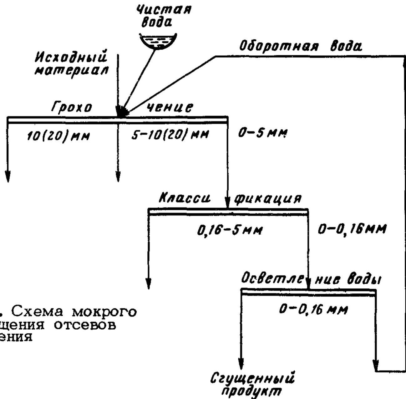
Рис.1. Схема мокрого обогащения отсевами дробления
