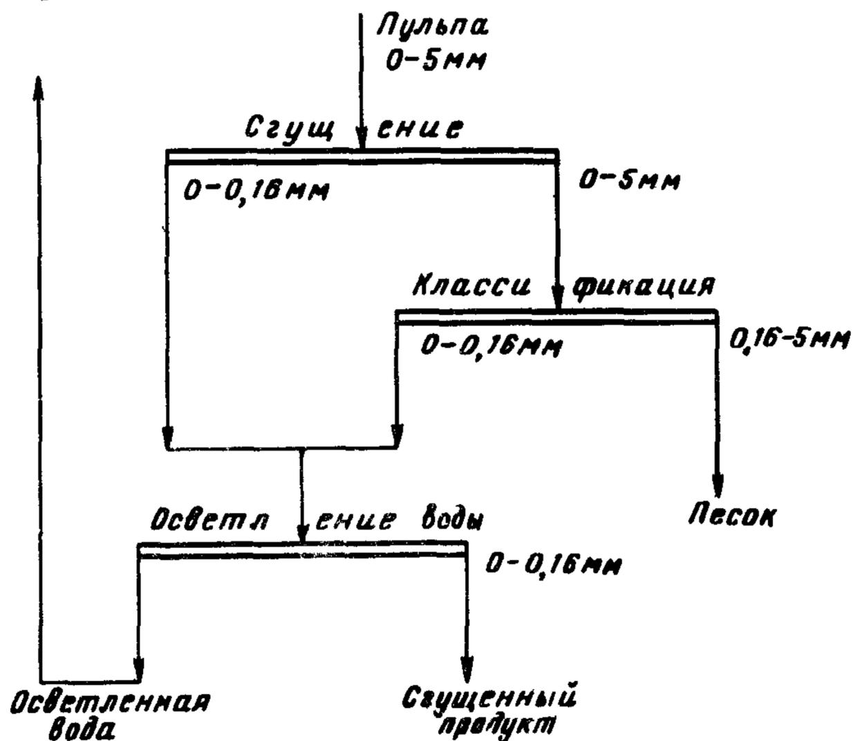
Рис.3. Схема мокрого обогащения отсевов текущего производства со сгущением пульпы
