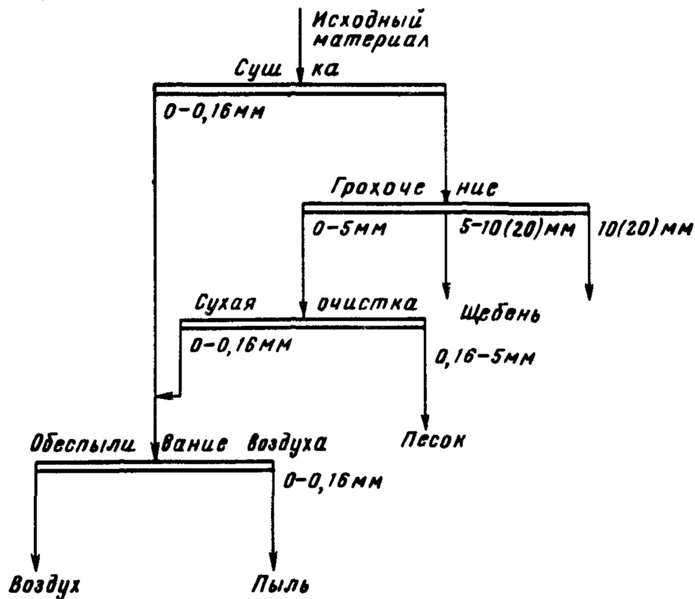
Рис.4. Схема сухого обогащения отсевов дробления
