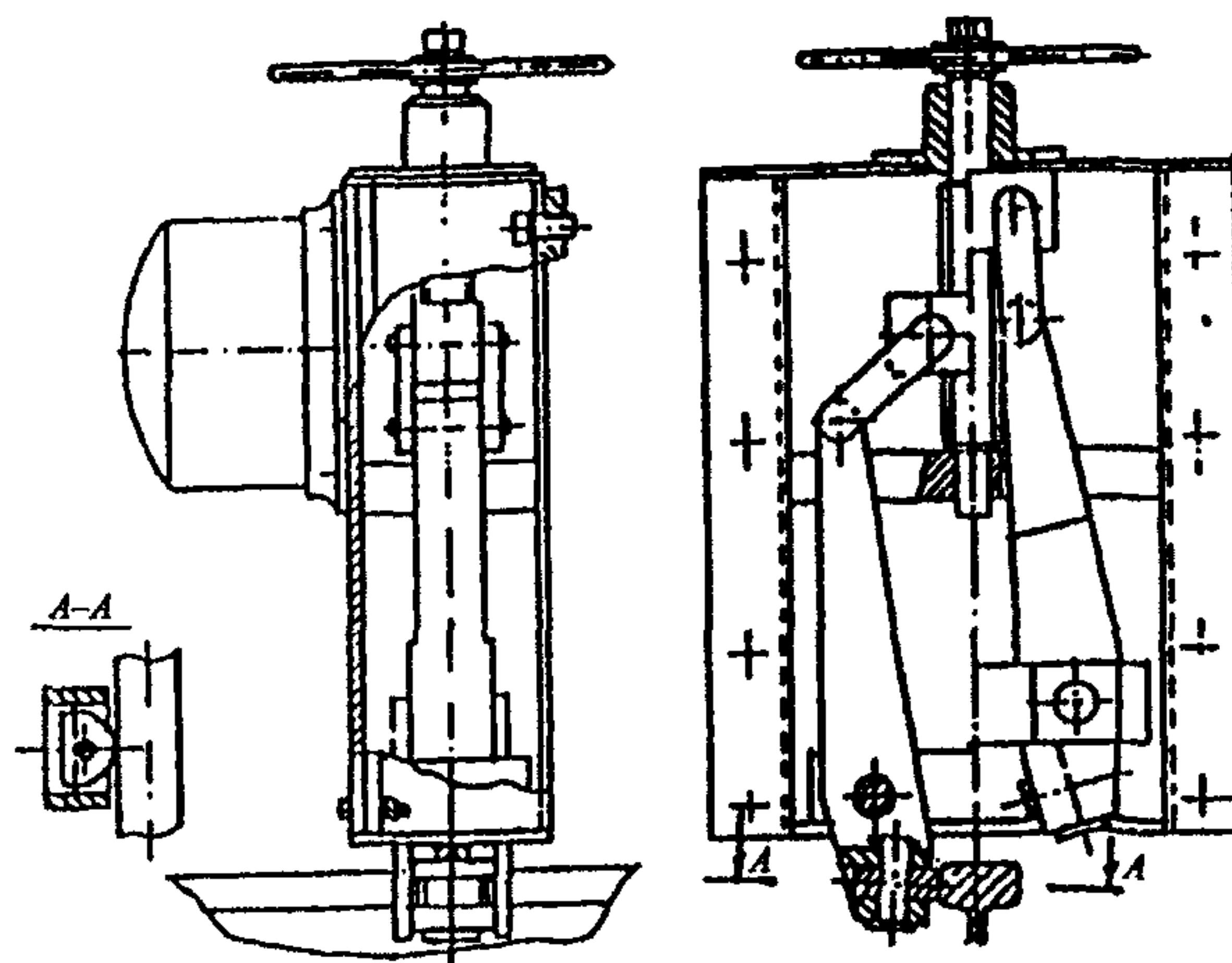
Рис. 4. Ручной рычажный захват
