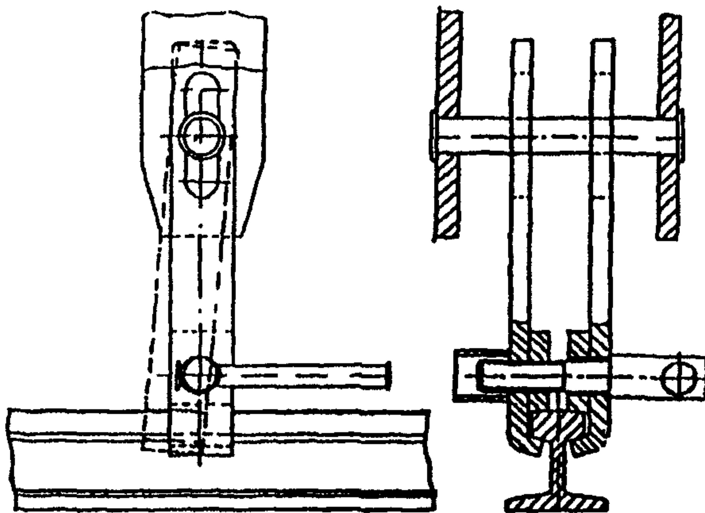
Рис. 3. Клещевой накидной захват
