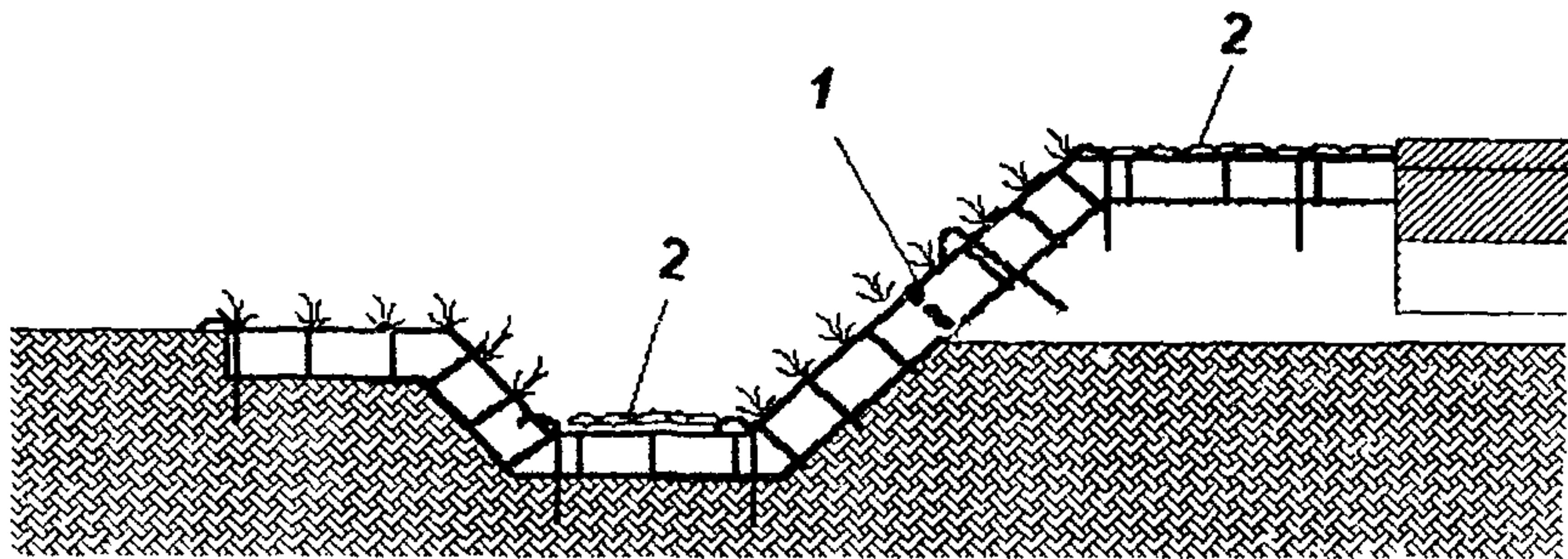
*Рис 4.4 Комплексное укрепление откоса насыпи и кювета на основе «Геовеба» с применением в качестве заполнителя растительного грунта с посевом трав по поверхности откоса (1) и щебня на обочине и в кювете (2)*
