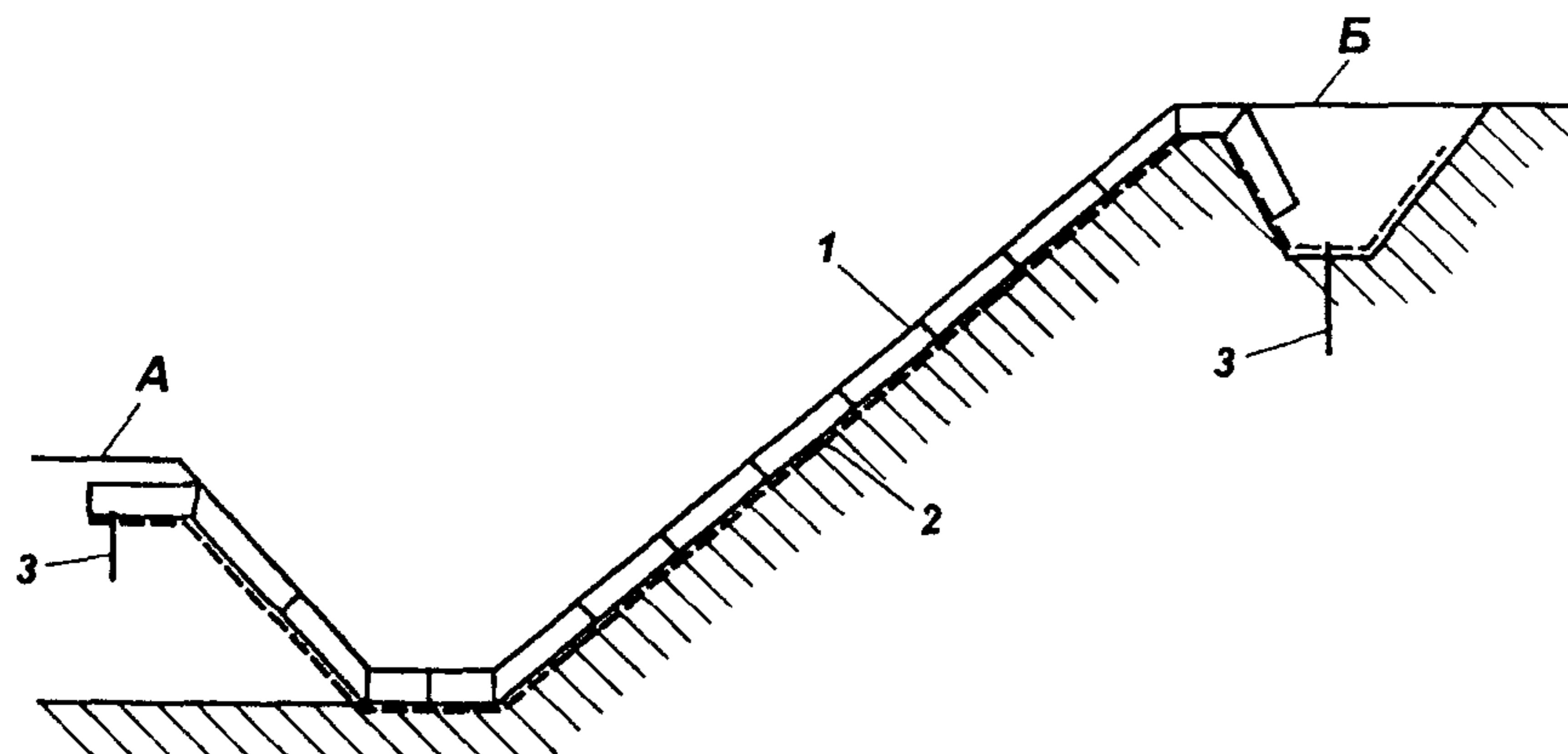
Рис. 4.8 Периферийная заделка геотекстиля под «Геовеб» в грунт.
