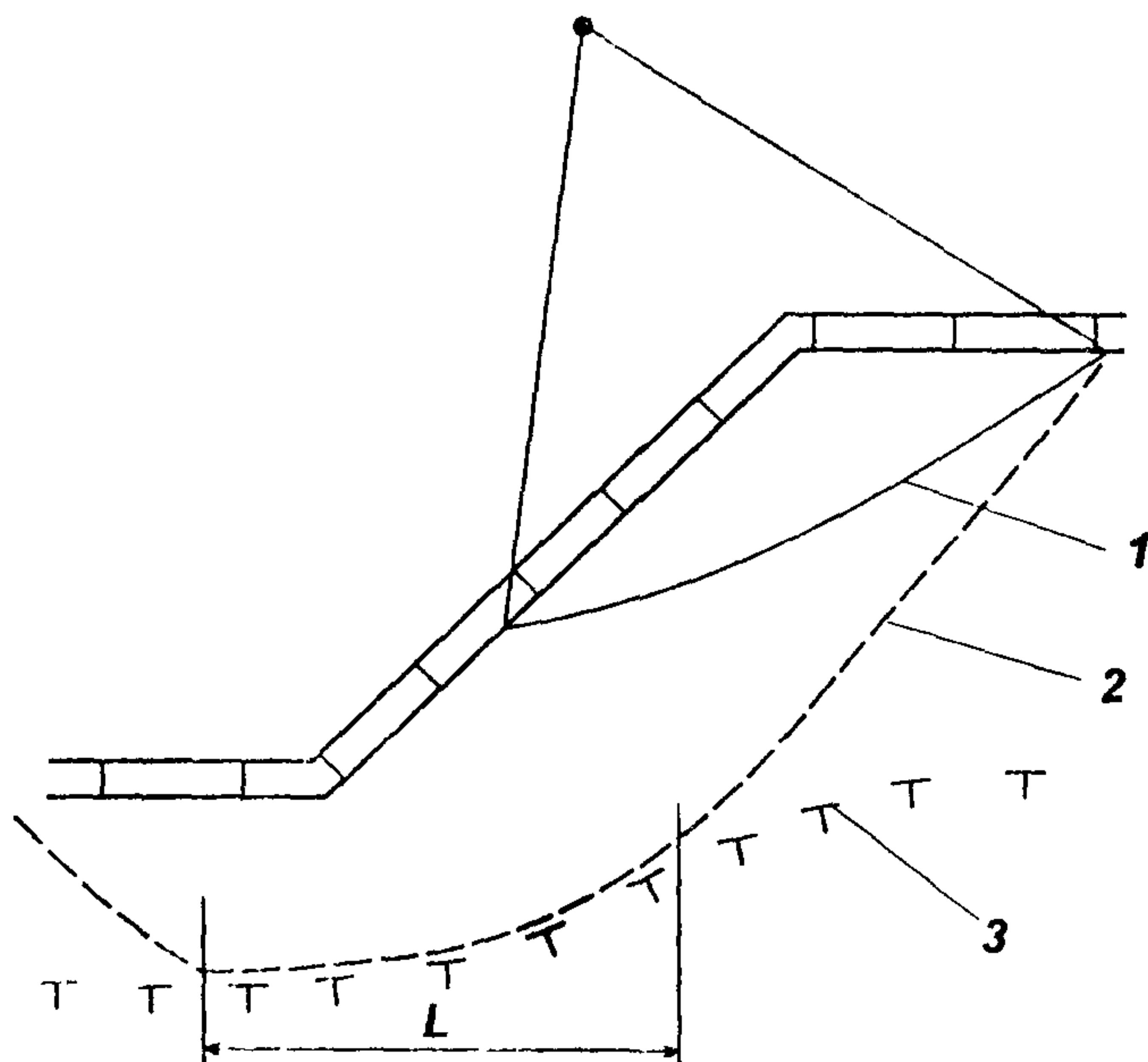
Рис. 7.1. Схема для расчета устойчивости откосов с «Геовебом» с применением поверхностей скольжения: 1 — круглоцилиндрической; 2 — с участком поверхности вечной мерзлоты  $L$ ; 3 — вечной мерзлоты
