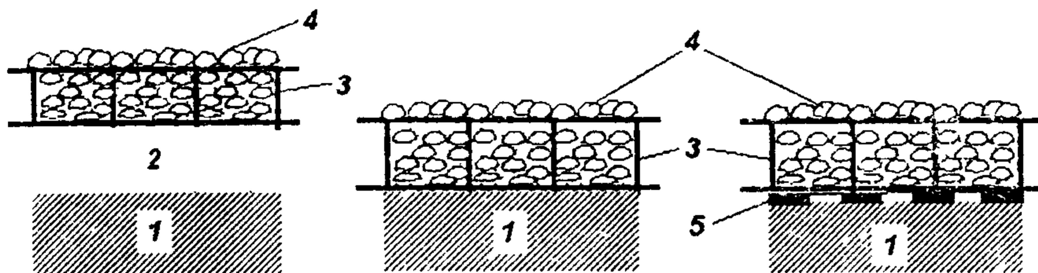
*Рис 4.1. Схемы вариантов конструкции переходных дорожных одежд с использованием «Геовеба» 1 – грунт земляного полотна; 2 – слой основания из щебня, песка, гравия, ПГС и т п., не укрепленного или укрепленного вяжущим; 3 – «Геовеб» с заполнением ячеек материалом, используемым в слое 2, 4 – защитный слой из щебня, песка или ПГС; 5 – геотекстильная прослойка*
