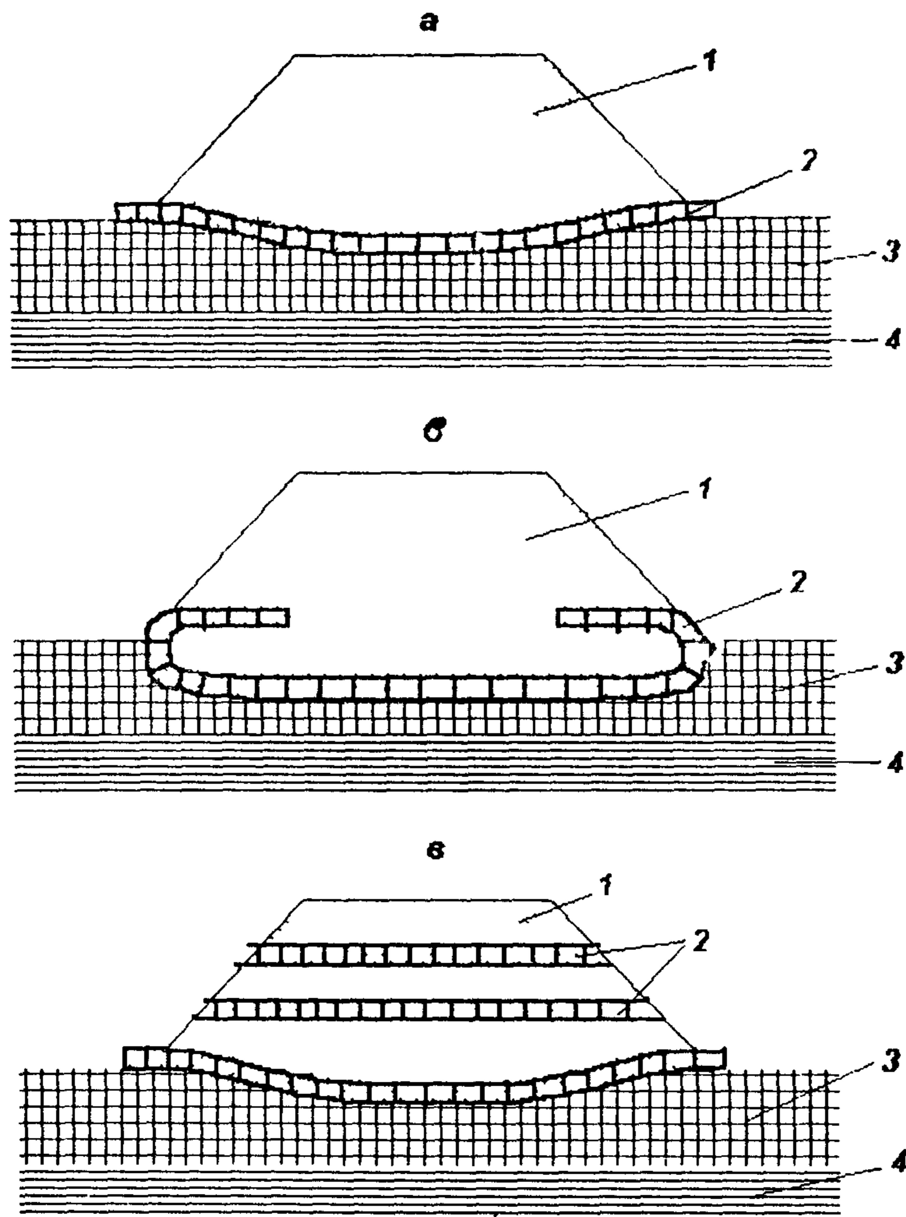
*Рис 4.9 Применение «Геовеба» при устройстве насыпей на болотах без выторфования а – с армирующей прослойкой в основании, б – с полуобоймой в основании, в – с прослойкой в основании и армирующей прослойкой по высоте, 1 – песок насыпи, 2 – «Геовеб» с заполнителем, 3 – торф, 4 – минеральное основание*
