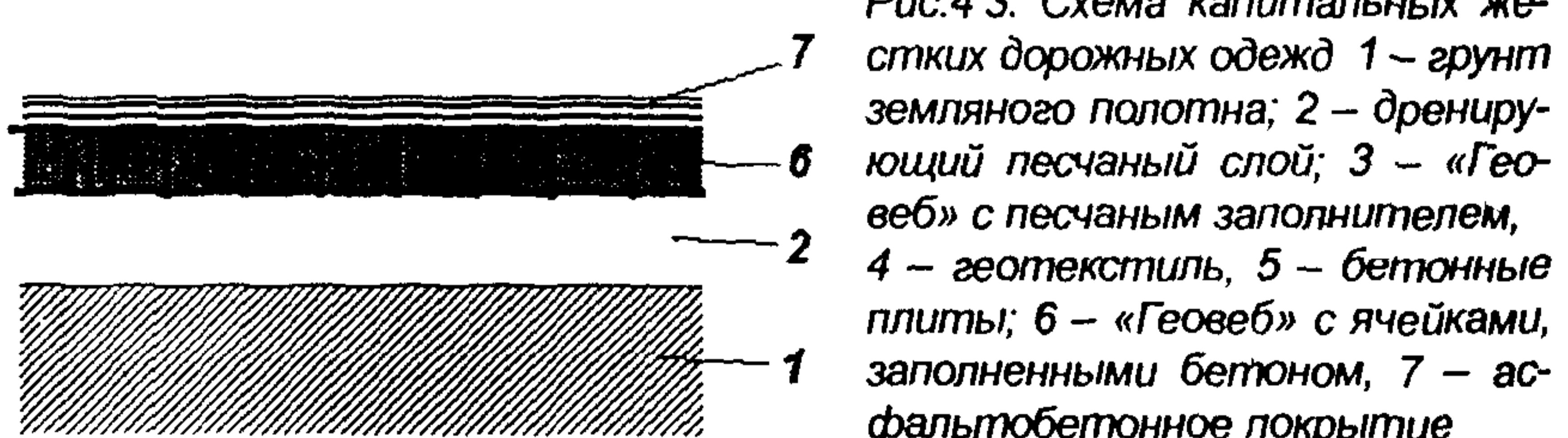
Рис.4.3. Схема капитальных жестких дорожных одежд 1 – грунт земляного полотна; 2 – дренирующий песчаный слой; 3 – «Геовеб» с песчанным заполнителем, 4 – геотекстиль, 5 – бетонные плиты; 6 – «Геовеб» с ячейками, заполненными бетоном, 7 – асфальтобетонное покрытие
