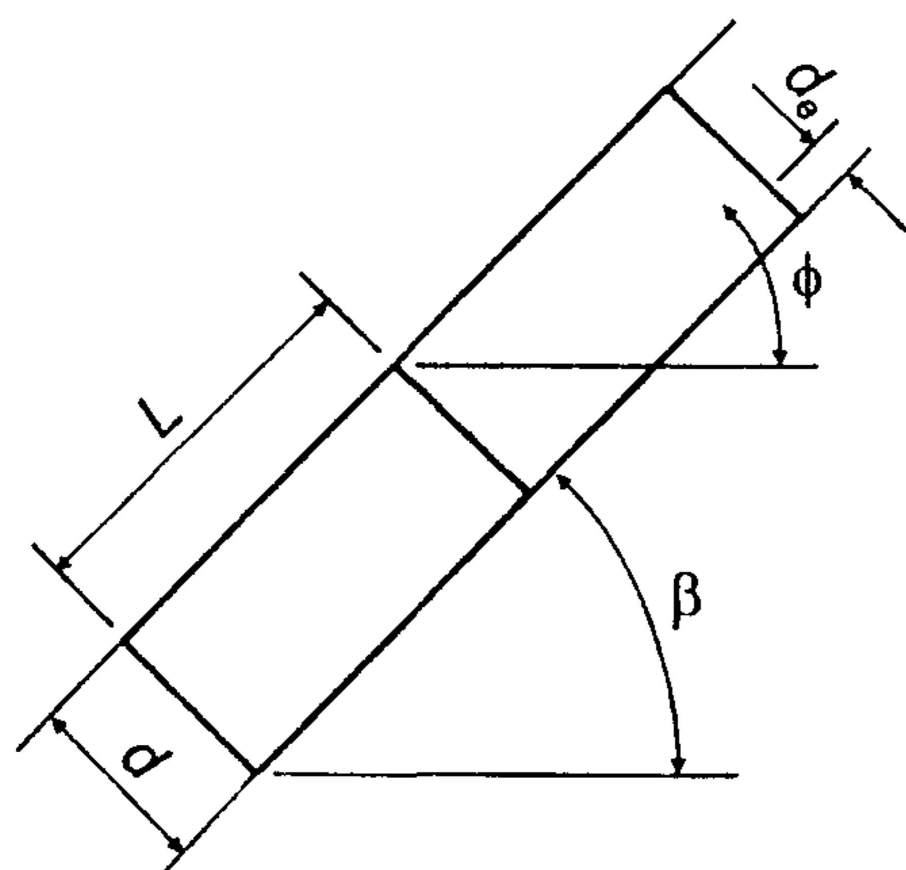
Рис 4.5. Определение требуемой глубины ячейки «Геовеба»
