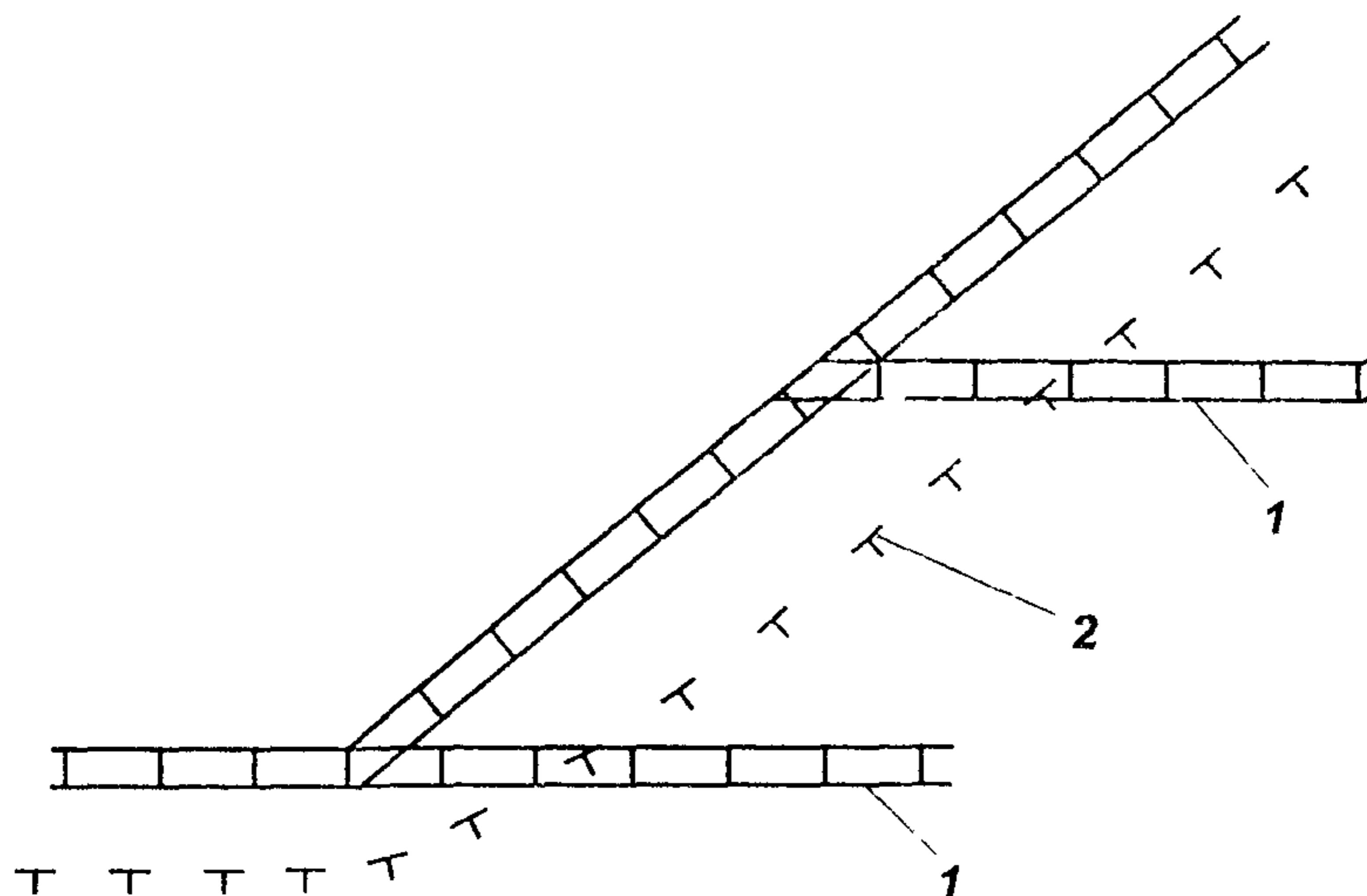
Рис. 7.2 Вариант устройства консолей из «Геовеба» для усиления откоса 1 – консоли из «Геовеба», 2 – поверхность части насыпи остающейся в мерзлом основании вечной мерзлоты
