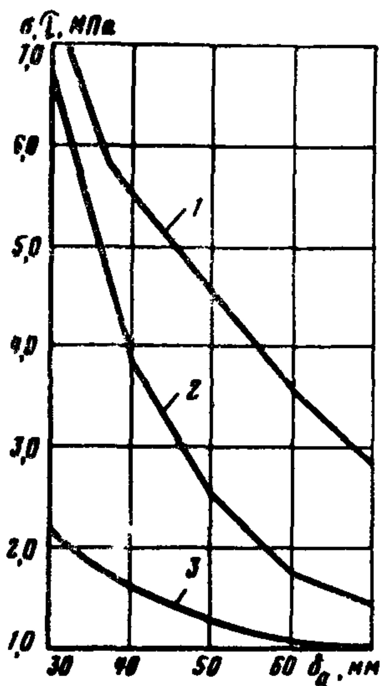
Рис.4. Зависимость напряжений в асфальтобетонном покрытии от толщины листа  $\delta_L$  (при  $\delta_a = 60$  мм и модуле упругости асфальтобетона  $E_a = 10000$  МПа):
