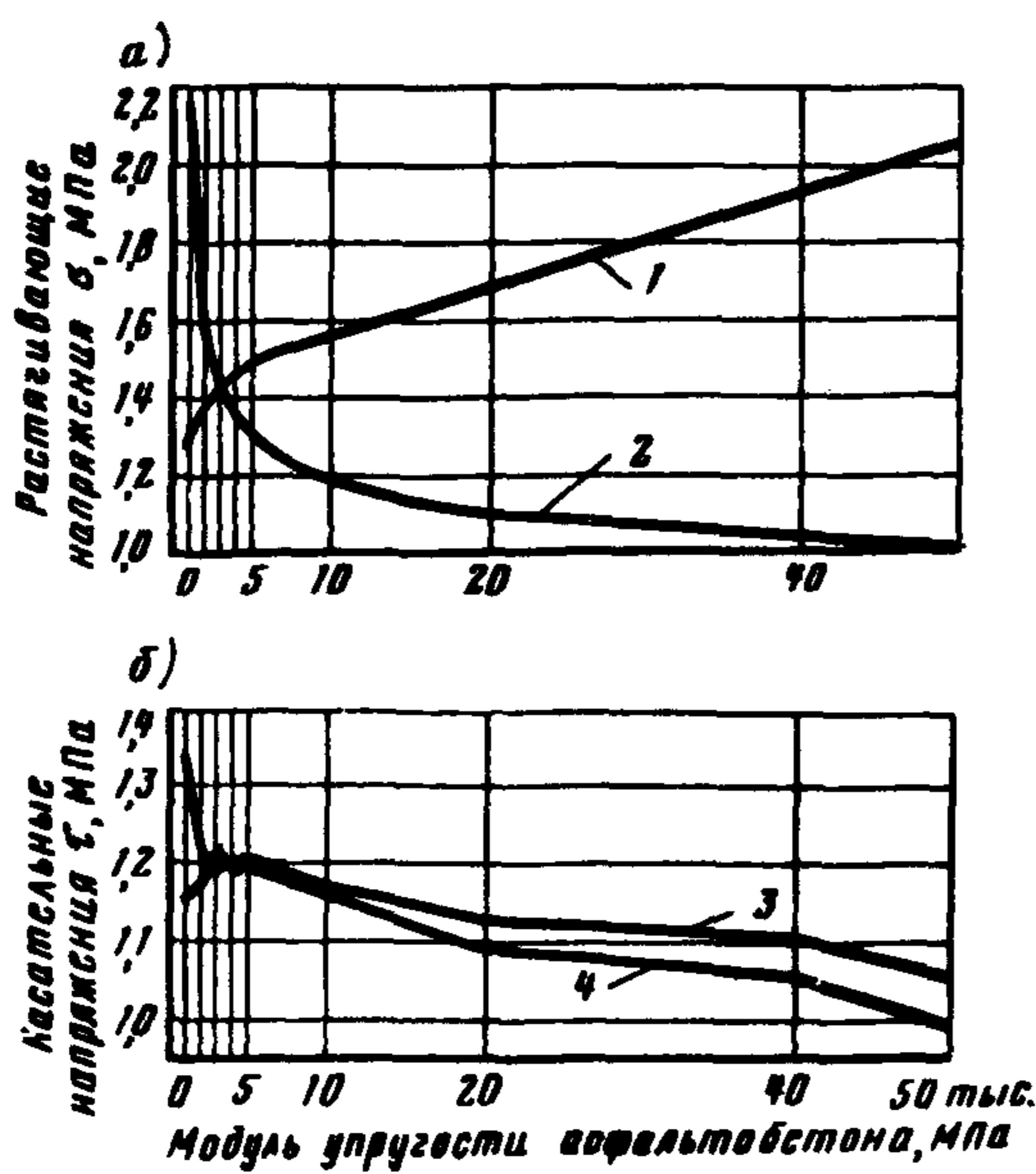
Рис.2. Зависимость главных растягивающих (а) и касательных (б) напряжений от модуля упругости асфальтобетона при изгибе:
