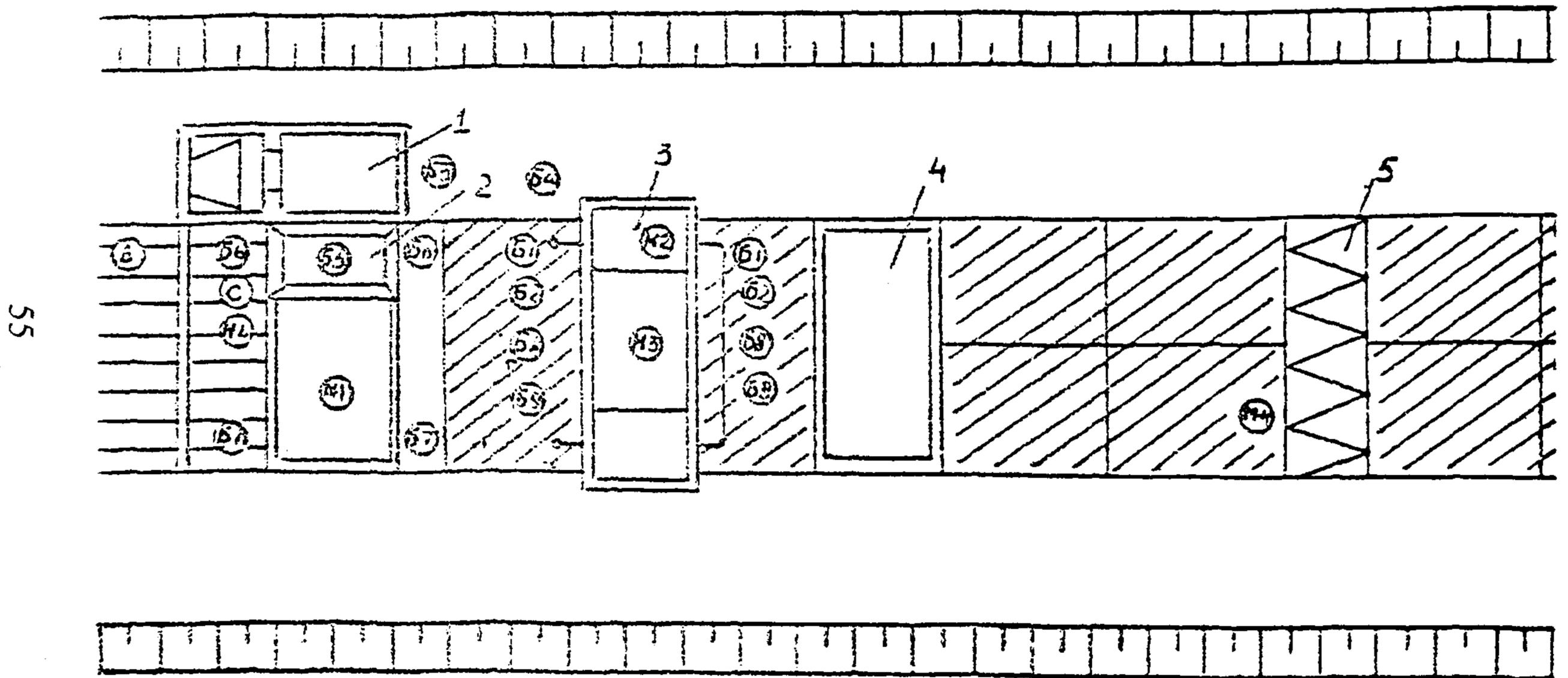
1 – автосамосвал; 2 – распределитель бетона; 3 – бетоноотделочная машина; 4 – нарезчик швов;
