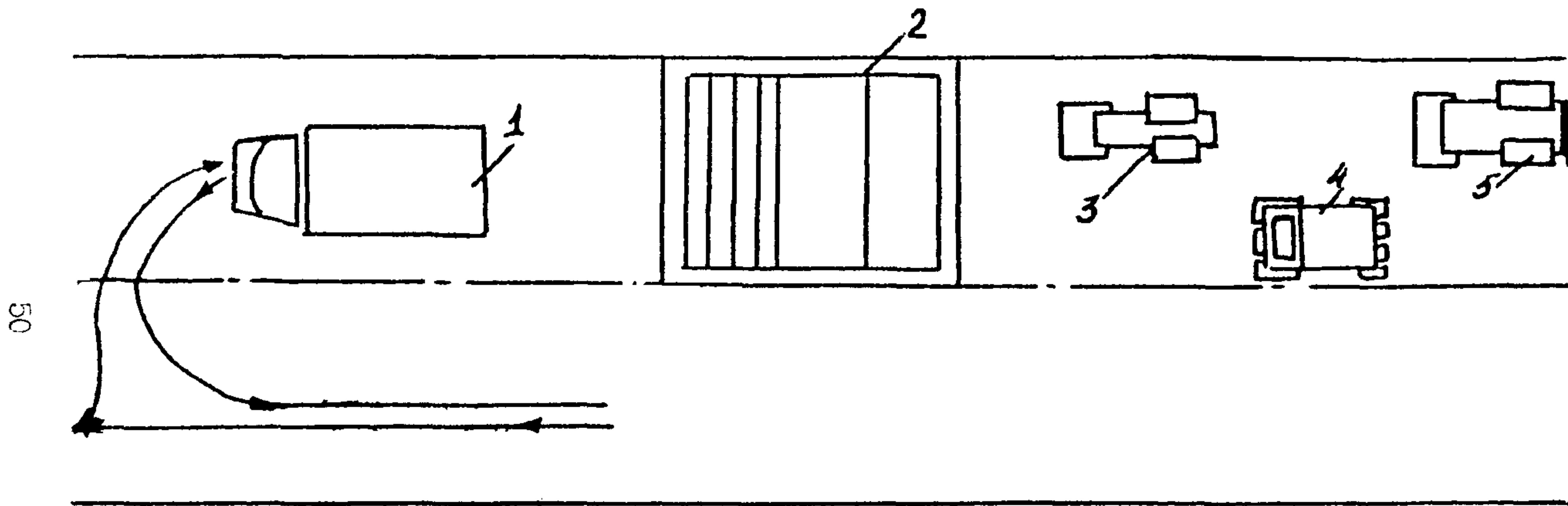
1 – автосамосвал, 2 – термосмеситель ДЭ-232, 3 – гладковальцовочный каток ДУ 47Б,
