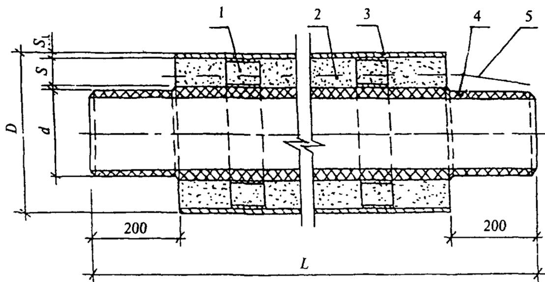
1 — центрирующая опора из полиэтилена ПЭ 63; 2 — изоляция из пенополиуретана; 3 — труба-оболочка из ПЭ 63 (ПЭ 80); 4 — асбестоцементная труба; 5 — проводники-индикаторы системы состояния оперативного дистанционного контроля пенополиуретана (показаны условно)
