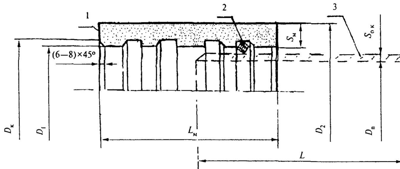
1 — муфта; 2 — кольцо (по 2 шт. на каждую трубу); 3 — труба;  $D_k$  — внутренний диаметр канавки;  $D_1$  — внутренний диаметр муфты;  $D_2$  — наружный диаметр муфты;  $S_m$  — толщина стенки муфты;  $L_m$  — длина муфты;  $D_b$  — внутренний диаметр трубы;  $S_{ок}$  — толщина стенки трубы по обточенному концу;  $L$  — длина трубы
