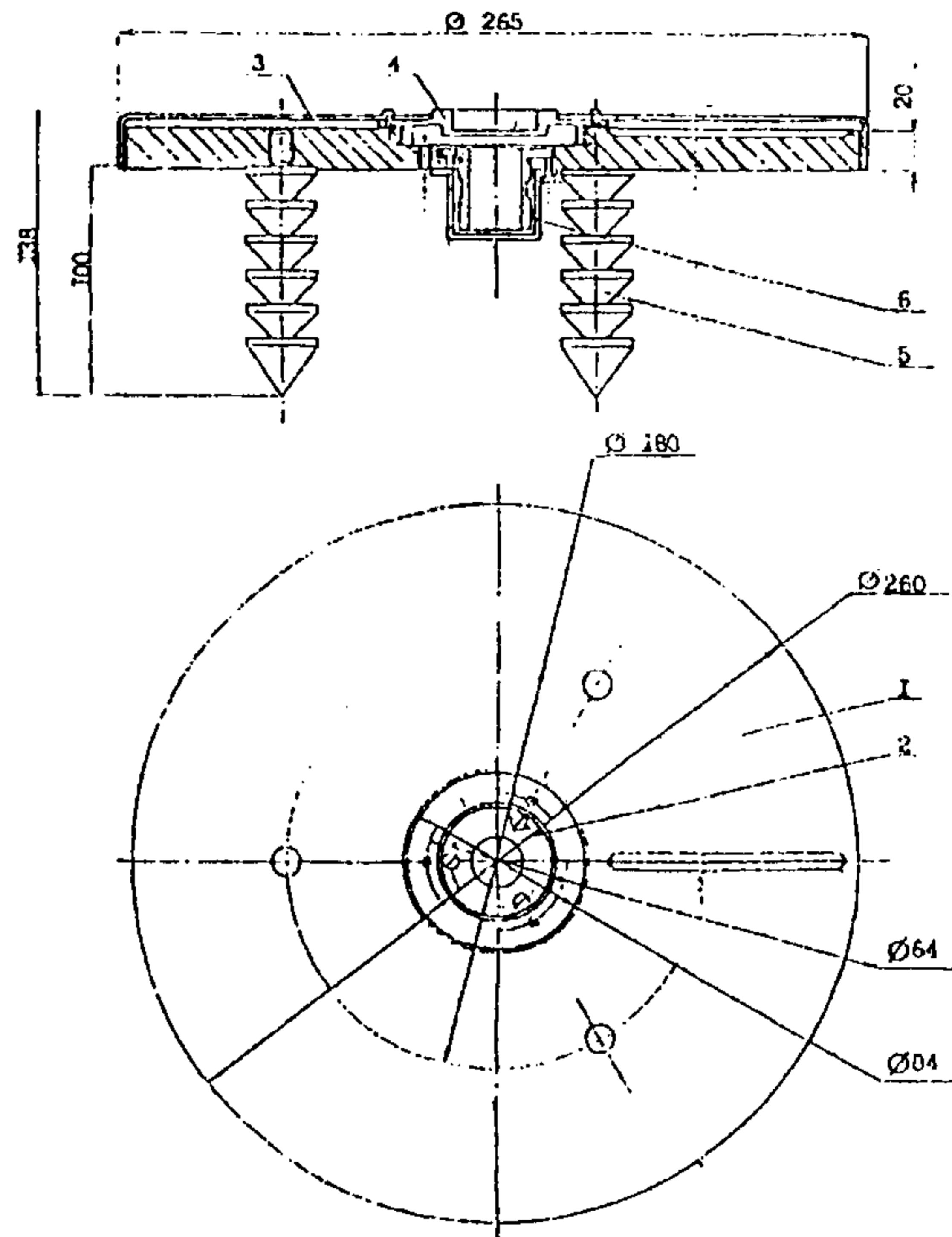
1-столик; 2-втулка; 3-крышка столика (на виде сверху крышка снята);
