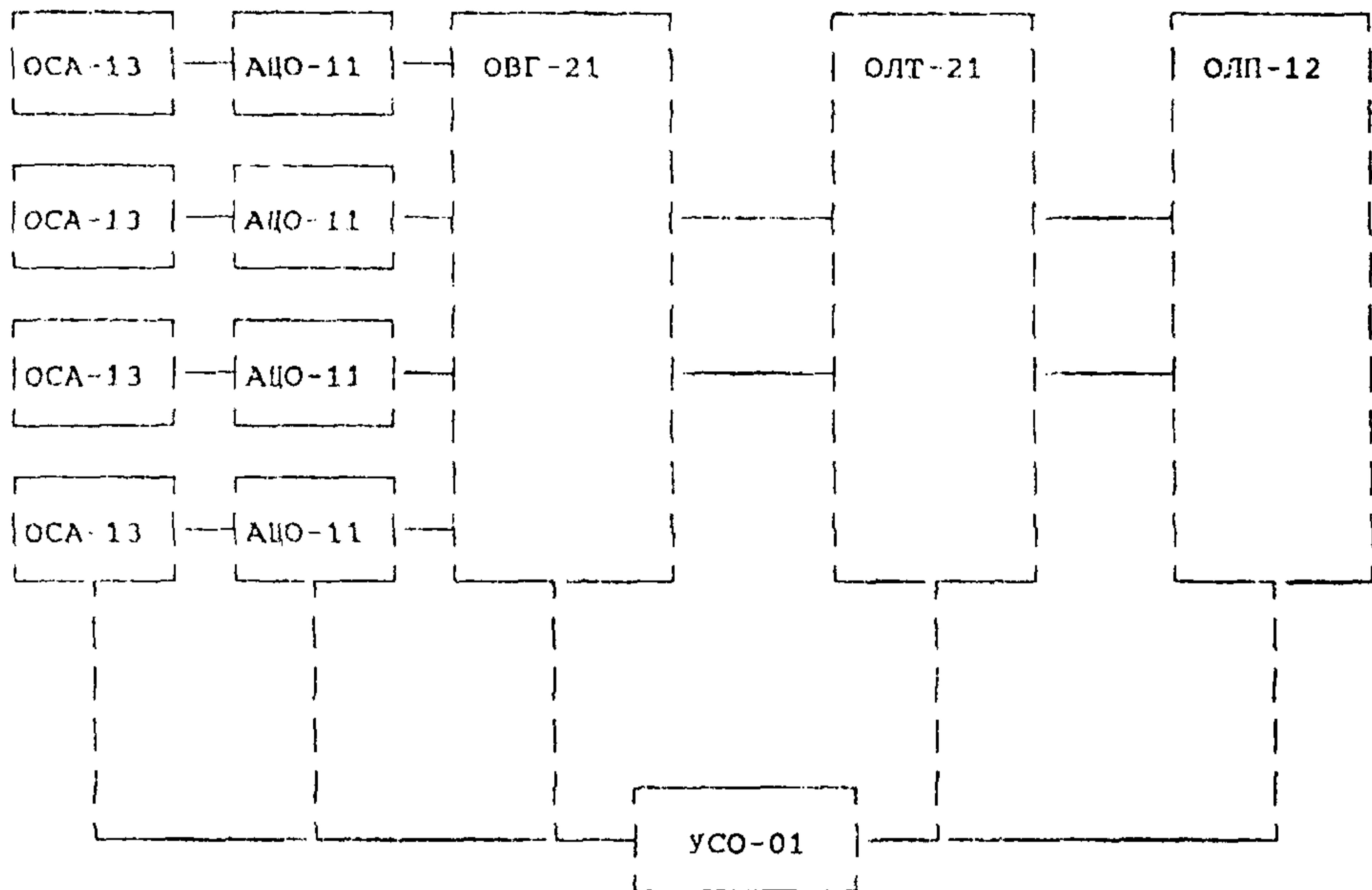
ОСА-13 - комплект согласующего оборудования межстанционных соединительных линий
